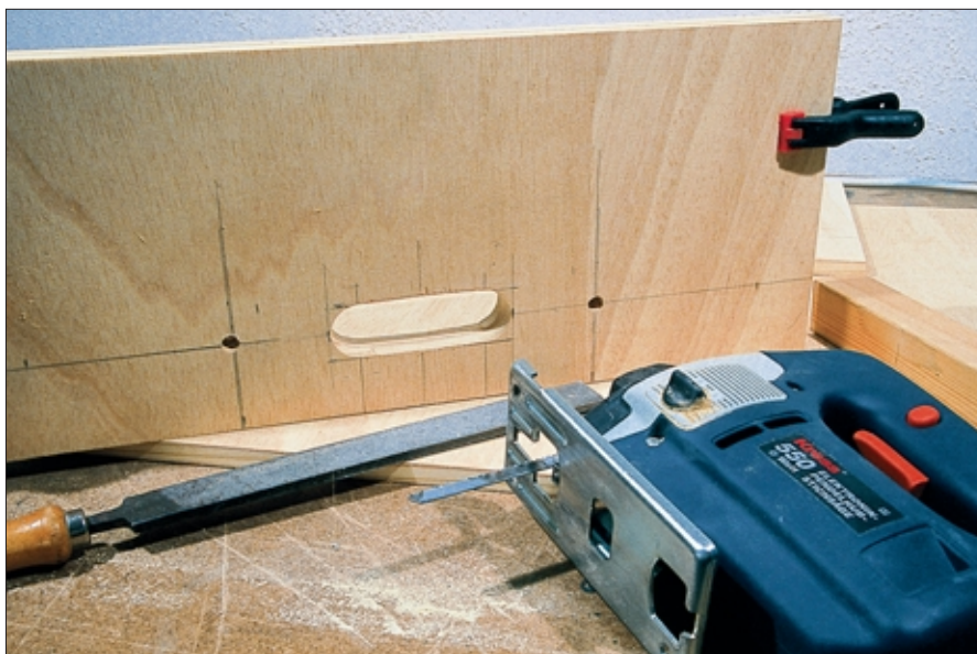
Die Bohrungen für Schlossschrauben und Grifföffnungen werden markiert. Basis ist eine 13 mm starke Tischlerplatte. Günstig ist es, immer zwei Kopfstücke mit entsprechenden Bohrungen und Sägeschnitten zu versehen. Damit erreicht man absolute Übereinstimmung. Allerdings sollten die freien Module tauschbar sein. Daher ist penibles Bauen absolut angesagt!
