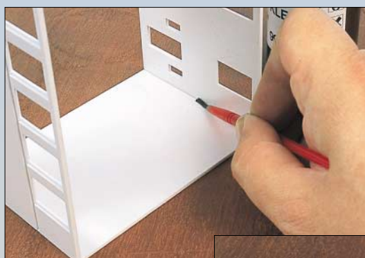
Oben: Die Wandteile sind sauber auf Gehrung gefräst. Zum Verkleben lässt man am besten dünnflüssigen Plastikleber von innen in die Spalte fließen. Rechts: Der Stellwerkvorbau. Bohrungen, in welche Polystyrol-Rundmaterial eingesetzt werden, helfen die Wände genau zu platzieren.
