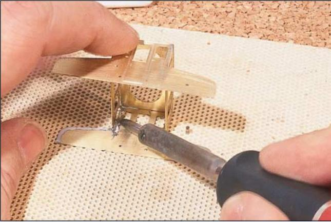
Nachdem die Vorderseite angeheftet war, konnten die Ecken von innen mit Hilfe von reichlich Lötlwasser verlötet werden. Dabei bewährte sich wieder die Keramikunterlage von Fohrmann mit den Stahlstiften zum Fixieren der Teile. Eine einfache Lötstation von Weller mit einem 40-W-Kolben reicht für das dünne Blech aus.
