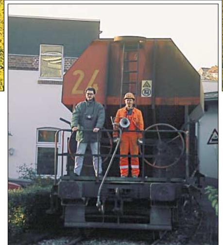
Quer durch fremde Firmengelände schlängelt sich das Anschlussgleis zur Verladung Lieth. Bei eisigem Wind und leichtem Regen hatte der Autor im November 1996 die Gelegenheit die Anschlussbahn zur Verladestelle Lieth von der Zugspitze aus kennen zu lernen. Der Rangierer hat eine an die Luft angeschlossene „Tröte“ für Warnsignale und kann notfalls die Bremluftleitung öffnen.
