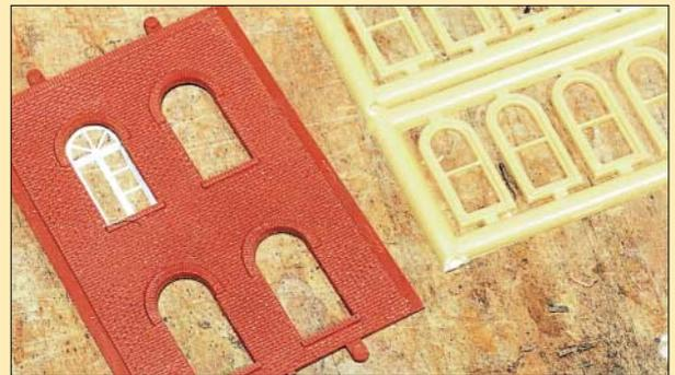
Oben: Die Fensterrahmen passen nicht ganz für Modelle nach deutschen Vorbildern; ich ersetzte sie durch neue aus zwei Schichten 0,5 mm starkem Polystyrol und entsprechenden Evergreen-Streifchen mit 0,5 mm, 1 mm und 2 mm Breite. Links: Drei Wandsegmente mit unterschiedlichen Torhöhen; die linke ist dabei groß genug für einen ins Innere führenden Gleisanschluss. Fotos: lk
