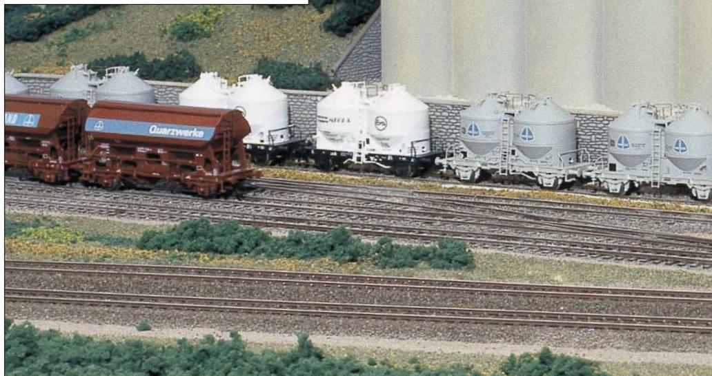
wegen der freien Verwendbarkeit von NEM- und RP-25-Radsätzen sonst fast ausschließlich Peco-Code-75-Material zum Einbau. Dank der bereits seit einiger Zeit lieferbaren DKW/EKW mit polarisierbaren Herzstücken kann hier auch mit kurzen, zweiachsigen Lokstörungs-frei rangiert werden.
