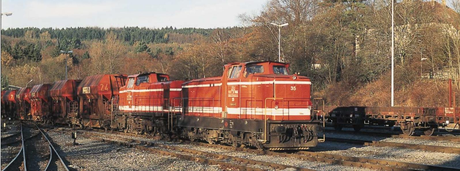
Die großen Industrie-Loks 35 (Achsfolge B'B', Klöckner-Humboldt-Deutz – KHD 1966, 1200 PS) und 40 (B'B', KHD 1970, 1100 PS) der WLE mit einem langen Leerzug bei der Einfahrt in den Endbahnhof Warstein. Nach der Ankunft werden die Loks umsetzen und den Zug Richtung Verladeanlage den Berg hinaufdrücken.
