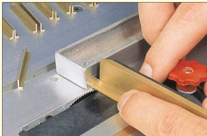
Beim Einklinken von Winkelprofilen sind Zulagen z.B. in Form eines weiteren Winkels erforderlich.
