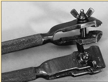
Feilkloben sind quasi kleine Schraubstöcke mit Griff, hier mit breiter und schmaler Backe.
