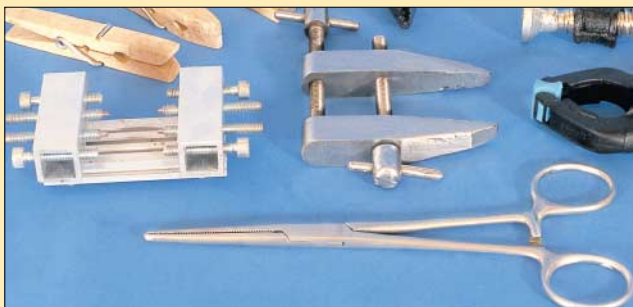
Als Haltevorrichtungen können z.B. Holzwäscheklammern dienen, es werden u.a. aber auch Spannzwingen oder Arterienklemmen verwendet. Unten eine Auswahl an Messern, z.T. mit Abbrechklingen; Taschenmesser eignen sich nicht für den Modellbau.
