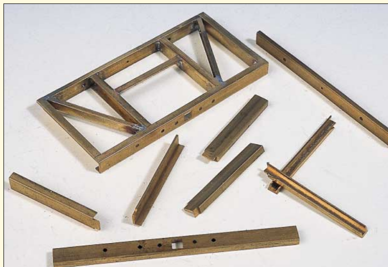
Die nötigen Profilzuschnitte und ein in der Lötlehre zusammengelöteter Rahmen
