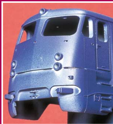
Typischster Lackierfehler: Staubeinschlüsse in Form von Staubkörnern und Fasern. Rechts wurde zu sehr aus einer Richtung gesprüht, weshalb in den Fensterlaibungen und den Vertiefungen nicht überall Farbe hinkam und so Spritzschatten entstanden.
