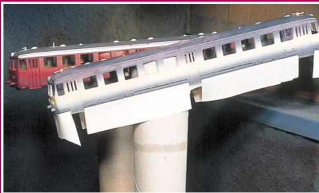
Bei mehrfarbigen Lackierungen wird in mehreren Arbeitsgängen vorgegangen. Hier bildet die helle Farbschicht die Grundlage für den noch herauszuarbeitenden Zierstreifen.
