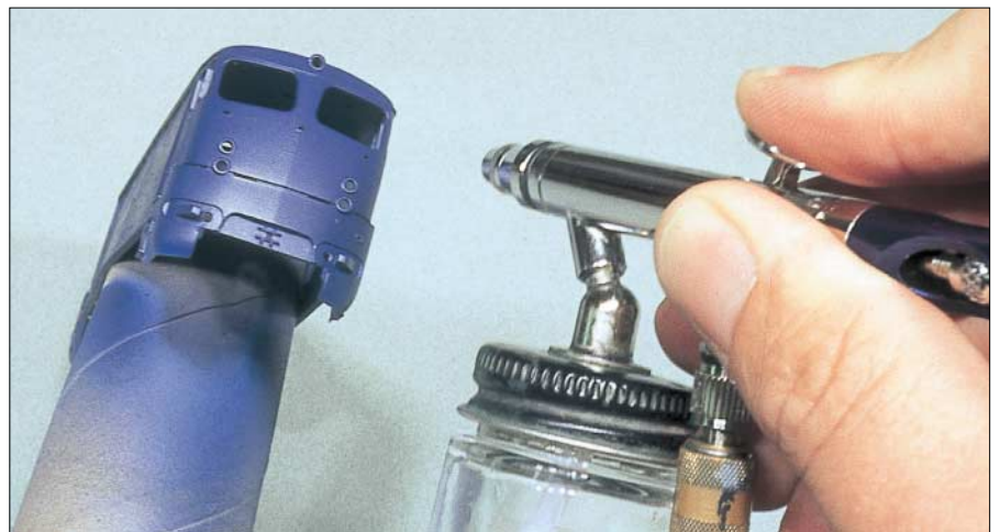
Insbesondere bei Modellen mit stärkeren Vertiefungen, Fensteröffnungen oder Ecken wird der Korpus bei der Lackierung in der anderen Hand gehalten und immer so gedreht, dass die Farbe überall gut hinkommt.
