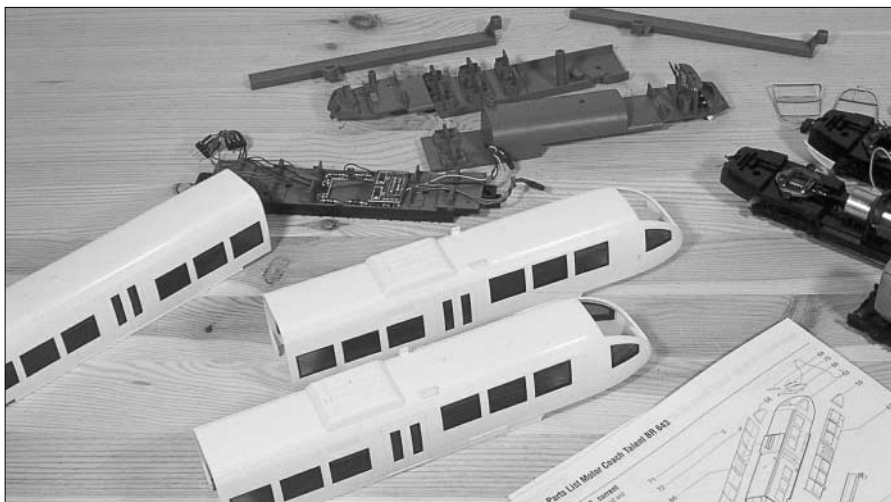
Aus dem undekorierten Brawa-„Rohmodell“ entsteht der Prototyp, zu dessen Bau nur die beiden Endteile benötigt werden. Zunächst einmal wird das Modell vollständig in seine Baugruppen zerlegt.
