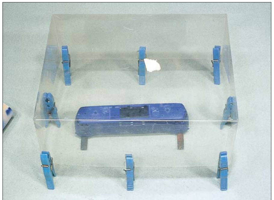
Beim Trocknen hat sich eine solche, hochgeständerte Haube bewährt, die die Luftzufuhr weiter gewährleistet, aber die Staubablage auf dem frisch lackierten Modell verhindert.
