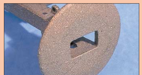
Ms-Feigussteil mit Korund behandelt
