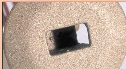
Ms-Feinguss mit Granatsand HS behandelt
