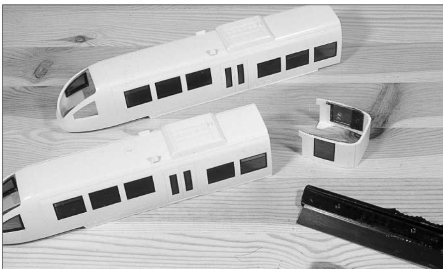
Durch einen geraden Schnitt wird das Gehäuse unmittelbar am letzten Fenster gekürzt. Hierzu eignet sich eine feinzahnige Bastelsäge. Der Fenstersteg sollte weitestgehend erhalten bleiben.
