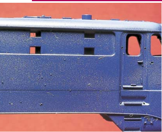
Typischster Lackierfehler: Staubeinschlüsse in Form von Staubkörnern und Fasern. Rechts wurde zu sehr aus einer Richtung gesprüht, weshalb in den Fensterlaibungen und den Vertiefungen nicht überall Farbe hinkam und so Spritzschatten entstanden.
