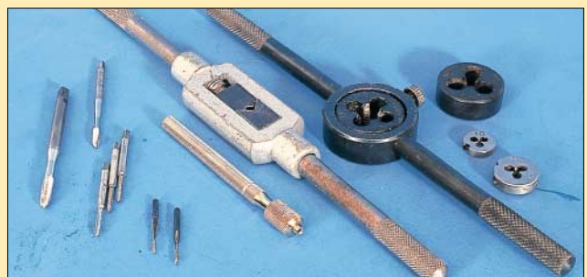
Auch das Gewindeschneiden findet im Fahrzeugbau Anwendung; links Gewindebohrer mit Windeisen, rechts Außengewindeschneider mit Halter.
