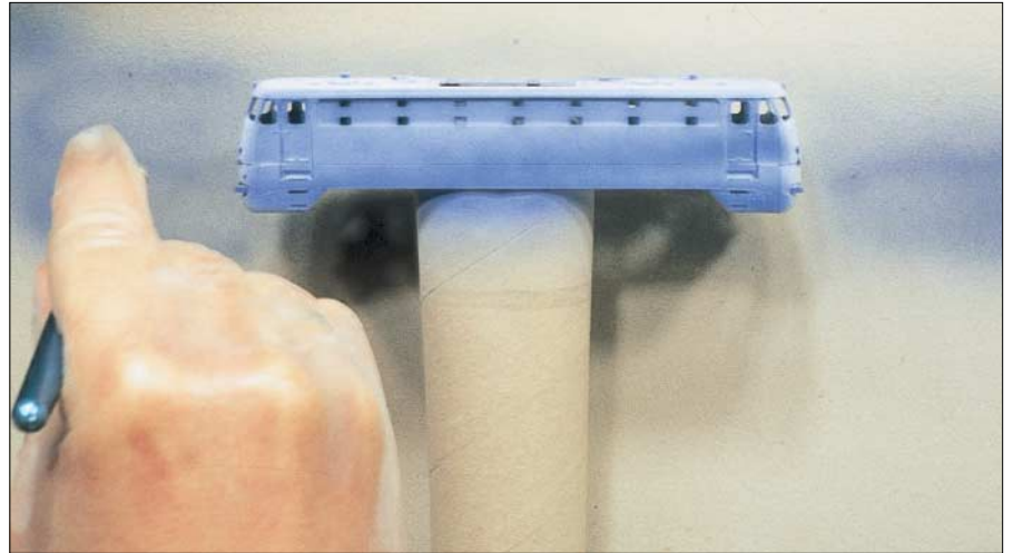
Beim Spritzlackieren sollte unbedingt außerhalb des Objektes mit dem Sprühen begonnen werden. Auch die Wendepunkte beim so genannten „Kreuzgang“ liegen außen.
