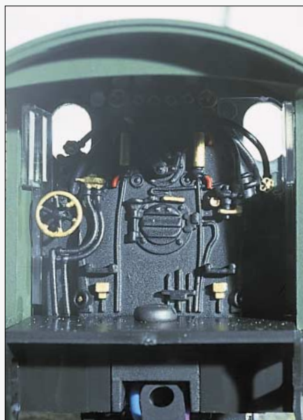
Die Stehkesselrückwand der G 4/5 von Bemo ist aus Weißmetall gefertigt.
