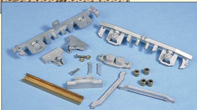
... Drehgestellblenden eingebohrt werden. Für die Höhenanpassung wird mit Distanzstücken eine Messingplatte auf einem Drehgestell montiert, auf dem anderen dient ein Messingrohr zur Abstützung.
