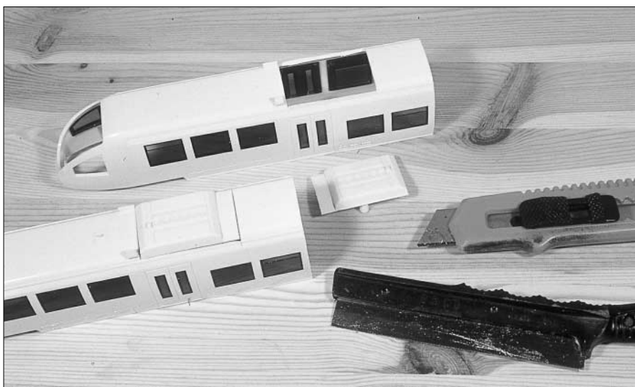
Die Klimaanlage auf dem Dach des Fahrzeuges werden einige Millimeter nach vorne versetzt. Dazu müssen sie aus dem Gehäuse gesägt und um 180 Grad verdreht wieder eingebaut werden.
