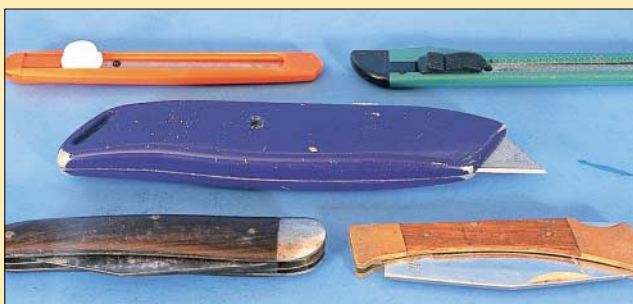
Als Haltevorrichtungen können z.B. Holzwäscheklammern dienen, es werden u.a. aber auch Spannzwingen oder Arterienklemmen verwendet. Unten eine Auswahl an Messern, z.T. mit Abbrechklingen; Taschenmesser eignen sich nicht für den Modellbau.
