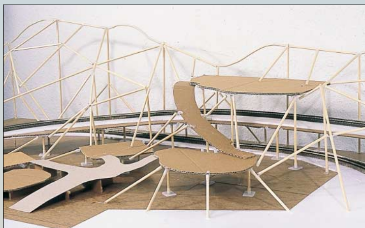
Oben links: Die Sarpronplatten geben der doch etwas wackeligen Trasse mehr Halt; als Unterlage für die Gleise wurden Korkbettungen von Faller verwendet. Oben: Der Unterbau für die „Landschaft“ entsteht aus Rundhölzern und den Verbindungselementen aus Kunststoff.
