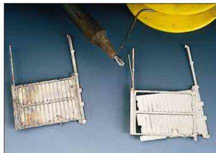
Links: Die beiden Wagenkastenteile werden rechtwinklig gebogen und durch Lötten fixiert. Anschließend richtet man beide Hälften aus und verbindet sie.
