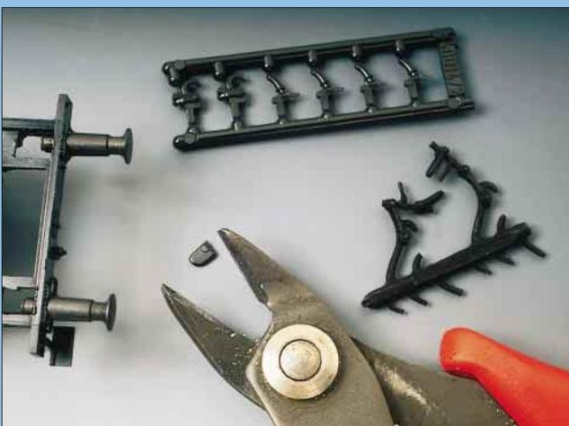
Die primitive Kupplungsattrappe wird abgetrennt und durch eine Kunststoff- oder Messingkupplung (z.B. Günther 001002) ersetzt.
