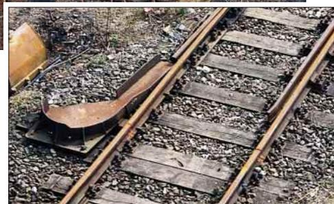
Noch vorhanden ist die Hemmschuhauswerfanlage am einstigen Stellwerk „R 1“. In Opladen gab es keine Gleisbremsen und daher wurde mit Hemmschuhen gearbeitet. An dieser Stelle wurden die Wagen vorgebremst und in den Richtungsgleisen zum Stehen gebracht.
