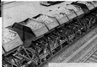
Abb. 12. Ein mit Bruchsteinen beladener Muldenkipperwagen, der — obwohl es sich um einen Spezialwagen handelt — paradoxerweise „vorbildlich“ beladen ist.
