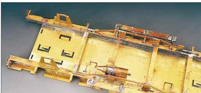
Das Fahrwerk entsteht auf gleiche Weise: Teile aus der Platine nehmen, versäubern und die Baugruppen schichtweise zusammensetzen.
