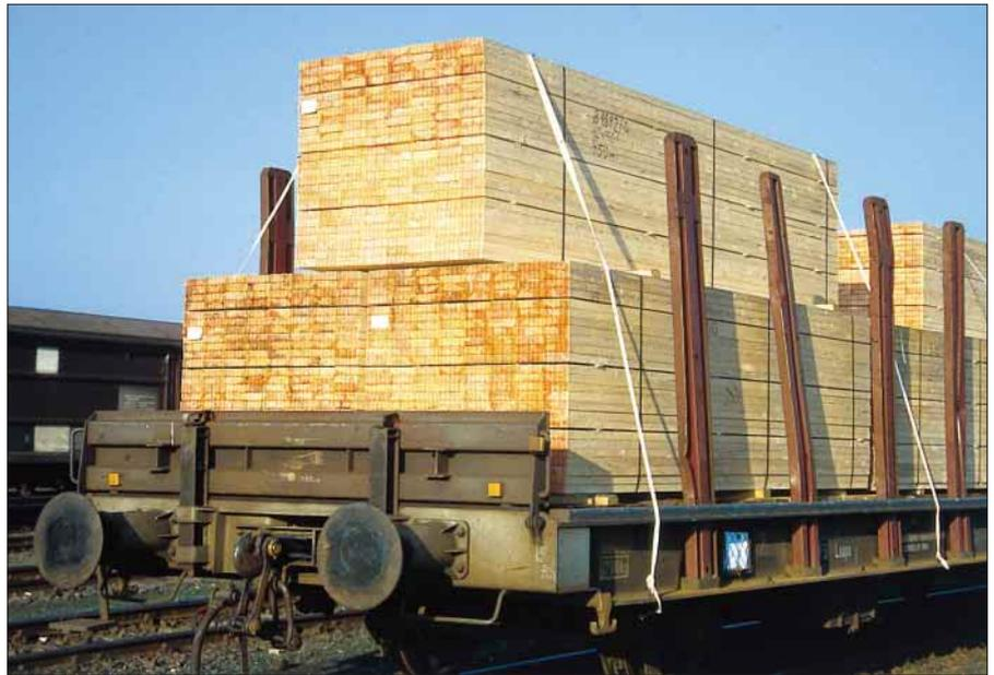
Niederbindungen – hier mit Nylongurten – halten die Ladeeinheiten auf dem Wagen rutschsicher fest.
