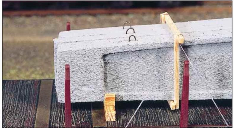
Gleich mehrere Sicherungsmittel auf einmal: Keile und Festlegehölzer begrenzen die seitliche Beweglichkeit dieser Kabeltrommel, Stützen verhindern die Längsverschiebung bzw. die Verlagerung des Schwerpunktes. Unterlagen und Sicherungshölzer im Modell: Wegen des enormen Gewichtes dieser Betondachbinder erfolgt die Zusammenfassung mit einem fest verbundenen Holzrahmen.
