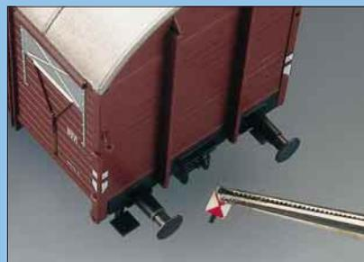
Die an Güterwagen angespritzten Signalhalter sind oft dick ausgeführt oder fehlen ganz. Die zu dicken schneidet man mit einem scharfen Messer ab, körnt die Stelle mit einer Nadel und bohrt ein Loch für das Messingteil (z.B. Günther 001320). Man kann auch Signalhalter mit einem Loch zur Aufnahme der Schlußscheibe verwenden.
