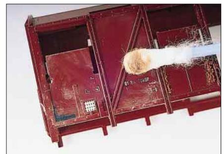
Mit Waschbenzin und einem Q-Tip entfernt man die alte Beschriftung vom Wagen.
