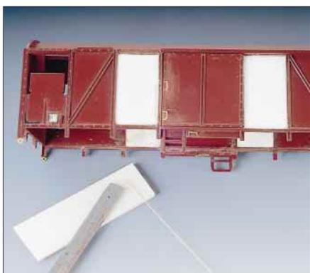
Die neuen Seitenwände entstehen aus 0,8 mm dicken Polystyrolplatten.
