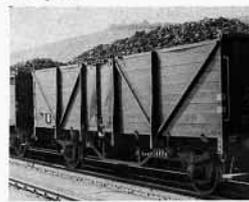
Abb. 11. Ein „bis zum geht nicht mehr“ mit Koks beladener O-Wagen der CFL. Die bis an die Seitenwand-Kanten reichende und auf diesen aufliegende Ladung widerspricht den Vorschriften der DB!
