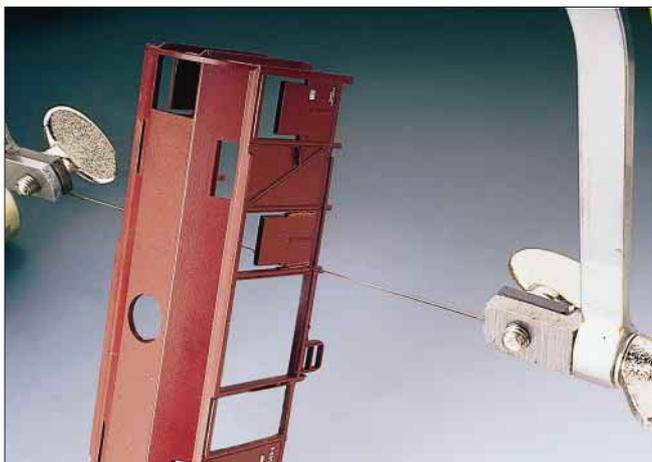
Nach der Demontage aller Teile vom Gehäuse trennt man mit einer Bügelsäge die jetzt falschen Wände neben den Schiebetüren auf beiden Seiten heraus. Die Sägeschnitte sollten aber nicht bis an die Profile geführt werden, um diese nicht zu beschädigen.
