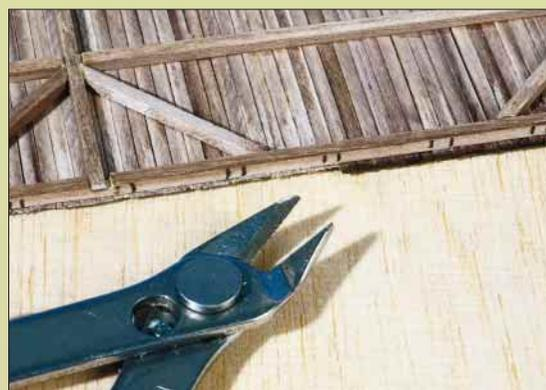
Zum Kleben kam Uhu-Kraft zum Einsatz. Damit er richtig hält, muß er nach kurzem Ablüften noch fest angedrückt werden. Nach dem Ankleben der Seitenteile war das leicht durchgebogene Dach auch wieder gerade.
