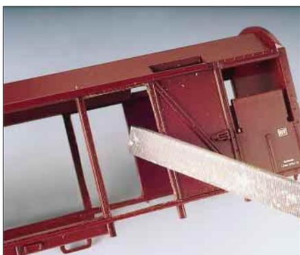
Mit einer Feile werden die nach dem Sägen verbliebenen Unebenheiten egalisiert.
