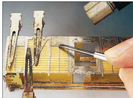
Nach dem Auftragen von Lötwasser wird das Teil von der Mitte zu den Enden hin verlötet.
