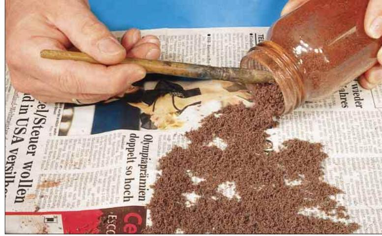
Die handfeuchte Spänemasse wird zum Trocknen auf einer saugfähigen Unterlage möglichst flach ausgebreitet. Für die Eaos-Ladung entstanden noch drei weitere Farbnuancen (Basis graublau).
