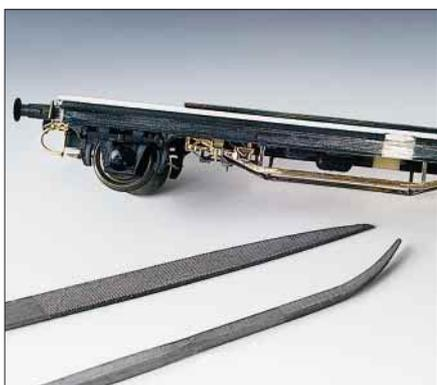
Der fehlende Wagenboden und die Seitenträger sind mit Polystyrolplatten ergänzt und mit Feilen angepaßt worden.
