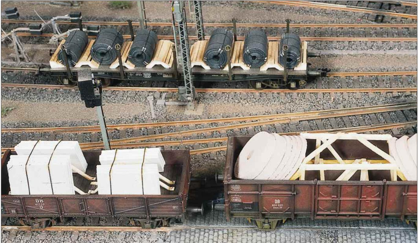
Zur Ladungssicherung bedient man sich bei bestimmten Ladegütern oft bestimmter Hilfsgestelle. Hier wurden für schräg gelagerte Steinplatten und Mahlsteine Lagergestelle gefertigt, bzw. für sich leicht verlagernde Coils hölzerne Mulden gezimert.
