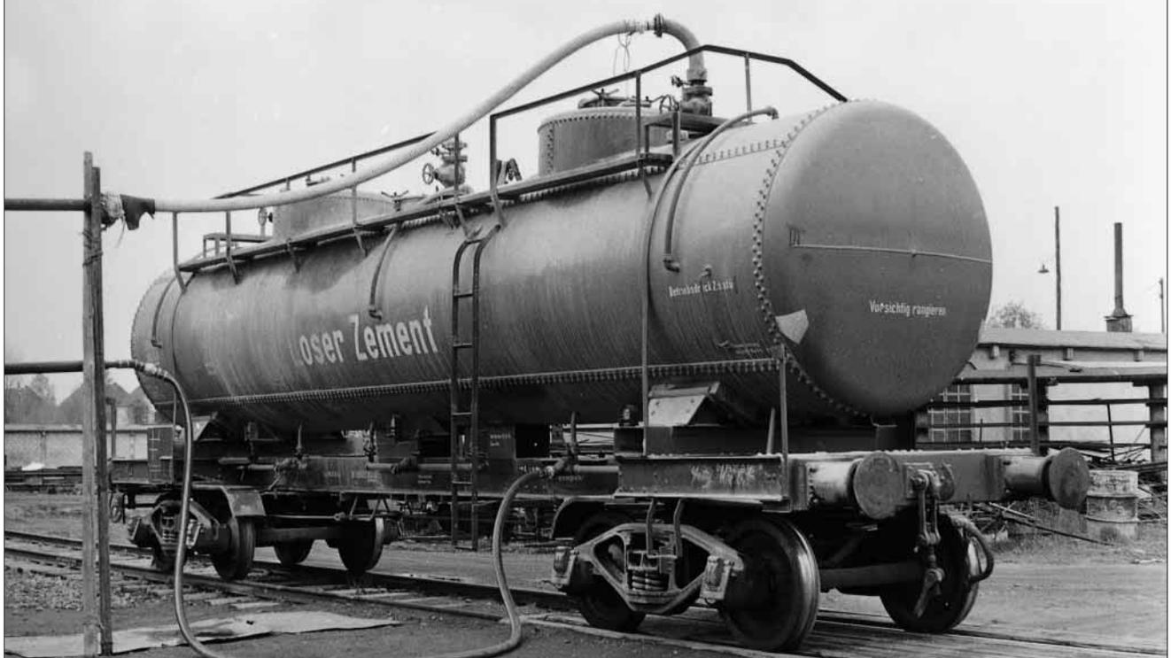
lungseinrichtung hindurch mit trockener Druckluft beschickt, die durch eine Kupplung angeschlossen wird. Sobald das Manometer 2 atü Druck anzeigt, kann das Absperrventil auf dem Kessel geöffnet werden.
