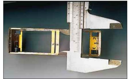
Mit einer Schieblehre wird die Maßhaltigkeit des Wagenkastens überprüft.
