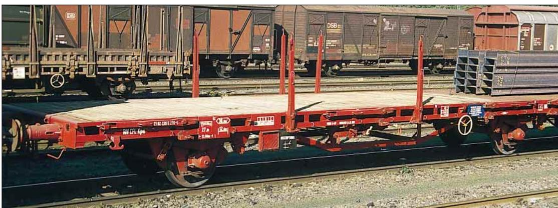
Ein sogenannter Schutzwagen wird bei überlangen Ladungen eingestellt, die über den eigentlichen Wagen hinausragen.
