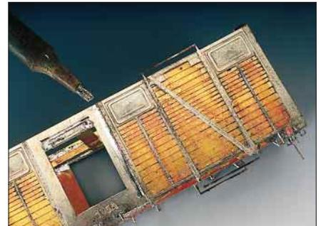
... exakt ausgerichtet auf den Wagenkasten gelegt und zuerst in der Mitte verlötet.
