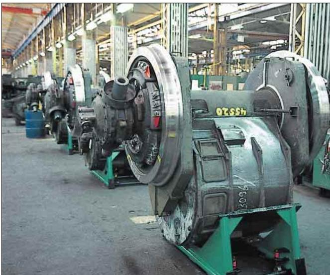
Bei den „Läufern“ werden die kupfernen Kontaktbahnen abgedreht.
