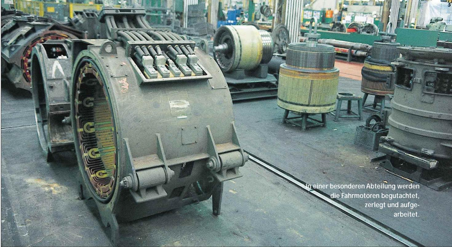
In einer besonderen Abteilung werden die Fahrmotoren begutachtet, zerlegt und aufgearbeitet.
