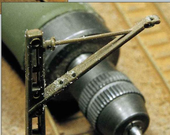
Rechts: Zwei Bohrungen mit einem Durchmesser von 0,5 mm im unteren Teil des Auslegers dienen zur Montage des Stützrohrs für die Befestigung des Seitenhalters. Die Bohrung an der Spitze des Auslegers, ebenfalls mit 0,5 mm Durchmesser, dient später zur Befestigung der Tragseile.
