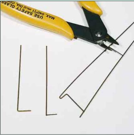
Über Weichen und an Nachspannabschnitten haben die Masten zwei Ausleger. Diese entstehen im Eigenbau aus nicht mehr benötigten alten 0,7-mm-Fahrdrähten. Man kann die Teile so heraustrennen, daß direkt rechte Winkel z.B. für den Auslegeranker (obere Waagrechte), vorhanden sind (links).
