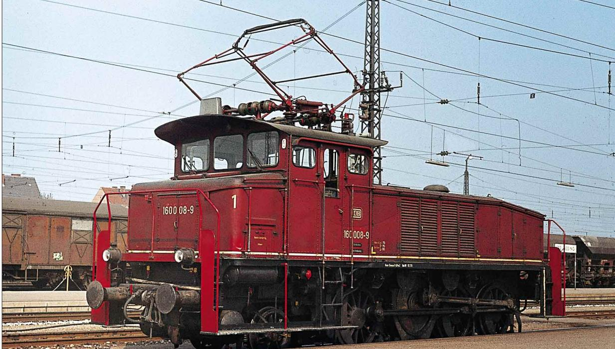
160 006 am 24. Juli 1976 im Hauptbahnhof Mannheim. Ab 1975 trugen alle Maschinen der Baureihe E 60 abgeänderte SBS-10-Stromabnehmer. Eine Verordnung der DB besagte, daß bei allen Altbau-E-Loks die Pantographen mit nur einem Schleifer gegen solche mit einer Doppelwippe ausgetauscht werden sollen, da in der Vergangenheit bei der 191 und 144.5 während schneller Fahrten mit nur einem Schleifer häufig Stromkontaktschwierigkeiten aufgetreten waren.
