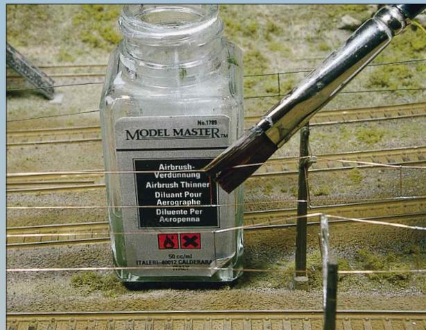
Mit einer normalen Ver-dünnung werden die fei-nen Kupferdrähte vor dem Lackieren entfettet. Vor allem im Bereich der vielen Lötunkte befindet sich oft noch übriggeblie-benes Lötvetts.
