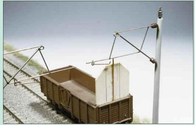
Am gegenüberliegenden Mast wird der Fahrdrabt durch den Seitenhalter folgerichtig vom Mast weggezogen (Ausführung L für langen Seitenhalter). Der Hilfswagen ist bei der Montage der Seitenhalter unentbehrlich.
