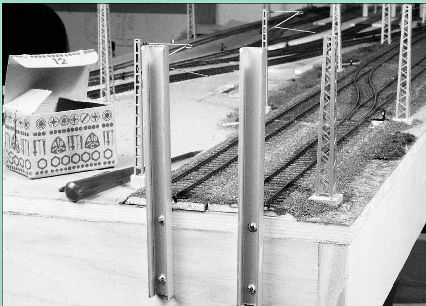
Für die Abspannung der am Anlagenrand endenden Gleise dienen Aluminium-U-Profile als Abspannmasten. Mit zwei Holzschrauben am Rahmen verschraubt, bieten sie ausreichend Stabilität. Bei Weiterführung müßten sie durch eine Toronstruktion ersetzt werden.
