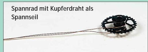
Spannrad mit Kupferdraht als Spannseil
