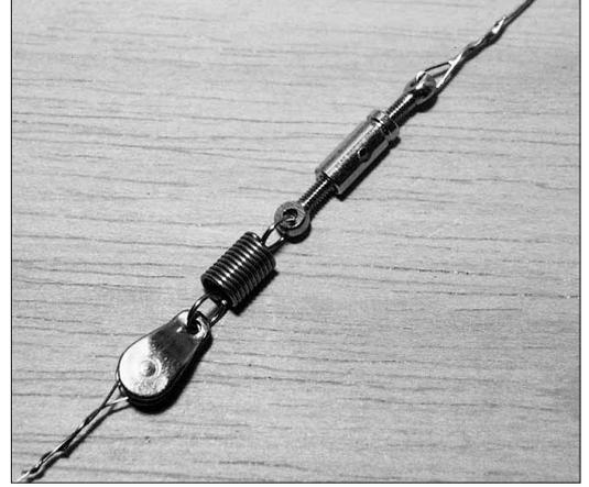
Nachspannung im Hintergrund: eine Feder aus dem Conrad-Federnsortiment, ein Spannschloß zur Feinjustierung und ein Block aus dem Schiffsmodellbau zur Aufnahme der Fahrdrachtschlaufe.
