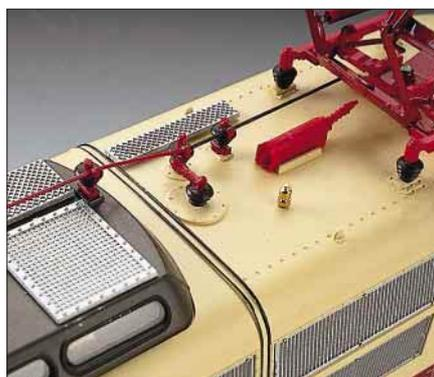
Der Trennschalter der 103 von Roco wurde um 30 Grad gedreht und direkt an die Dachleitung angeschlossen. Die gebogene Leitung ersetzt ein gerader 0,4-mm-Draht.
