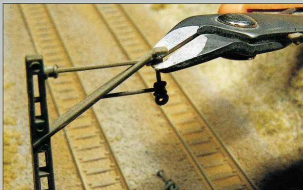
Links: Der erste Schritt zum Umbau der Masten. Mit einem kleinen Seitenschneider, beispielsweise von Faller, werden die nicht mehr benötigten Teile des Auslegers abgetrennt.
