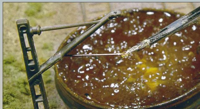
Links: Lötflüss aus dem Elektronikhandel erleichtert die nun anstehenden Arbeiten ganz enorm. Mit einem kleinen alten Pinsel läßt es sich auch in kleinsten Mengen punktgenau auftragen.
