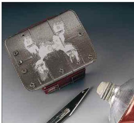
Die alten Halterungen werden auf dem Dach abgeschnitten, die Löcher der alten Pantograph-Halterungen mit Nitropachtel geschlossen und verschliffen. Zu einem späteren Zeitpunkt wird das gesamte Dach mit Silber neu lackiert.
