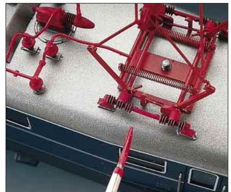
Die Pantographen-Halterungen, meistens in braunem Kunststoff hergestellt, werden rot angemalt. Jetzt fehlt nur noch, die Modellhalterplatte des Pantographen silbern zu lackieren.
