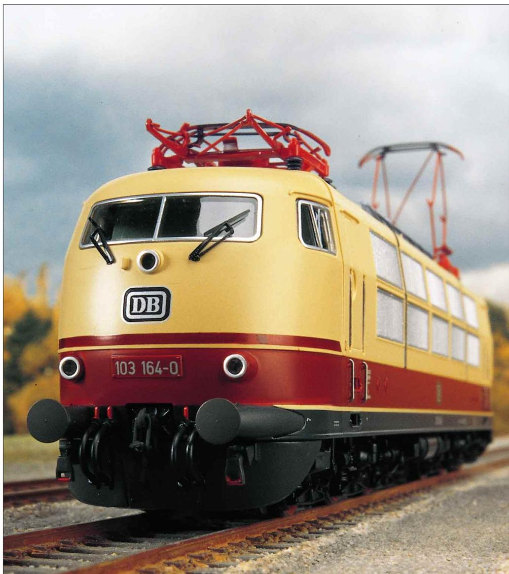
Bei Lokomotiven, die sehr hohe Geschwindigkeiten fahren, wie z.B. bei der 103, hat man auf das seitlich ständig angebrachte Kabel verzichtet. Es liegt im Maschinenraum und kann bei Bedarf auch in der zusätzlich rechts installierten Heizleitungs-Steckdose angeschlossen werden.
