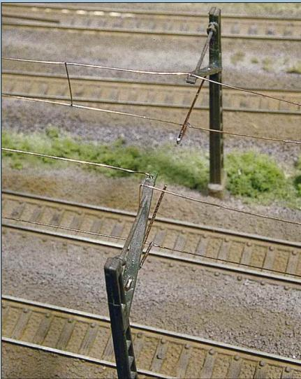
Oben links: So werden die Seitenhalter montiert. Mit Hilfe der Profillehre und einer Klemmpinzette macht das Ganze weniger Schwierigkeiten als befürchtet.
