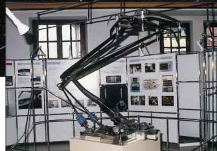
Der ICEexperimental ist mit Einholmstromabnehmern von Dornier, Typ DBS 350, bestückt (Isolatoren wegen der etwas größeren Bauhöhe des Prototyps in den Armen).
