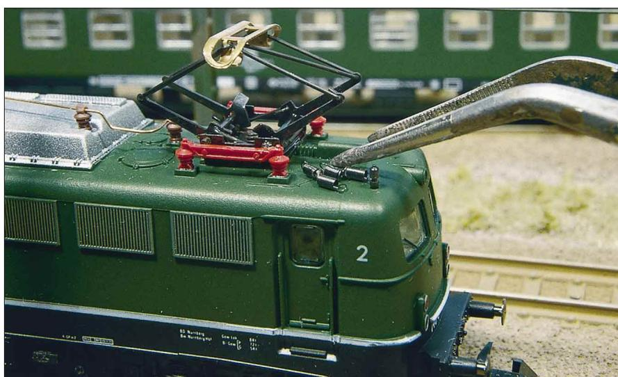
Kleine Operation, kurz und schmerzlos. Um die beweglichen Pantographen in einer bestimmten Höhe festzusetzen, werden die kleinen Federn kurzerhand mit einer Pinzette herausgenommen. Die Gelenke erhalten eine Sicherung mit Sekundenkleber. Damit die Höhe bei allen Loks auch wirklich gleich wird, baut man sich am besten eine kleine Lehre.
