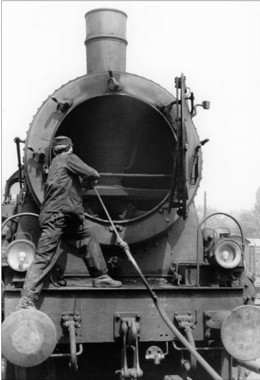
Das Reinigen und Ausblasen der Rauchkammer war eine schmutzige und unbeliebte Arbeit. Foto: Archiv Dr. Wolff u. Tritschler
