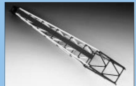
Die Zwischenstreben können vom Originalbausatz übernommen werden. Fehlende Quer- und V-Streben werden wieder aus den L-Profilen erstellt. Fotos: Markus Tiedtke
