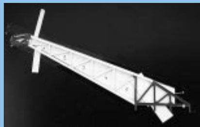
Auf der Papierschablone, die mit Tesafilm auf der Grundplatte befestigt ist, wird der Ausleger für die Einpassung der seitlichen V-Streben mit Stecknadeln fixiert.
