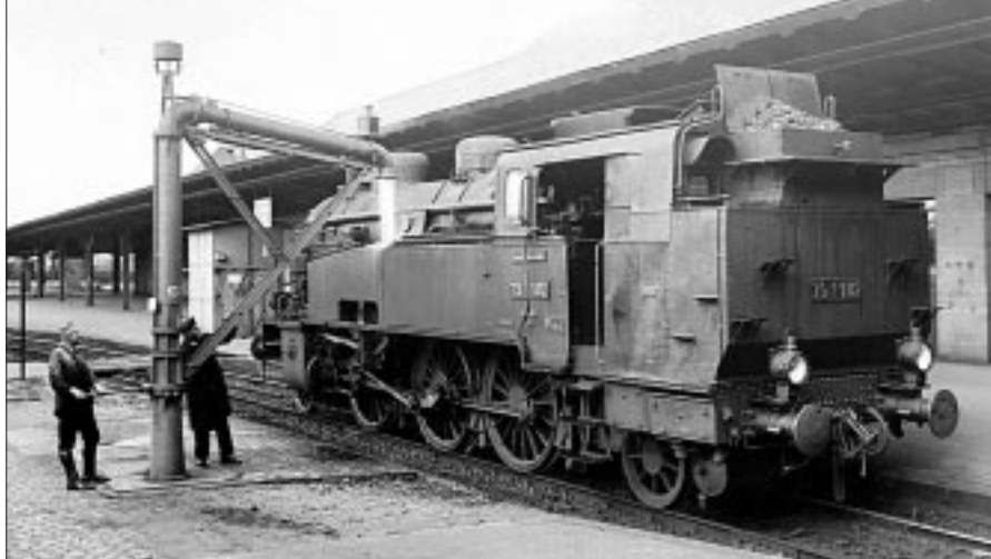
Wasserkran der badischen Staatsbahn. Um bei Schnellzuglokomotiven das zielgenaue Halten vor dem Wasserkran zu umgehen, konnte das Auslegerrohr durch Ausziehen in der Länge beliebig variiert werden.
