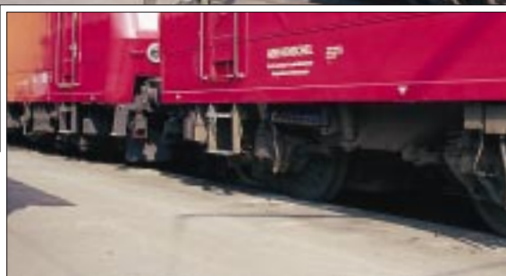
Zwei Vorserien-120. 120 004 ist die erste mit Scheibenbremsen ausgerüstete Hochleistungslokom – die Aufschrift verkündet es unübersehbar. Außerdem: Eigentums- und Heimatanschrift in neuer Form.
