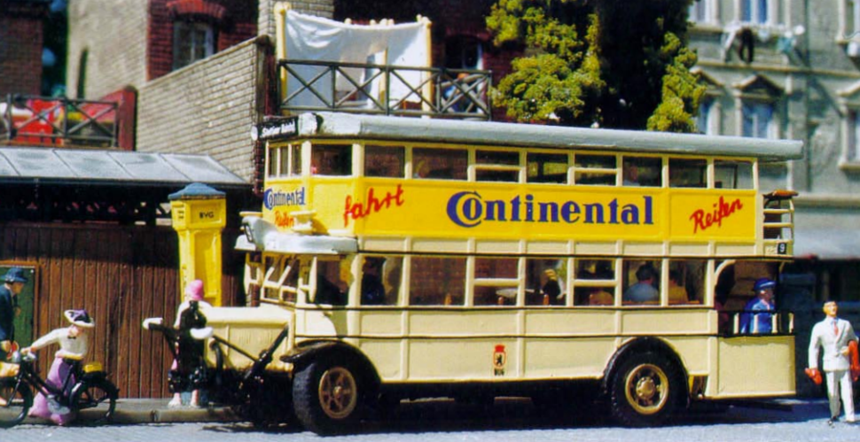
Dieser NAG D2 May ist mit einer teilweise geöffneten Frontscheibe dargestellt. Außerdem fällt an diesem Fahrzeug die außenliegende Lenksäule auf.
