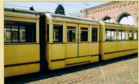
Die Gelenkstraßenbahn TG 29/38 in voller Länge. Oben erkennt man den schwebenden Mittelteil des Originals.
