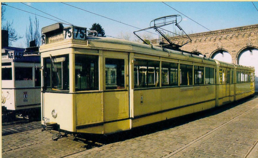
Die Gelenkstraßenbahn TG 29/38 in voller Länge. Oben erkennt man den schwebenden Mittelteil des Originals.
