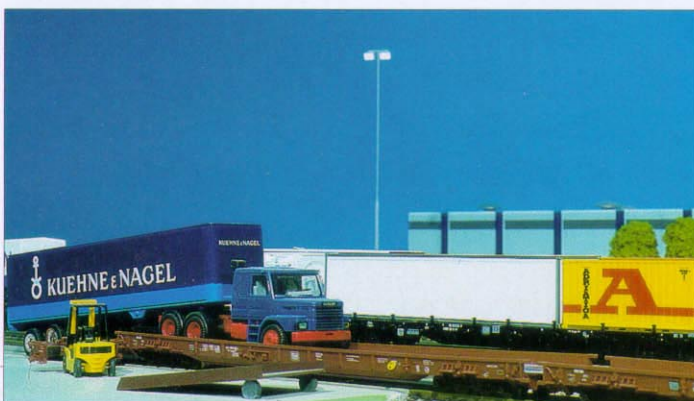
Die Auffahrrampe und die abschließende Pufferbohle des letzten Taschenwagens werden mit einem Gabelstapler manövriert.
