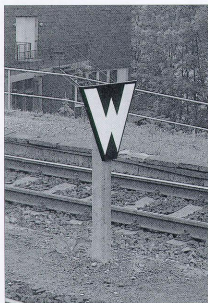
Das Signal Ra 11b bei der DR erlaubt die Weiterfahrt nur nach mündlichem, fernmündlichem oder einem entsprechenden Handzeichen.
