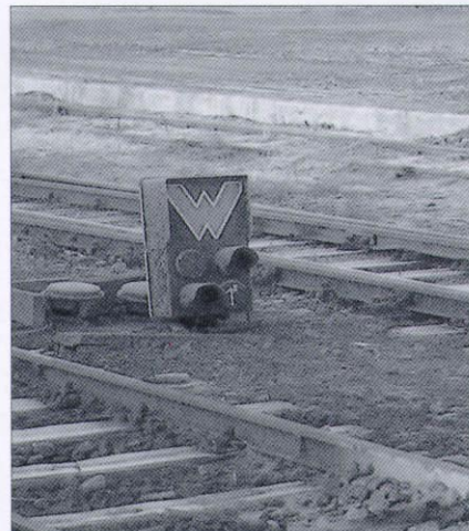
Bei der DB gilt das Signal Sh 1 nur als Fahrauftrag, wenn sich am Signalmast die auf der Spitze stehende, quadratische weiße Scheibe befindet (links).
