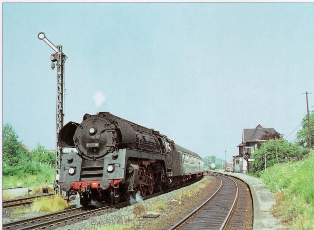
01508 bei Hönebach. Ebenso wie die DB war die DDR-Reichsbahn auf leistungsstarke Dampfloks älterer Baureihen angewiesen. Während die DB schon in den Fünffzigern mit der Neubekesselung von Pacifics begann, kam es in der DDR erst Anfang der Sechziger zum Kesseltausch bei Loks der Baureihen 01 und 03. Die „Reko“-01.5 erhielten neben einem neuen Kessel u.a. auch ein neues Führerhaus. Ihr Kessel war sogar noch leistungsfähiger als der Ersatzkessel für die DB-01.10.
