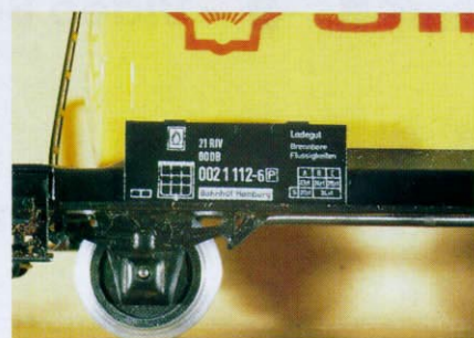
Beschriftungstechnik. Handgemaltes Anschriftenfeld an einem Guß-Wagen (oben). Schiebebilder (oben rechts) wurden durch gedruckte Aufschriften (rechts) abgelöst.
