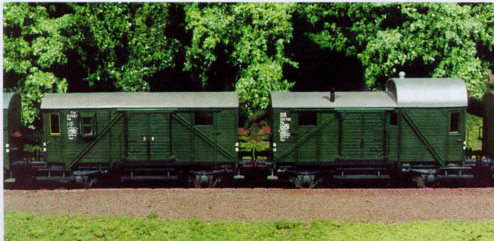
Stark umgebaut wurde dieser Packwagen. Bernd Lang entfernte die Dachkanzel und brachte dafür die Fenstererker für die freie Sicht des Modell-Zugführers.
