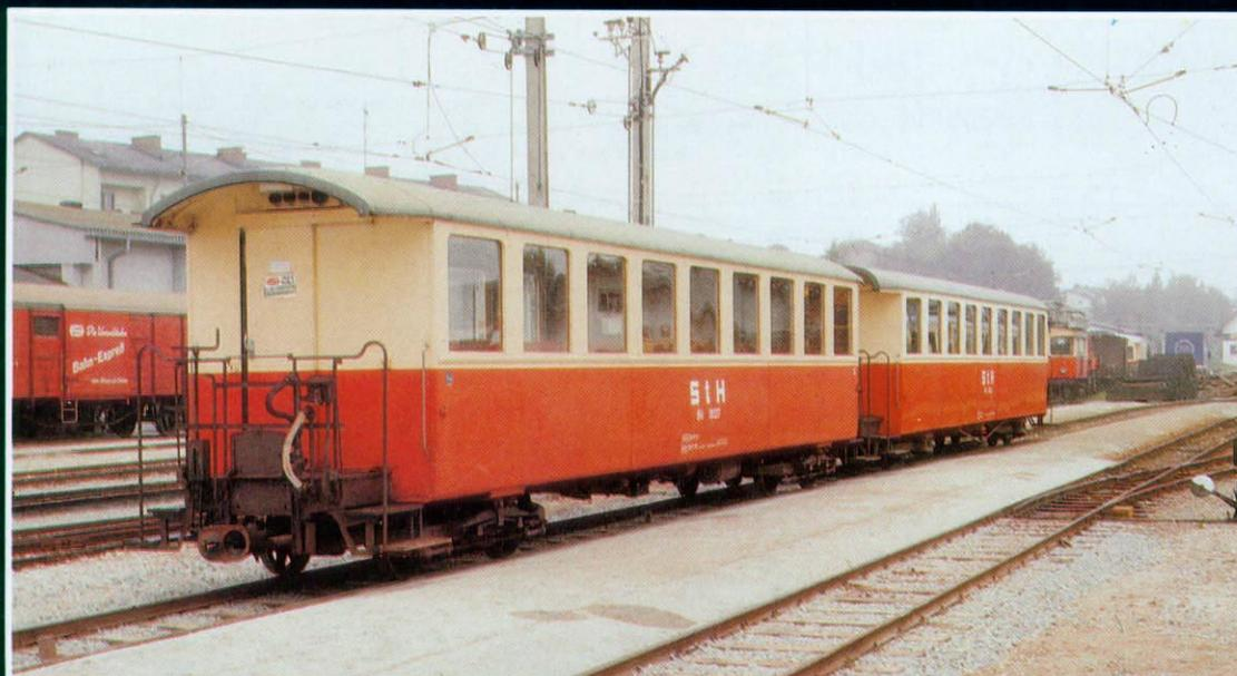
◀ Zwei vierachsige Schmalspurwagen. Sie ergänzen das Fahrplatzangebot der Triebwagen.
