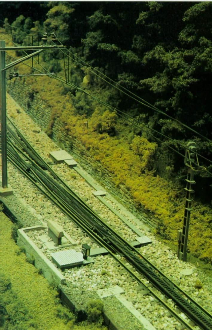
Eine von HRF gebaute Zahnstangenweiche nach System Rigenbach/SLM. Entsprechende Bausätze oder gar Fertigmodelle der Weichen sind allerdings nicht im HRF-Programm. Der Verstellmechanismus für die das Schienenprofil trennbar überlappenden Zahnstangen wäre zu aufwendig, zu kostenintensiv.
