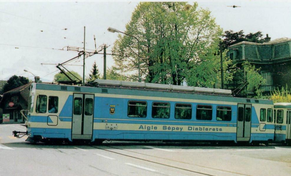
▲ Der Zug der ASD überquert die im Straßenplanum liegende Strecke der AOMC. Beide Oberleitungen sind getrennt, die der ASD ist hier ein kurzes Stück stromlos.
