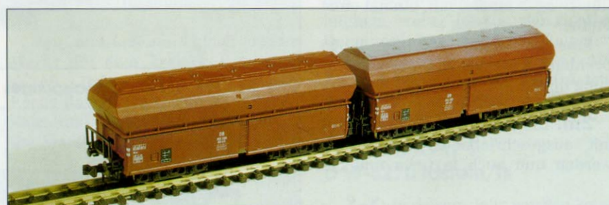
N Bild 194. Die Selbstentladewagen Fad erhielten jetzt auch eine Dachabdeckung.
