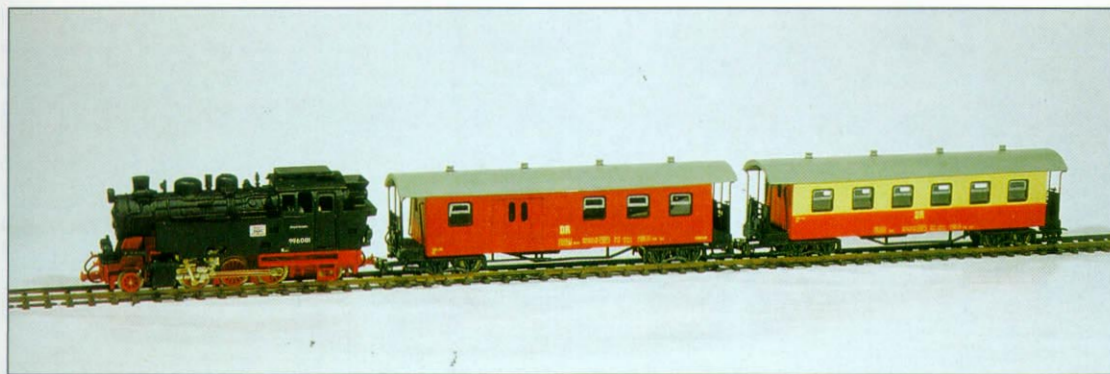
H0m Bild 156. Ein schöner Harzquer-Bahn- zug, bestehend aus der 99 6001 und zwei typi- schen Reko- Wagen. Die Kehi-Fertigmo- delle bestehen aus Messing und Weißmetall.
