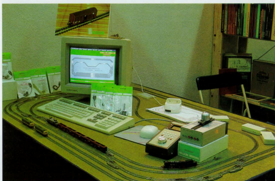
2-Z Bild 290. Railtronic: Computersteuerung für Selectrix. Alle Schaltungen am Bildschirm.
