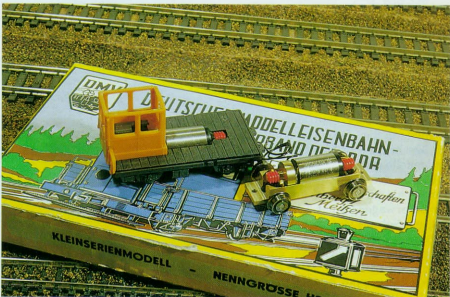
H0 Bild 339. Reichsbahn-Skl mit Faulhaber-Antrieb bei sb.
