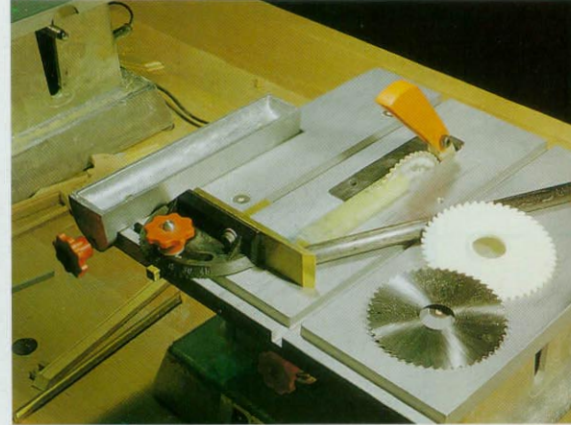
Bild 37. Die neue Keramik-Säge-scheibe Z 48 (weiß) mit den Maßen 63 x 1,5 x 16.
