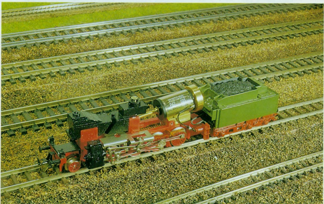
H0 Bild 339. Reichsbahn-Skl mit Faulhaber-Antrieb bei sb.
