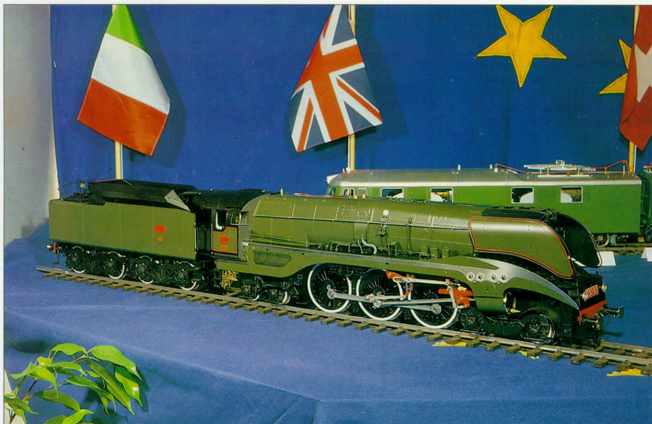
1 Bild 93. Von Aster für Fulgurex: Die SNCF-Dampflok 232 U.1 mit Dampf- und Elektroantrieb.
