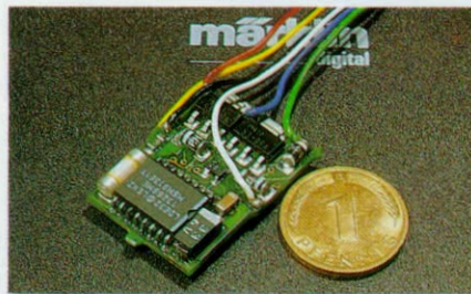
2-N Bild 178. Ein sehr kleiner Lokempfänger von Lenz.
