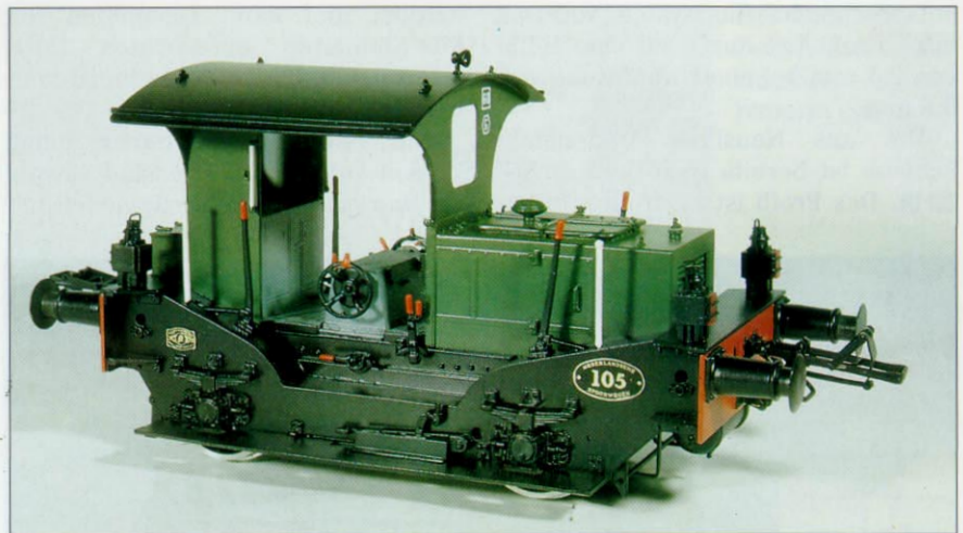
O Bild 264. Motor-Kleinlok der NS mit allen Details, die das Vorbild besaß.
