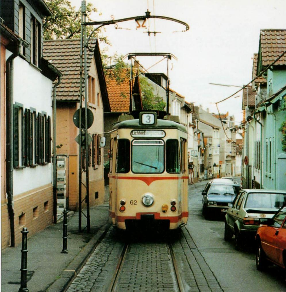
Eine Vorbildsituation, die zum Nachbau reizt: TW 62 der HEAG in der Ludwigshöhstraße, Darmstadt-Bessungen. Der Triebwagen – eine Sonderbauart – kam aus Remscheid und hat deshalb 376 PS und eine zusätzliche Scheibenbremse für Steilstreckenbetrieb. Foto: Holger Kötting
