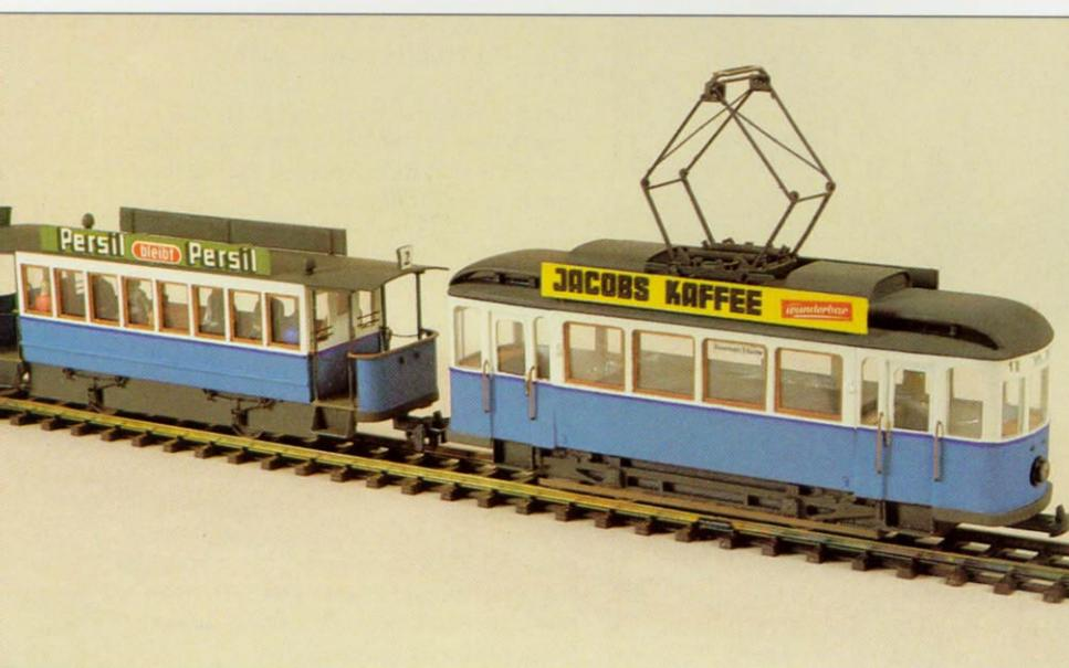
Ab 1910 erfolgte der Umbau der Triebwagen. Die Plattformen wurden geschlossen und mit Schleppdächern versehen; der Achsstand von 2,00 Meter auf 2,80 Meter verlängert (unten).
