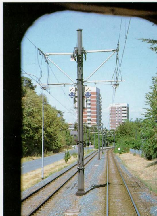
Lichtsignal mit Zwangshalt-Tafel oben auf dem Mast. Selbst wenn, wie hier, „Fahrt“ signalisiert wird, muß ein fahrender Wagen kurz anhalten. Das runde Dauerlicht bedeutet „Achtung!“ (Bild links oben). Fahrleitungssignale im Bild rechts oben: einmal für den Überspannungsableiter, je zweimal für Streckentrenner und Trennstelle, die nur mit Fahrswitcherstellung „Null“ überfahren werden darf. Aufnahmeort: unmittelbar südlich des Depots Frankenstein in Darmstadt-Eberstadt. Fotos: Bertold Langer
