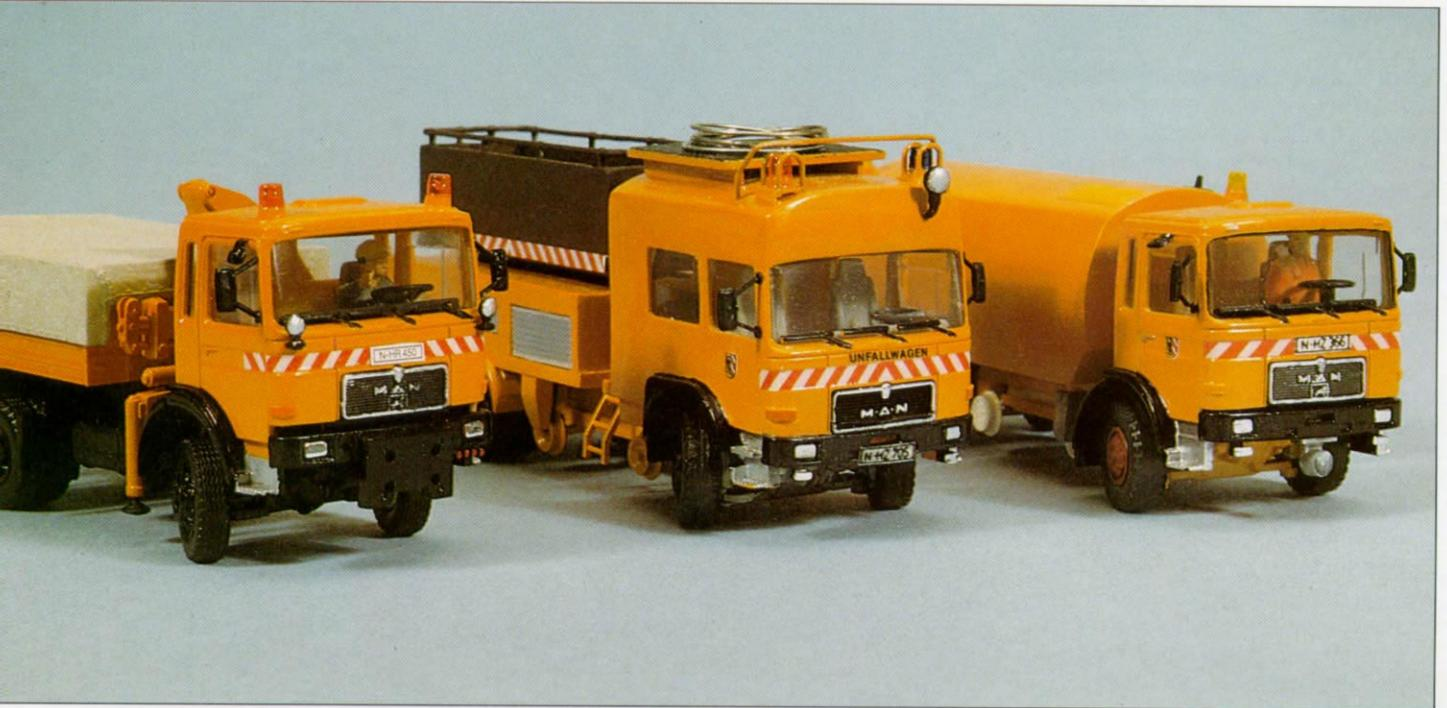
Zur Straßenbahn gehören auch Kraftfahrzeuge für Hilfsdienste: Oberleitungs-Reparaturwagen, Schienenreiner, Unfallhilfswagen. Kfz sind – zugegebenermaßen – im Straßenverkehr beweglicher als Schienenfahrzeuge. Deshalb setzen Verkehrsbetriebe für die genannten Zwecke Kraftfahrzeuge ein.
