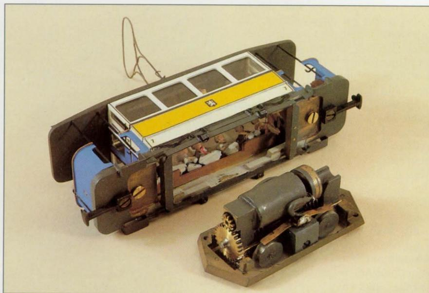
Der Fahrzeugantrieb mit Schwungmasse wurde ebenfalls selbst gebaut. Infolge der guten Abgabeleistung und Drehzahl-dynamik des Glockenankermotors im unteren Bereich konnte die Kraftübertragung über ein Schneckengetriebe (1:25; M 0,3) auf beide Achsen erfolgen. Der Fahrzeuglauf ist bei guter Zugkraft ruhig und ausgewogen (Mitte).
