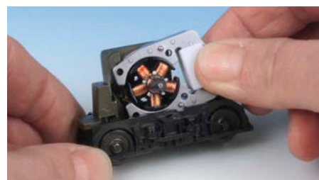
Mit den neuen Komponenten wird der Wechselstrommotor zum Gleichstrommotor.
