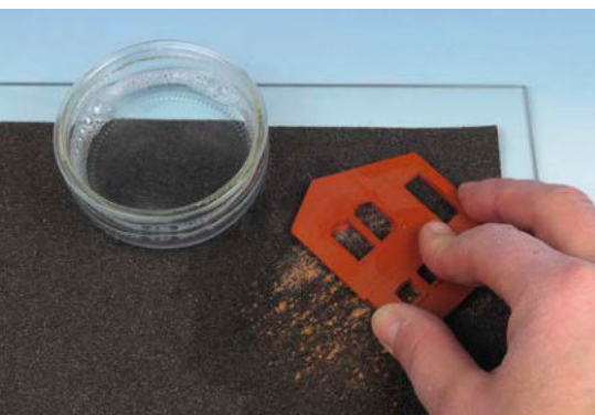
Für glatte Innenwände sollten die Wandelemente an der Innenseite geschliffen werden.
