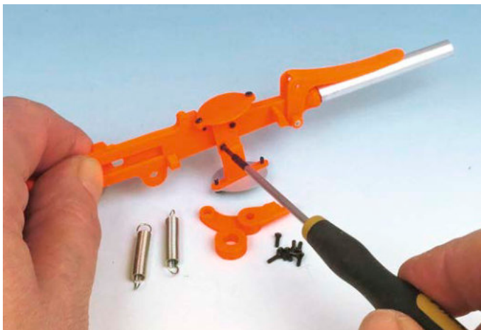
Die meisten Bauteile werden nicht geklebt, sondern verschraubt. Die winzigen Befestigungsschrauben gibt's im Fachhandel oder im Internet.
