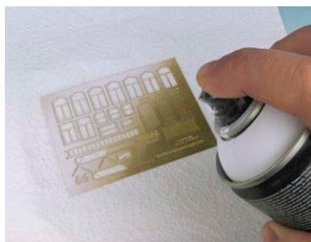
Die Fenster aus dem fotogätzten Messingblech werden noch im Rahmen grundiert.
