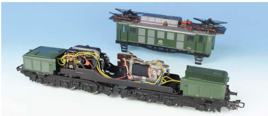
Das Modell 3022 der schweren Güterzuglok der Baureihe 194 ist ein Klassiker im Sortiment des Göppinger Traditionsherstellers. Bis in die 1990er-Jahre wurden Wechselstrommotoren verbaut.
