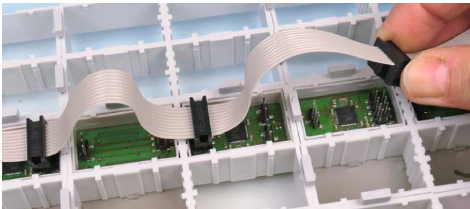
Die Busverdrahtung ist gegenüber der konventionellen Verdrahtung analoger Tischfelder klar im Vorteil. Nur die aktiven Funktionsplatinen werden dabei mit dem Erbert-Datenbus verbunden.
