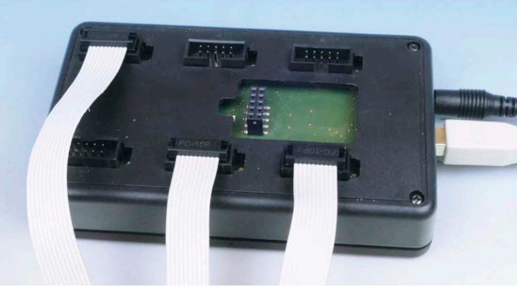
Das aktuelle PC-Interface von Erbert besitzt neben den sechs Anschlüssen für die Datenleitungen noch einen zusätzlichen Programmiersteckplatz für die aktuellen Platinen der 132er-Serie.
