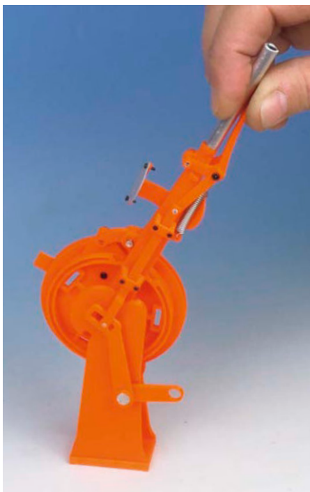
Funktionsfähige Weichenstellhebel lassen sich auch – gewusst wie – im 3D-Druck herstellen.
