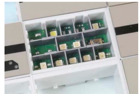
Die Elektronik wird einfach von oben in die miteinander verbundenen Rahmen eingelegt.
