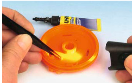
Zu den ersten Arbeitsschritten gehört es, die kleinen Teile mit UV-Kleber vorzumontieren.
