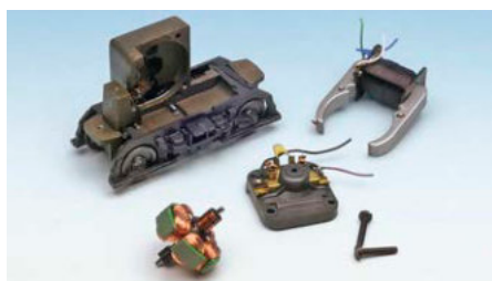
Die Einzelteile des alten Motors mit der Feldspule haben ausgedient und werden ersetzt.
