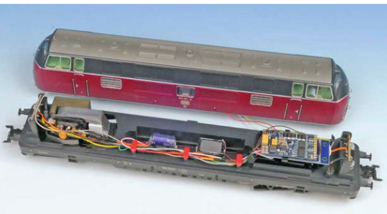
Die Automatikkupplungen sind mit zwei schwarzen Leitungen ausgestattet, die neben den Drehgestellen nach innen geführt werden.
