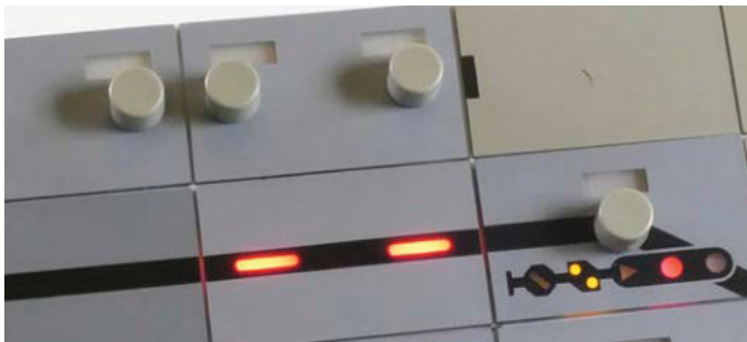
Für Sonderfunktionen sind auch Außen- und Gruppentasten verfügbar. Die rote Gleisausleuchtung darunter zeigt ein belegtes Gleis an.
