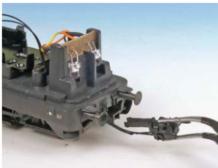
Die Automatikkupplungen sind mit zwei schwarzen Leitungen ausgestattet, die neben den Drehgestellen nach innen geführt werden.
