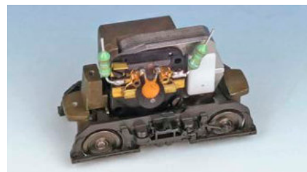
Das Drehgestell ist mit Entstördrosseln versehen und kann wieder eingebaut werden.
