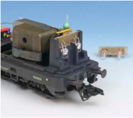
Die 3-mm-LEDs ersetzen die guten alten Glühlampen an den Stirnseiten der Lokomotive.
