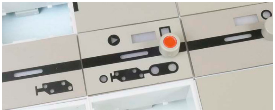
Fertig eingebaut sind die Tischfelder des Erbert-Stelltischs vom großen Vorbild kaum zu unterscheiden. Auch der Sperrmelder, der Festlegemelder sowie der Ersatzsignalmelder sind an Bord.
