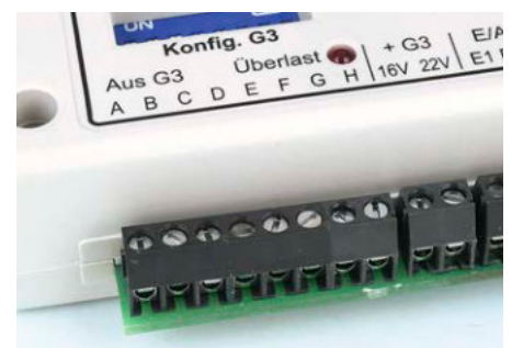
Die Verbraucher werden über Schraubklemmen mit dem Lichtcomputer verbunden. Alle Ausgänge sind gegen Überlastung geschützt.
