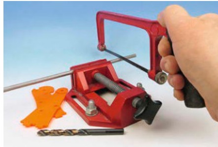
Vor dem Baubeginn müssen die Alustangen und die Drähte auf die passende Länge gebracht werden. Dies gelingt mit der Puksäge.
