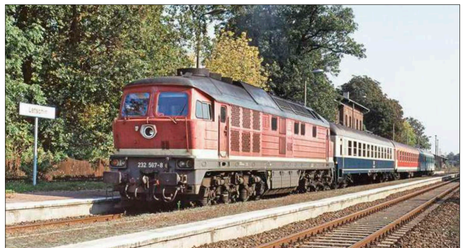
Auch dieser RE 7 des Verkehrsverbandes Berlin-Brandenburg am 27. September 2000 in Letschin im Oderbruch war eine recht bunte Zugzusammenstellung. Hinter 232 567 in DR-Farben läuft ein Bm der ehemaligen DB in Blau-Beige. Dahinter ein ABom Seitengangwagen der DR in Verkehrsrot und am Zugschluss ein mint-türkiser By. Die diesellokbespannten Züge auf der Relation Berlin-Lichtenberg-Frankfurt (Oder) mussten damals als Lok-Wagenzug verkehren, weil die Neubau-triebwagen der Baureihe 646 noch nicht für den Prignitz-Express zur Verfügung standen.
