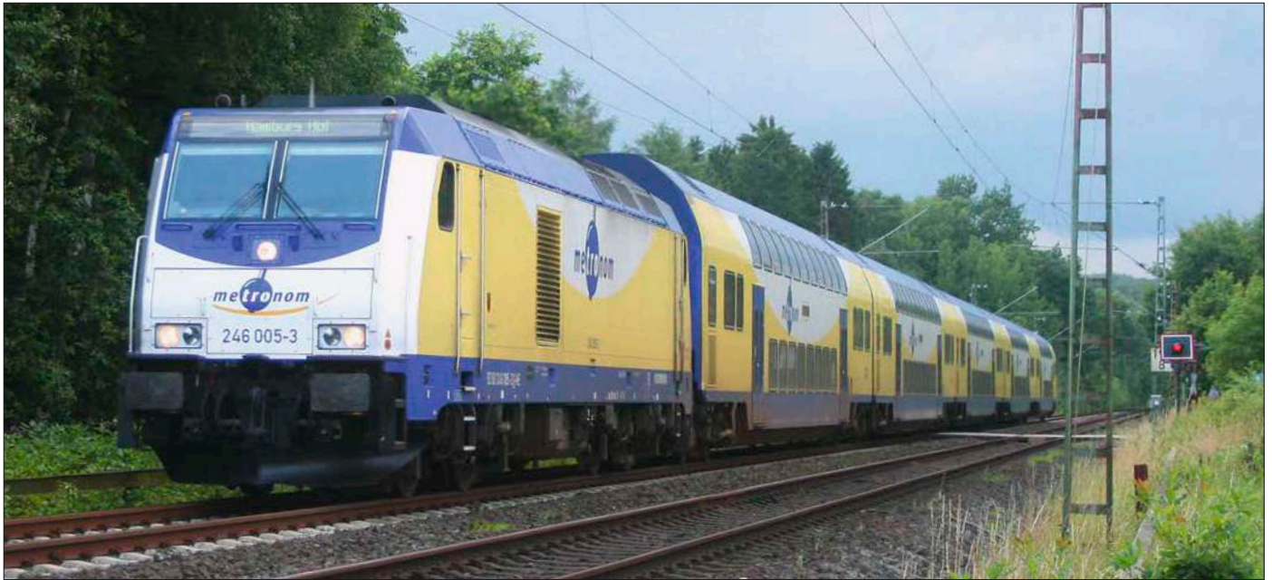
Am 19. Juli 2009 war 246 005 noch als metronom von Cuxhaven nach Hamburg unterwegs. Hinter der dieselelektrischen Lok laufen fünf Doppelstockwagen, die alle einen Tiefeinstieg im Niederflurbereich haben. Der 1.-Klasse-Bereich befindet sich im Obergeschoss des Steuerwagens. Planmäßig liefen die Loks in Richtung Hamburg.
