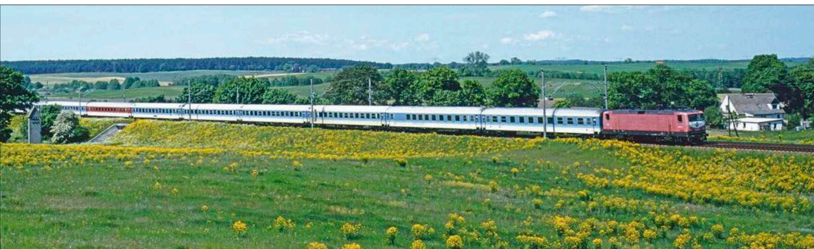
Unten: In der Uckermark wurde dieser IR von Stralsund nach Frankfurt (M) mit 112 104 fotografiert. Hinter dem 1.-Klasse-Wagen (Aim) läuft der typische 1.-Klasse-Bistrowagen (Arkimbz) und dahinter sieben 2.-Klasse-Wagen (Bim/Bimd).
