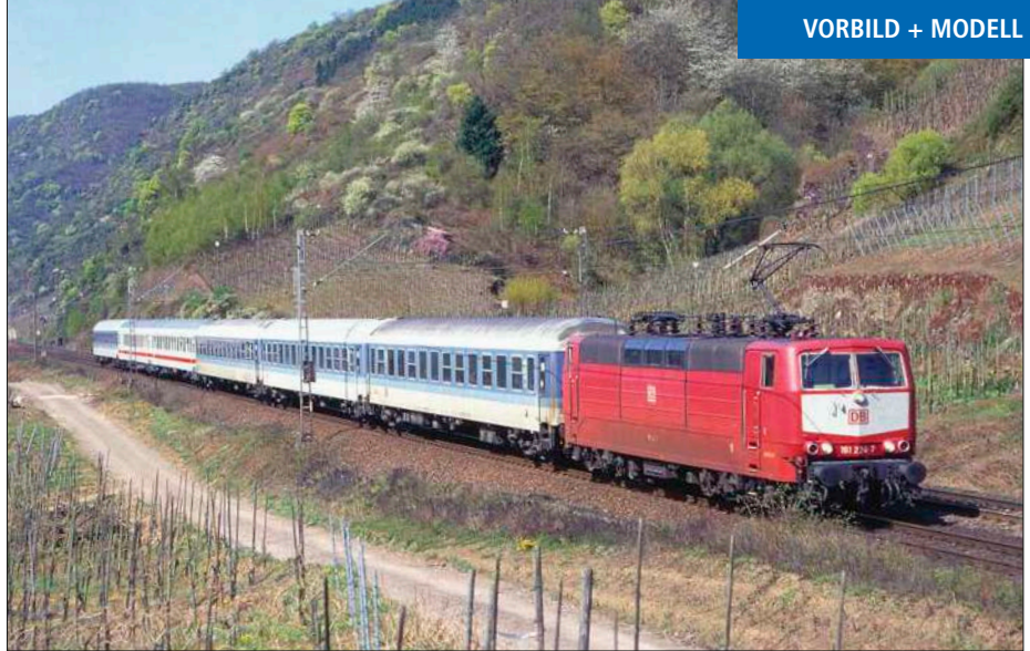
Am 7. April 2002 bespannte 181 224 den IR 2431 von Luxemburg nach Münster (Westf), als sie an der Mosel bei Pommern fotografiert wurde. Der Zug besteht aus vier 2.-Klasse-Wagen (Bim), einem Wagen Arkimbz mit Bistroabteil und einem 1.-Klasse-Wagen Aim. In Koblenz wurde der Zug auf die Baureihe 101 umgespannt und mit zwei weiteren Bim ergänzt.
