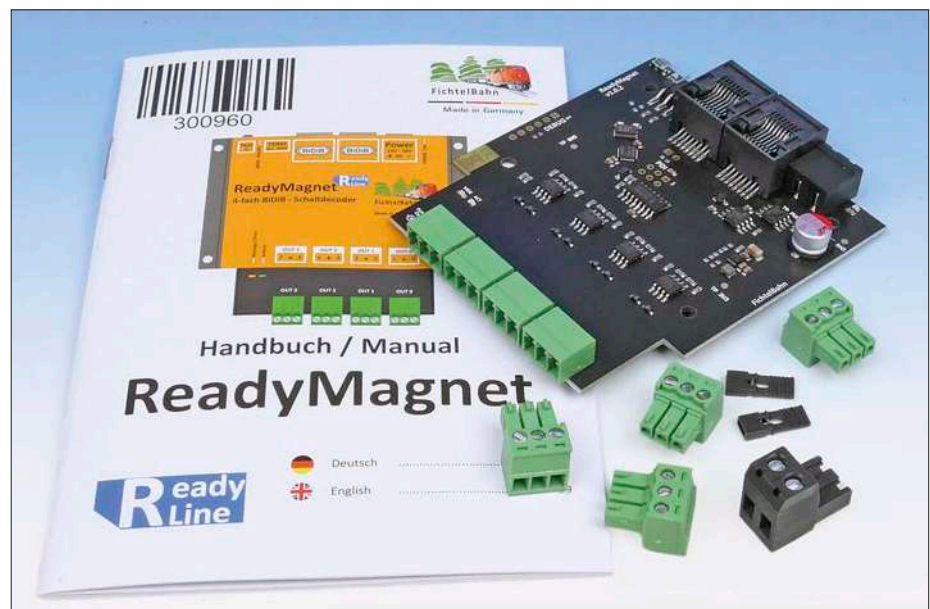
Der ReadyMagnet besitzt über Schraubklemmen Anschlüsse für vier Doppelspulantriebe oder alternativ acht andere Verbraucher. Jeder Ausgang darf dabei mit max. 1,2 A belastet werden.
