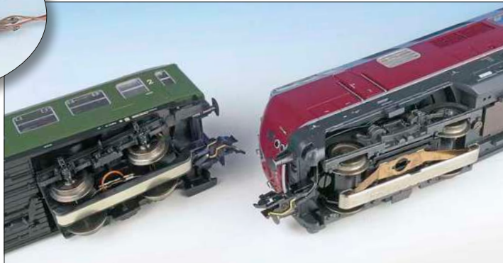
Stromleitende Kupplungen werden von verschiedenen Herstellern und in unterschiedlichen Ausführungen angeboten. In vielen Fällen passen diese in die genormten Kupplungsaufnahmen der Loks und Wagen.
