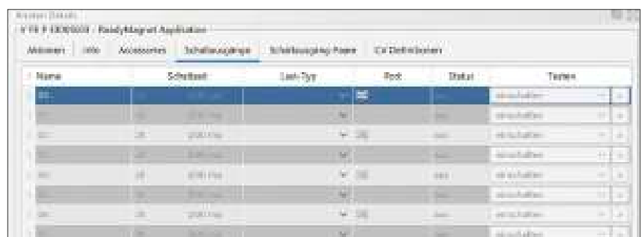
Der BiDiB-Wizard besitzt für die unterschiedlichen Einstellmöglichkeiten mehrere Karteikarten. Für jeden einzelnen Ausgang können hier die individuellen Schaltzeiten definiert werden.
