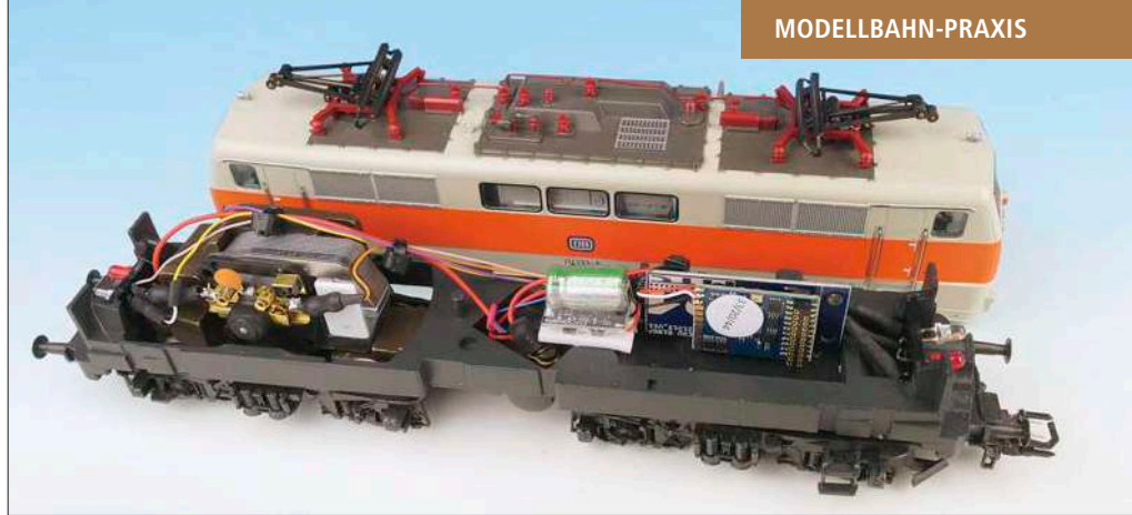
Der PowerPack Mini von ESU bringt es auf schlanke 15,7 x 9,7 x 13 mm. Der Energiespeicher passt damit problemlos in die meisten Lokomotiven der Baugröße H0.
