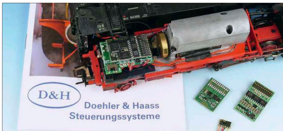
Die Digitaldecoder von Doeblner & Haass werden in zahlreichen Ausführungen mit und ohne Sound angeboten. Alle verfügen über eine hochfrequente Regelung für Glockenanker-Motoren.
