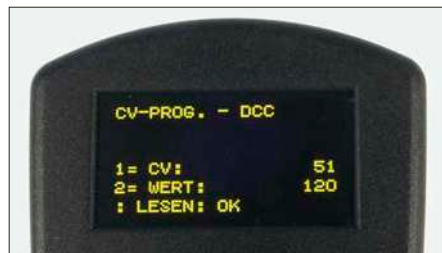
Der proportionale Anteil des PID-Reglers wird über den Wert in CV 51 festgelegt.
