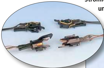
Eine doppelte Stromabnahme und stromleitende Kupplungen können in vielen Fällen die Betriebssicherheit erhöhen.
