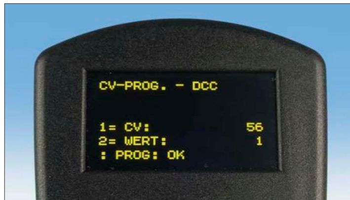
Die Decoder von Appel können im eingebauten Zustand programmiert werden. Dabei wird sowohl die Programmierung auf dem Hauptgleis als auch auf dem Programmiergleis unterstützt.
