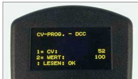
CV 52 zeigt sich für den integralen Anteil der Motorregelung verantwortlich.
