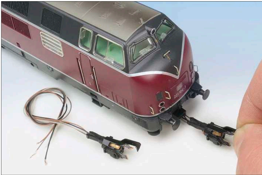
Stromleitende Kupplungen werden von verschiedenen Herstellern und in unterschiedlichen Ausführungen angeboten. In vielen Fällen passen diese in die genormten Kupplungsaufnahmen der Loks und Wagen.
