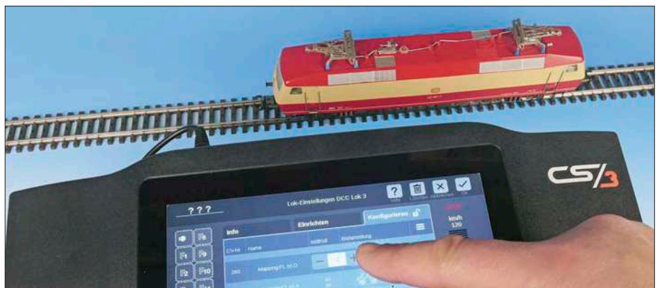
Über die CV-Programmierung kann u.a. festgelegt werden, welche Decoderfunktionen (z.B. Motor, Sound, Licht, AUX) vom Spannungspuffer bei Stromunterbrechungen versorgt werden sollen. Auf diese Weise können sensible Funktionen bei der Spannungspufferung bevorzugt werden.
