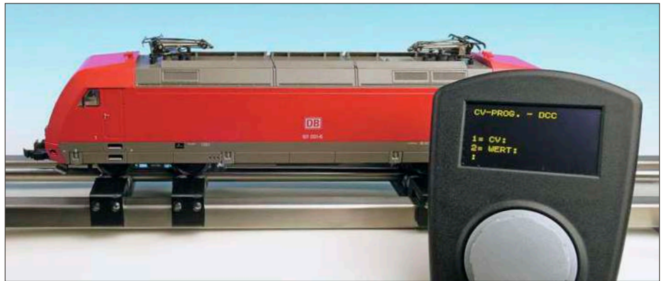
Die Decoder von Appel können im eingebauten Zustand programmiert werden. Dabei wird sowohl die Programmierung auf dem Hauptgleis als auch auf dem Programmiergleis unterstützt.
