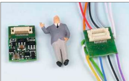
Mit nur 15 x 9,5 mm ist der LD-G-41 mit der Next18-Schnittstelle ein echter Winzling.
