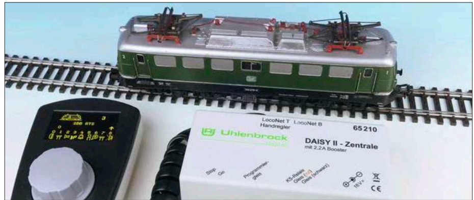
Die CV-Programmierung des Decoders erfolgt über eine Digitalzentrale. Wir nutzen hier bei der umgebauten Märklin-Lok eine Daisy II von Uhlenbrock zur Konfiguration der Motorregelung.
