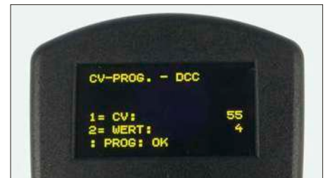
Über CV 55 kann die Regelgeschwindigkeit des PID-Reglers in ms beeinflusst werden.
