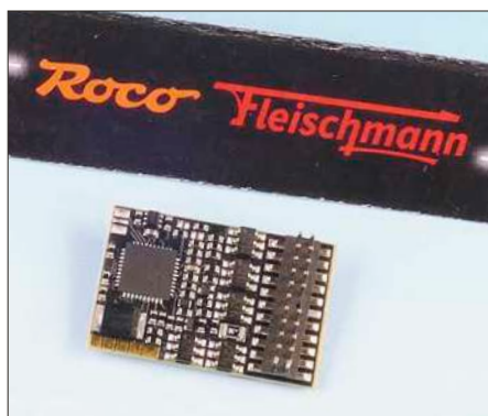
Der Decoder 10896 von Roco ist eigentlich ein Zimo-MX633P22. Der Baustein misst 22 x 15 x 3,5 mm und unterstützt die Datenformate DCC und MM sowie den AC/DC-Analogbetrieb.
