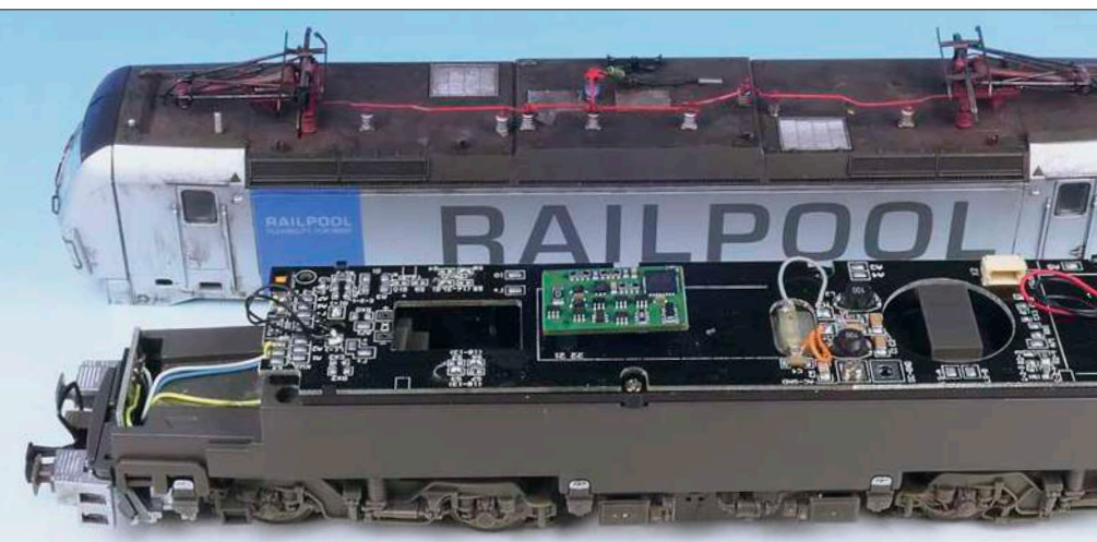
Die BR 193 von Piko bringt von Haus aus bereits eine PluX22-Digitalschnittstelle mit, sodass der Einbau des neuen Lenz-Silver-Plus-Decoders als erfreulich einfach und unkompliziert erwies.
