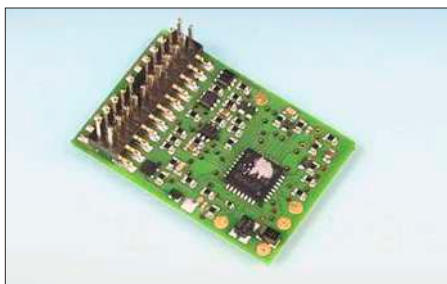
Der IntelliDrive-2-Digitaldecoder, hier das Modell 74570, eignet sich mit einer Taktfrequenz von 18,75 kHz auch für Glockenanker-Motoren.
