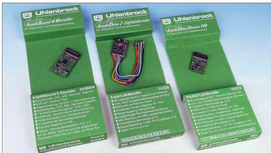
Die aktuellen Digitaldecoder von Uhlenbrock unterstützen je nach Modellvariante neben den Digitalprotokollen DCC, Märklin-Motorola und Selectrix auch das Märklin-Datenformat mfx.
