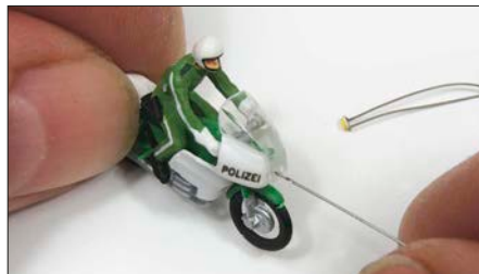
Um die LEDs für das Front- und Rücklicht einsetzen zu können, ist eine Bohrung nötig.
