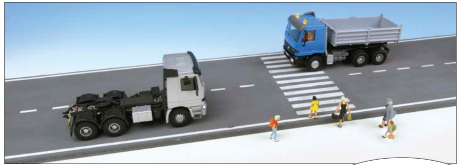
Die Spurführung der CarMotion-Fahrzeuge erfolgt am besten über Magnetbänder, die unsichtbar in die Fahrbahn eingelassen sind.
