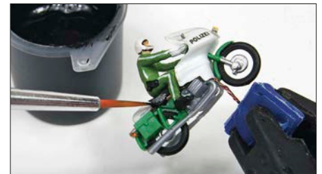
Im letzten Arbeitsschritt werden die Kabel mit Farbe kaschiert und das Modell komplettiert.
