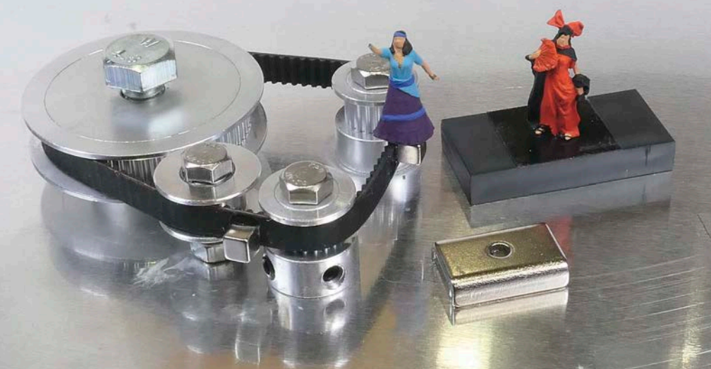
Mit Zahnriemen und den passenden Spann- und Umlenkrollen lassen sich mit wenig Aufwand gundsolide Modellantriebe aufbauen, die auch einen Dauerbetrieb problemlos überstehen.
