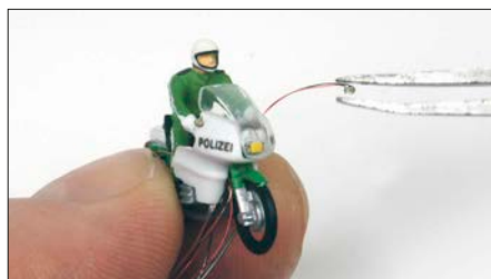
Auch die Blaulichtblitzer bestehen aus SMD-LEDs. Die Kabel dienen dabei als Halterung.
