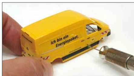
Zur Montage der Seitenleuchten werden 0,5-mm-Löcher in die Karosserie gebohrt.
