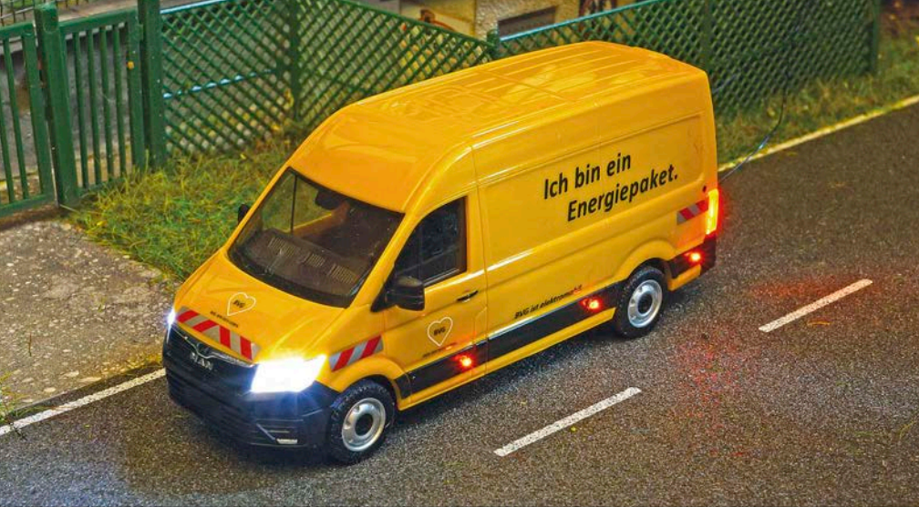
Mit Front- und Rücklicht wird aus dem MAN TGE von Herpa ein interessantes Funktionsmodell. Zusätzlich wurden hier auch die gelben Seitenleuchten des Modells funktionsfähig nachgebildet.
