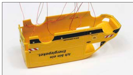
Die SMD-LEDs müssen mit (wenig!) UV- oder Sekundenkleber von außen angeklebt werden.
