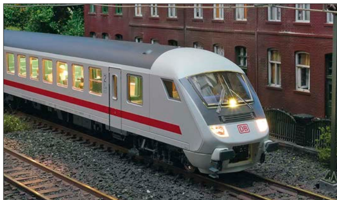
Auch der automatische Lichtwechsel eines Steuerwagens lässt sich über den Funktionsdecoder der Wageninnenbeleuchtung realisieren.
