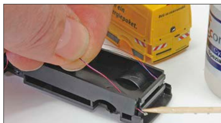
Die Front- und Rücklicht-LEDs mit den Kupferlackdrähten werden im Chassis eingeklebt.
