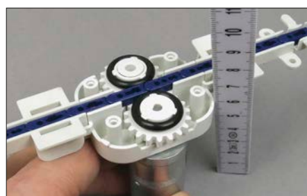
Der Antrieb erfolgt über gummierte Reibräder und benötigt an dieser Stelle 60 mm Freiraum.
