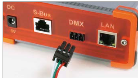
Über den DMX-Anschluss kommuniziert die PC-Software mit der Hardware des Raumlichts.
