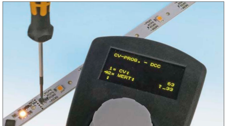
Die Waggoninnenbeleuchtungen von Viessmann sind mit elf LEDs bestückt und in den Lichtfarben Weiß, Warmweiß und Gelb erhältlich.
