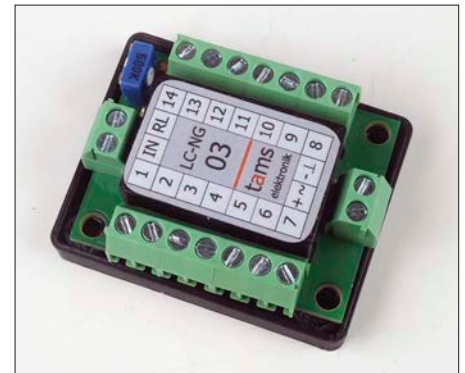
Die Tams-LC-NG-Module, hier ein LC-NG-03, bringen bis zu 14 einzelne Lichtausgänge mit.
