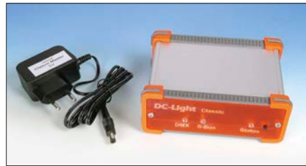
Bei der DC-Light-Lichtsteuerung ist der Classic-Master Bindeglied zwischen Bahn und PC.
