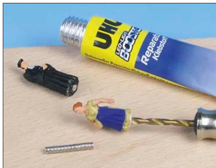
Die zu bewegenden Figuren und Elemente erhalten Magneten. Die kleinsten Magneten im Fachhandel sind gerade einmal 1 x 1 mm groß.
