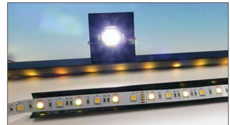
Die zuckenden Gewitterblitze werden über helle Chip-LEDs synchron zum Donner erzeugt.
