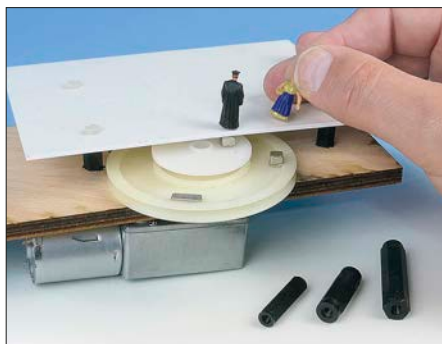
Der Abstand zwischen den Magneten muss durch Probieren gefunden werden. Anziehende und abstoßende Wirkungen sind möglich.
