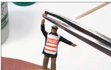
Die winzige SMD-LED wird mit Sekundenkleber (oder UV-Kleber) auf die Kelle geklebt. Beim Kleberauftrag hilft ein Zahnstocher.
