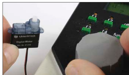
Der Digital-Motor besitzt keine Endanschläge und wird direkt über die Zentrale bedient.
