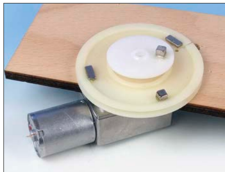
Montiert auf einer Grundplatte aus Holz oder Alu können z.B. auf direktem Wege mit Magneten bestückte Elemente angetrieben werden.
