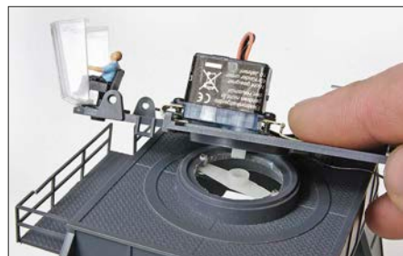
Ohne Endanschläge eignet sich der Digital-Motor u.a. auch als Antrieb für Drehkräne.
