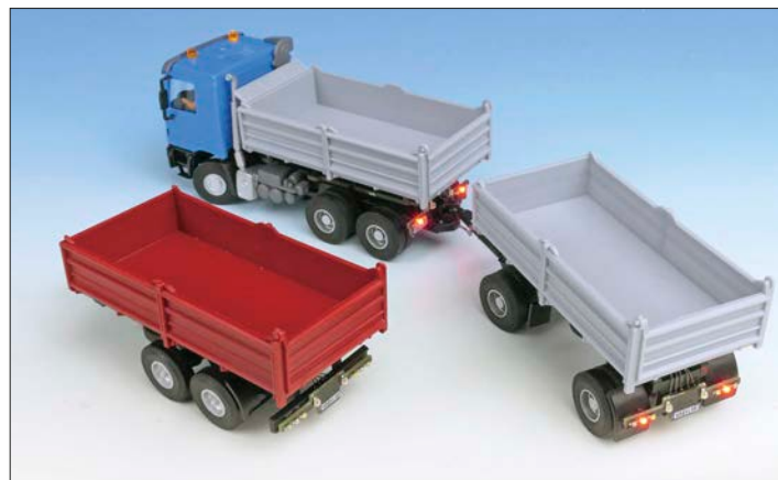
Auch die separat lieferbaren Anhänger des CarMotion-Systems sind mit einer vorbildgetreuen Beleuchtung und Infrarot-Sendedioden für die automatische Abstandssteuerung ausgerüstet.
