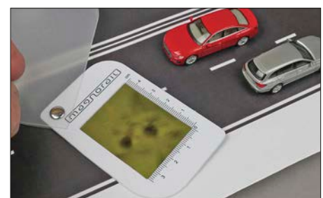
Eine spezielle Positionierhilfe macht die Magneten unter der Fahrbahnoberfläche sichtbar.
