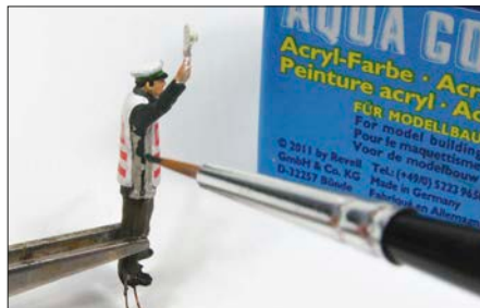
Nachdem der Silberleitlack vollständig getrocknet ist, kann er mit Acrylfarbe überpinselt werden und ist damit unsichtbar.
