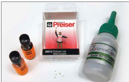
Neben einer geeigneten Figur von Preiser o.Ä. werden für den Umbau eine SMD-LED sowie Silberleitlack und Sekundenkleber benötigt.
