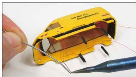
Die LEDs werden gemäß Schaltplan in Reihe geschaltet und anschließend verlötet.
