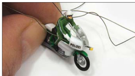
Die LEDs für Front- und Rücklicht werden am besten mit UV-Kleber in den Bohrungen fixiert.
