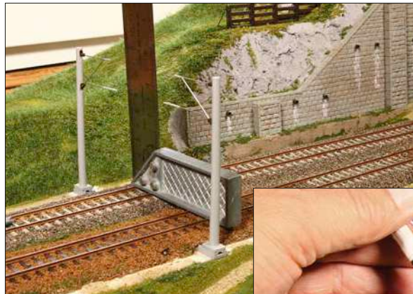
Da die Fahrleitung bei dem rechts abgebildeten Streckenstück im Bogen liegt, müssen die Fahrdrähte individuell auf Länge gebracht werden. Dazu markiert man die Position der Stützpunkte mit einem dünnen wasserfesten Stift am Fahrdraht.
