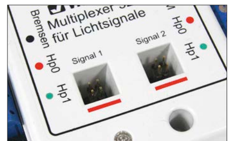
Der Doppel-Multiplexer ermöglicht den Anschluss von zwei separaten Hauptsignalen.
