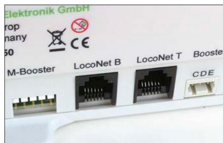
Digitalkomponenten mit LocoNet- oder L-Net-Anschluss sind an der RJ12-Buchse erkennbar.
