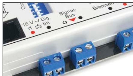
Nur der einfache Multiplexer besitzt eine Anschlussklemme für den Viessmann-Signalbus.
