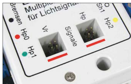
Am Multiplexer 5229 kann ein Hauptsignal mit zugehörigem Vorsignal angeschlossen werden.
