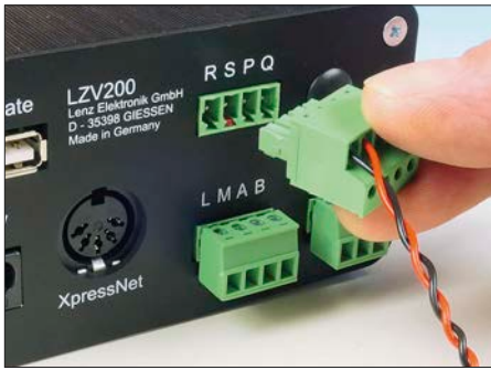
Den 2-adrigen RS-Bus finden wir z.B. an der Digitalzentrale LZV 200 von Lenz Elektronik.
