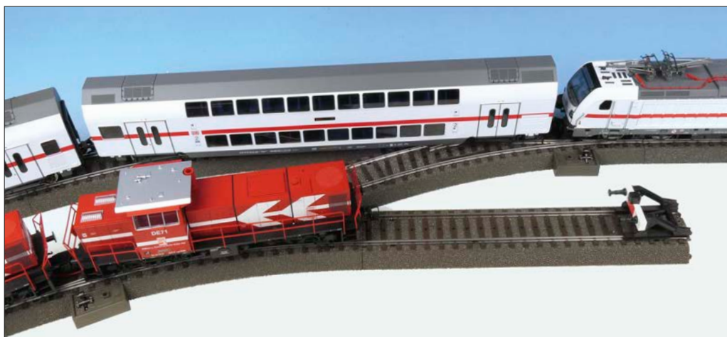
Wenn die Schutzweiche mit in die Fahrstraßensteuerung eingebunden ist, können gefährliche Flankenfahrten sicher vermieden werden. Innerhalb derartig gesicherter Bereiche darf dann auch rangiert werden, während die eigentliche Fahrstrecke von anderen Zügen genutzt wird.
