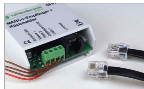
Als Verbindungskabel kommen beim LocoNet-Bus schmale RJ12-Westernstecker zum Einsatz.
