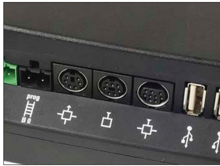
Einige Digitalzentralen besitzen für hauseigene Bausteine ein eigenes CAN-Bus-System.
