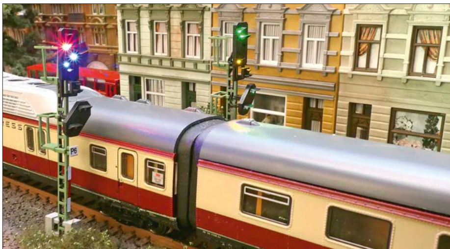
Für Modellbahnen ab der Epoche IV eignen sich besonders die Lichtsignale der Bauart 1969. Lediglich vier Kabel werden benötigt, um bis zu zwölf LEDs mit der Multiplextechnik anzusteuern.
