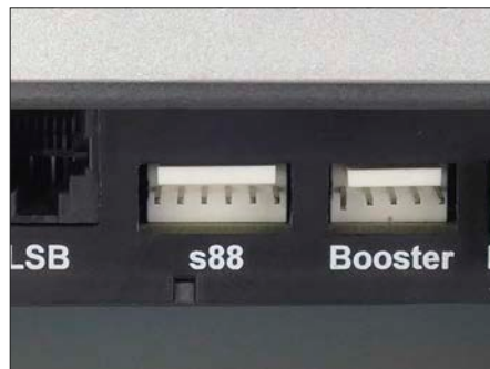
Der s88-Standard ist nach wie vor sehr verbreitet und an vielen Digitalgeräten zu finden.
