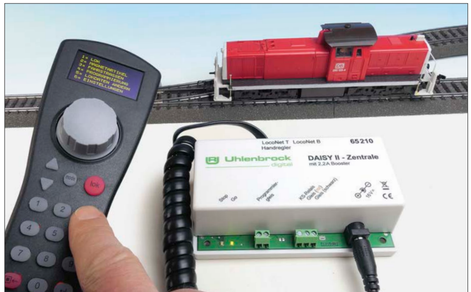
Die DAISY II von Uhlenbrock bringt einen eigenen Fahrstraßenmodus mit. Die einzelnen Fahrstraßen lassen sich dabei in Achterblöcken über die Zifferntasten 1 bis 8 des Handreglers auslösen.
