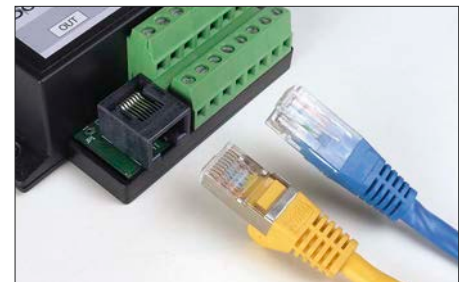
Bei den Geräten mit s88-N-Schnittstelle kommen geschirmte Netzwerkkabel zum Einsatz.
