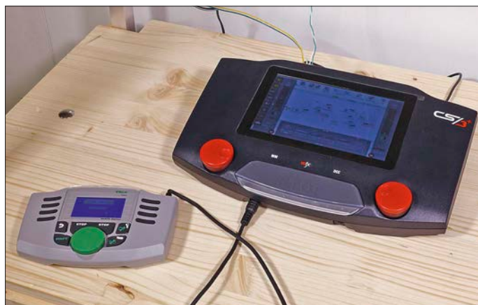
Die Steuerung und Stromversorgung des Arrangements übernimmt eine CS 3. Endgeräte wie die Mobile Station werden vorne angeschlossen.
