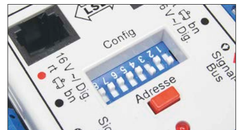
Die Blockstreckenlogik kann an den blauen DIP-Schaltern ein- und ausgeschaltet werden.
