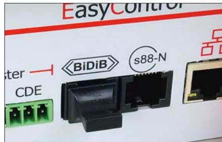
Die Weiterentwicklung der bekannten s88-Schnittstelle wird als s88-N bezeichnet.
