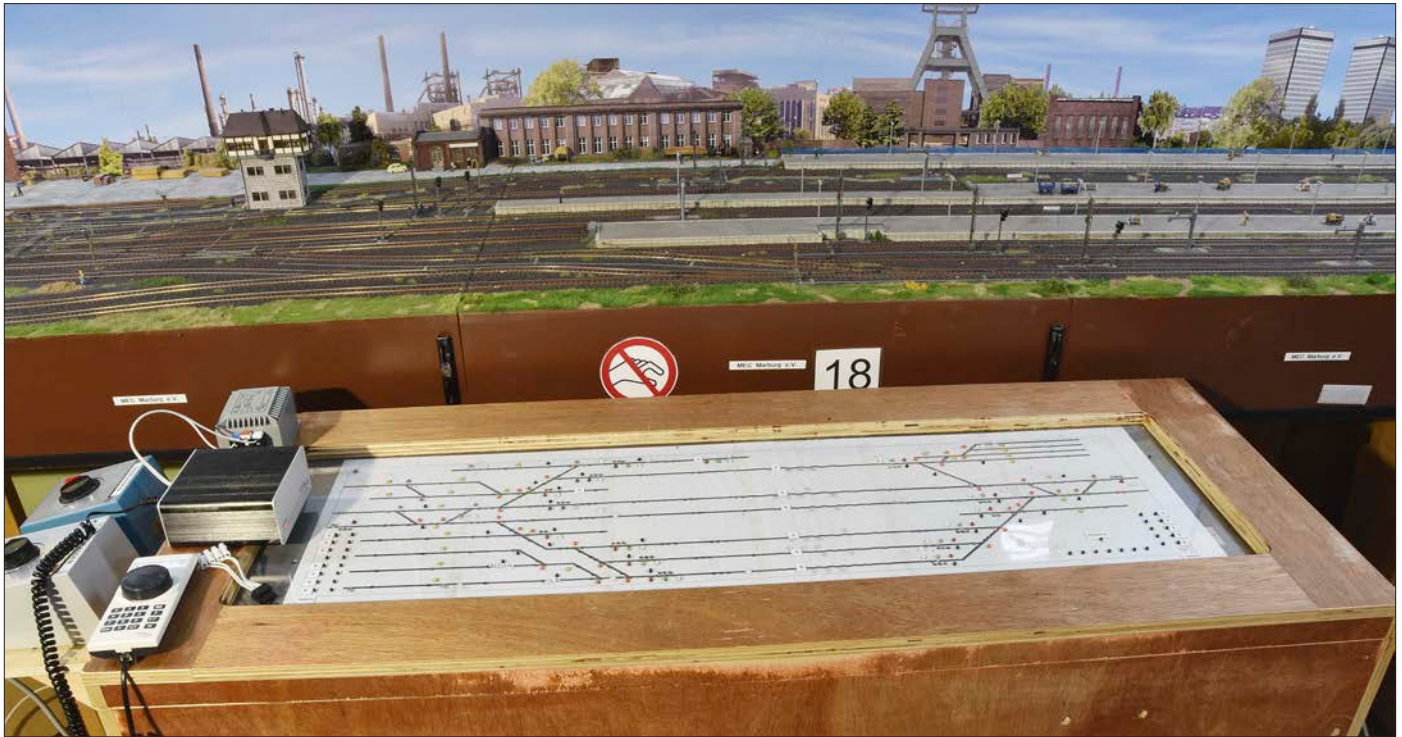
Dem in die Jahre gekommenen Gleisbildstellpult mangelte es an Funktionssicherheit. Es sollte durch eine flexible, softwaregestützte Variante ersetzt werden. Foto: Uwe Bohländer
