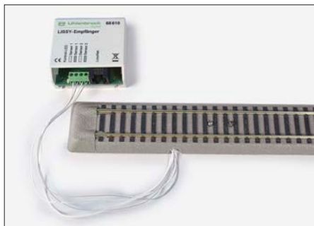
Mit zwei LISSY-Sensoren direkt nebeneinander lässt sich die Fahrtrichtung der Lok zweifelsfrei bestimmen.
