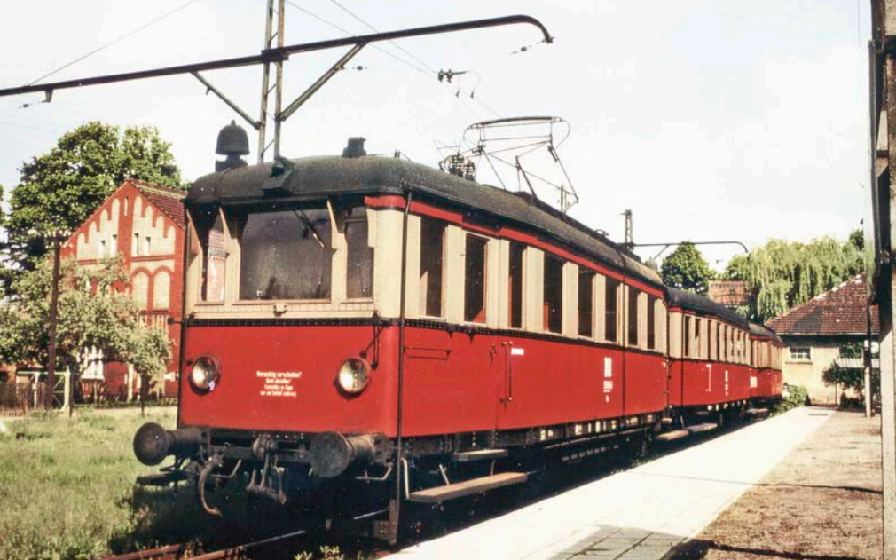
Bis 1980 versahen die Triebwagen von 1930 ihren Dienst. Die Beiwagen konnten in Ermangelung eines Steuerabteils nur zwischen zwei Triebwagen laufen. Ab 1982 kamen moderne Fahrzeuge mit geschweißten Wagenkästen zum Einsatz. Die Garnituren waren nun als Wendezug nutzbar.
