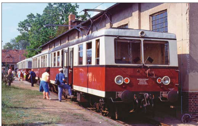
Bis 1980 versahen die Triebwagen von 1930 ihren Dienst. Die Beiwagen konnten in Ermangelung eines Steuerabteils nur zwischen zwei Triebwagen laufen. Ab 1982 kamen moderne Fahrzeuge mit geschweißten Wagenkästen zum Einsatz. Die Garnituren waren nun als Wendezug nutzbar.
