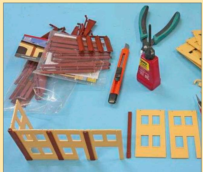
Die Bauteile lassen sich nach dem Versäubern der Angusstellen mit jedem herkömmlichen PLastikkleber zusammenfügen.
