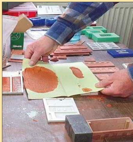
Die Abgussmasse sollte nach dem angege-benen Mischungsverhältnis angesetzt und dann zügig ausgegossen werden. Dabei kann ein Stab als Gießhilfe benutzt wer-den.
