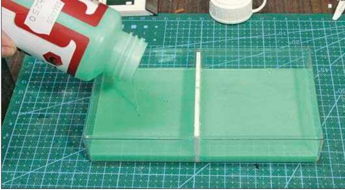
Mit der exakt nach dem Mischungsverhältnis angerührten Silikonmasse werden die Teile übergossen und eventuelle Luftblasen durch kleine Erschütterungen der Gießbox gelöst.
