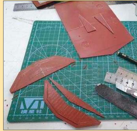
Links: Die zunächst farblich unterschiedlichen Gefache der Sioux-Schuhfabrik erhalten einen Ziegelsteinhintergrund im gleichen Aussehen.
