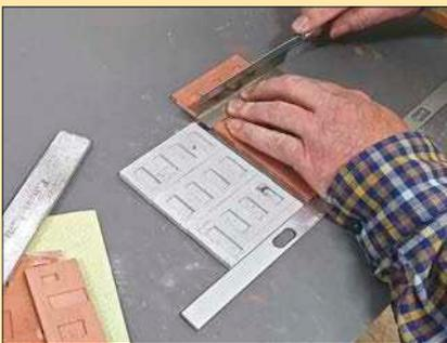
Links: Mit den bei Vampisol erhältlichen Sägen und Feilen lassen sich die Abgussteile in der Größe anpassen. Dabei entstehen saubere Schnittkanten.
