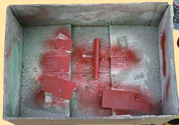
Oben: Das Resin ist stark rückfettend – mehr noch als Polystyrol. Daher muss es vor dem Lackieren gut entfettet werden. Hier kommen wieder die üblichen Verdächtigen zum Einsatz, in diesem Fall Fettlöser aus dem Haushalt. Es ist auch angeraten, die Bauteile anschließend mit Haushaltspapier abzutupfen, um alle Rückstände sicher zu entfernen und den Arbeitsfortschritt zu beschleunigen.
