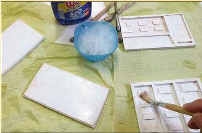
Die Formen sind vor der Verwendung erst einmal ausgiebig zu reinigen. Mit einem harten Pinsel und ein wenig Spülmittel-lösung bürstet man die Gummiteile zu-nächst gründlich ab.
