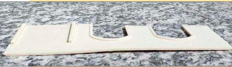
Resinteile haben den Nachteil, dass sich das Material nach dem Entfernen aus der Form leicht verziehen kann – so ist diese Wand stark durchgebogen.
