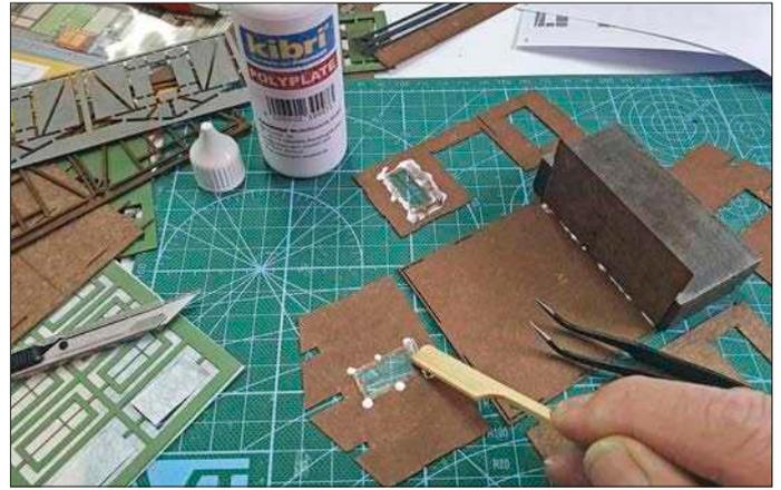
Beim Bausatz der kleinen Werkstatt von Vollmer lassen sich die selbstklebenden Fensterrahmen ohne Kleberflecken auf der durchsichtigen Glasfolie aufreiben. Die Fenstereinsätze passen exakt in die vorgesehenen Öffnungen und werden von hinten noch mit etwas Leim fixiert.
