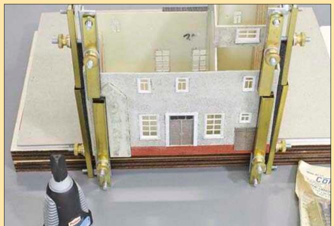
Mit den schon genannten Winkelhaltern von Coffman kann man das Zusammenfügen exakter machen, indem die Teile passgenau aneinandergehalten werden. Dann würde flüssiger Sekundenkleber (von innen) gute Dienste leisten.
