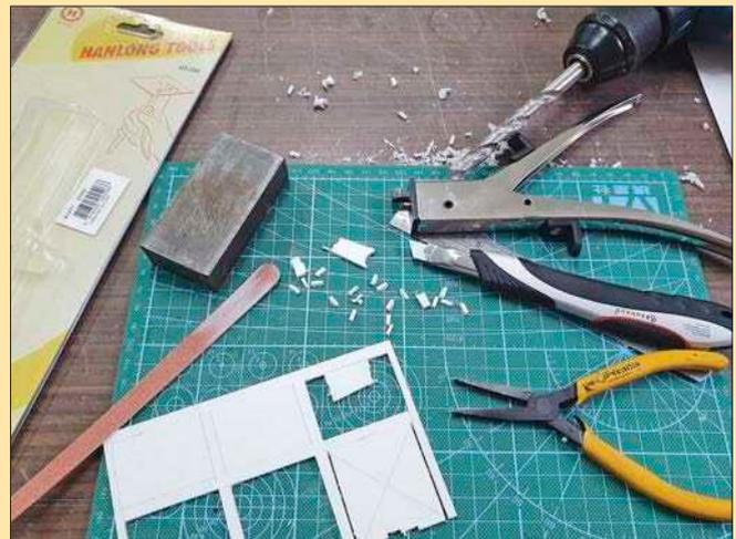
Beim Gebäudekorpus entstehen die Fensterbereiche aus schmalen Streifen, die die lichte Fensterhöhe aufweisen. Auf gleichmäßigen Abstand geklebt, bleiben die Fensteröffnungen frei.
