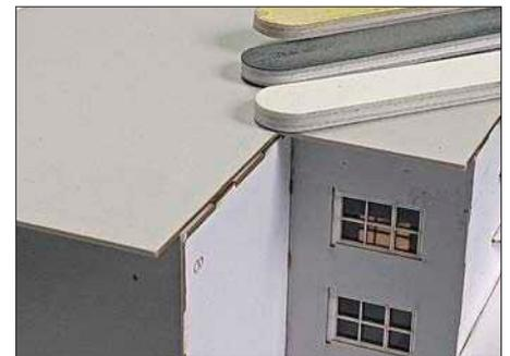
An den stumpf aneinanderstoßenden Bauteilen fallen oft die dunklen Schnittkanten auf – was den Gesamteindruck unangenehm stört. Um dem entgegenzuwirken, sollten die gelaserten Kanten des durchgefärbten Kartons vorsichtig abgeschliffen werden. So lassen sich die dunklen Schmauchspuren beseitigen.
