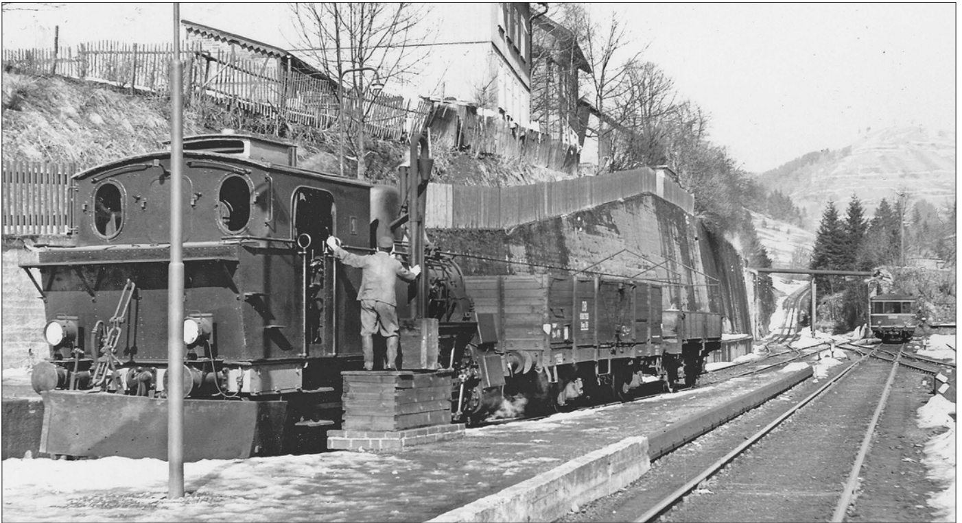
Willkommen in den 50ern: Oben eine der beiden baugleichen Lokomotiven der Zahnradbahn beim Wassernehmen am Bahnsteig der Kleinbahn am 11.3.1954; im Hintergrund auf dem Gleis der Kopf-/Seitenrampe der Goslarer VT 70. Foto: Peter Böhm, Sammlung SR
