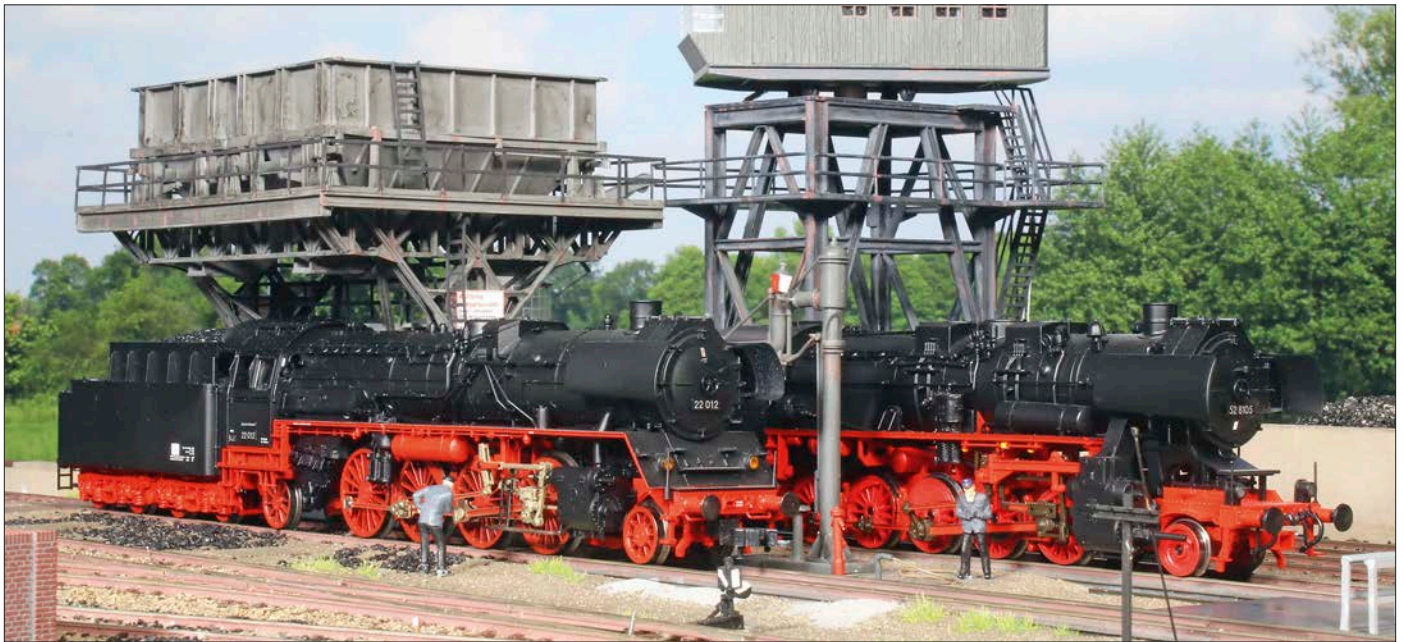
Um die Nutzungszeit von Dampfloks zu verlängern, unterzog die DR ab Ende der 1950er-Jahre viele Dampfloksbaureihen einer sogenannten Rekonstruktion. Die Fahrwerke wurden überarbeitet und neue Kessel mit Mischvorwärmer verbaut. Diese Kessel waren abgestimmt auf Braunkohlenfeuerung. Im Vordergrund eine 22 (Fleischmann), die aus der Baureihe 39 entstand, im Hintergrund eine Reko-52 (Güztold).
