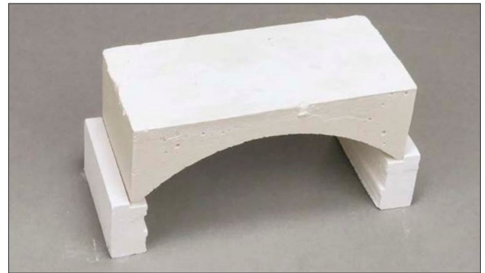
Auf dem Brückenunterbau ruht das Gewölbe der Innendecke. Auf eine spezielle Unterkonstruktion kann beim Brückenbau verzichtet werden.
