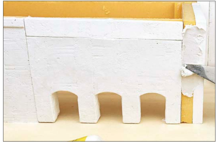
Der Übergang zwischen Pfeiler und Seitenwand wird hier der Einfachheit halber verspachtelt. Bei Betonoberflächen gelingt das problemlos.
