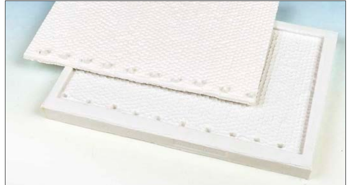
Die aufgestellten Begrenzungssteine der zweiten Rampendecke bleiben beim Abgießen mit Modellgips sehr gerne in der Silikonform hängen.
