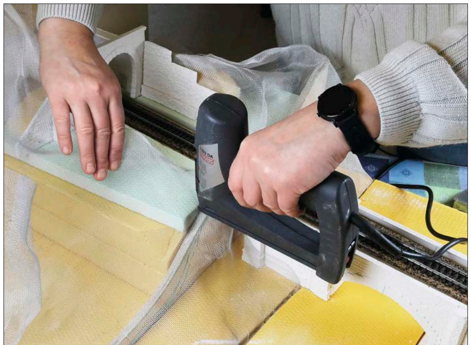
Das Aluminiumgewebe wird direkt mit Spanten und Gleistrassen verbunden. Das gelingt besonders einfach in Verbindung mit einem Elektrotacker. Zur Not geht es auch mit einem Handgerät.
