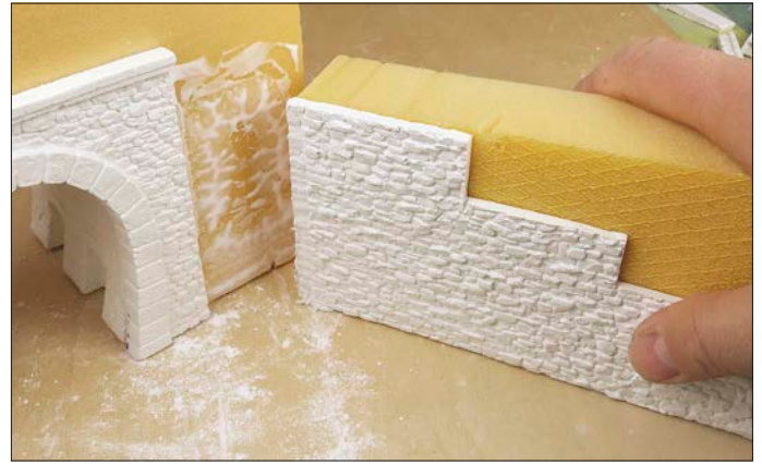
Die Flügelmauer entstand aus der Silikonform 6049. Die Abstufung wurde mit der Laubsäge in das Mauersegment gesägt.
