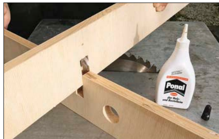
Über Kammschlitze werden die einzelnen Rahmenhölzer verzugsfrei miteinander verleimt.
