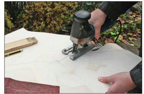
Die Spanten werden mit der Stichsäge ausgesägt und geben die Form der Landschaft vor.
