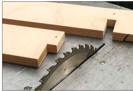
Der Rahmen der Modellbahnanlage wird aus 19 mm dicker Tischlerplatte gefertigt.
