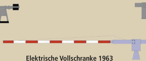
Elektrische Vollschanke 1963 Typ WSSB eVs 63 Verwendet bis ca. 1990
