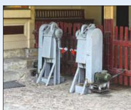
In Mulda (Sachsen) werden vier Schrankenbäume vom Empfangsgebäude aus bedient (Bild oben).
