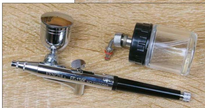
Bei Double-Action Pistolen wird die Luftzufuhr durch Drücken des Bedienehebels gestartet; die Farbmenge kann danach durch das Zurückziehen individuell geregelt werden.
