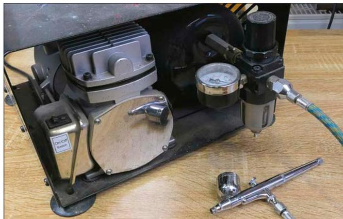
Single-Action-Pistolen sind besonders leicht zu handhaben. Die Farbmenge wird hier fest eingestellt und kann während des Arbeitsgangs nicht mehr verändert werden.
