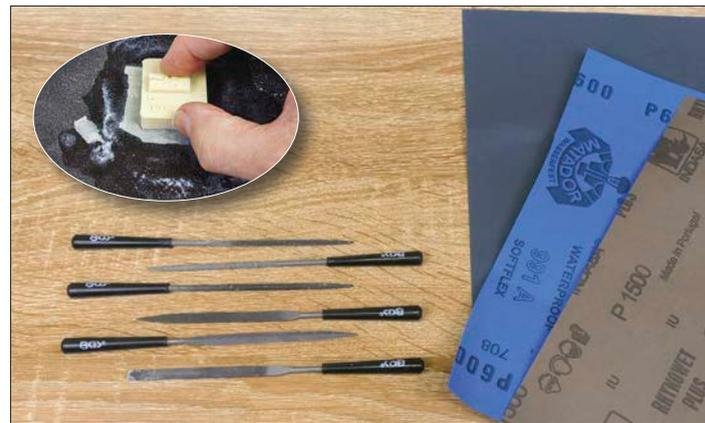
Ein kleines Set mit Feilen und einige Bögen Schleifpapier in verschiedenen Körnungen sollten ebenfalls immer zur Hand sein. Beim Schleifpapier sollte eine wasserfeste Ausführung bevorzugt werden – damit lassen sich auch sehr gut Resinteile im Nassschliff bearbeiten.
