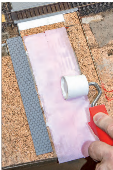
Mit einer kleinen Tapetenandruckrolle werden beide Keilstreifen in den Schnellkleber gedrückt.
