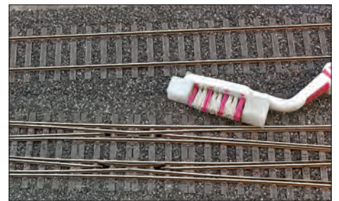
Eine Zahnbürste mit Gleitklötzchen und passender Höhe befreit die Kleiseisen vom Schotter.
