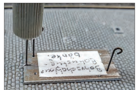
Eine Bohrschablone sorgt für die exakte Position der Stecklöcher bei der Doppelsitzbank.
