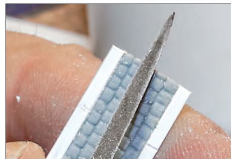
Auch die Streifen zwischen den Gleisen erhalten mit einer Dreikantfeile ihre fehlenden Fugen.
