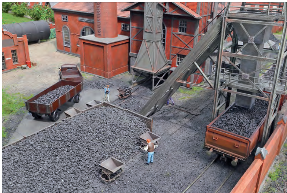
Mithilfe des Fördergerüsts können Güterwagen der Bahn sehr schnell mit Koks beladen werden.
