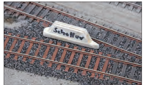
Mit der Form eines kleinen Schiffchens kommt man durch dessen Spitze an jede Weiche heran.
