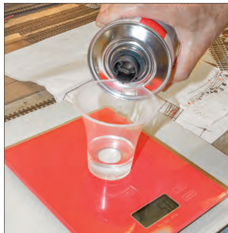
Das Zweikomponenten-Gießharz von Voss Chemie wird exakt mit der Waage abgewogen und gemischt.
