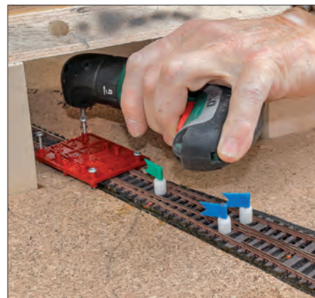
Mit einem Winkelschrauber kommt man zum Fixieren der Bohrschablone auch unter Brücken.
