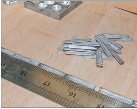
Aus dem Weinert-Sortiment stammen die aus Weißmetall gegossenen Bahnsteigkanten.
