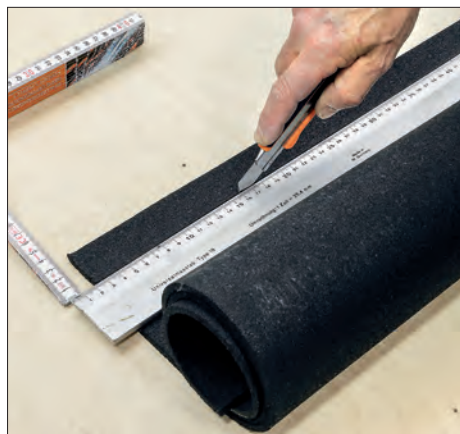
Schallschluckendes Regenerat-Gummi von Weinert als Gleisbett wird in Streifen geschnitten.
