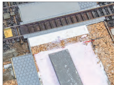
Den Übergang zwischen Straßenwölbung und Bahngleis muss man mit einer Feile angleichen.
