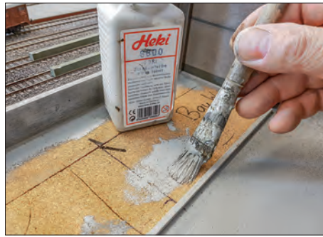
Die Betonfarbe von Heki wird direkt auf den Korkboden und auf die Holzleisten gepinselt.
