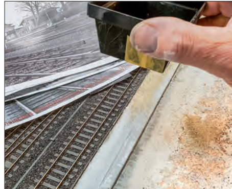
Auf den aufgespritzten Weißleim wird mithilfe eines Siebs gleichmäßig Sand gestreut.
