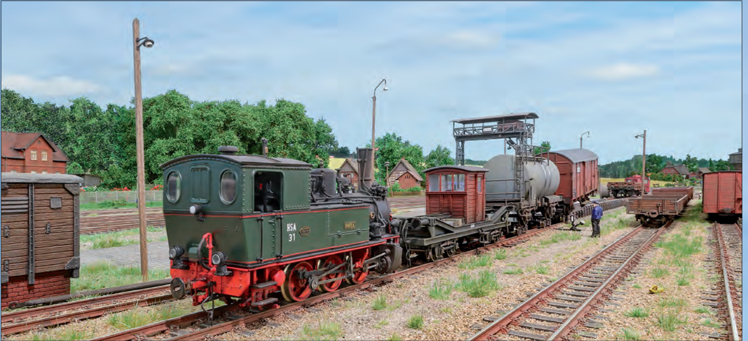
Betrieblicher Mittelpunkt bei der Schmalspurbahn HSA ist die Rollbockanlage zum Umsetzen von Regelspur-Güterwagen auf das ein Meter breite Schmalspurgleis. Hier kommen alle Weinert-Schmalspurmodelle der Kleinbahn um 1960 zum Einsatz, auch der kurios aussehende vierachsige Pufferwagen.
