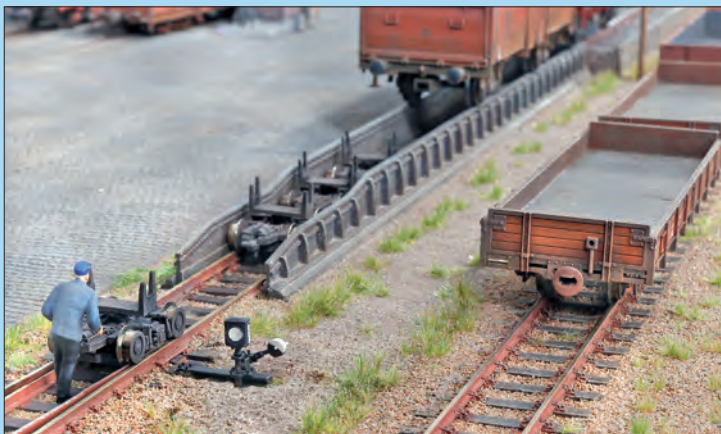
Im Gelände der Freiladegleise befindet sich auch eine Rollbockanlage zum Umsetzen der DB-Regelspurwagen auf die Rollböcke der Schmalspurbahn.
