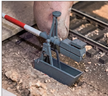
Der Schranken senkkasten lässt sich im exakt geschnittenen Loch passgenau einfügen.
