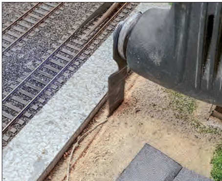
Der Bahnsteig ist zum Schutz abgedeckt, da mit einer Tauchsäge eine Nut für Büsche entsteht.
