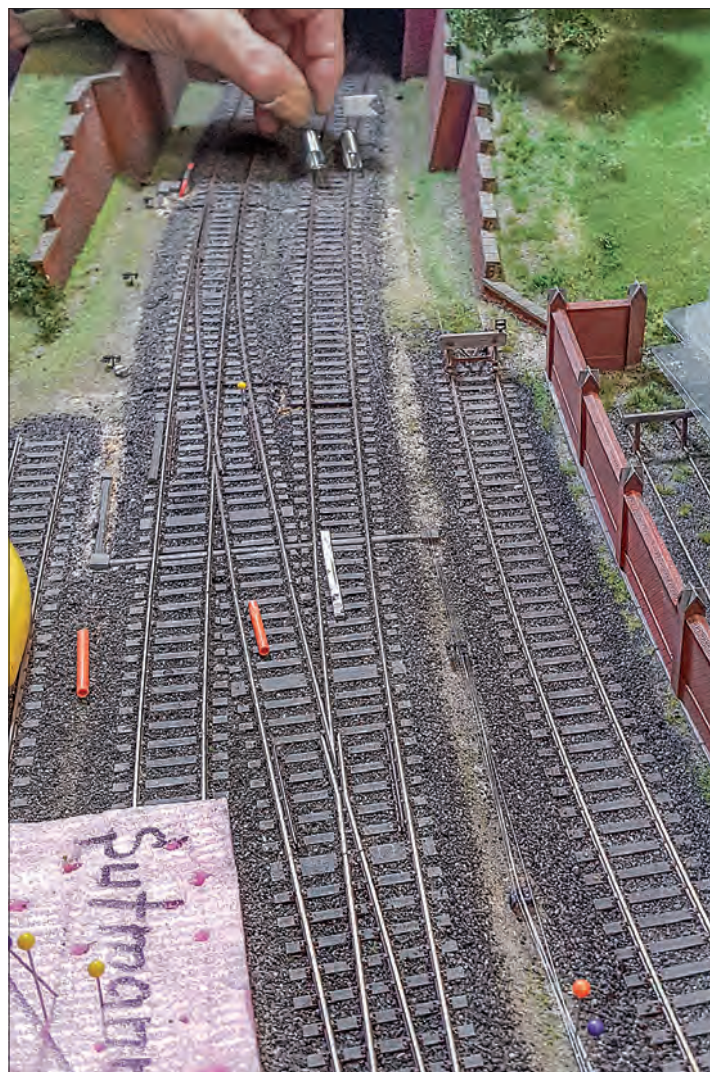
An einem Endpunkt fest fixiert wird der Draht mittels Feder am anderen Ende auf Spannung gebracht, um so einen strammen Draht zu erhalten
