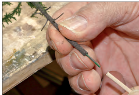
Das Bohrloch im Holzstab muss so groß sein, dass der Draht des MBR-Baums hineinpasst.
