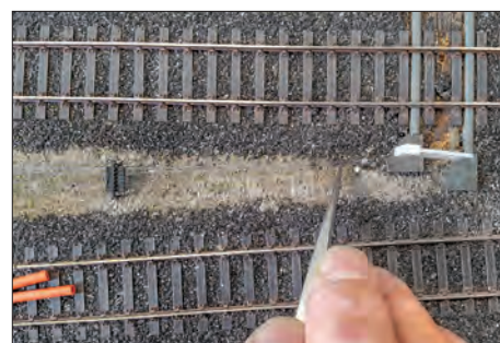
Für jedes Drahtpaar dient ein kleiner Nagel als Endpunkt, damit der Drahtabstand gleichbleibt.
