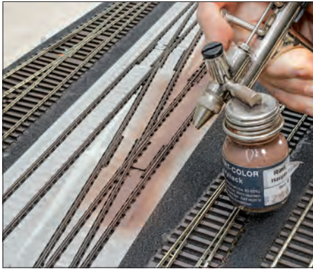
Sind alle Gleise verlegt, werden die Schwellen mit Kreppband vor dem Lackauftrag abgedeckt.
