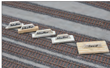
Für das Glätten von Sand- und Schotterflächen hat man sich Andrückhilfen aus Holz gebastelt.
