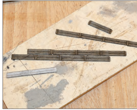
Nebeneinander geklebt und bemalt ergeben die Weißmetallteile eine Holzbohlenkante.
