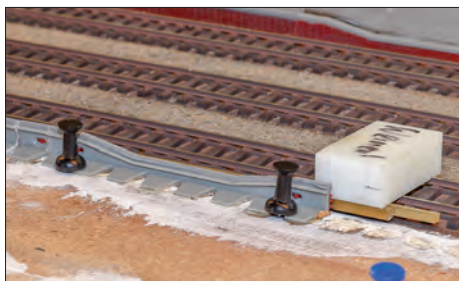
Für den exakten Klebeabstand zum Gleis sorgt wieder eine Lehre und zusätzlich Messingprofile.
