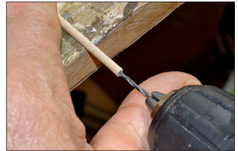
Zu deren Baumstammverlängerung wird in einen Schaschlikstab ein tiefes 1,5-mm-Loch gebohrt.
