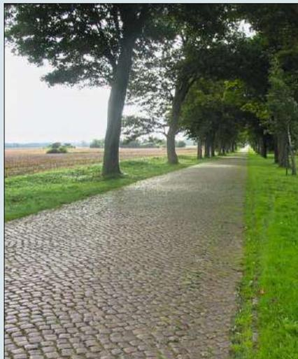
Links: Eine Allee mit Kopfsteinpflaster, wie man sie in Norddeutschland oft findet. Gut zu erkennen ist die leicht gewölbte Fahrbahndecke.
