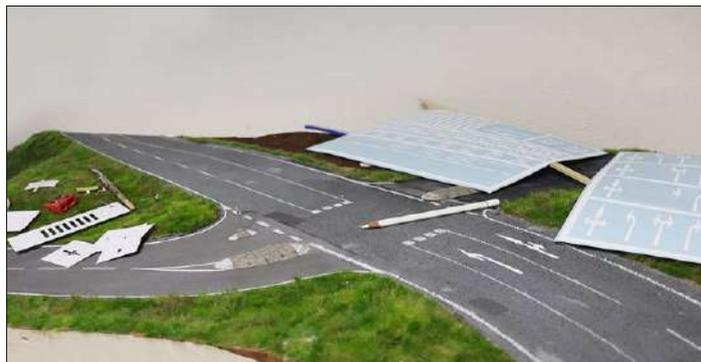
Die Kreuzung wurde mit verschiedenen Belägen gestaltet, um die diverse Zustände der Erneuerung und Ausbesserung darzustellen. Ebenfalls kamen unterschiedliche Markierungstypen zum Einsatz.
