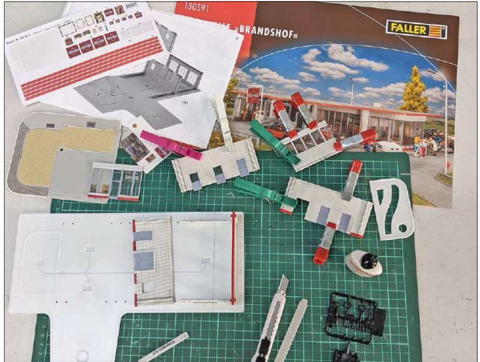
Die Faller-Tankstelle kommt im passenden Design nach Originalvorbild aus Hamburg. Auch viel Zubehör ist mit dabei. Beim Bau sollte mit kleinen Klemmen gearbeitet werden, um alle Bauteile gut zu fixieren.
