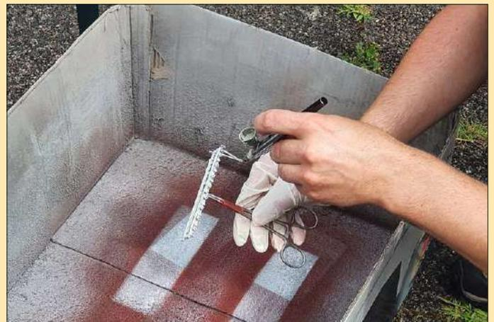
Nach dem Verdünnen werden die Weinert-Farben mit der Spritzpistole in zwei Schichten auf die grundierten Modelle gesprüht. Auch die Felgen sollten in der Wagenfarbe lackiert werden. Die Räder werden anschließend mattschwarz bemalt. Zum besseren Halt während des Sprühens sind die Felgen auf Klebeband befestigt. Tipp: Solche Kleinteile lassen sich auch gut auf Zahnstocher spießen und zum Trocknen in Styroporblöcke stecken.
