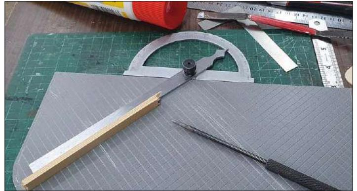
Gehwege mit diagonal verlegten Platten lassen sich in eine PVC-Platte gravieren. Ausrutscher kann man mit Spachtel reparieren, danach wird einfach noch einmal nachgraviert und das Ganze übermalt.
