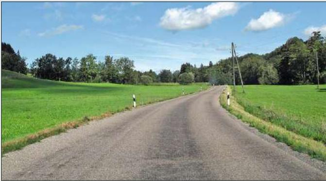
Die einfachste Form einer Landstraße: Abgefahrene helle Spuren, keine Markierungen (Einzelfahstreifen unter 2,75 m – daher nur mittlere Breite), Leitpfosten – also fast zeitlos und sozusagen ideal für die Nachbildung im Modell.
