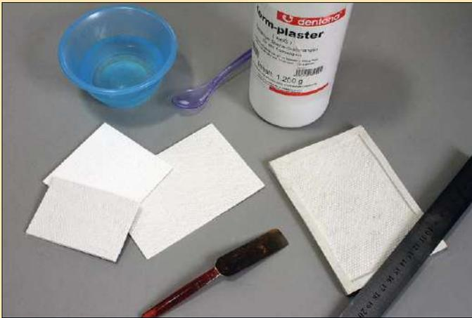
Die Gestaltung gepflasterter Straßen ist auch mit Gipsabgüssen aus Spörle-Gussformen möglich. Eine große Variantenvielfalt bieten Straßen mit gewölbter Fahrbahn als gerade Elemente und Kurvenabschnitte oder auch flache Fahrbahnen für Plätze und Rampen. Man gießt die Formen am besten mit einem Spezialgips aus, zieht die Oberfläche plan ab und lässt das Ganze gut aushärten. Gießmassen aus keramischem Abgusspulver härten dabei besser aus und zeigen weniger Lufteinschlüsse und damit Blasenlöcher.
