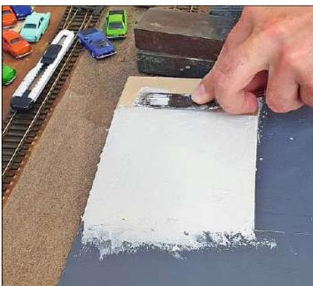
Die Rampe braucht eine gewisse Länge, damit die Auffahrwinkel nicht zu steil werden. 15 cm sollten nicht unterschritten werden. Der Unterbau aus Styrodur wird mit einer Deckschicht Gips überzogen, geschliffen und asphaltgrau angemalt.
