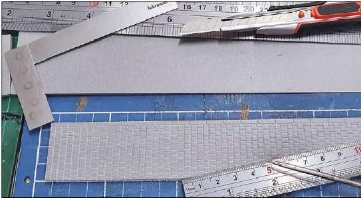
Die Plattenreihen bei Bürgersteigen liegen in der Regel quer zum Straßenverlauf, die einzelnen Platten werden dabei um eine halbe Plattenbreite versetzt zueinander verlegt.
