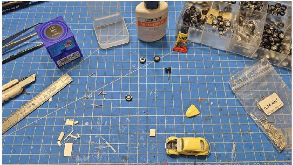
Nach dem Öffnen der Motorhaube geht es ähnlich wie beim Lkw im Bild unten voran. Mit Polystyrolresten wird der Innenraum verkleidet, schwarz bemalt und mit einem Ersatzrad sowie dem Einfüllstutzen aus einer Kanüle bestückt.
