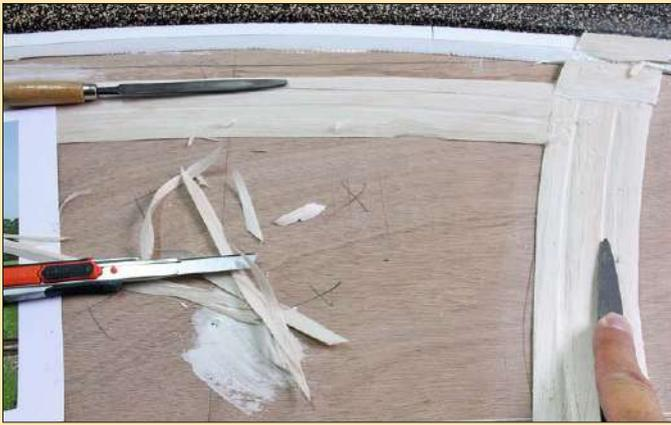
Der etwas erhöht liegende Feldweg wird zunächst mit einem dünneren Streifen Balsaholz angelegt, in den mit Bastelmesser oder Feile die vertieften Fahrspuren eingearbeitet werden. Hier ist darauf zu achten, dass die Fahrinnen breit und tief genug modelliert werden. Das lässt sich prima mit landwirtschaftlichen Fahrzeugen prüfen.
