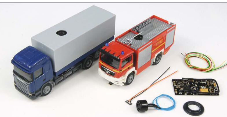
Die Fahrzeuge im digitalen Car System sind an der runden Ultraschallkapsel zu erkennen. Zur Nachrüstung vorhandener analoger Modelle werden Umrüst-Kits angeboten.
