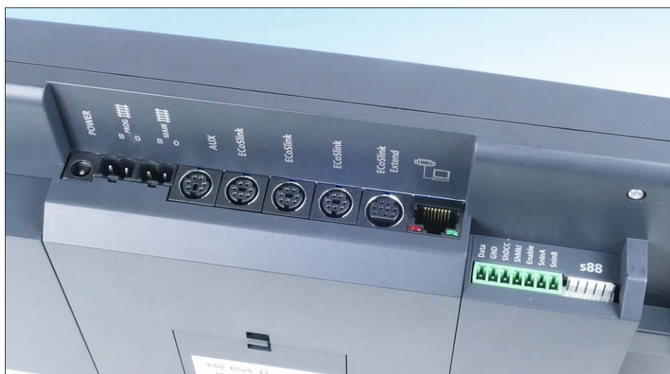
Zur Kommunikation mit der Außenwelt steht bei der ECoS an der Rückseite eine Vielzahl von Schnittstellen und Anschlussmöglichkeiten zur Verfügung. Die Anbindung des PC erfolgt entweder direkt oder über einen Router in Verbindung mit dem klassischen Netzwerkanschluss.
