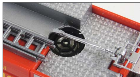
Die Ultraschallkapsel ist unauffällig im Dach platziert. Die Strecke wird beim Abfahren vom Fahrzeug aufgezeichnet.
