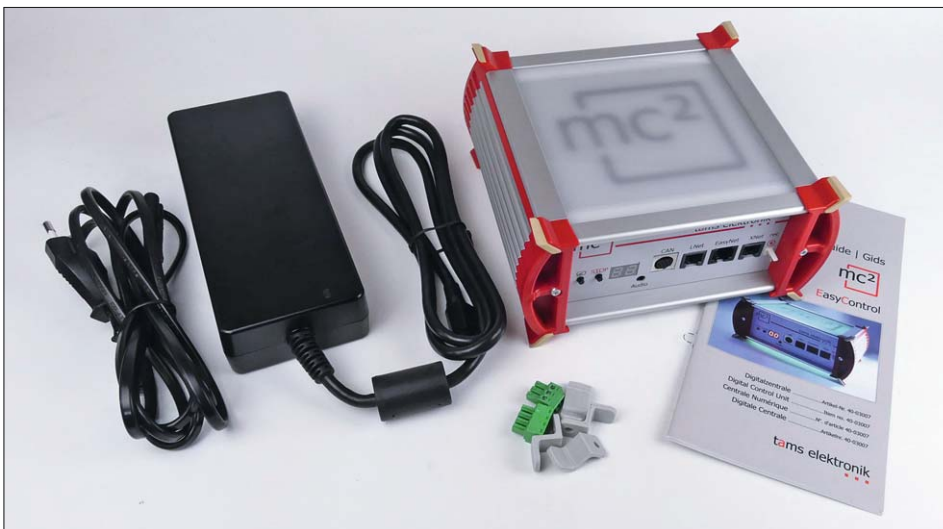
Tams verzichtet bei seiner Digitalzentrale mc 2 auf eigene Bedienknöpfe oder ein aufwendiges Display und setzt entweder auf den Anschluss externer Handregler oder alternativ bzw. ergänzend auf die Steuerung mit PC, Tablet und Smartphone. Das Schaltnetzteil mit 24 V gehört zum Lieferumfang.
