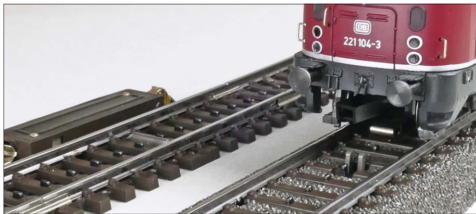
Spezielle Kontaktgleise werden passend zu vielen Gleissystemen angeboten. Allerdings erfolgt die Rückmeldung nur im Moment des Überfahrens. Eine echte Gleisbesetzmeldung findet nicht statt.
