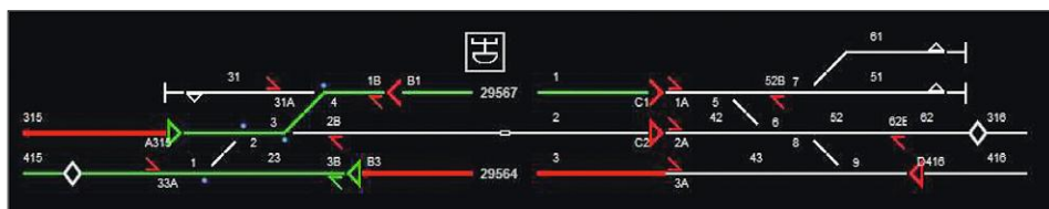
Ebenfalls für die Schweizer Bahnen: Die Steuerungssoftware ILTIS für Relaisstellwerke und eStw
