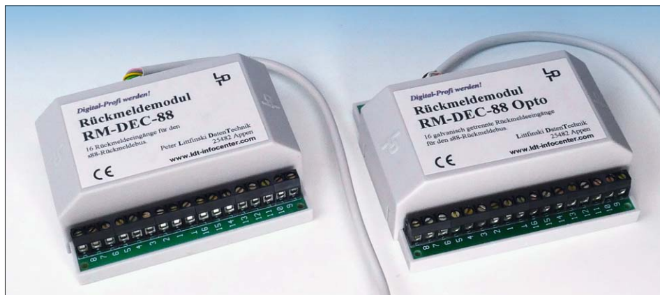
Verschiedene Hersteller, hier LDT, bieten ihre Rückmeldebausteine mit und ohne galvanische Trennung an. Wenn die einzelnen Gleisanschlüsse mittels Optokopplern von der restlichen Elektronik getrennt sind, erleichtert dies u.a. den störsicheren Betrieb mit unterschiedlichen Boosterkreisen.
