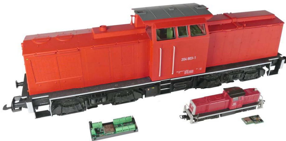
Beim CTC-System erhalten die Lokomotiven eigene Wifi-Module, in denen sämtliche Informationen abgespeichert sind. Sie eignen sich auch hervorragend zur Nachrüstung analoger Fahrzeuge.
