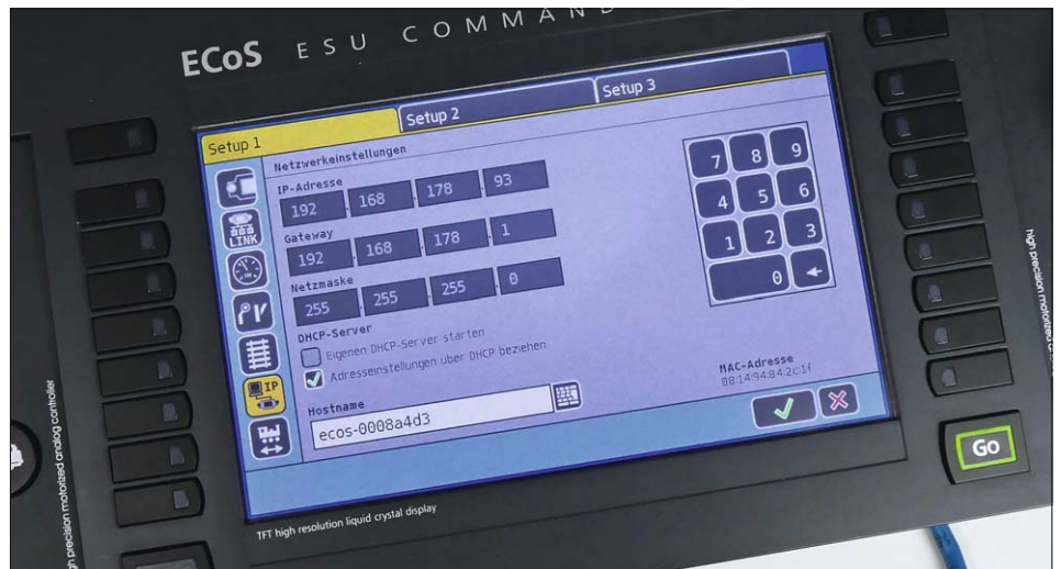
Damit die ECoS von einem PC im Netzwerk angesprochen werden kann, muss die Netzwerkadresse bekannt und in der PC-Software eingetragen werden. Die vom System vergebene IP-Adresse kann bequem in den Systemeinstellungen der Digitalzentrale ausgelesen werden.
