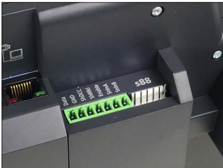
Ein klassischer s88-Anschluss für Flachbandkabel ist bei der ECoS ebenfalls an Bord. Damit lassen sich viele gängige Rückmeldebausteine von Fremdherstellern an der Zentrale anschließen.
