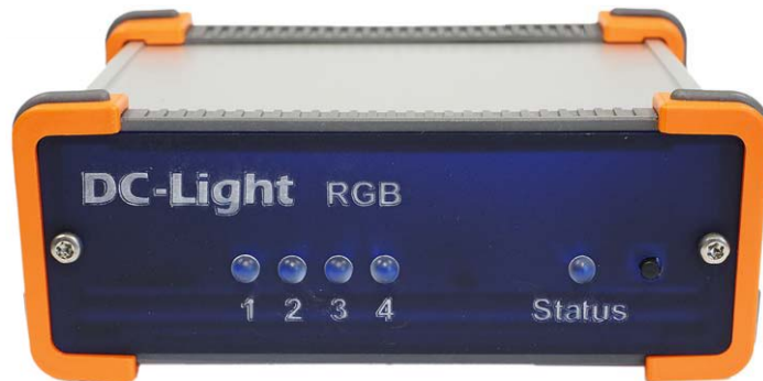
Der neue DC-Light RGB Master bringt vier D-Bus-Anschlüsse mit und kann fast 1000 einzelne LEDs unabhängig voneinander steuern (Handmuster).
