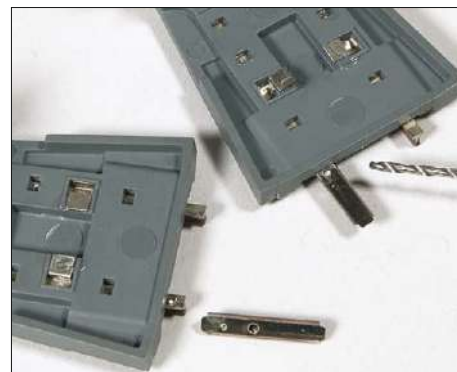
Zum leichteren Abziehen der nicht benutzten Schienenverbinder sollten die Prägungen mit einem 1-mm-Bohrer herausgebohrt werden.
