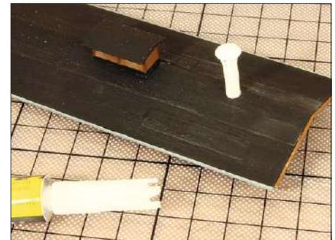
In eine Bohrung im Dach klebt man das Rauchrohr des Dampfsammelkastens senkrecht ein. Die Unterkante des Dampfsammelkastens sollte an die Dampffloks angepasst werden. Der Rauchabzug wird auf das Rauchrohr geklebt, lackiert und bei Bedarf mit Alterungsspuren versehen.
