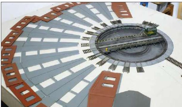
Die Standorte von Ringlokschuppen und Drehscheibe müssen aufeinander abgestimmt sein. Eine gängige Möglichkeit ist es, die Grundplatten des Lokschuppens auszulegen und so die spätere Position zu markieren. Auch die Lage der Untersuchungsgruben kann so bestimmt werden. Die Einfahrten sollten alle die gleiche Entfernung zur Drehscheibe haben.
