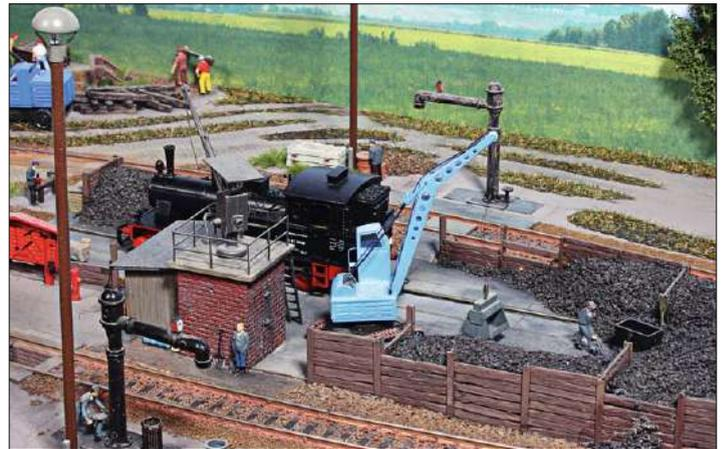
Fahrbare Portalkrane hatten von der oben angeordneten Kabine eine gute Sicht. Ihr Portal überspannte das Kohlenzufuhrgleis für den Kohlenbansen. So konnte der Kran mehrere Wagen entladen und die Kohle im Bansen verteilen. Der Ausleger erreichte die hintere Tasche des Kohlenbunkers.
