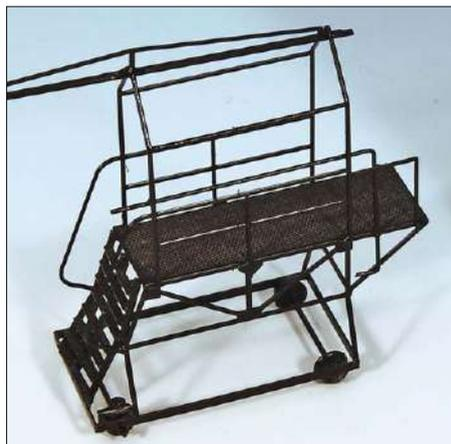
Im Bild rechts ist das fertige Modell von Weinert zu sehen. Zwischen der Druckluftleitung am Gerüst und dem Blasrohr wird noch ein dünner Gummischlauch eingesetzt. Das Blasrohr kann anschließend mit zwei Haken aus feinem Neusilberdraht an der oberen Laufschiene aufgehängt werden – danach ist das Rohrblasgerüst zum Einsatz im Bw bereit.
