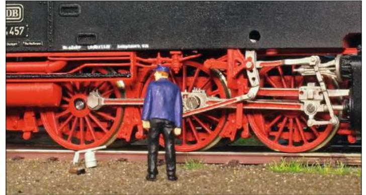
Treib- und Kuppelstangen sowie die Steuerung besaßen viele Lager. Hier kontrolliert der Lokführer die Lager direkt nach der Fahrt, um Heißläufer zu identifizieren. Die Ölgefäße der Stangenlager werden aufgefüllt.
