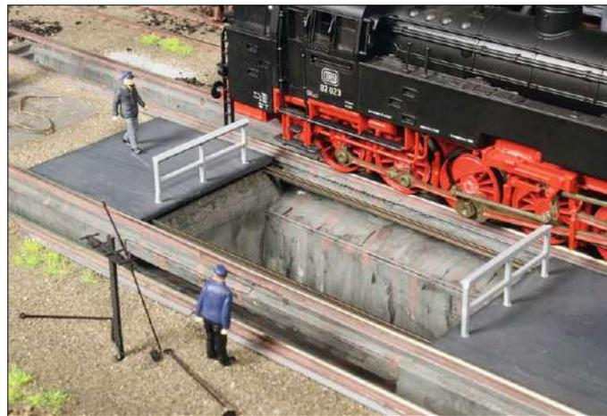
An der Ausschlackanlage waren Ausschlacker beschäftigt. Diese hatten die mitunter härtesten Tätigkeiten im Bw-Alltag. In großen Bahnbetriebswerken öffneten sie die Klappen der Aschkästen, woraufhin Schlacke und Asche in den Schlackesumpf fielen. In der Feuerbüchse wurde mit Schürhaken und Kratzen mit Muskelkraft nachgeholfen.
