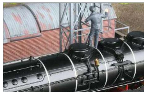
Zum Befüllen des Sandes muss der Heizer auf den Kessel steigen und den Sandbehälter öffnen. Mit dem Schlauch wird der Sand dann nach dem Betätigen des Auslaufschiebers in die Lok gefüllt.
