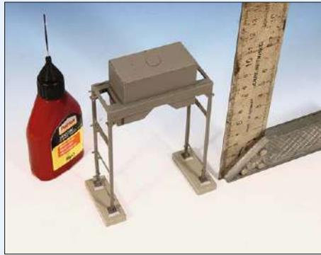
Bei der Montage sollte auf einen senkrechten Stand der seitlichen Stützen geachtet werden. Kontrollieren lässt sich dies mit einem Winkel.
