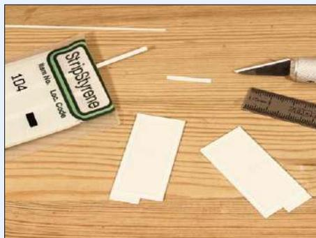
Den Rahmen und die Querstreben der Metalltore bildet man mit dünnen Polystyrolstreifen nach. Die Streifen lassen sich entlang eines Stahllineals mit einem Skalpell zuschneiden.
