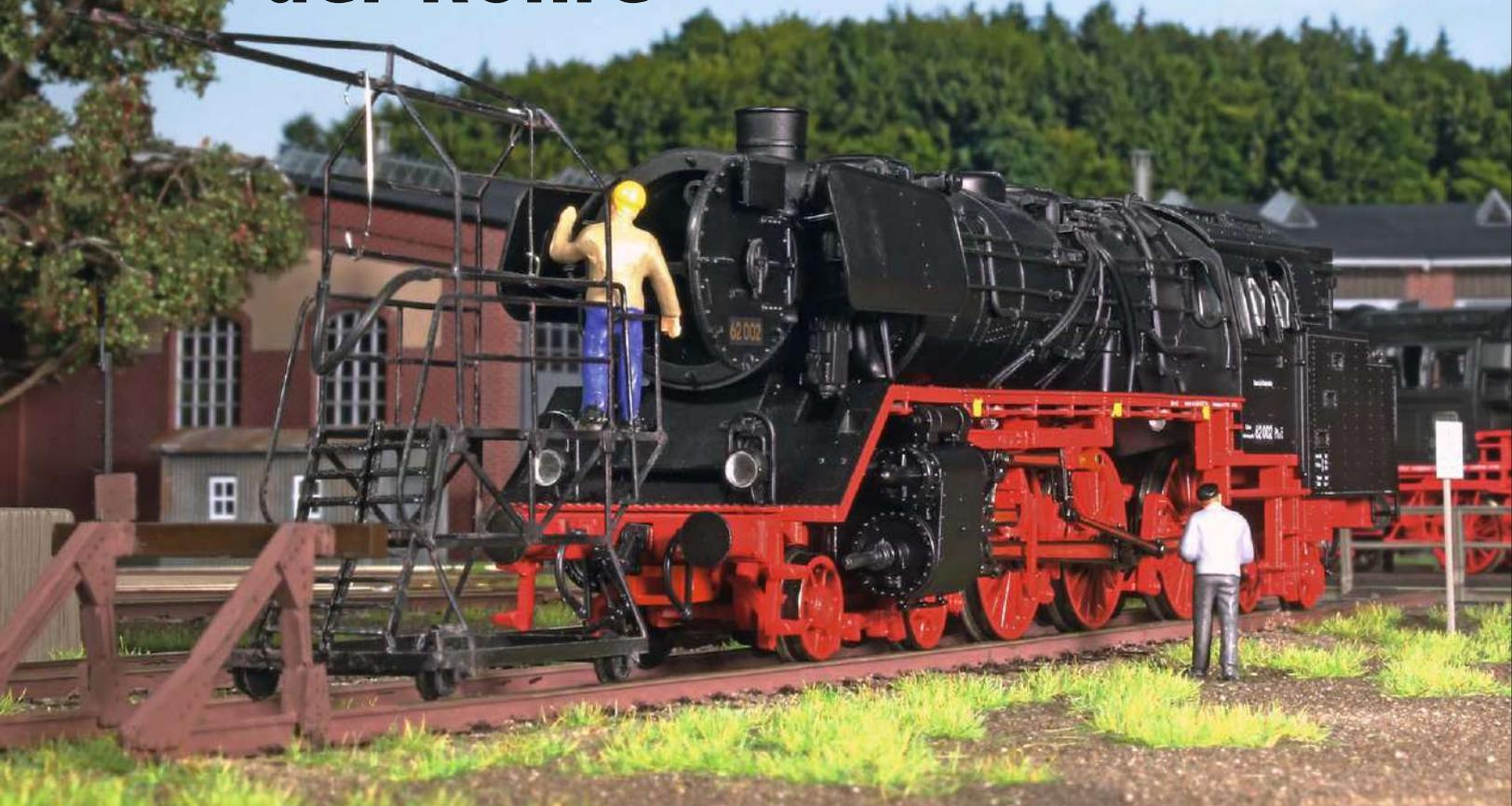
*Die Ablagerungen aus Asche und Ruß in den Rauch- und Heizrohren im Kessel von Dampflok mussten regelmäßig entfernt werden. Dies erfolgte mit langen Blasrohren und Druckluft. Mit den kleinen Bausätzen von Weinert und Faller lassen sich solche Rohrblasgerüste auch im Modell nachbilden.*
