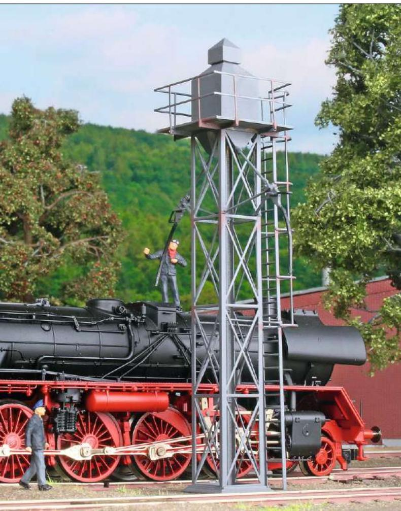
Der Weinert-Sandturm steht mit seinem Fundament zwischen zwei Bw-Gleisen und kann über Schläuche den Sand zu beiden Seiten abgeben. Die Länge der Schläuche sollte so bemessen sein, dass sie knapp über den Sandkästen der Dampflok enden, diese aber ohne Berührung darunter hindurch fahren können. Der Heizer ist für das Auffüllen des Sandes zuständig.
