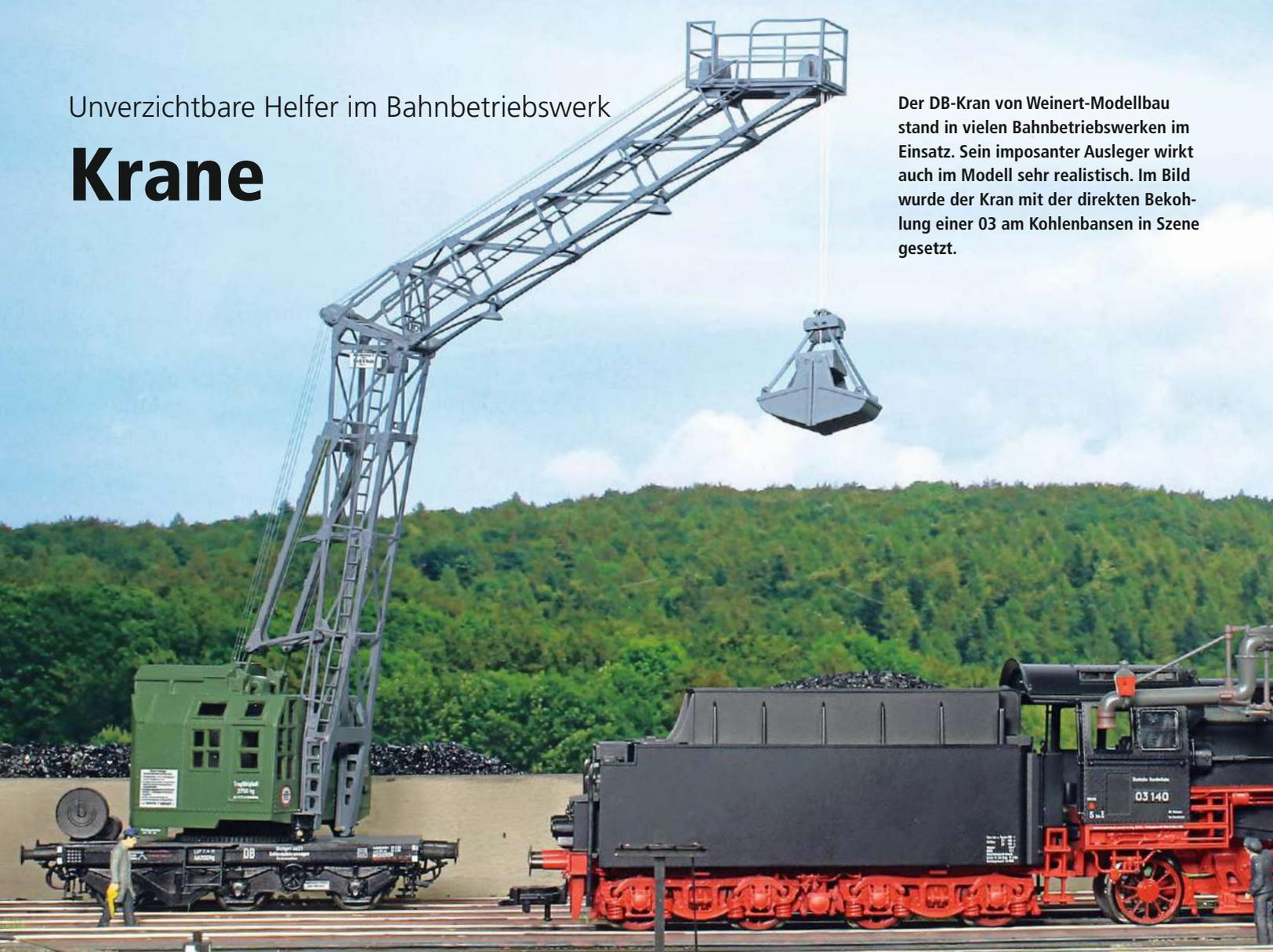
*Ob an der Bekohlungsanlage zum Befüllen der Hochbunker oder zum Ausbaggern von O-Wagen, ob am Schlackensumpf oder nur zum Heben von Hunten an Kleinbekohlungen – Krane fand man in den unterschiedlichsten Größen und Ausführungen in nahezu jedem Bahnbetriebswerk. Je größer die Einsatzstelle und deren Anforderungen an die Lokomotivbehandlung wurde, umso größer und leistungsfähiger gestaltete man die stationären oder fahrbaren Krananlagen.*
