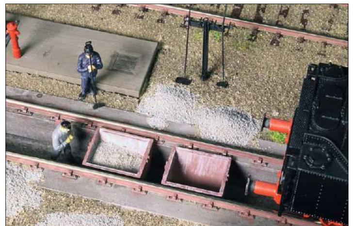
Eine recht warme und staubige Arbeit war das Löschiezen. Hier schaufelte der Ausschlacker nicht verbrannte Kohlenreste, die vom Rauch nach vorne gezogen wurden, aus der Rauchkammer. Entsorgt wurden sie im Schlackesumpf oder an der Lok in Hunten oder Haufen.
