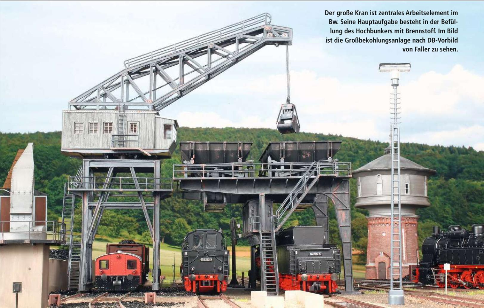
Der große Kran ist zentrales Arbeitselement im Bw. Seine Hauptaufgabe besteht in der Befüllung des Hochbunkers mit Brennstoff. Im Bild ist die Großbekohlungsanlage nach DB-Vorbild von Faller zu sehen.
