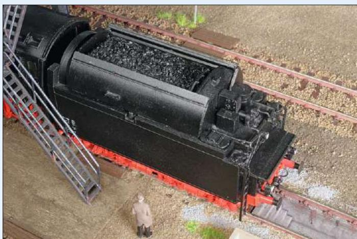
Die 03.10 der Deutschen Bundesbahn besaß Klappen über dem Kohlenkasten. Diese wurden mit Druckluftzylindern angetrieben. Vor der Bekohlung musste die Klappe geöffnet und danach wieder geschlossen werden. Am Weinert-Modell der 03 1011 hat Martin Knaden diese Klappen beweglich ausgeführt.
