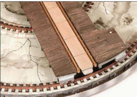
Die Oberfläche der Laufschiene wurde wieder von Farbe befreit, sodass sich die Rollen aus Kunststoff leicht darauf bewegen können. Vor dem Einbau der Drehscheibe wurde die Beweglichkeit der Drehbühne geprüft (oben):
