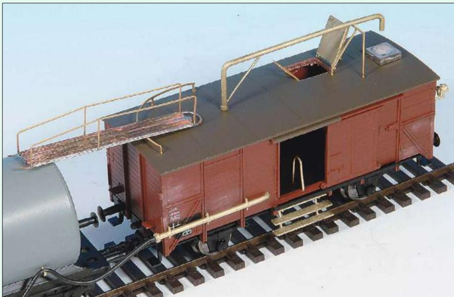
Der Umbausatz von Weinert-Modellbau hat einen Güterwagen der Gattung G 10 als Basis. Im Dach muss eine Öffnung eingearbeitet werden und die Seitentür sollte im geöffneten Zustand nachgestellt werden. Die Teile aus Messingguss und Ätzblech montiert man probeweise vor der Lackierung. Am G 10 ist an einer Seite ein Rohr angebracht, durch das das Öl aus dem Kesselwagen zur Pumpe fließt. Am Kesselwagen ist dazu ein an der Auslassöffnung angeflanschter Schlauch vorhanden, der Bogenfahrten ermöglicht.
