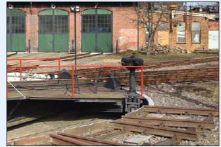
Bei Drehscheiben befinden sich gegenüber von Gleisanschlüssen kleine Gleisstummel, die ein Entgleisen bei ungenauem Halten verhindern sollen.
