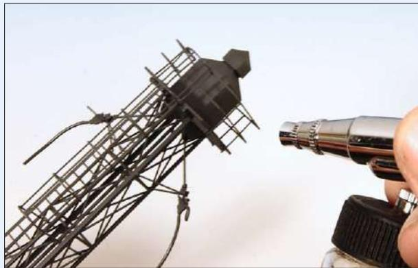
Bei den Geländern am oben liegenden Sandbehälter sollte man exakt rechtwinklig arbeiten. Auch der Schutz der Aufstiegsleiter ist kleinteilig, entschädigt bei akkurater Montage aber durch einen sehr vorbildgerechten Eindruck (links). Die feine Metallkonstruktion sollte nach der Montage gereinigt und dann mit einer Airbrush-Pistole grundiert und lackiert werden.
