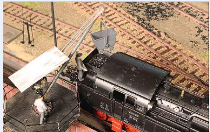
Über einen Handantrieb wird der Kran gedreht und die Hunte gehoben. Die Position des Krans muss so gewählt werden, dass der Ausleger bis über den Kohlenkasten der Lok reicht. Die Hunten werden auf der Lok oder dem Kohlenkasten von Hand oder mit einer Stange gekippt.
