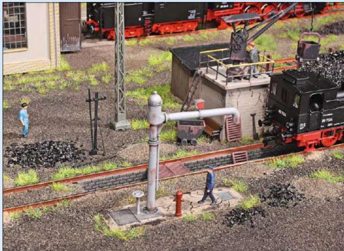
Die Behandlungsanlagen für Dampfloks konzentrieren sich in kleinen Lokbahnhöfen meist an einem Gleis. Neben der Bekohlungsanlage mit Kran befindet sich eine Grube zum Entschlacken und Abölen der Lok von unten. Ein Wasserkran befindet sich ebenfalls vor dem Lokschuppen.
