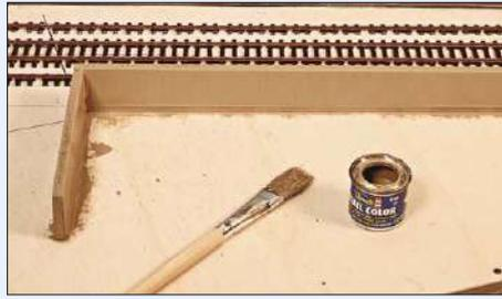
Für eine Großbekohlungsanlage entstand die Abgrenzung des Kohlenbansens aus Sperrholzstücken. Diese wurden im Abstand des Lichtraumprofils senkrecht auf die Anlagengrundplatte geklebt (links) und dann mit matten Farben gestrichen. So entstand eine betonähnliche Oberfläche, die abschließend noch eine Alterung aus verdünnten Farben erhielt.
