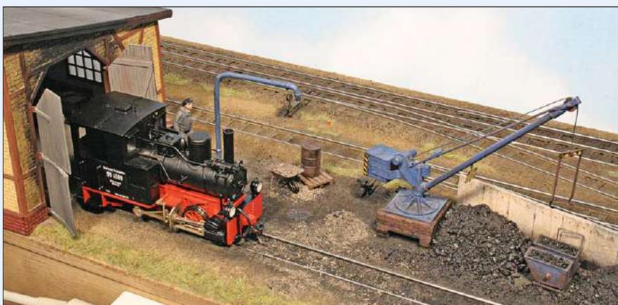
Bei einer Bekohlungsanlage mit Hunten werden diese von Hand im Kohlenbansen befüllt und dann mit einem Kran über den Kohlenkasten der Lok gehoben. Diesen kleinen Kohlenbansen mit Kran baute Frank Barby auf seiner 0e-Anlage nach Rügen-Vorbild.
