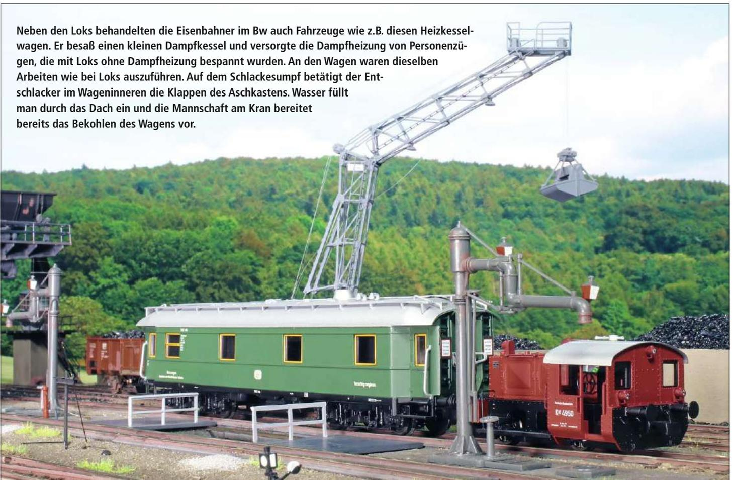
**Neben den Loks behandelten die Eisenbahner im Bw auch Fahrzeuge wie z.B. diesen Heizkesselwagen. Er besaß einen kleinen Dampfkessel und versorgte die Dampfheizung von Personenzügen, die mit Loks ohne Dampfheizung bespannt wurden. An den Wagen waren dieselben Arbeiten wie bei Loks auszuführen. Auf dem Schlackesumpf betätigt der Entschlacker im Wageninneren die Klappen des Aschkastens. Wasser füllt man durch das Dach ein und die Mannschaft am Kran bereitet bereits das Bekohlen des Wagens vor.**
