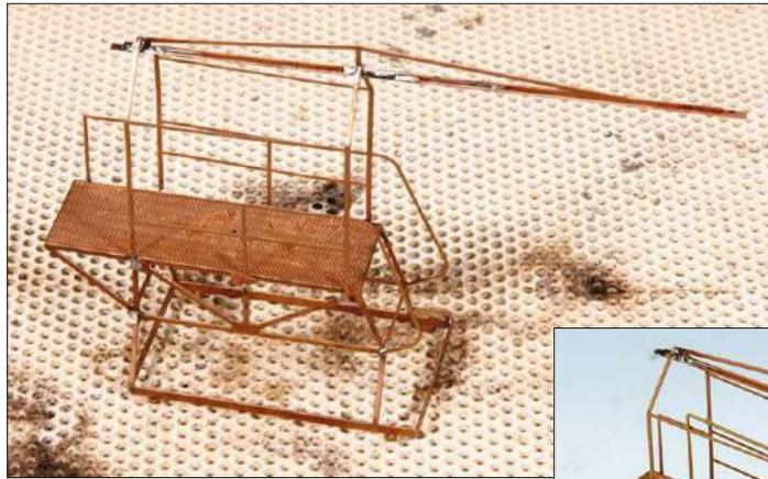
Rechts: Etwas pfriemelig ist die Montage des Aufstiegs, der aus vier Bauteilen zusammengesetzt wird. Danach können die kleinen Kunststoffräder eingesetzt werden. Hier sollte man die korrekte Spurweite mit einem Gleisstück prüfen.
