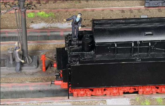
**Je nach Wasserhärte musste der Heizer beim Wassernehmen Zusätze in den Wasserkasten füllen. Die Zusätze wurden in Fässern auf dem Tender aufbewahrt. Zum Dosieren des Pulvers nutzte der Heizer einen Messbecher, mit dem er den Zusatz in die Wasserkastenlücken auf dem Tender füllte.**
