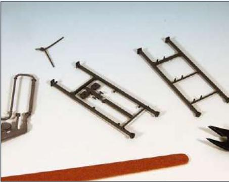
Die feinen Kunststoffteile beschleift man, um Grate zu beseitigen. Die dünnen Leitungen und Schläuche sollten nicht beschädigt werden.
