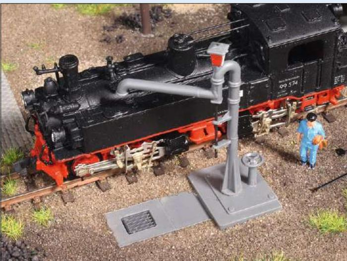
Solch einen Wasserkran fand man in Sachsen oder in Norddeutschland bei vielen Schmalspurbahnen. Der Wasserauslauf wurde in der Höhe angepasst. Die Laterne auf dem Ausleger signalisiert das Hindernis über dem Gleis. Die Sammelöffnung fängt das tropfende Wasser auf.
