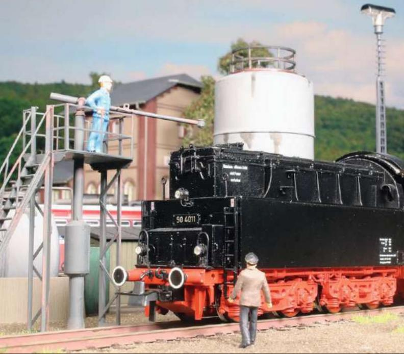
Für Ölloks nutzte man Ölkräne mit einem beweglichen Galgen. Bevor die Öltender mit unten liegenden Einfüllstutzen nachgerüstet wurden, mussten die Ausleger der Ölkräne von oben in die Einfüllluken des Ölbehälters gedreht werden. Dies erfolgte durch einen Bw-Mitarbeiter von einer höher liegenden Plattform aus.
