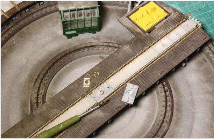
Ein Gitterrost aus Kunststoff dient als Abdeckung über dem Zapfen des Königsstuhls. Mit einem Federblech und einem Sprengring ist die Brücke auf dem Königsstuhl gesichert. Mit einem kleinen Schraubendreher kann man die Abdeckung vorsichtig abhebeln und den Sprengring entfernen.
