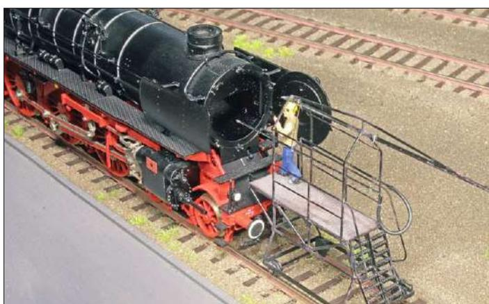
An einem Rohrblasgerüst hing das Blasrohr an einer Schiene und konnte so leicht von vorn in den Kessel geschoben werden. Von einem Laufsteg aus mit Geländer konnte der Rohrbläser sicher seine Arbeit ausführen. Auf Rollen wurde das Gerüst an die geöffnete Rauchkammer gefahren.
