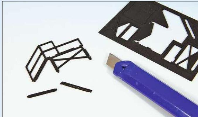
Die dünnen Bauteile aus Karton trennt man mit einem Cuttermesser vorsichtig aus dem Trägerbogen. Die winzigen Montagezapfen sollten nicht beschädigt oder verbogen werden.
