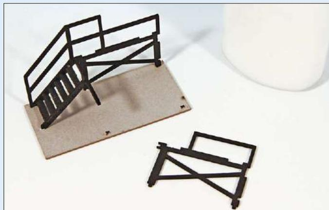
Die Grundplatte mit den eingearbeiteten Löchern dient als Montagehilfe und erleichtert den winkligen Zusammenbau. Mit sparsam dosiertem Holzleim lassen sich die Bauteile verkleben.
