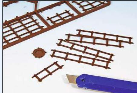
Die einzelnen Gleisroste und Drehscheiben trennt man mit einem Skalpell vom Bausatzspritzling und entfernt die Angüsse.
