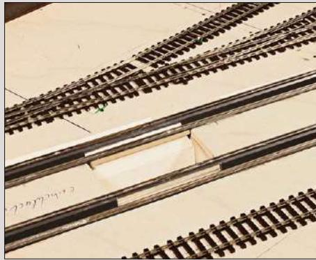
Die Schienenprofile wurden auf den Rändern der Untersuchungsgruben von Fallner verlegt. Über dem Sumpf verlaufen sie auf dem Holzstück. Fixiert sind sie mit Sekundenkleber.
