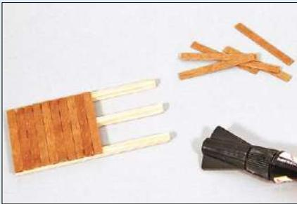
Der Boden der Bühne entstand aus dünnem Furnierholz, das in schmale Streifen geschnitten auf drei Bohlen geklebt wurde.
