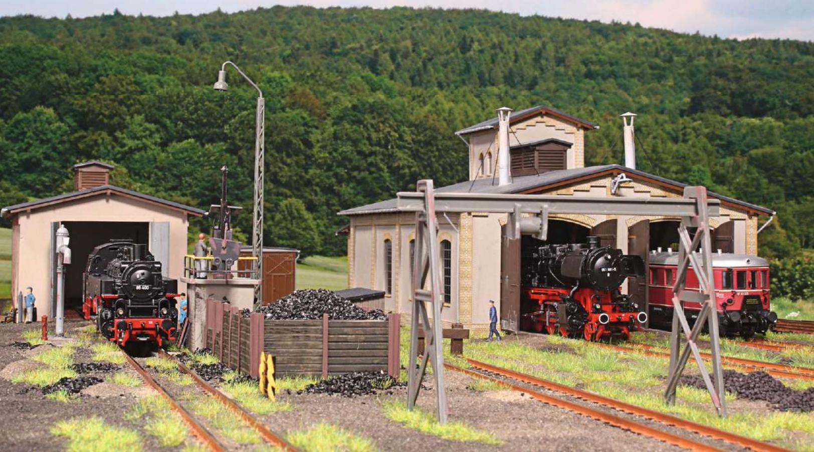
pen befindet sich ein Gleis für die Lokomotivbehandlung mit Kohlenbansen, Untersuchungs- und Entschlackungsgrube sowie einem Wasserkran.
