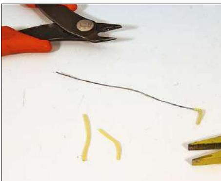
Kleine Entnahmestutzen fand man vielfach neben Wasserkränen. Damit konnten über Schläuche auch die Wasserbehälter von Dieselloks gefüllt werden. Einen solchen Anschluss kann man leicht aus einem Drahtstück biegen und den Schlauch durch dünneren Draht formen.
