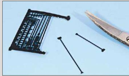
Links: Die Schürhakengestelle von Weinert weisen Ständer aus Messingguss auf, die Werkzeuge sind geätzt. Die Bauteile sind bereits brüniert und müssen daher nicht mehr lackiert werden. Neben einfachen Ständern für kleine Anlagen (links) können auch breitere Gestelle aus dem Bausatz entstehen. Die geätzten Schürhaken lassen sich am besten mit einer kleinen Schere vom Ätzrahmen trennen.
