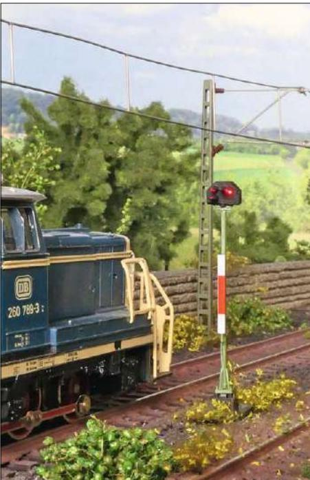
Ein Lichtperrsignal in hoher Ausführung in Stellung Sh0 mit zwei roten Lichtern. Anfang 2006 wurde der Begriff Sh0 durch Hp0 ersetzt und nur noch über ein rotes Licht signalisiert.
