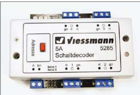
Auch der Schaltdecoder 5285 eignet sich vom Grundsatz her zum Schalten von Lichtsignalen. Dank der Relais können auch Signale mit unterschiedlichen Spannungen betrieben werden.
