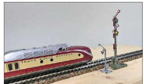
... kann der Geschwindigkeitsanzeiger auf der Modelleisenbahn installiert werden. Er sorgt im Betrieb später für einen echten Hingucker.
