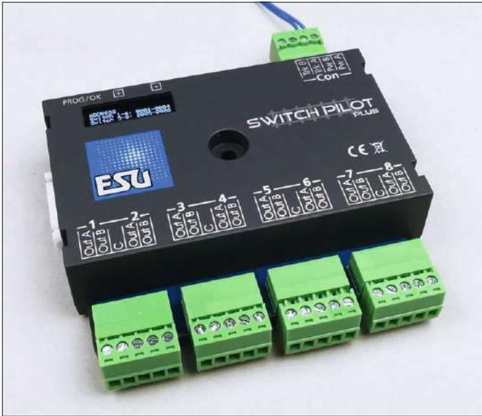
Der SwitchPilot 3 plus von ESU verfügt über 16 Transistorausgänge, die jeweils dauerhaft mit 1,5 A belastet werden dürfen. Kurzzeitig sind je Ausgang auch bis zu 2,5 A möglich.
