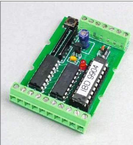
Der DCC-FPSB-Decoder 9904 basiert auf der gleichen Hardware wie der 9404. Zwölf Signalbilder lassen sich individuell konfigurieren und über separate Digitaladressen abrufen.
