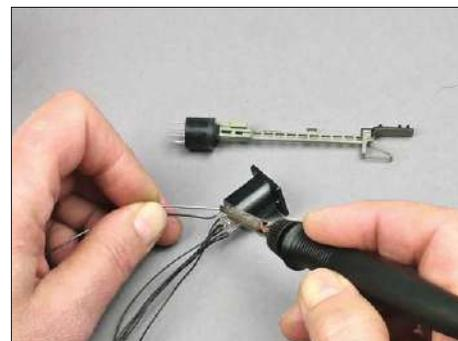
Die einzelnen Kabel für die LEDs müssen bei Alphamodell am Steckfuß angelötet werden.
