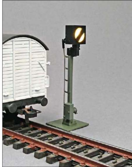
**Das Form-Sperrsignal in Stellung Sh1 signalisiert die Aufhebung des Fahrverbotes.**
