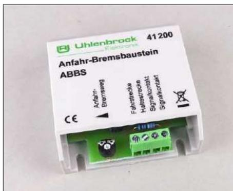
**Der Anfahr- und Bremsbaustein von Uhlenbrock erlaubt dem analogen Modellbahner in Verbindung mit der Zugbeeinflussung eines Signals ein sanftes Abbremsen und Beschleunigen.**
