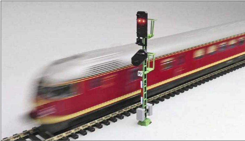
Das ABC-Bremsen ist besonders beliebt bei Modellbahnern mit Zweischieneversorgung. Da die Fahrstromversorgung getrennt über die linke und rechte Schiene erfolgt, können Züge je nach Fahrtrichtung die Polarität der Bremsspannung erkennen und den Bremsabschnitt eines „Halt“ zeigenden Signals in Gegenrichtung ohne Zusatzaufwand durchfahren.
