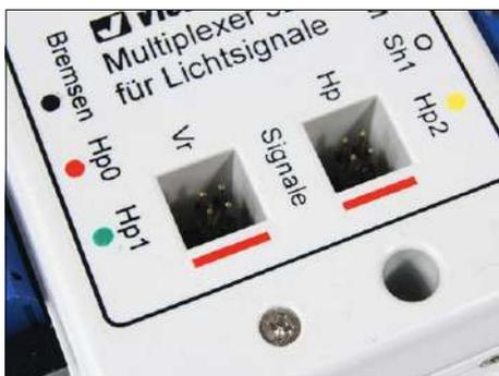
Der Multiplexer 5229 erlaubt einen Anschluss von Hauptsignal und zugehörigem Vorsignal.
