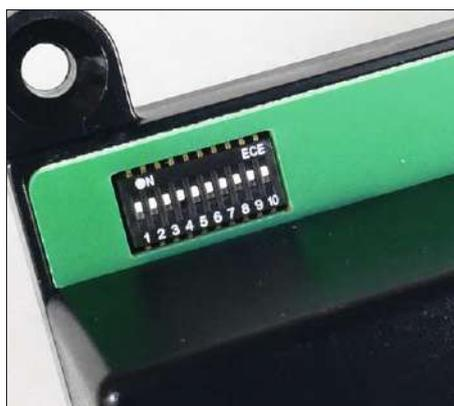
Zur Einstellung des Digitalprotokolls bzw. der Betriebsart sowie der Digitaladresse des ersten Schaltausgangs sind DIP-Schalter vorgesehen.
