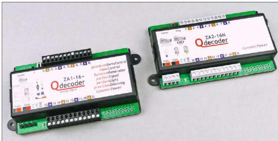
Die Qdecoder aus den Serien ZA1 und ZA2 sehen sich ähnlich und eignen sich beide zum Betrieb von Formsignalen mit Magnet- und Doppelspulenantrieben. Der ZA2 kann zusätzlich auch Elektromotoren in beiden Richtungen bzw. motorische Signalantriebe ansteuern.
