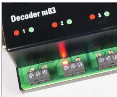
Praktisch: Für jeden einzelnen Schaltausgang sind beim m83 LED-Anzeigen zur Kontrolle des Schaltzustandes vorhanden.
