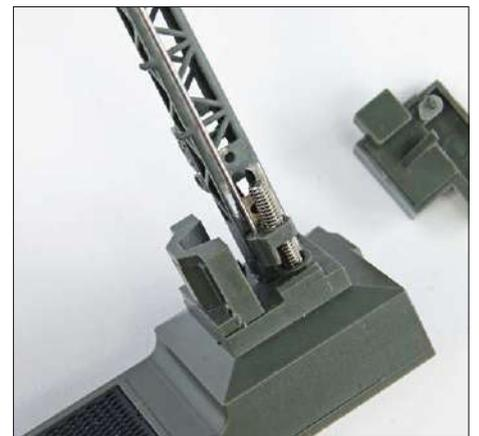
Der Antrieb der Signalfügel erfolgt über eine kleine Antriebsschnecke. Der Mikromotor wurde zusammen mit der Steuerelektronik platzsparend im Signalfuß untergebracht.
