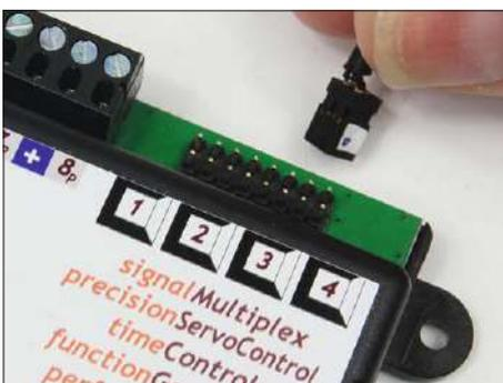
Nur in der Deluxe-Ausführung (EU) bringt der ZA2-16+ die vierpoligen Multiplexstecker mit. In der Standardausführung werden die Signale über die Schraubklemmen angeschlossen.
