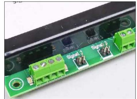
Zwei Viessmann-Multiplexsignale können über die vierpoligen Kontaktleisten am Digimux von bogobit angeschlossen werden.
