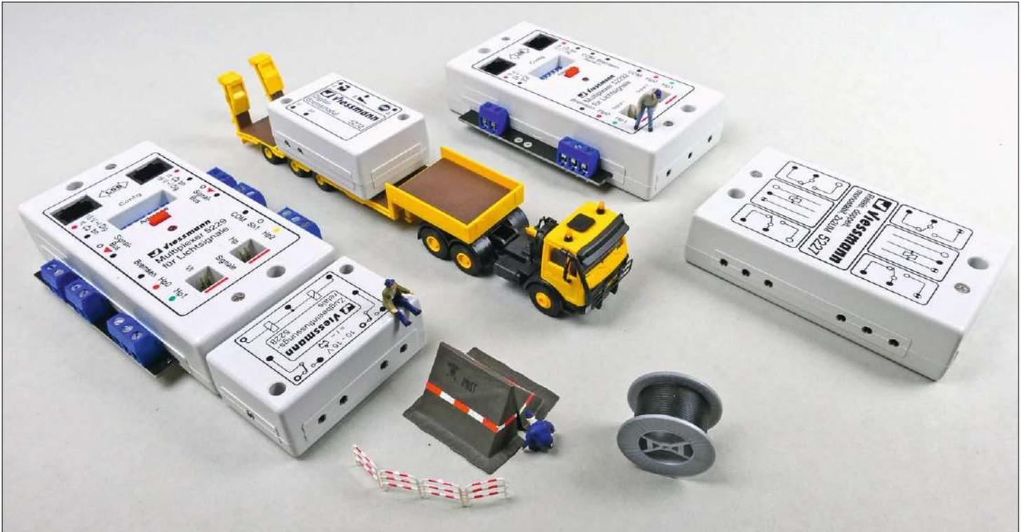
Viessmann bietet passend zu seinen Multiplexern für eine signalabhängige Zugbeeinflussung verschiedene Zusatzbausteine an. Das Zugbeeinflussungsmodul 5228 und das Doppel-Relais 5227 lassen sich seitlich an den verschiedenen Bausteinen direkt anstecken. Das Bremsmodul 5232 wird über die Relaiskontakte aktiviert und erlaubt über die „Märklin-Bremsstrecke“ ein sanftes Abbremsen der Lokomotiven bis zum Stillstand.
