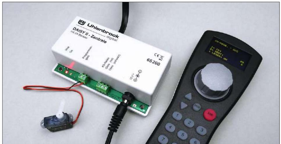
Das Digitalservo besitzt einen eingebauten Digitaldecoder. Betriebsart, Digitaladresse und die Bewegungsfunktionen des Stellantriebs lassen sich bequem über die CV-Programmierung einstellen.
