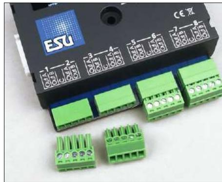
Die Anschlussklemmen sind für eine komfortable Installation steckbar ausgeführt.
