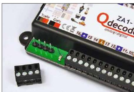
Die Qdecoder in der „DeLuxe“-Ausführung besitzen steckbare Schraubklemmen für einen komfortablen elektrischen Anschluss.
