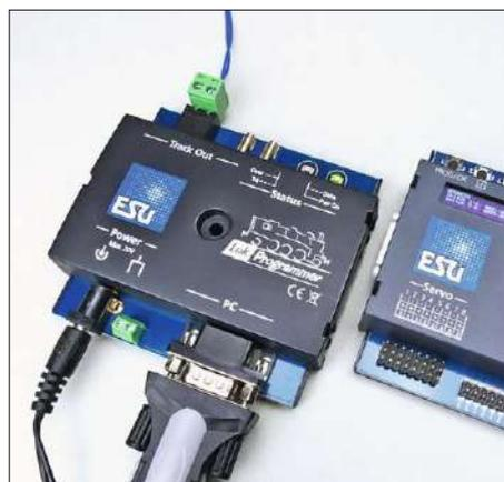
Zur komfortablen Konfiguration am PC ist der ESU-LokProgrammer 53451 ebenso geeignet. Zwingend notwendig ist dieser aber nicht.
