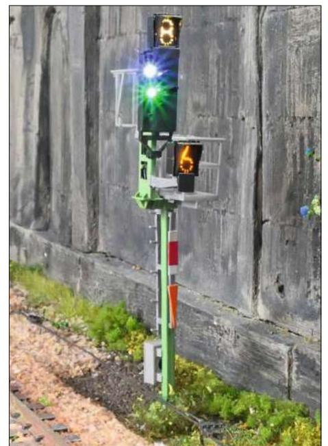
Bei diesem Mehrabschnittssignal sind Geschwindigkeitsanzeiger Zs3 und Geschwindigkeitsvoranzeiger Zs3v an einem Signal vereint.
