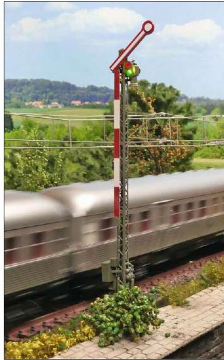
Blocksignal als Formsignal auf freier Strecke. Das Signal kommt mit einem einzigen Flügel für die Stellungen Hp0 und Hp1 aus.
