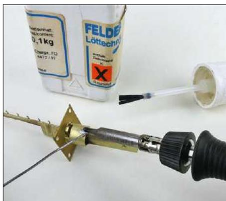
Die einzelnen Bausatzteile von Weinert sollten möglichst verlötet werden. Wer keinen LötKolben hat oder noch nie mit Messingteilen gearbeitet hat, greift am besten zu Sekundenkleber.
