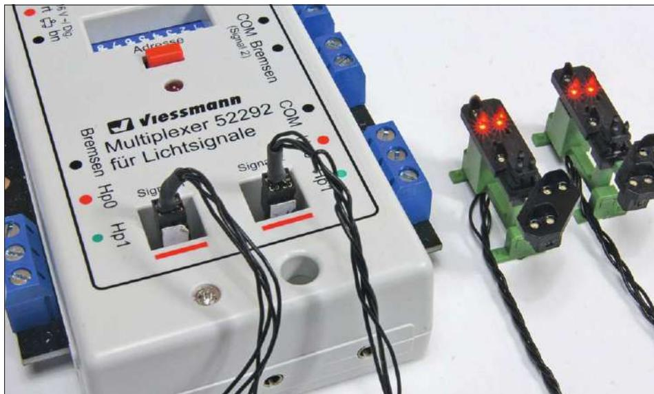
Multiplexsignale lassen sich nicht einfach mit einem Tastenstellpult o.Ä. bedienen. Hierzu sind spezielle Steuerbausteine erforderlich, die die gewünschten Signalbilder erzeugen.
