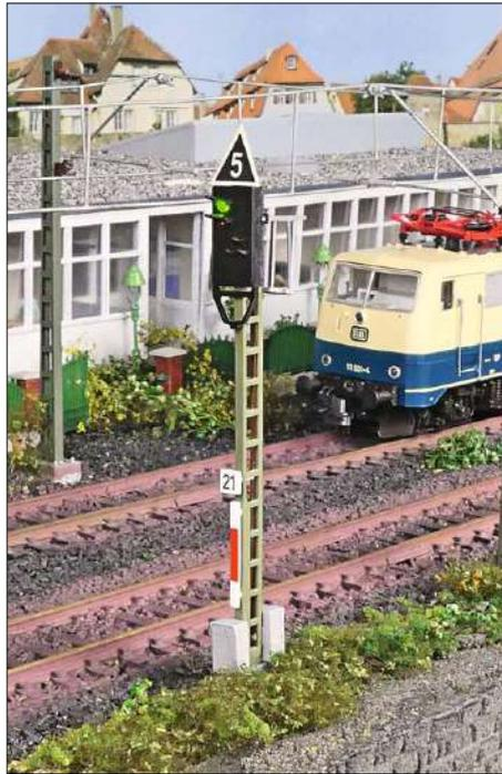
Der feste Geschwindigkeitsanzeiger Zs3 kann auch zusammen mit Lichtsignalen eingesetzt werden, wie hier am Beispiel eines Kompaktsignals von Busch zu sehen ist. Die dreieckige Tafel sitzt dabei oberhalb des Signalschirms.
