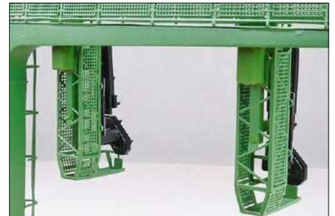
Dank der Multiplexertechnik sind an den Signalgondeln auch von hinten keine störenden Anschlusskabel zu erkennen.
