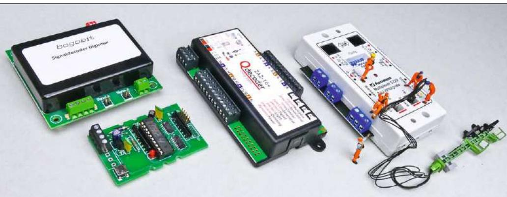
Grunde immer aus einzeln angesteuerten LEDs zusammen. Da die Ansteuerung zeitversetzt erfolgt, leuchten jedoch nur wenige oder einzelne LEDs gleichzeitig – und dank der Trägheit des menschlichen Auges entstehen aus einzeln angesteuerten LEDs komplette Signalbilder.
