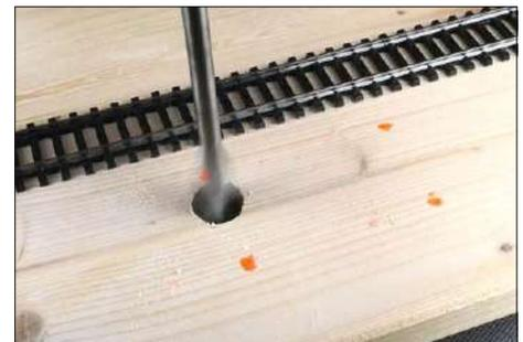
Nach dem Anzeichnen werden vier Löcher mit je 2 mm und ein weiteres Loch mit 16 mm Durchmesser gebohrt.
