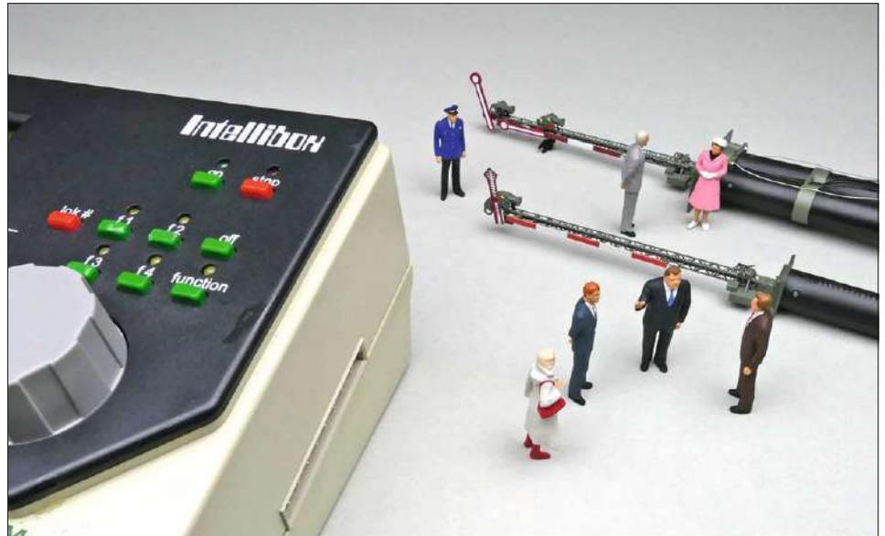
Über den geeigneten Digitaldecoder zum Stellen eines Formsignals entscheiden vorrangig der Antriebsmechanismus des vorhandenen Signals und das gewünschte Digitalsystem bzw. das bevorzugte Digitalprotokoll. Auch wenn die meisten Modellbahnhersteller heutzutage mit Märklin-Motorola (MM) und DCC die beiden gängigsten Digitalprotokolle unterstützen, empfiehlt sich aus der Praxis
