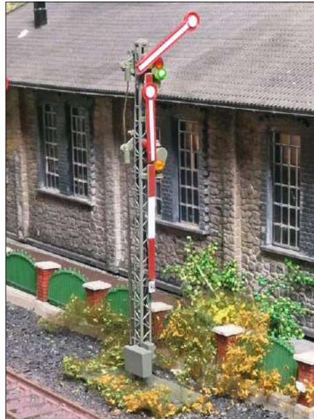
Hp1: Ein Signalflügel – bei zweiflügeligen Signalen der obere Flügel – zeigt schräg nach rechts aufwärts und erlaubt die Fahrt mit der im Fahrplan zugelassenen Geschwindigkeit. Das Nachtzeichen ist ein einzelnes grünes Licht.
