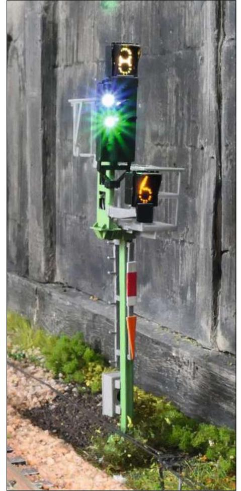
Zs3 und Zs3v an einem modernen Ks-Mehrabschnittssignal von Viessmann
