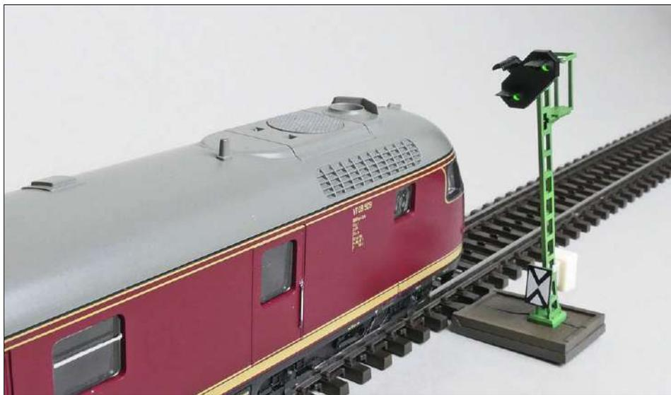
Das separat stehende Vorsignal gehört funktional zum nächsten Hauptsignal und wird einfach mit dessen Steuerelektronik verbunden. Eine separate Programmierung ist dabei nicht notwendig.
