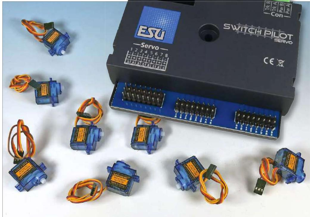
Der multiprotokollfähige SwitchPilot 3 Servo von ESU erlaubt den Anschluss von bis zu acht RC-Servoantrieben und kann diese sowohl analog als auch digital in verschiedenen Betriebsmodi ansteuern. Ein mögliches Nachwippen von Formsignalfüglern ist ab Werk ebenfalls integriert.
