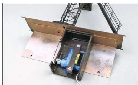
Der Servoantrieb wird mit der Servoaufnahme unter dem Signalausleger befestigt und bedient über den Stelldraht den Signalflügel.
