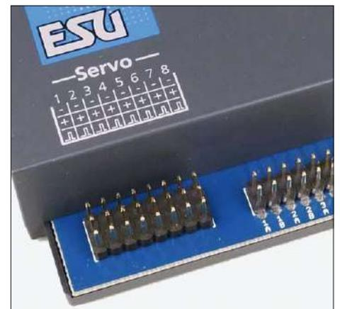
Neben den klassischen dreipoligen Anschlüssen für die Servoantriebe sind zur Steuerung der Servos auch noch Tastereingänge vorhanden.
