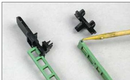
Signalmast und Signalschirm werden am besten in Verbindung mit einem kleinen (!) Tropfen Sekundenkleber miteinander verklebt.
