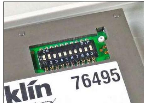
Zum schnellen Einstellen von Betriebsart und Digitaladresse ist die Steuerelektronik mit einem „Mäuseklavier“ ausgerüstet.
