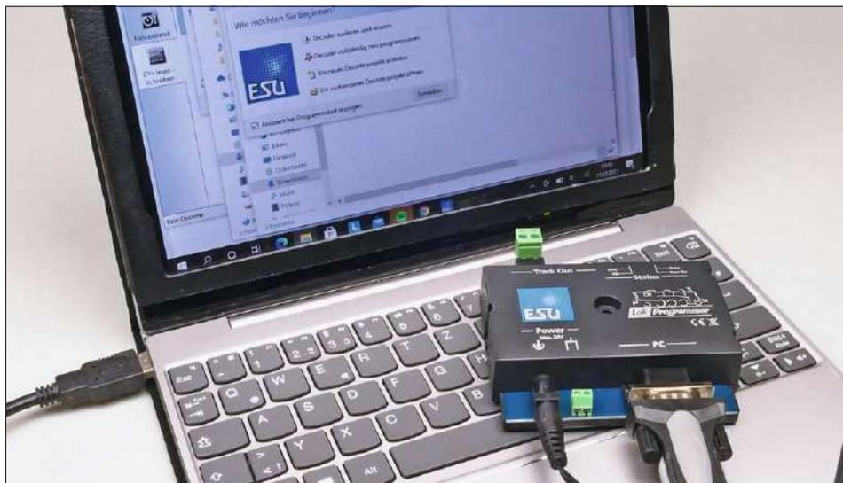
Der LokProgrammer 53451 eignet sich ideal zur komfortablen und übersichtlichen Konfiguration des ESU-SignalPilots. Über einen USB-Anschluss findet der LokProgrammer Anschluss an den PC.
