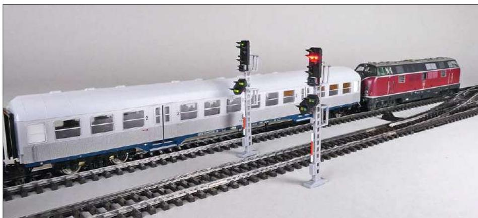
Bei einer Bahnhofsausfahrt müssen die Ausfahrtsignale so aufgestellt werden, dass eine eindeutige Zuordnung zum Gleis gegeben ist. Der Standort befindet sich vor der ersten in Fahrtrichtung folgenden Weiche. Die hier aufgestellten Lichtsignale stammen von Modellbahnzubehör Schneider.
