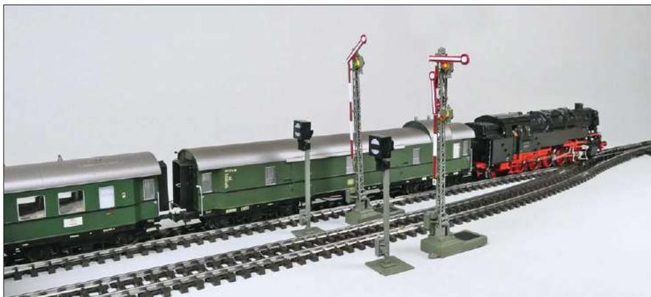
Bei dieser Bahnhofsausfahrt benötigt das linke Signal nur die Signalstellungen Hp0 und Hp1 und kommt mit einem Flügel aus. Da der Fahrweg rechts immer über den abzweigenden Strang der Weiche führt, genügen hier zwei gekoppelte Flügel für Hp0 und Hp2. Die Signale sind von Viessmann.
