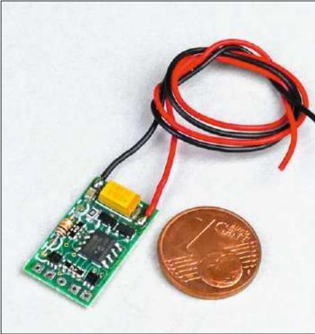
Der DCC-Klein-Signaldecoder 9025 misst gerade einmal 23 x 11 x 3 mm und ist für ein einzelnes Signal gedacht. Er kann sowohl H/V-Signale als auch Ks-Signale digital steuern.
