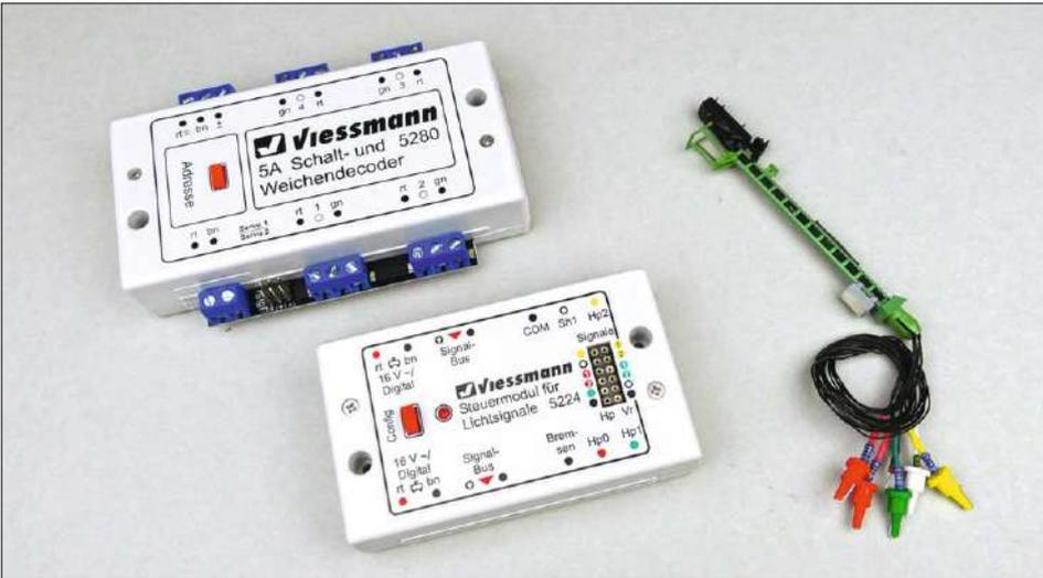
Die klassischen LED-Lichtsignale von Viessmann besitzen für die Lichtbilder einzeln herausgeführte Kabel. Zur einfachen digitalen Steuerung eignet sich der Schaltdecoder 5280. Komfortabler und vorbildnäher lassen sich vor allem mehrbegriffige Signale mit dem Baustein 5224 bedienen.
