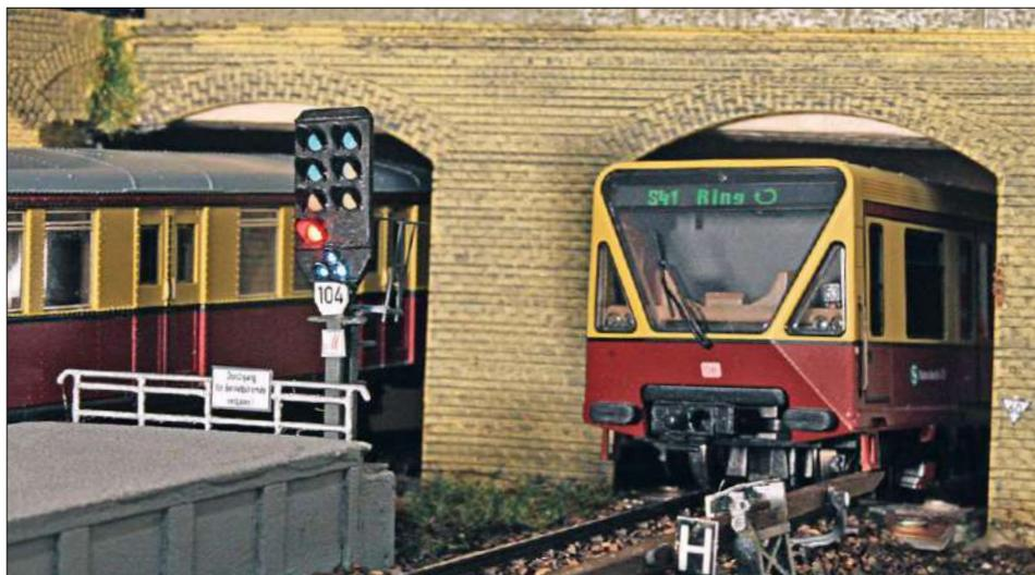
Zu den ersten Lichtsignalen gehörten die Sv-Signale der S-Bahnen in Berlin und später Hamburg. Sie sind auf städtisch geprägten Modellbahnen schon ab dem Ende der Epoche II einsetzbar.
