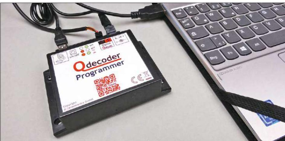
Zur Konfiguration am PC kommt der Qdecoder-Programmer (QD 054) in Verbindung mit der PC-Software Qrail zum Einsatz. Das Programmiertool wird über den USB-Anschluss mit dem PC verbunden.
