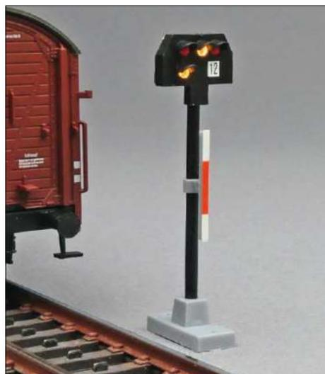
Schutz- und Sperrsignale gelten für Zug- und Rangierfahrten. Über die zwei aufsteigenden weißen Lichter zeigt das Lichtsignal hier den Begriff Sh1 an. Im Bahnbetrieb der DB entspricht dies der Aufhebung des Fahrverbotes.
