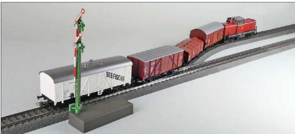
Da die Einfahrt in den Bahnhof sowohl über den geraden als auch über den abzweigenden Strang der Weiche erfolgen kann, sind bei diesem Einfahrtsignal drei Signalbegriffe notwendig. Das Märklin-Formsignal besitzt zwei ungekoppelte Flügel und kann somit Hp0, Hp1 und Hp2 signalisieren.
