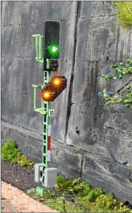
Licht-Blocksignal mit Vorsignalschirm am gleichen Mast. Das Vorsignal zeigt an, dass am nächsten Hauptsignal Hp0 zu erwarten ist.
