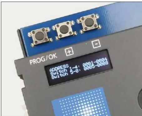
Das vierzeilige OLED-Display und die drei eingebaute Tasten dienen der Konfiguration.
