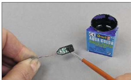
Vor der Montage von Signalschirm und Mast wird die Rückseite der Platine geschwärzt.
