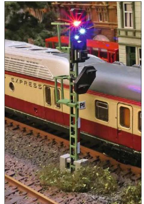
Bei rotem Licht am Hauptsignal wird das Vorsignal am Mast automatisch dunkel getastet.
