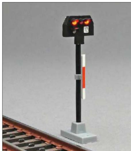
Zwei parallel angeordnete rote Lichter standen bis zum Ende der Epoche V für Sh0 (Halt! Fahrverbot). Danach wurde der Begriff offiziell bei den Licht-Sperrsignalen abgeschafft und durch den Hauptsignalbegriff Hp0 ersetzt.
