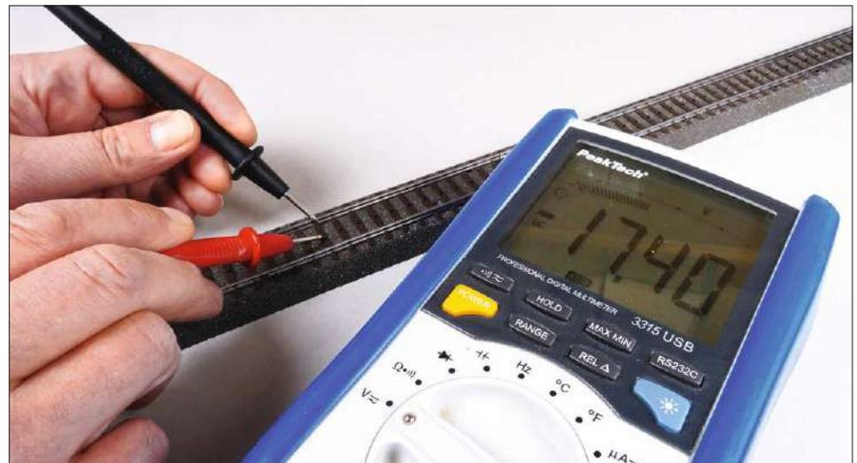
Da die Gleichspannung am Mittelleiter gegenüber der linken und rechten Schiene negativ gepolt ist, spricht man bei diesem Bremsverfahren von einer negativen Gleichspannung oder in der Modellbahnpraxis auch von der „Märklin-Bremsstrecke“.
