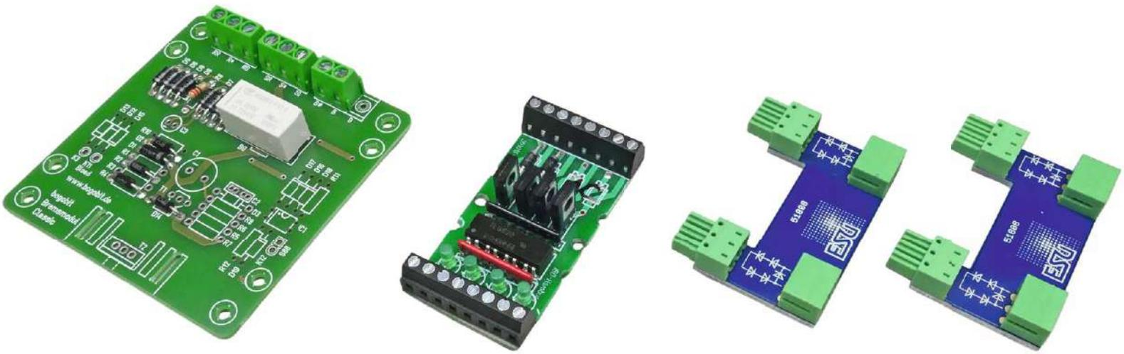
Links und in der Mitte die beiden ABC-Bremsbausteine von bogobit und dem Ingenieurbüro Duncker. Rechts der ABC-Bremsstreckenadapter von ESU.
