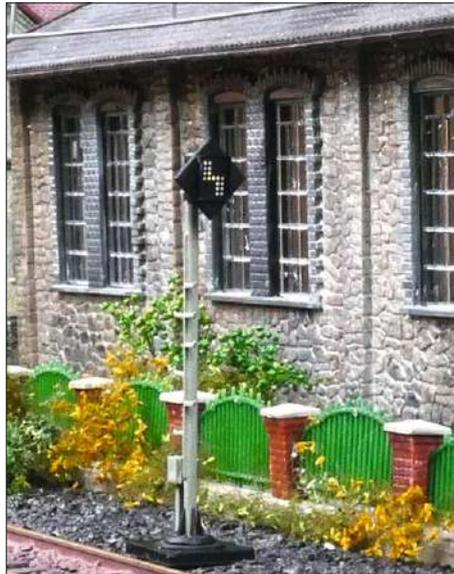
Wenn der Fahrweg in das Streckengleis entgegen der gewöhnlichen Fahrtrichtung führt, wird dem Lokführer dies mit dem Gegengleisanzeiger Zs6 (hier von Alphamodell) signalisiert.
