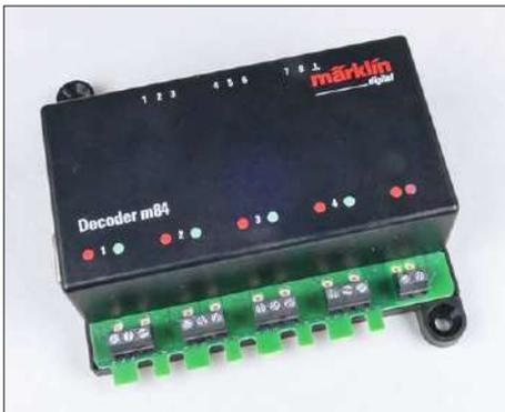
Mit dem Digitaldecoder m84 ist auch ein digitaler Betrieb der Start up-Lichtsignale möglich.
