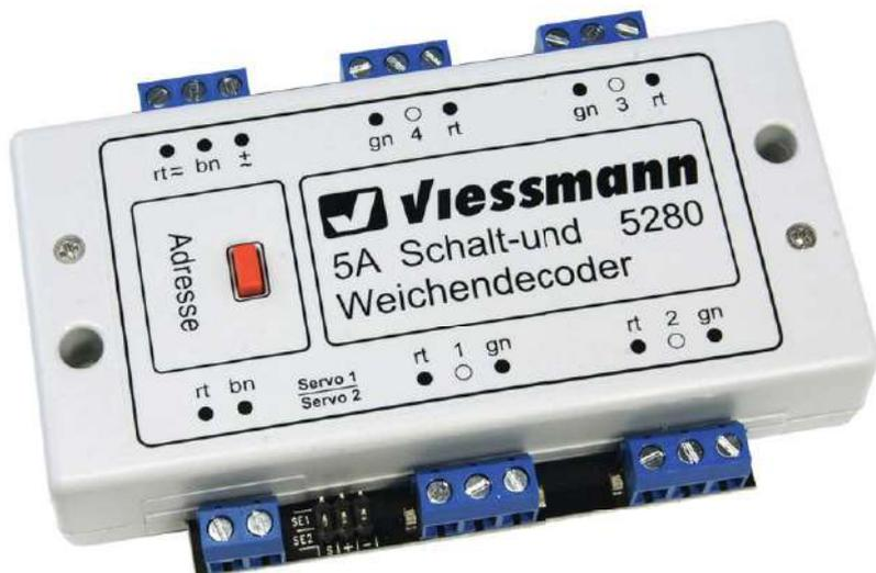
Der digitale Schalt- und Weichendecoder 5280 von Viessmann erlaubt den Anschluss von bis zu vier Signalen mit Doppelpulsenantrieben. Zusätzlich sind auch noch zwei Servos ansteuerbar.
