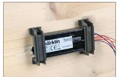
Geschafft! Das Signal ist fertig unter der Grundplatte montiert. Wenn die DIP-Schalter später nicht mehr zugänglich sind, muss das Signal vor der Montage konfiguriert werden.
