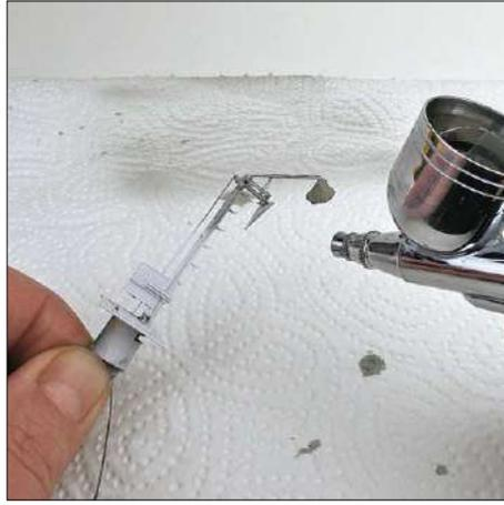
Nach dem Grundieren erhält das Signal mit der Airbrushpistole einen mattgrauen Überzug.
