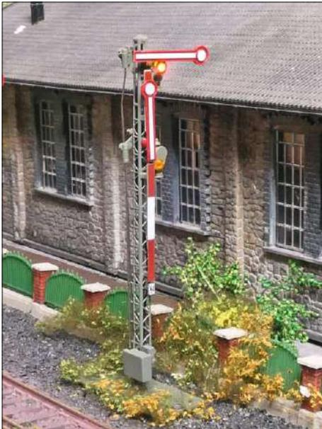
Das Signal Hp0 zeigt an, dass der anschließende Gleisabschnitt nicht befahren werden darf. Der Haltebefehl gilt für Zug- und Rangierfahrten und wird über den (oberen) waagrecht stehenden Flügel und ein rotes Licht angezeigt.
