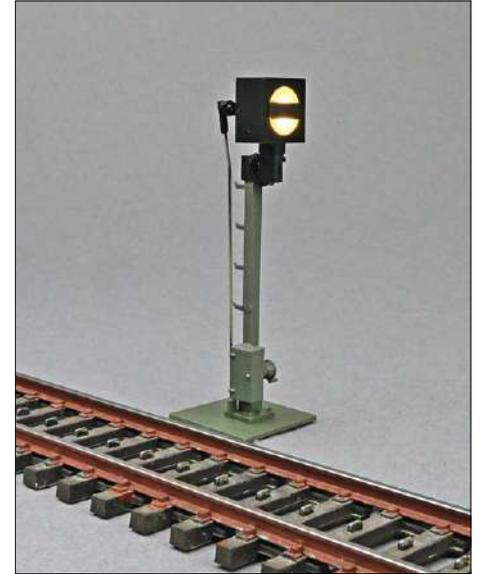
**Der waagerechte schwarze Streifen deutet auf den Befehl Sh0 und auf ein Fahrverbot hin.**
