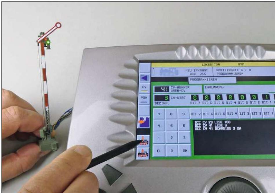
Nach dem Auspacken des Viessmann-Formsignals sollte dieses zunächst konfiguriert und programmiert werden. Am einfachsten gelingt das über die CV-Programmierung mit einer geeigneten Digitalzentrale. Über CV41 wird beispielsweise der Nachwippeffekt des Signalfügels aktiviert.
