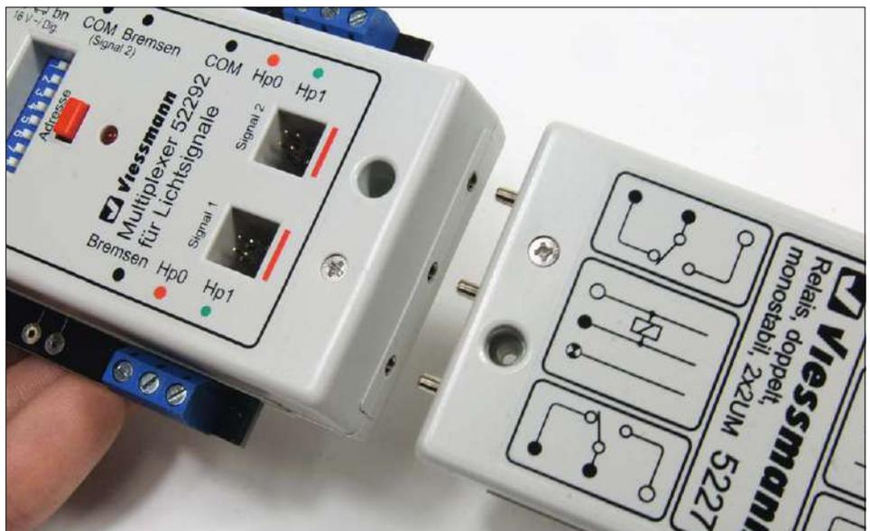
Der Doppel-Multiplexer bringt keinen Anschluss für den Signalbus mit. Trotzdem lassen sich auch hier auf der rechten Seite Zusatzbausteine, wie z.B. das Doppelrelais 5227 zur Zugbeeinflussung durch die angeschlossenen Hauptsignale anschließen bzw. einfach anstecken.
