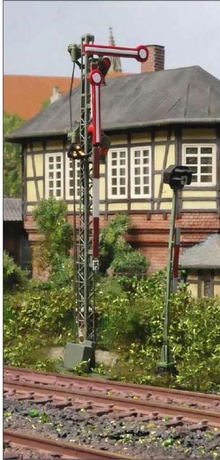
Ersatzsignal Zs1 mit drei LEDs von Ebert, hier nachgerüstet an einem Form-Hauptsignal von Viessmann. Bei leuchtendem Zs1 darf der Lokführer an dem gestörten Hauptsignal ohne schriftlichen Befehl vorbeifahren.
