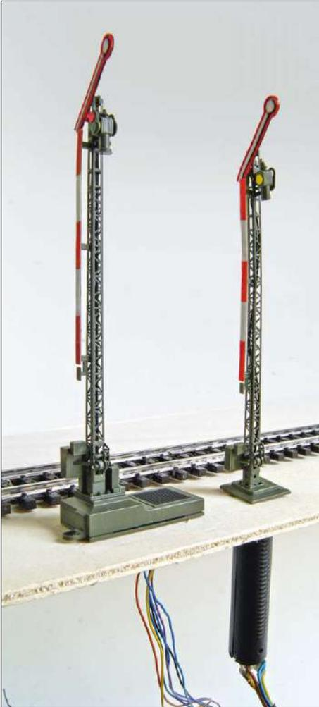
Die neue Signalgeneration von Viessmann (links) kommt ohne langen Antrieb aus und erfordert dadurch wesentlich weniger freien Einbauraum unter der Anlagenoberfläche.
