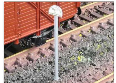
**Die Rangierhalttafel Ra10 steht in der Regel links vom Gleis. Über diese Tafel hinaus darf nicht rangiert werden, da die Rangierabteilung sonst in den Durchrutschweg des Einfahrsignals geriete.**
