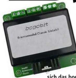
Die bogobit-Classic Bremsbausteine benötigen zum Abbremsen mit Gleichspannung nur einen einzigen isolierten Gleisabschnitt vor dem jeweiligen Signal (oben).
