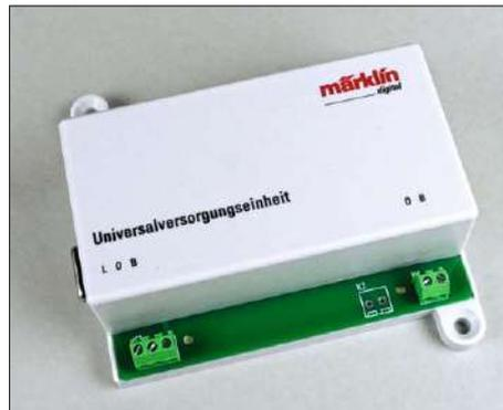
Zur externen Stromversorgung mit einem Netzteil ist die Universalversorgungseinheit nötig.
