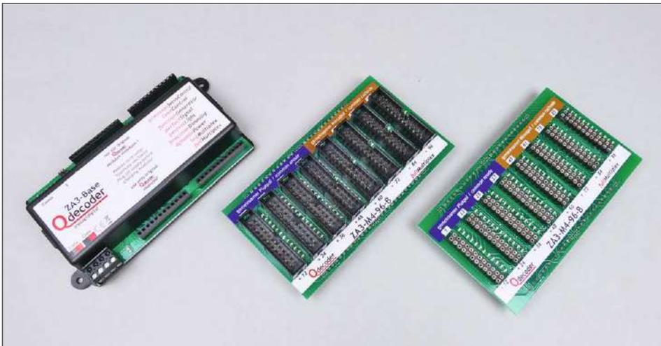
Der Qdecoder ZA3 ist als Huckepack-System konstruiert. Auf ein Basismodul ZA3 Base lassen sich verschiedene Zusatzmodule mit unterschiedlichen Steuerungsmöglichkeiten stecken.
