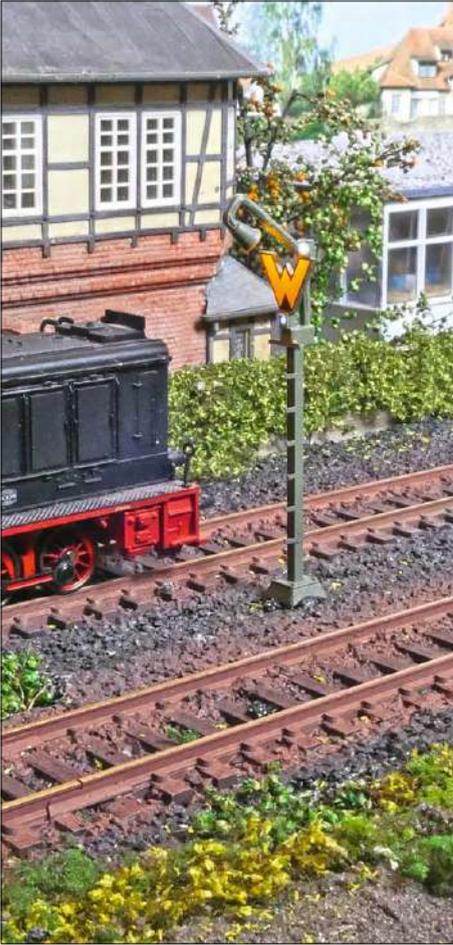
Am Wartezeichen Ra11 darf erst vorbei gefahren werden, wenn eine offizielle Zustimmung des Weichenwärters vorliegt. Diese wurde bei dem Viessmann-Signal 4519 gerade durch die Signalisierung vom Lichtsignal Sh1 gegeben.
