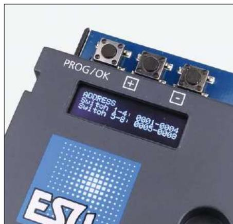
Zur Konfiguration und Funktionskontrolle bringt der Baustein ein vierzeiliges OLED-Display und drei Programmieretaster mit.
