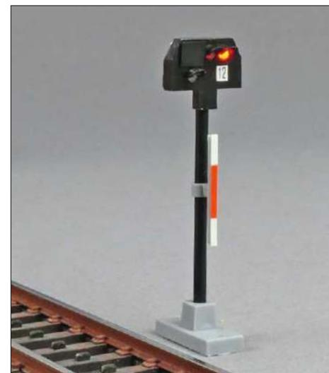
Der neue Signalbegriff Hp0 erfordert für die Epoche VI eine Umstellung der Licht-Sperrsignale auf ein einzelnes rotes Licht. Im Original wurde dies durch Abdecken der linken Laterne mit einer kleinen Blende erreicht.
