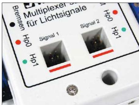
Beim Doppel-Multiplexer 52292 sind zwei unabhängige Hauptsignale anschließbar.
