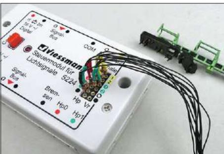
Der Signaldecoder 5224 besitzt zum Anschluss der Lichtsignale an der Oberseite eine Vielfach-buchse, die Drahtenden bzw. Anschlussdrähte von Widerständen und Dioden aufnimmt.
