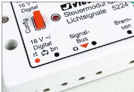
Über den Signalbusanschluss wird nicht nur das Vorsignal am funktional zuvorstehenden Haupt-signal bedient, es wird gleichfalls die Block-streckenfunktionalität gesteuert.
