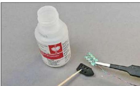
Nachdem die Signalschirme lackiert wurden, können die LED-Platinen eingeklebt werden.
