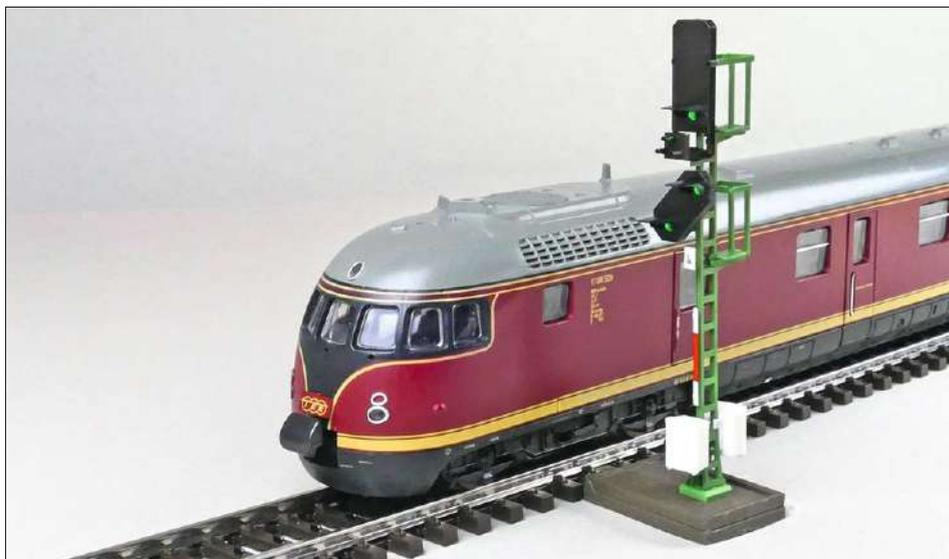
Wenn sich das Vorsignal am Mast eines Hauptsignals befindet, zeigt es den Signalbegriff des nachfolgenden Hauptsignals an. Es muss daher zusätzlich auf dessen Adresse programmiert werden.
