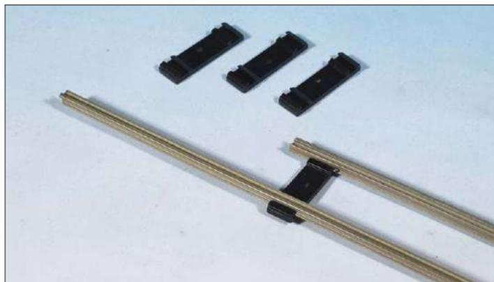
Die Verbindung zwischen normalen Schienenprofilen und Rillenschienenprofilen ist nicht einfach. Dafür muss ein herkömmlicher Verbinder umgebaut werden. Dessen Hälfte unter dem Rillenprofil muss zum Auflöten eine ebene Fläche bilden.
