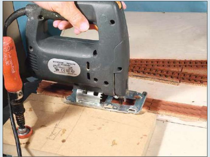
Die Wasserfläche wird abgetrennt. Da das Kaigleis höher liegt, ist ein Holz untergelegt, damit die Säge frei laufen kann und das Gleis nicht beschädigt.
