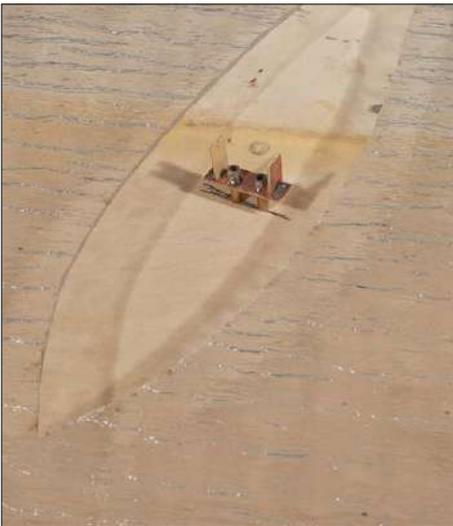
Für die Wippmechanik wird ein Lagerbock eingesetzt. Auf ihm ruht eine Welle, die am Schiffsrumpf befestigt ist. Zwei Messingrohre fixieren die Lage auf der Grundplatte.
