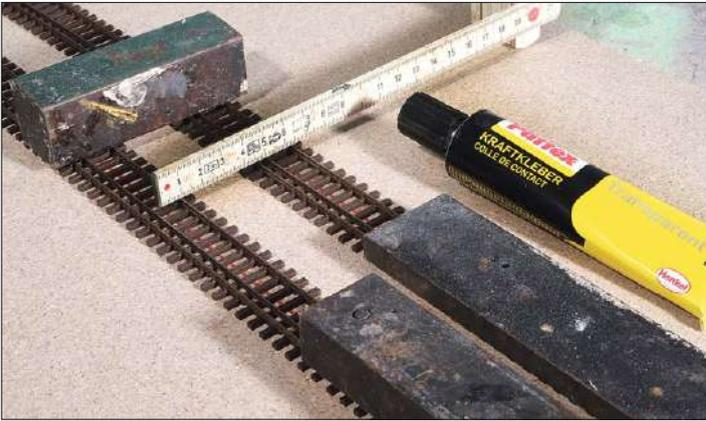
Der Gleisabstand der zwei Zufahrtsgleise muss 56 mm betragen. In diesem Abstand werden die Schwellenroste aufgeklebt.
