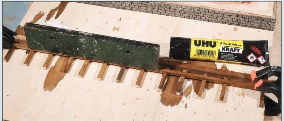
Die Leisten zur Nachbildung der Balken an der Kaimauer werden mit Beize im Farbton „Nussbaum“ getränkt. Bei der Montage der Quer- und Stützbalken dient die Mauerkante als Anschlag. Im Abstand der senkrechten Stützen erhält der querliegende Verbindungsbalken Einschnitte. Bis zur Hälfte des Querschnitts fügen sich dort die Stützbalken passgenau ein, auf diese Weise ergibt sich eine stabile Verbindung der Holzteile.
