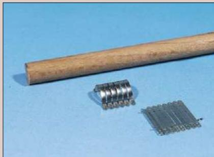
Als Biegeschablone nutzt man die Rundhölzer. Die Schellenenden werden mit der Flachzange gebogen. Es ist ratsam, alle Schellen am Stück zu bearbeiten. So springt kein Ätzteil davon.
