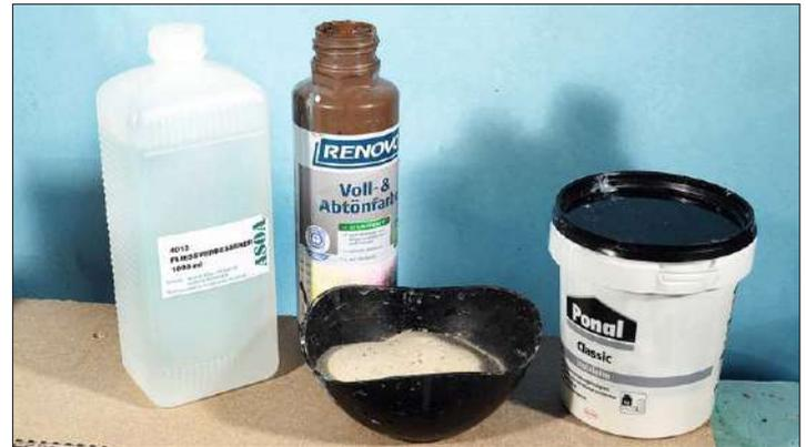
an die Reihe. Eins ist jetzt schon wichtig: Die Styrodurabschnitte müssen gegen eine Reaktion mit dem später einzufüllenden Gießharz geschützt werden. Es würde sonst den Schaumstoff auflösen. Dazu streicht man ein Gemisch aus Dispersionsfarbe und Weißleim auf den Schaumstoff und bestreut die nassen Flächen mit Sand. Später kann diese Schicht mit einer zusätzlichen Tränkung von verdünntem Weißleim und Spülmittel weiter
