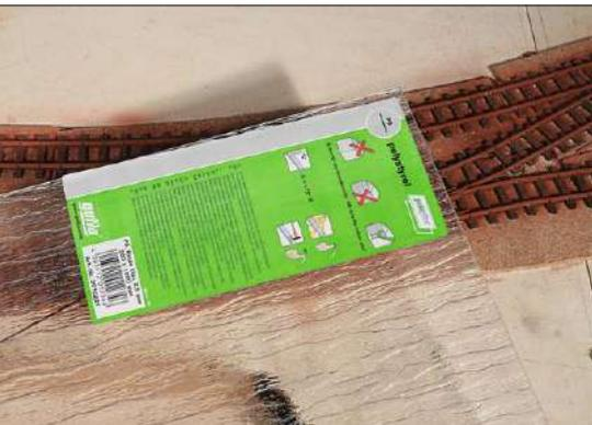
Eine Kunststoffplatte von Gutta weist eine realistisch wirkende Wellenstruktur für die Wasserfläche auf. Die Kunststoffplatte wird am besten mit einer Trennscheibe ausgeschnitten, denn ein Laubsägeblatt verklebt beim Sägen zu schnell.
