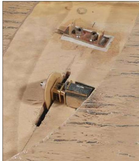
Davor liegt der Getriebemotor mit dem Exzenter. Dieser hebt und senkt den Schiffsrumpf, womit das Schaukeln auf den Wellen dargestellt wird.
