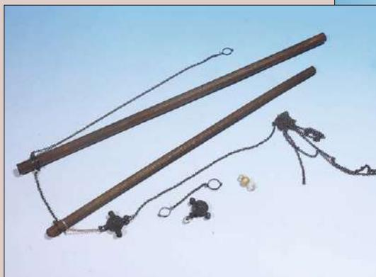
Rechts der fertige Ladebaum. Es muss nur noch die Kette durch die Flaschen geführt werden.
