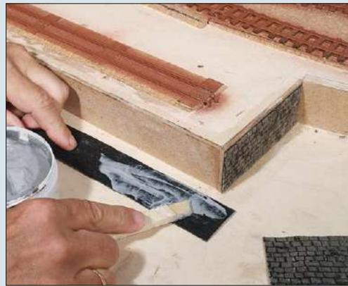
Für die Mauerbereiche werden Brettchen zugeschnitten, sie dienen als stabile Unterlage für die Steinfolien von CH-kreativ zur Nachbildung des Mauerwerks. Auf die Folienabschnitte wird der Kleber „Flex Glue“ aufgetragen, sie brauchen danach nur leicht angedrückt zu werden.
