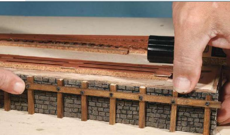
Der Balken für die Mauerkante ist oben angelegt. Die Stützen werden eingeschoben und mit Sekundenkleber fixiert. Die Darstellung der Verschraubungen ist ein wirkungsvolles Detail. Dazu wurden Stifte aus 1-mm-Rundmaterial in Bohrungen eingesetzt. Kleine Plättchen, die aus 1000er-Schleifpapier zugeschnitten wurden, dienen zur Nachbildung der Unterlagsplatten. Abschließend wird das komplette Bauteil vor die Kaimauer geklebt.
