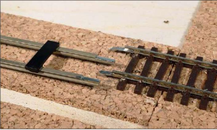
Die gegenüber dem Roco-Profil viel höheren Rillenprofile müssen am Schienenfuß befeilt werden.
