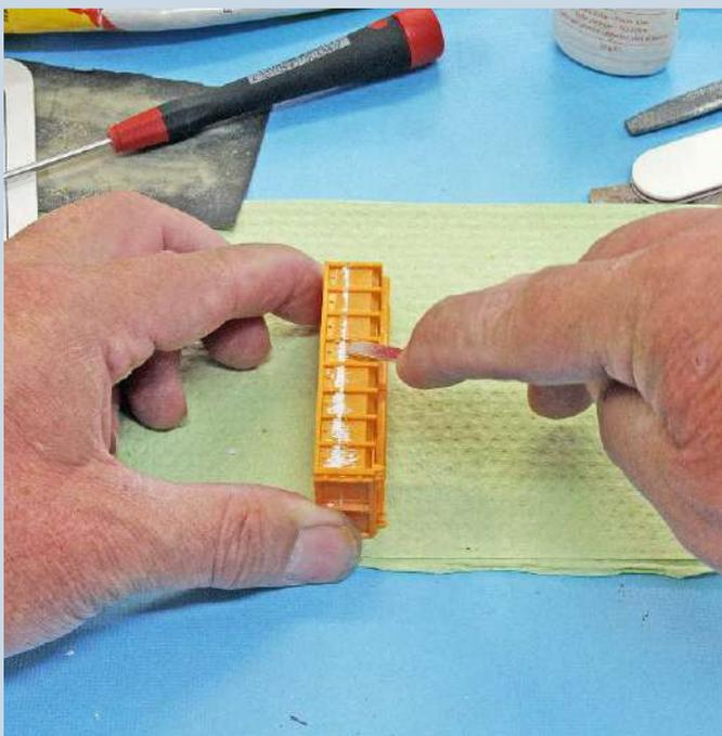
Eine der großen Kibri-Container wird in der Höhe reduziert. Die geschnittenen Teile müssen plan geschliffen werden.
