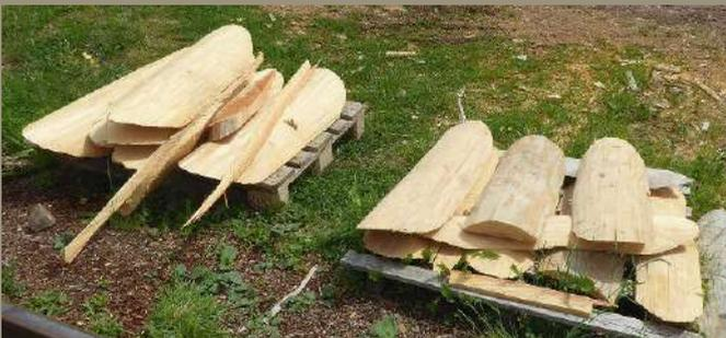
Oben: Die mit der Kettensäge herausgetrennten Stammstücke werden zur Weiterverwendung auf Paletten gesammelt. Als sauberes Vollholz können sie z. B. gehäckselt und zu Pressspanplatten weiterverarbeitet werden.
