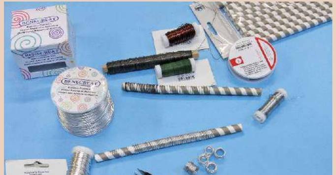
Die Wicklungsprobe ergab fast durchgängig eine zu große Widerstandigkeit der Metalldrähte, die umso stärker war, je dünner der Draht war. Einzig der Aluminiumdraht behielt halbwegs seine Form.
