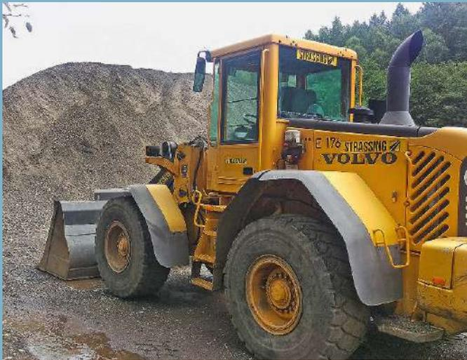
Radlader, hier eine modernere Ausführung, bilden einen unabdingbaren Bestandteil des Areals. Sie schichten das Material um, schieben es zusammen, bringen es zu den Schreddern oder laden weiterverwendbare Körnungen auf Lkws.
