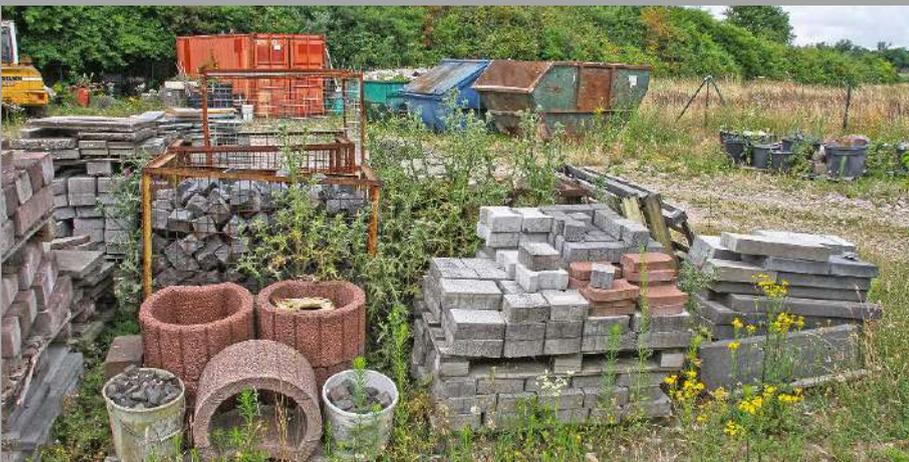
In Gitterboxen werden Basaltpflastersteine aufbewahrt – ein heute teurer Werkstoff, der nicht mehr so oft aufzufinden ist. Massenware hingegen sind die auf Paletten abgelegten Kunstpflastersteine, Betonkübel und Randsteine.
