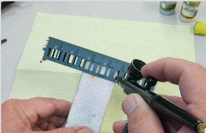
Der entkernte Waggonkörper wird umgedreht auf einen entsprechend dicken Styroporklotz geklemmt. Dieser muss eine ausreichende Haftung beim nachfolgenden Sprühen gewährleisten. Da der ganze Wagen dabei in alle Richtungen gedreht wird, ist ein fester Sitz unabdingbar. Mit sog. „Fading Agents“ erhält der Wagen nun einen ausgeglicheneren Farbüberzug und wirkt dadurch etwas heller.
