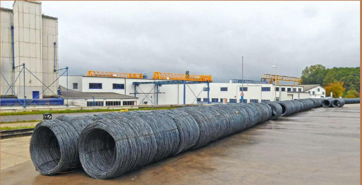
Entlang des Zufahrtgleises lagern die angelieferten Metalldrahtringe auf der Betonfläche. Die mehrfach gewickelten Bündel von 1,50 bis 1,80 m Breite werden durch Eisendrahtbindungen zusammengehalten. Dies muss man auch im Modell so gestalten.
