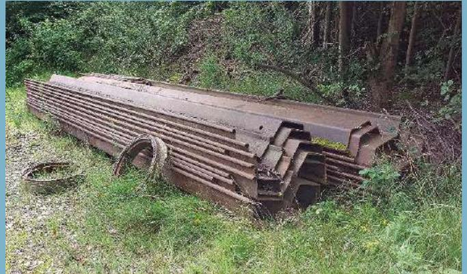
Diese Spundwandteile, die fein säuberlich aufeinandergesetzt abgelegt wurden, stellen einen Teil der auf dem Gelände gelagerten Baumaterialien dar. Sie harren sicherlich einer weiteren, sinnvollen Verwendung.
