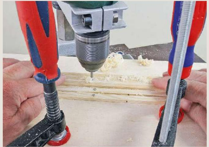
In einer doppelten Führungsschiene wird das Rundholz eingebettet und entlang einer weiteren Längsführung unterhalb des Kugelfräsers entlanggeführt. So ergibt sich eine Hohlkehle.
