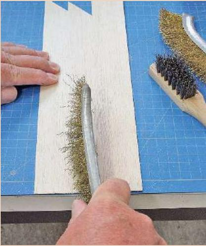
Für die Wandverschalung des Bansen wird 2 mm Balsaholz mit einer Drahtbürste in Faserrichtung aufgeraut. So entstehen die Riefen alter Holzbalken.
