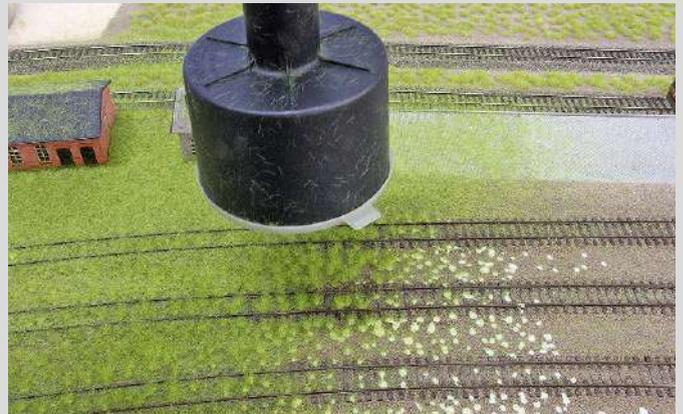
Mit einem Maag-Elektrostaten – bestückt mit dem großen Vorratsbehälter – trägt man nun die 6 mm hohen GrASFasern bei höchster Feldspannung auf. So stehen sie optimal aufrecht. Nach dem Trocknen des Leims wird die Fläche abgesaugt.
