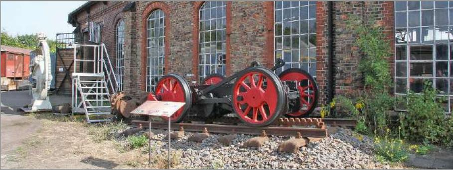
An der Rückwand des Ringlokschuppens findet man weitere Fragmente von Fahrzeugen wie diesen Zahnradwagen einer Baureihe 97.2, die auf der steirischen Zahnradbahn von Vordernberg nach Eisenerz in Österreich zum Einsatz kam.
