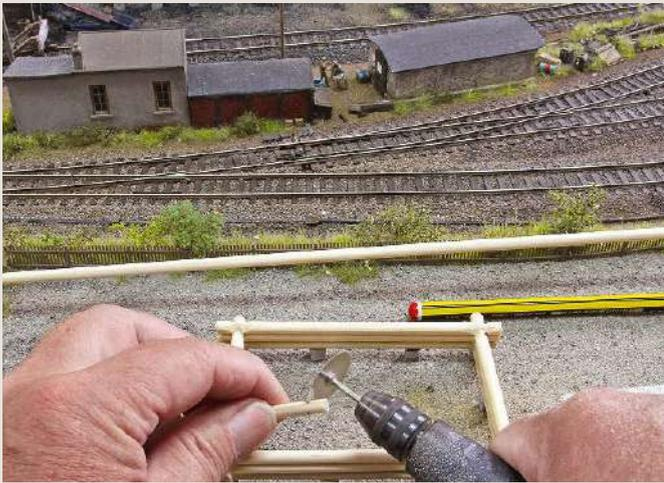
Die vorgekerbten Rundhölzer erhalten beim Einbau mittels einer Kleinbohrmaschine und eines feingezahnten Sägeblattes passgenaue Einschnitte für die Eckverbindungen.
