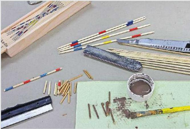
Aus Schaschlikspießen, Mikadostäbchen o.Ä. entstehen die Zaunpfosten in leicht unterschiedlicher Länge. Die einseitig angespitzten (angeschliffenen) Hölzer werden noch mit einer leicht verdünnten Holzfarbe angemalt.
