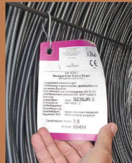
Die korrekte Fachbezeichnung für den „Walzdraht“ ist warmgewalzter Draht in Ringen. Die Stärke von 7,5 mm beim Vorbild würde eine entsprechende Drahtstärke von umgerechnet 0,086 mm bedeuten. Im Modell nicht zu realisieren!
