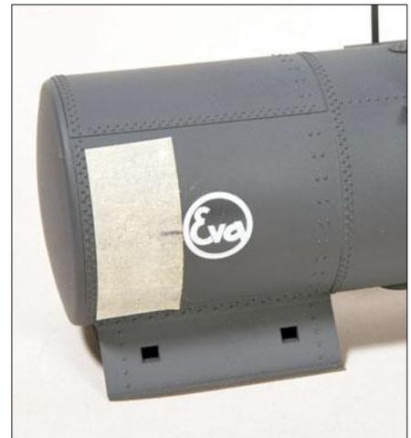
Mithilfe eines in der Breite passenden Malerkreppstreifens lassen sich die Logos auf dem Kessel an der gleichen Stelle positionieren.
