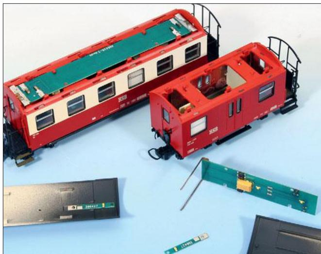
Tillig bietet für seine Wagen Beleuchtungssätze an. An diesen müssen nur die Anschlussbahnen umgebogen und die Platinen von oben in die vorbereiteten Wagenkästen gesteckt werden. Die Bühnen der Wagen werden ebenfalls mit kleinen LED-Platinen beleuchtet. Diese sollte man unter den Dächern ankleben.
