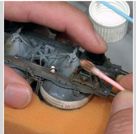
Die Räder werden in die passenden Öffnungen einer Holzleiste gesetzt und durchgängig mit einem dunklen Rostton eingesprüht. Gleich im Anschluss reinigt man die Spitzen der Achsstummel und die Laufflächen mit Wattestäbchen und Airbrush-Reiniger.
