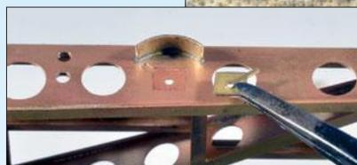
Und nu? Die Seitenwände wurden gespiegelt, die Bremsumsteller nicht. Zur Behebung des Malheurs wurde der Umstellerahmen durch Feilen freigestellt und mit einem kleinen Blechstück gefüllt.
