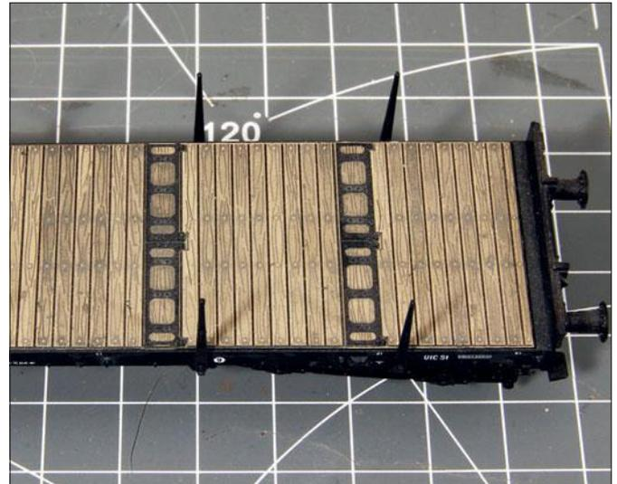
An dem Flachwagen von Roco erkennt man an der Holzmaserung die Wirkung von etwas Farbe. Der Holzboden präsentiert sich mit einer filigranen Zeichnung und einer dezenten Alterung. Beim Farbauftrag ist ein Verschmieren der Farbe auf andere Bereiche zu vermeiden.
