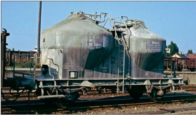
Die Zementsilowagen der DR mit ihren flacheren Aufbauten traf man häufig mit einem entsprechenden „Knaster“ an festgebackenem Zementpulver auf der Oberseite an. Dadurch waren auch die streifigen Spuren des heruntergelaufenen Staubes deutlich ausgeprägter.
