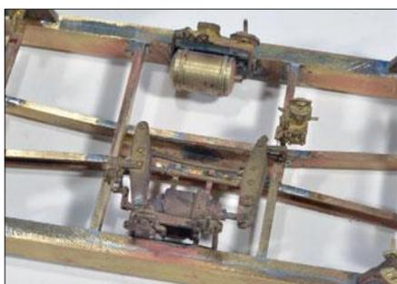
Rechts: Die Bremsklötze stammen von Weirner. Die Messingussteile lassen sich gut biegen und so der Lage der Radlauflächen anpassen. Die neuen Radsätze kommen von Schnellenkamp, da die ursprünglichen Radsätze wegen geschrumpfter Radscheiben (Kunststoff) unter losen Radreifen litten.
