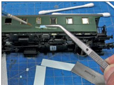
Rechts: Die bei den als Güterzuggepäckwagen so häufig anzutreffenden beschädigten Fenster lassen sich mit einem Kegelfräser nachbilden. Sowohl Löcher als auch Risse können auf diese Weise hergestellt werden.
