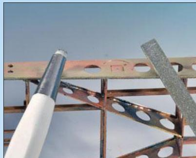
Ist das Seitenblech fertiggelötet, sollte die Unterkante mit einer Feile geglättet werden. Falls Lot wegen der direkten Zuführung von der Spule auf die Außenseite gelangt sein sollte, hilft ein Glasradierpinsel beim Säubern der Messingflächen.
