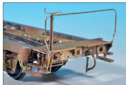
Auf der Unterseite der Bremserbühne ist die Lage der Bremswelle zu erkennen. Die Trittstufen stammen von O-Problemo.
