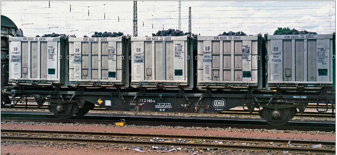
Dieser Lbms 589 (BTmms 58) hat fünf Stände für Mittelcontainer, hier die offene Bauart Eoskrt mit 10,2 m<sup>3</sup> Fassungsvermögen für witterungsunempfindliche und spezifisch leichte Güter wie Koks, Ziegelsteine, Dachziegel, Stempelholz oder Schrott. Der Containerkörper hatte senkrechte Wände, die Stirnwände waren aushebbar und nach oben und unten klappbar.
