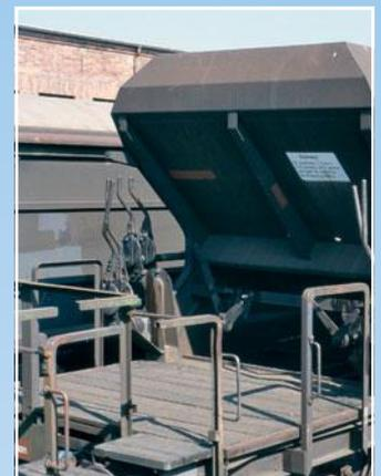
... eines Schüttgutwagens, dessen Entladeschieber von der Stirnbühne aus bedient werden.
