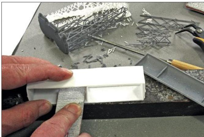
Leider passte das bearbeitete Dach nicht exakt auf den Wagenkasten. Dessen Wandstärke musste deutlich dünner geschliffen werden. Er wird daher auf einer stabilen, erhöhten Unterlage platziert und entsprechend bearbeitet. Dieser Arbeitsschritt soll bei künftigen Bausätzen entfallen können.
