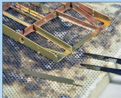
Dann wird Lötlösung entlang der Fuge aufgepinselt. Nur dort, wo Lötlösung seine Wirkung entfaltet, fließt später das Lötzinn hin.
