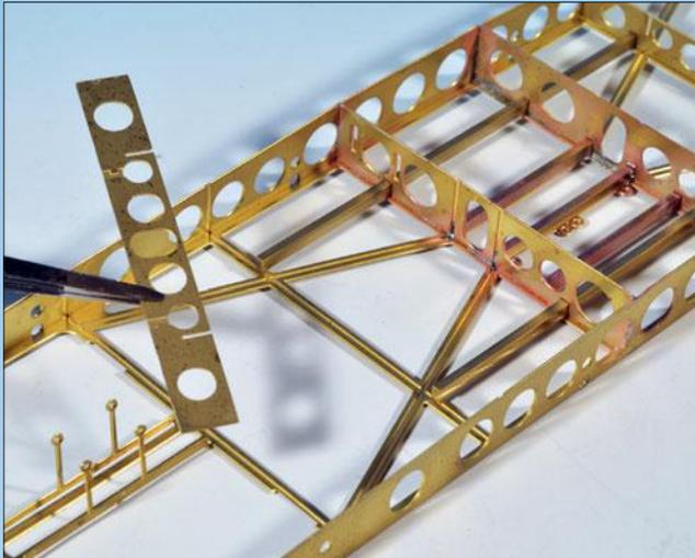
Es ist Konzentration erforderlich, um alle Bauteile in der korrekten Position einzubauen. Hier ist beispielhaft Spant (15) zu sehen, der unterschiedliche Aussparungen für die diversen U-Profile zeigt. Bevor er nicht eingebaut ist, sollten die Profile auch nicht festgelötet werden.
