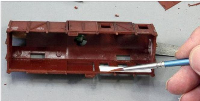
Beim Heraustrennen des zweiten Leerfeldes sollten die Schnitte mit dem Metallsägeblatt dagegen etwas knapper ausfallen, kreuzförmige Schnitte erleichtern das Herausbrechen der Dreiecke. Danach werden die Kanten exakt beschliffen, bis das Fensterteil genau hineinpasst.
