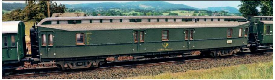
Links: Die Bauart Post4-ü/20 (hier das Modell von Roco) entstand beim Vorbild in den 1920er-Jahren in Stahlgerippe-Bauweise und basierte auf den „Hechtwagen“.
