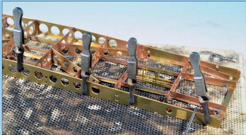
Zum Verlöten der großen Seitenbleche braucht man mehr Energie. Hier kommt der große Lötbrenner zum Einsatz. Zuvor sollte man die Bleche exakt deckungsgleich ansetzen (dabei helfen 1,9-mm-Bohrer) und mit Kreuzpinzetten fixieren.
