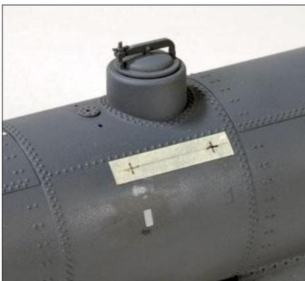
Ein Streifen Malerkrepp dient mit den Markierungen für die Bohrungen der Bühnenzapfen als Schablone.
