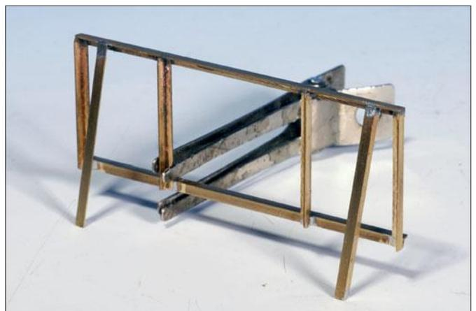
Das am Kessel stehende Geländer erhielt noch zwei schräg angesetzte Messingprofile, die sich später am Rahmen abstützen.
