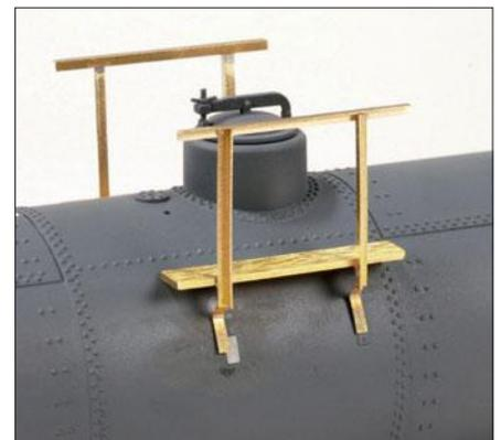
Die Zapfen der Bühne passen in die Bohrungen und halten sie waagrecht. Die Abstützung liegt zunächst lose auf dem Kessel auf.
