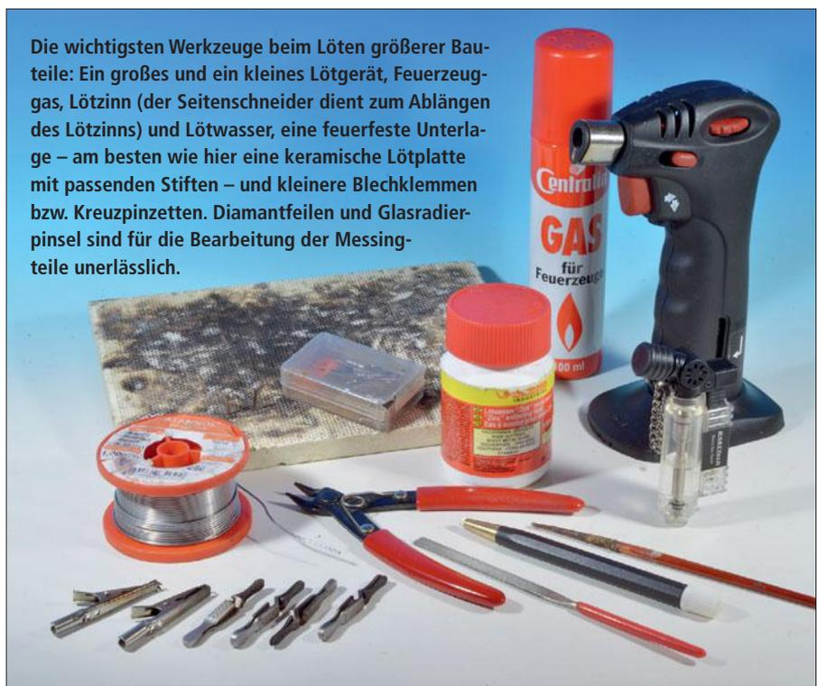
Die wichtigsten Werkzeuge beim Löten größerer Bauteile: Ein großes und ein kleines Lötgerät, Feuerzeuggas, Lötzinn (der Seitenschneider dient zum Ablängen des Lötzinns) und Lötwasser, eine feuerfeste Unterlage – am besten wie hier eine keramische Lötplatte mit passenden Stiften – und kleinere Blechklemmen bzw. Kreuzpinzetten. Diamantfeilen und Glasradierpinsel sind für die Bearbeitung der Messingteile unerlässlich.
