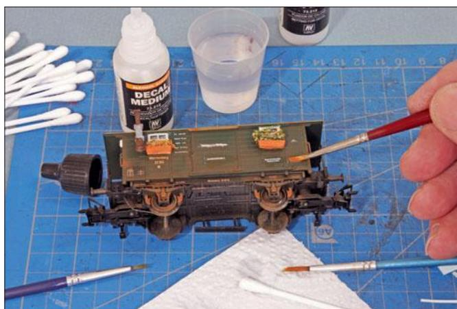
Sitzt das Schiebeschild, wird es angedrückt und mit etwas Softener weicher gemacht, damit es sich besser an den Untergrund anschmiegt.
