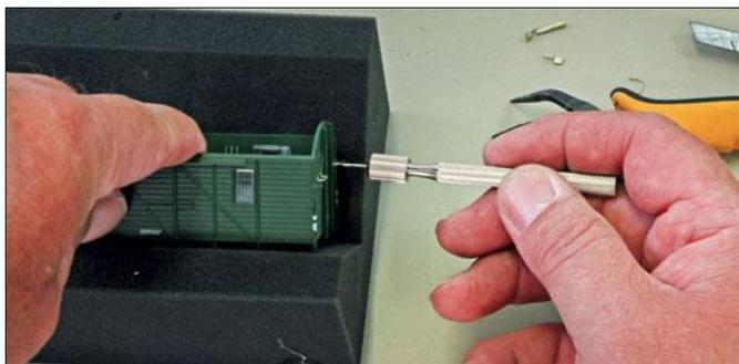
Auf der Stirnseite des Roco-Modells lassen sich noch ein paar Details wie zusätzliche Haltegriffe und Trittstufen anbringen. Die erforderlichen Löcher bohrt man am besten mit einem Stiftenklöbchen.
