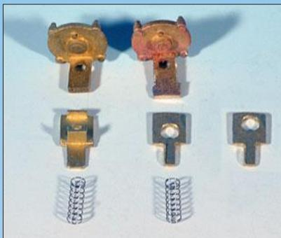
**Spezielle Arbeiten an diesem Bausatz:** Setzt man die Achsen nach Bauanleitung ein, steht der Wagen zu tief – und zwar so deutlich, dass man von außen mit bloßem Auge erkennt: Achse und Achslager liegen in verschiedenen Höhen. Zum Ausgleich wurden vier Blechstücke angefertigt, deren Achslagerbohrung 2 mm höher liegt.
