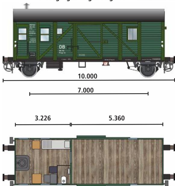
Der Pwgs 44 entstand als Kriegsbauart aus dem gedeckten Güterwagen „Bremen“. Das Zugführerabteil hat eine Grundfläche von 8 m<sup>2</sup>, die Ladefläche hat 14,7 m<sup>2</sup>.
