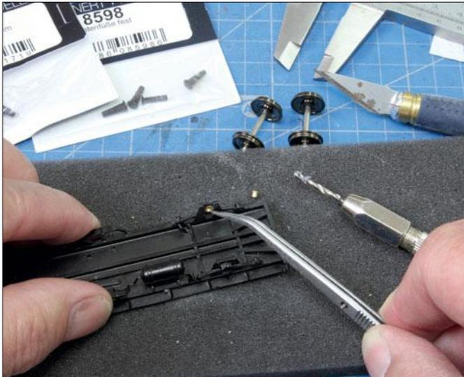
Die Lagerbuchsen sind in die Achslager einzusetzen, ggf. muss das Loch aufgebohrt werden. Beim Einsetzen muss man sehr vorsichtig vorgehen und das Achslager durch leichten Gegendruck sichern.
