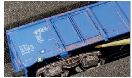
Da das Wasser auf den Ladeflächen unter den Türen hindurch nach außen läuft, treten die Bereiche direkt darunter oft mit rostfarbenen Verlaufsspuren in Erscheinung.
