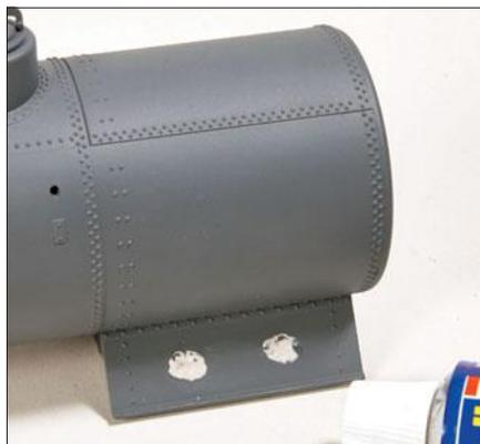
Mit dem Revell-Kunststoffspachtel wurden Vertiefungen aufgefüllt. Zu beachten ist, dass der Spachtel beim Trocknen schrumpft.
