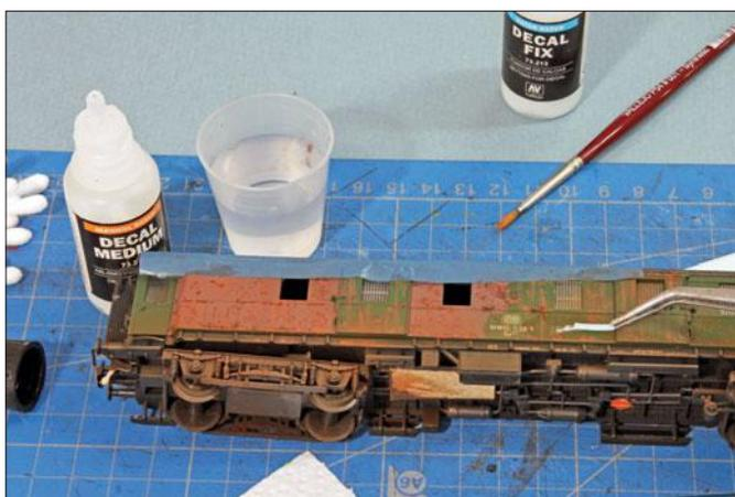
Bei der Beschriftung erfolgt zunächst eine Vorbehandlung mit Decal Fix, dann wird das 10 Sekunden lang eingeweichte Schiebeschild aufgetragen und ausgerichtet.
