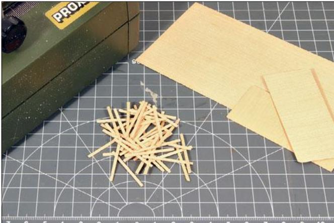
Aus Furnierholz kann man Holzböden von Güterwagen leicht nachbilden. Mit einer Tischkreissäge lassen sich die dünnen Holzstreifen winklig und in der benötigten Länge zuschneiden.
