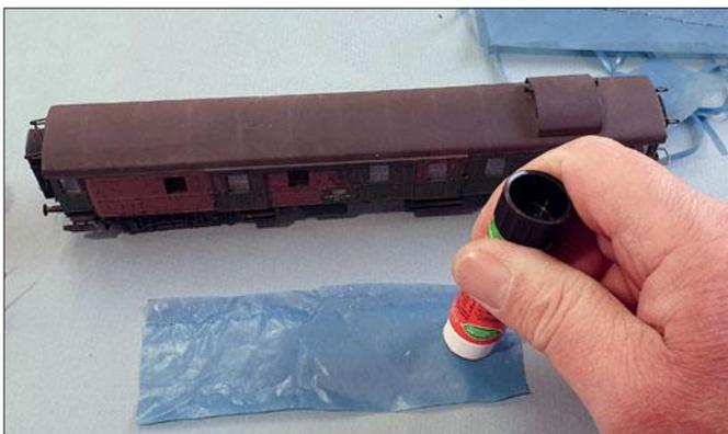
Ein blaues Stück Plastikfolie aus einem Müllsack, passend zurechtgeschnitten, wird mit einem Klebestift eingestrichen und aufgeklebt.
