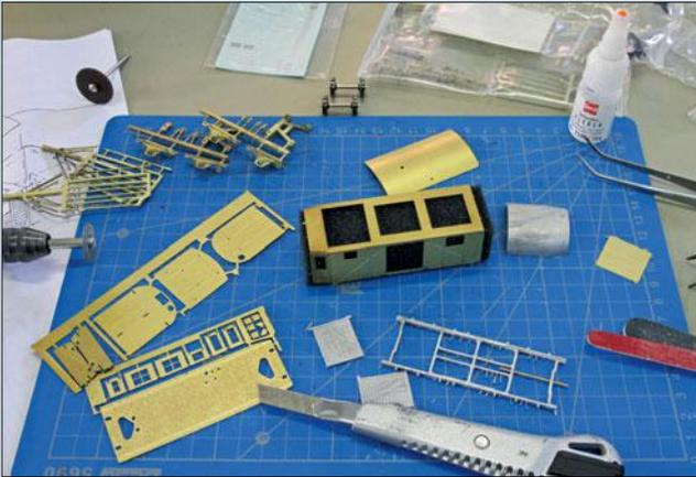
Der Messingbausatz des Pwg pr 14 von Weinert. Der Wagenkasten ist schon abgekantet, ein Schaumstoffkern sorgt für den nötigen Schutz beim Transport. Gussgrate an Weißmetallteilen lassen sich mit Bastelmesser und/oder Feile beseitigen. Messingussteile trennt man besser mit einer Trennscheibe ab als mit einem Seitenschneider.
