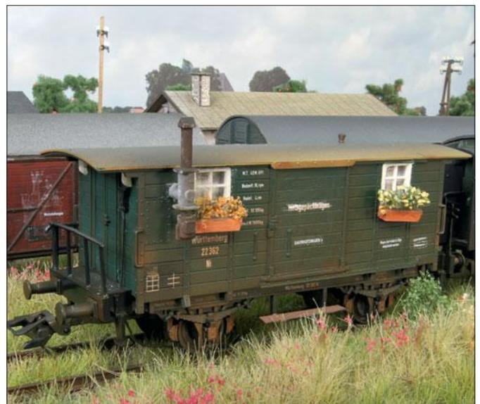
Die beiden ursprünglichen Länderbahngepäckwagen sind nun zu Bahnhofswagen mutiert. Bei dem im linken Bild wurde nur das Aussehen etwas auf alt getrimmt. Der Wagen im Bild oben erhielt Blumenkästen, Lampen über der Bühne, eine Stromzuleitung und einen zusätzlichen Außenkamin.
