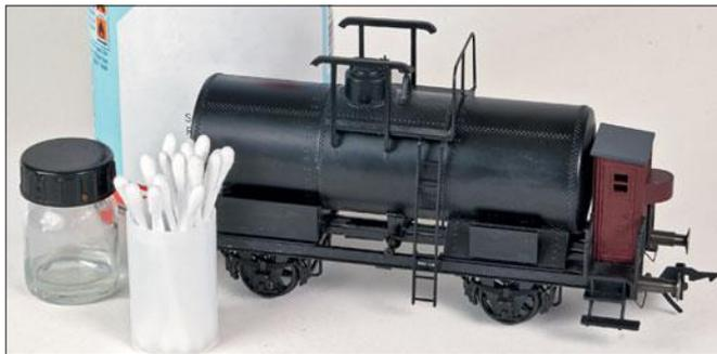
Die Schlitze für die Rastnasen des Bremsenhauses wurden mit Polystyrol verschlossen. Die Maserung wurde noch mit einer Stecknadelspitze eingearbeitet.
