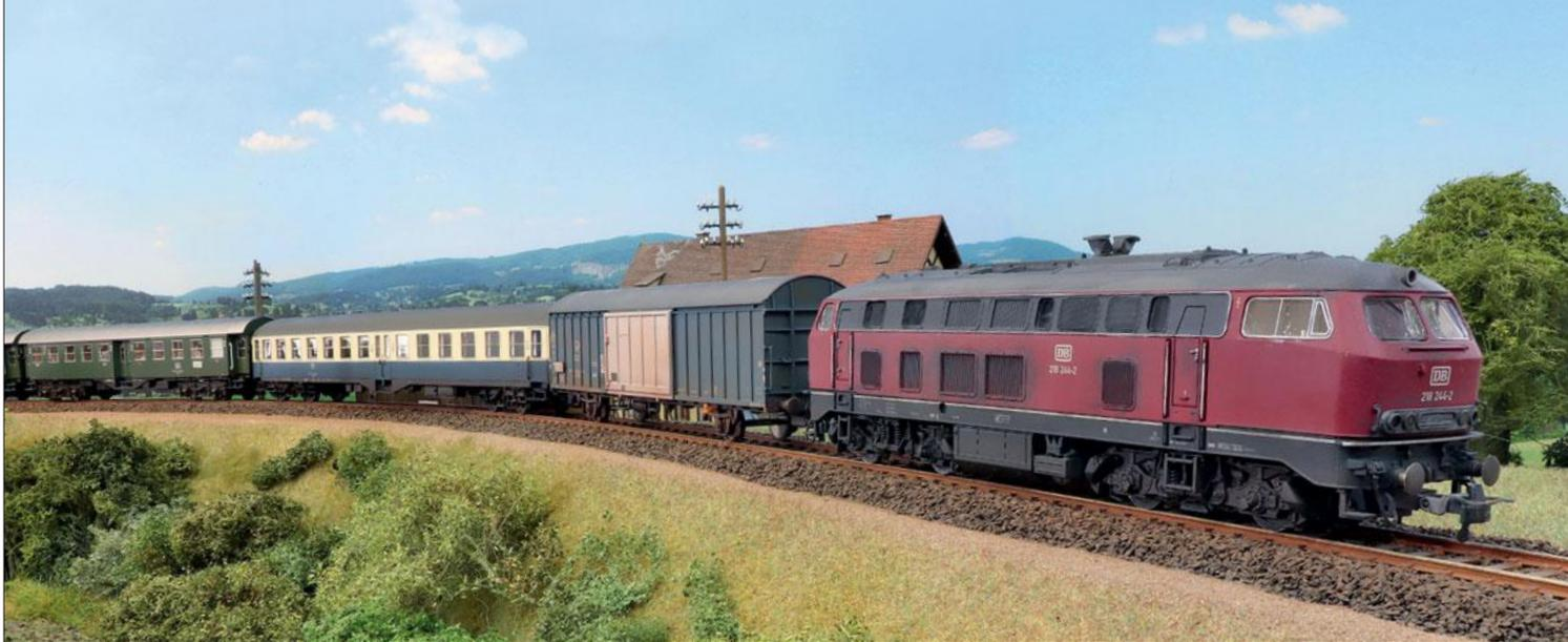
Rechts: Das Epoche-IV-Beispiel im Eilzugverkehr zeigt hinter der 218 einen unbesetzten Paketpostwagen der Gattung Post 2ss-t/15, welche ab 1976 für den direkten Austausch von Paketsendungen zwischen zwei Postzentren ohne Sortierung gebaut wurden. Die zulässige Höchstgeschwindigkeit des Postwagens lag bei 120 km/h.
