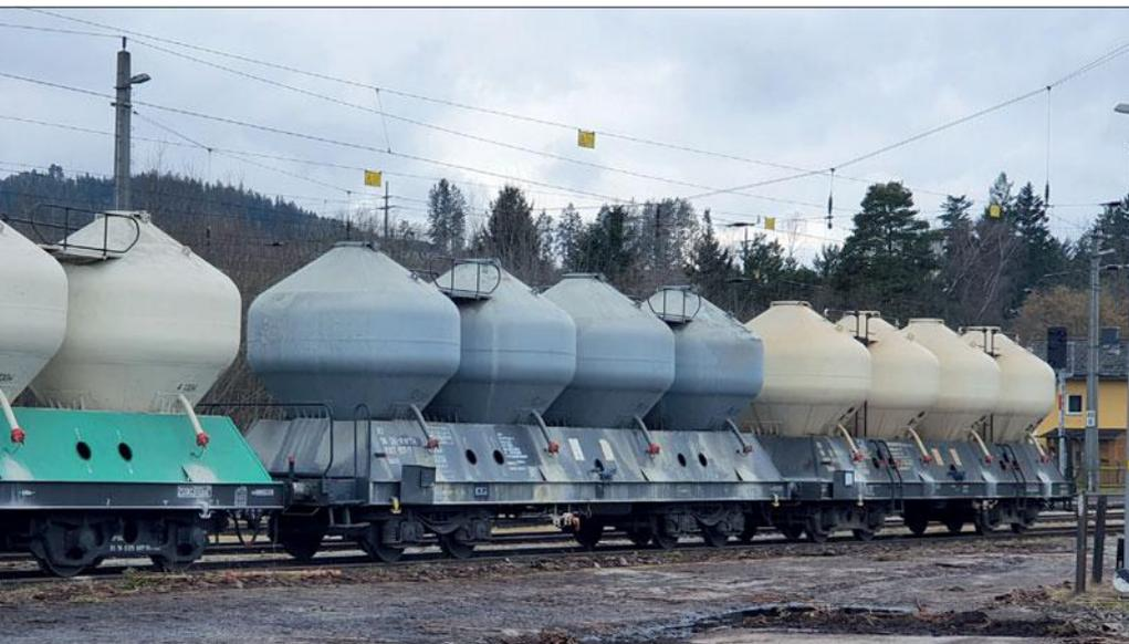
Eine aktuelle Aufnahme zweier slowakischer Uacs zeigt deutliche Zementstaubspuren unterhalb der Schlauchöffnungen.
