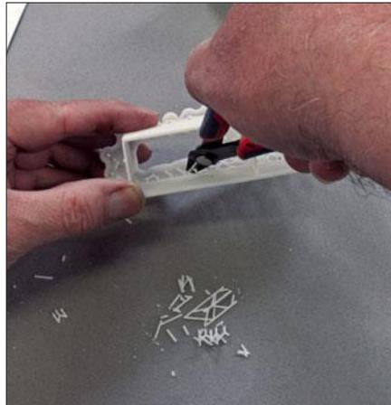
Innen, wo man mit der Säge nicht hinkommt, kann man mit einem scharfen Seitenschneider für Kunststoff die Halter mit genügend Abstand entfernen.
