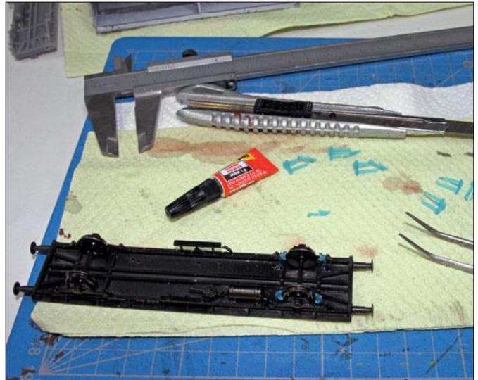
Die Bremsbacken sollte man erst einkleben, wenn die Radsätze eingebaut sind. So kann auf den richtigen Sitz und Abstand geachtet werden. Die Kupplungsaufnahme bzw. -Kinematik fehlt hier noch.
