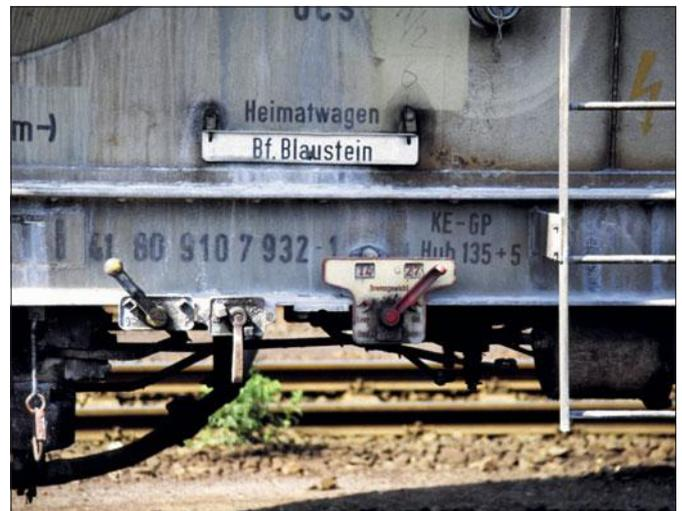
**Kaum zu glauben, dass dieser Staubgutsilowagen mit seinen ausgeprägten Betriebsspuren „nur“ im Zuckerverkehr unterwegs war. Er weist mehr Dreck- und Rostspuren als Reste von angebackener Ladung auf. Aber Zucker ist ja auch stärker wasserlöslich als mineralische Staubgüter.**
