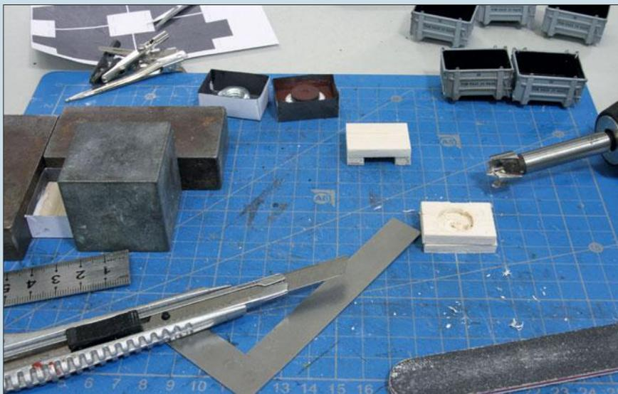
Links: Zwei Lagen 5 mm starkes Balsaholz, entweder flächig aufeinander geklebt oder mit Abstandshölzern verleimt, erhalten mittels eines sog. Forstnerbohrers ein 15 mm breites Bohrloch, in das der Scheibenmagnet eingeklebt werden kann.
