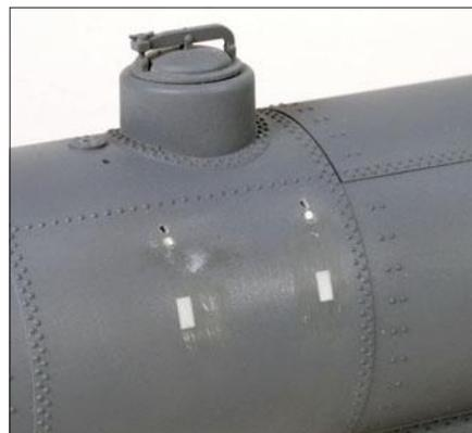
Zu erkennen sind die verschlossenen Öffnungen der alten Bühne und die Bohrungen für die neue Bühne.
