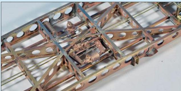
Sind die Bremsbauteile mit allen Leitungen und die Kupplungsfeder mit den Zugstangen eingelötet, kann das abschließende Kreuz des Untergerütes (3) eingesetzt werden.
