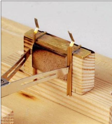
Zum Verlöten der Teile der Arbeitsbühne entstand aus Holzresten eine kleine Lötlehre, denn alle vier Bühnen für die beiden Wagen sollten gleich sein. Zum Fixieren der Pfosten wurden bei einer Metallklammer die Spitzen abgewinkelt.
