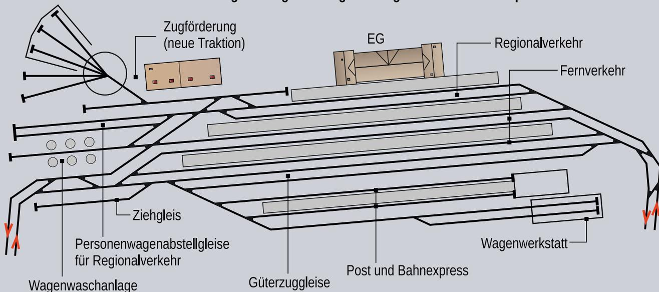
Die Gleisanlagen fallen durch die zweigleisige Streckenführung sehr umfangreich aus. Von den Bahnsteig- und Güterzuggleise gelangt man über eine Sägefahrt zur Wagenwerkstatt. Die Abstellgleise der Personenwagen sind direkt von den Bahnsteiggleisen aus erreichbar und mit einer Waschanlage für Reisezugwagen ausgestattet. Die Bahnhofsbreite schränkt jedoch die Zugriffsmöglichkeiten ein.
