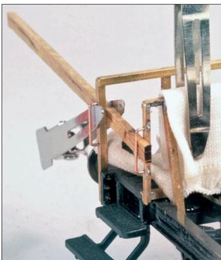
Aus Mangel an passenden Griffstangen im Fundus entstanden die Griffstangen aus 0,6-mm-Messingdraht. Eine Eichenleiste dient als Abstandshalter beim Löten. Auch hier kommt wieder das feuchte Leintuch zum Einsatz, um vorhandene Lötstellen kühl zu halten. Bei den geringen Profildicken dauert der Lötvorgang auch nur eine gute Sekunde.
