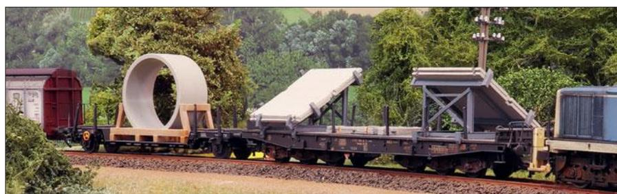
Betonfertigteile gehören zu Gütern, die aufgrund ihrer Beschaffenheit spezielle Ladevorrichtungen benötigen. Das Rohrstück überragt das Lademaß in der Höhe, die Platten stehen wegen der schrägen Anordnung in der Breite über.
