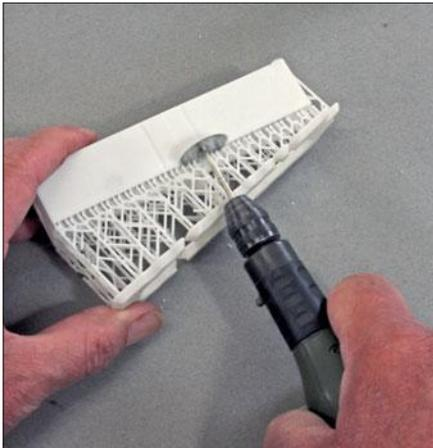
Die Supporter, also die Stützsäulen des Druckes, sollte man wegen ihrer Sprödigkeit mit einer Säge – hier einem Metallsägeblatt in einer Kleinbohrmaschine – entfernen.
