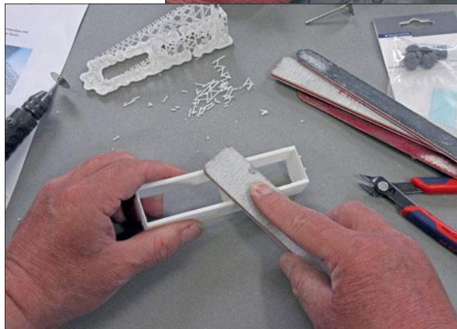
Die Längsseiten mit noch geringen Schleiferresten schleift man zunächst mit einer flächigen Nagelfeile plan und nutzt dann einen noch feineren Schleifschwamm (z.B. aus dem Airbrush-Zubehör) zum Glätten der Kanten.
