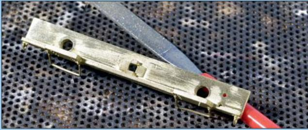
Alle Messingteile müssen vor dem Löten an den Kontaktflächen blankgefeilt werden. Das erledigt man am besten mit einer Diamantfeile.
