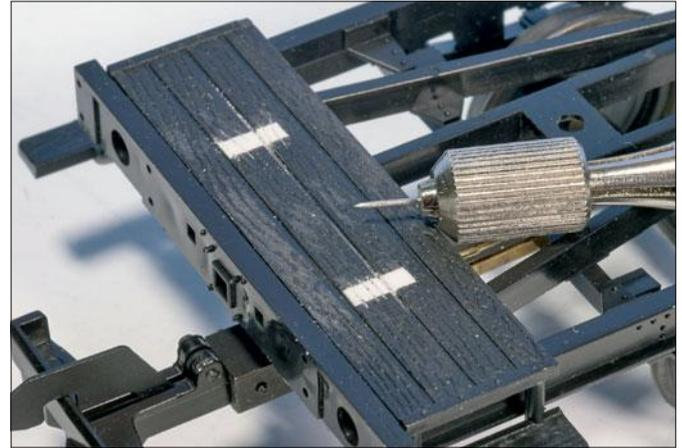
Durch den Einbau der Kulissenführung musste eine neue Befestigung für den Kessel in den Rahmen geklebt werden. In den Kesselsattel wurde ein Winkel mit korrespondierender Gewindebohrung geklebt.
