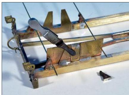
Die Komponenten der Bremsanlage mussten ebenfalls neu verlötet werden. Das Umsteuerventil der Bremse kommt von 0-Problemo.
