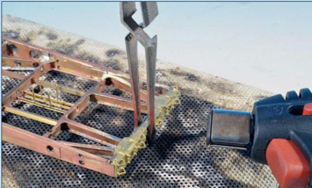
Für die vergleichsweise massiven Pufferbohlen braucht man sowohl den größeren Lötbrenner als auch eine größere Kreuzpinzette. Lotstücke (4, 7 und 4 mm) werden hier an drei Stellen aufgelegt.
