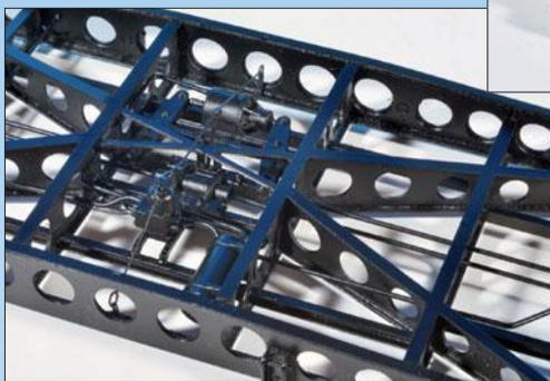
Zur Darstellung der Lösezüge soll man 0,4-mm-Draht selbst biegen. Einfacher geht es aber, wenn man von Weinert die Tendergriffstangen aus dem H0-Programm verwendet. Der hintere Lösezug muss dazu allerdings verlängert werden.
