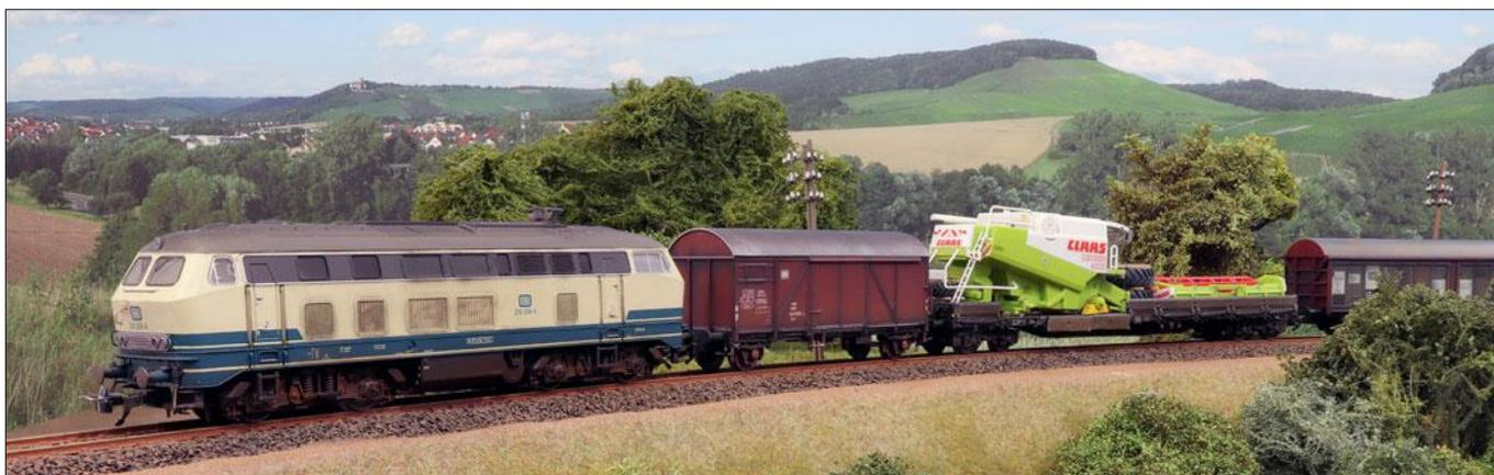
Oben: Ein Mähdrescher auf einem Flachwagen wurde in einen für LÜ-Ladungen freigegebenen Durchgangsgüterzug eingestellt. Trotz Demontage der Räder überragt er die Wagenkanten.
