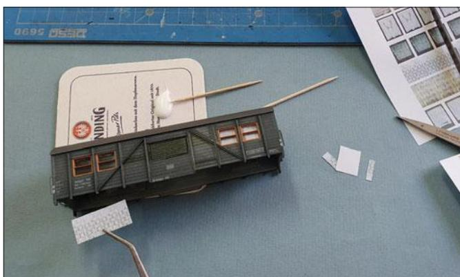
Die Vorhänge (Vorlagen aus dem Internet) wurden in einem Bildprogramm auf Maß gebracht, ausgeschnitten und eingeklebt.
