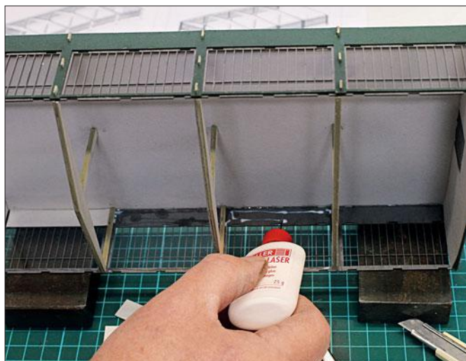
Zum Kleben der Innenwände kommt Faller-LaserKleber zum Einsatz.
