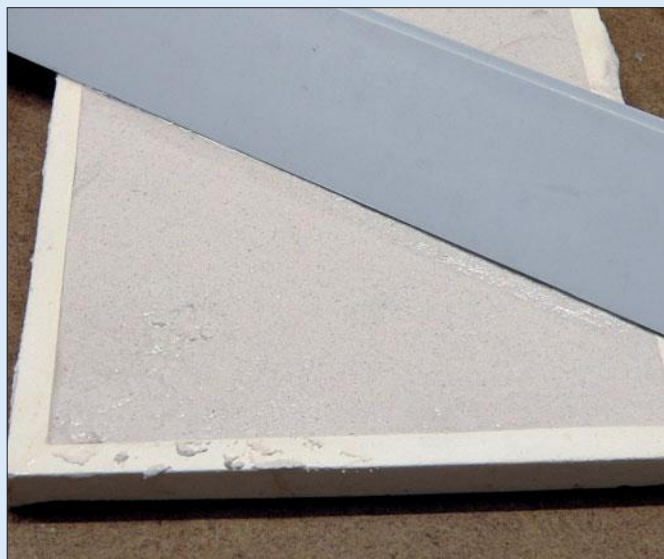
Zum Glattstreichen der Masse eignet sich bestens ein altes Lineal.
