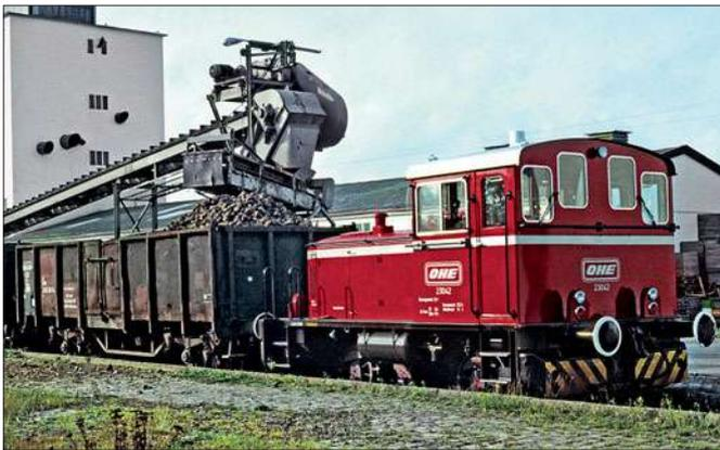
Diese Szene zeigt eine Rübenverladung bei der OHE. Hierfür ist ein stationäres Förderband verbaut, mit dem die Wagen beladen werden können. Zum Beladen müssen die Wagen verschoben werden.
