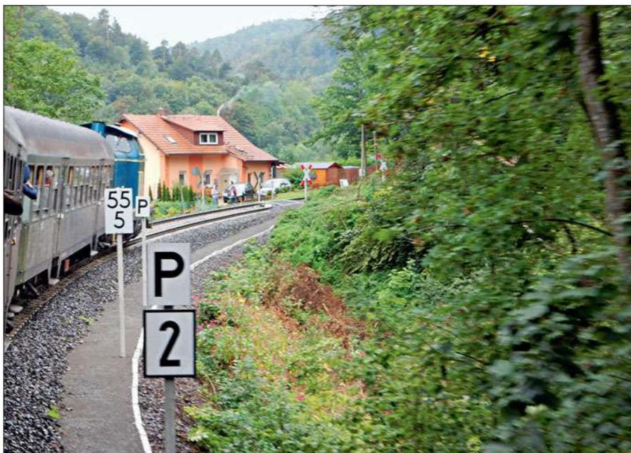
Auf der reaktivierten unteren Edertalbahn wurden ungesicherte Übergänge beibehalten. Dem unübersichtlichen Übergang darf sich nur mit 20 km/h genähert werden. Direkt hinter ihm steht eine weitere Lf7-Tafel mit der Streckenhöchstgeschwindigkeit.
