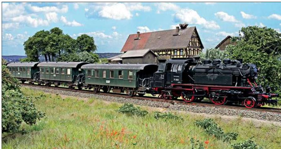
Die für Ein-Mann-Betrieb konstruierte BR 71 war für den schnellen (90 km/h!) Personenverkehr auf Nebenbahnstrecken gebaut worden, hier mit einer vierteiligen Garnitur Personenwagen mit offener Bühne, also frühe Epoche III.
