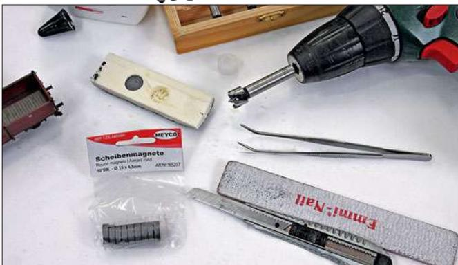
Bei einem geschlossenen Wagen sollte indes die Ladung herausnehmbar bleiben. Mit einem Forstnerbohrer erhält der Hartschaumkern zwei Löcher von 15 mm Durchmesser. Dort lassen sich passende Scheibenmagneten einkleben.
