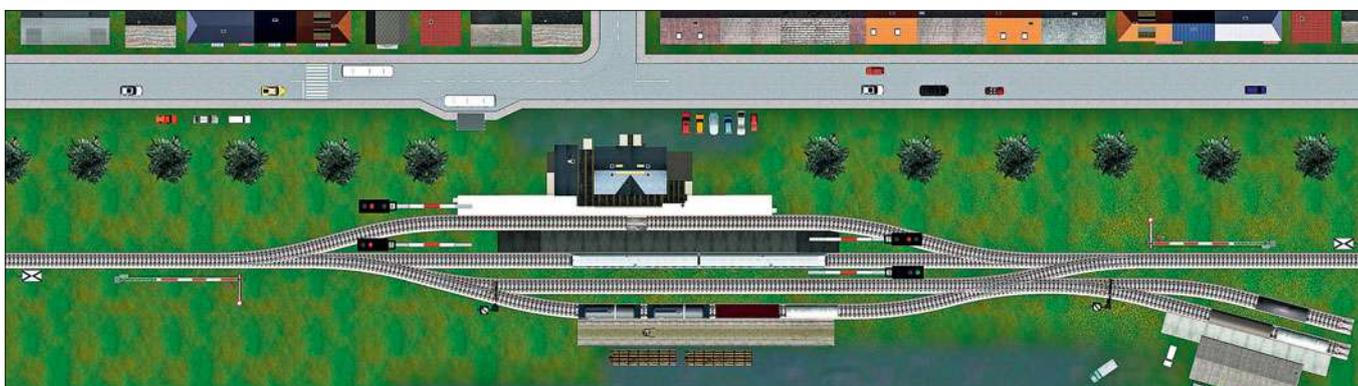
In der Weiterentwicklung des Falls #2 im mittleren Gleisplan wurden Ausfahrtsignale und Streckenblock nachgerüstet. Dies erfolgte in einigen Fällen mit einfachen Lichtsignalen. Sie können die Signalbilder analog zu klassischen Ausfahrtsignalen zeigen. Insofern wäre die hier gezeigte Beispielsignalisierung anstelle der Lichtsignale von vornehe-
