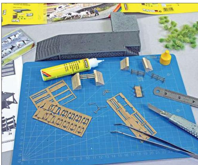
Die Hartschaumrampe von Noch kommt mit etlichem Zubehör für eine Viehverladung daher. Die Höhe ist auf Betungleise ausgelegt. Schutzzäune bestehen aus Laser-cut-Karton und sind einfach zusammenzubauen. Ich habe mir mit kleinen Holzresten eine Ablagehilfe gebaut. Mit dem passenden Kleber sind die Teile schnell trocken.
