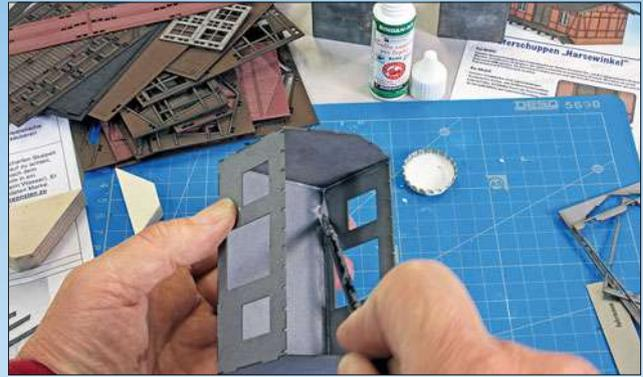
Moebo empfiehlt die Verdünnung seines Klebers mit etwa 20 % Wasser. Die sämige Klebeflüssigkeit ist dann dünn genug, um mit dem Pinsel aufgetragen zu werden, aber noch nicht zu dünn.
