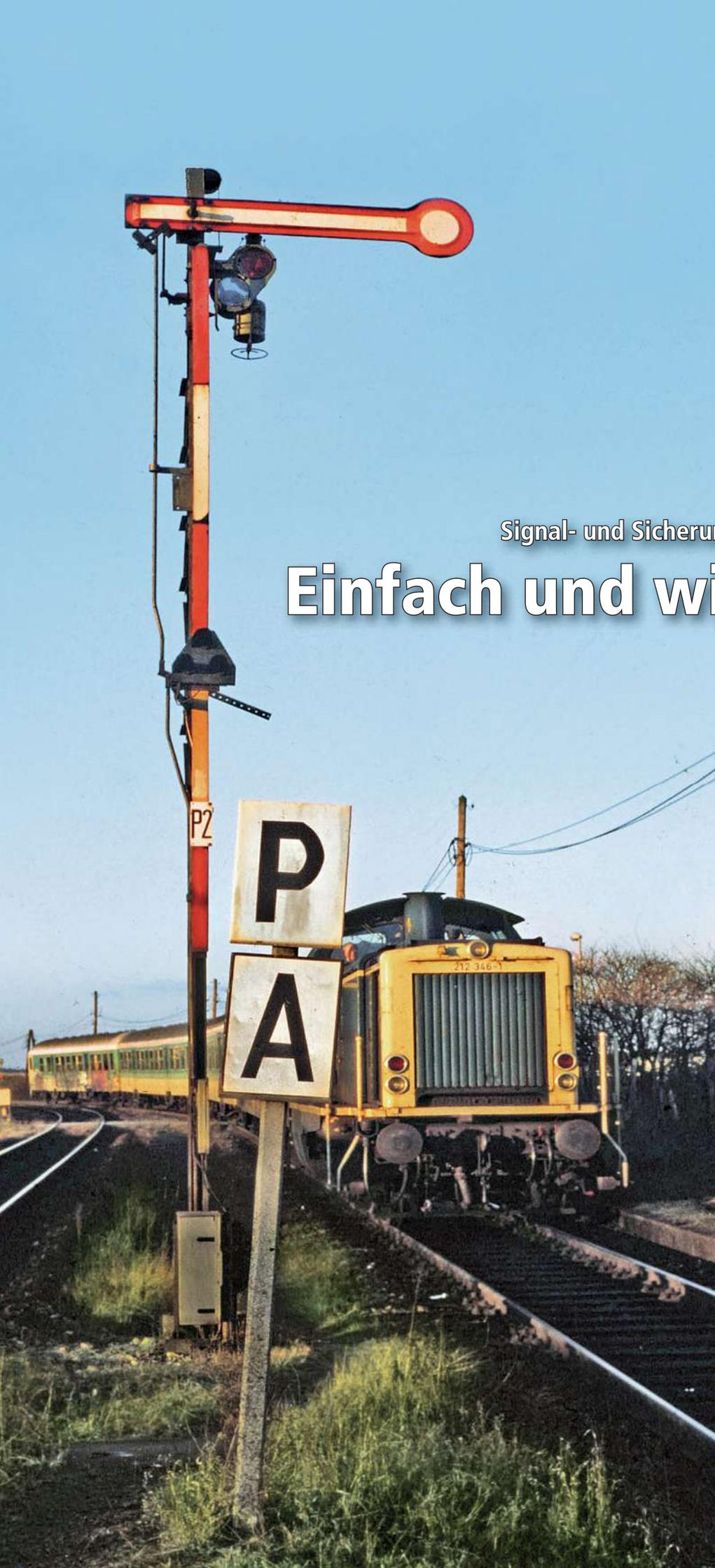
*In strukturschwachen Gegenden reichte in der Regel der Bau von sogenannten Nebenbahnen. Die wenigen Züge fuhren mit niedrigen Geschwindigkeiten und der Bahnbetrieb konnte mit relativ einfachen Sicherungsmitteln durchgeführt werden. Je nach Bedeutung der Nebenbahn unterschieden und unterscheiden sich Signalisierung und Sicherungssysteme, wie der Überblick zeigt.*
