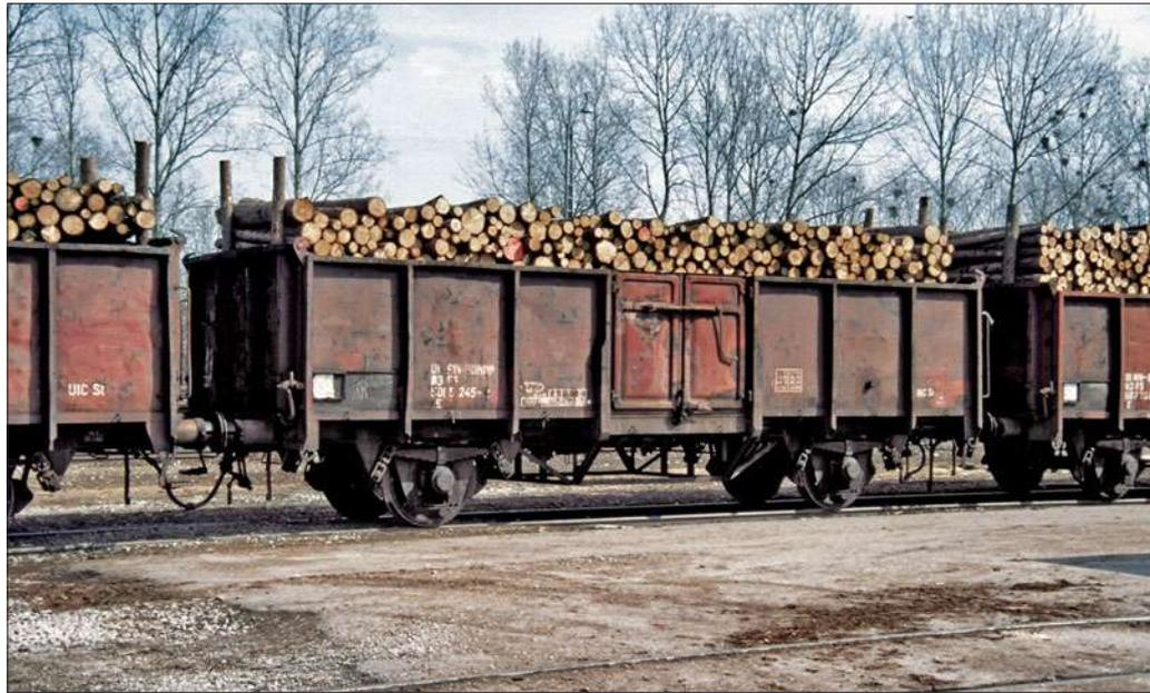
Rundhölzer mit 2 m Länge, die noch die Rinde tragen, sind in diesen Om 55 zur Erhöhung der Ladekapazität über die Bordwand hinaus gestapelt. Möglich wird dies durch die aufrecht stehenden Stützhölzer an den Stirnseiten der Wagen.
