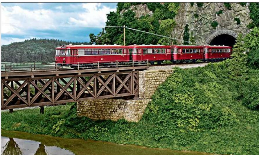
Mit mehr als zwei Beiwagen konnte ein VT 95 nicht fahren, weil der Motor mit seinen maximal 150 PS ansonsten überfordert gewesen wäre. Aber im Verbund VT+VB+VB+VT durften die Garnituren dank der 1954 eingeführten Kleinsteuerung eingesetzt werden (Anlage: Hofstetten).
