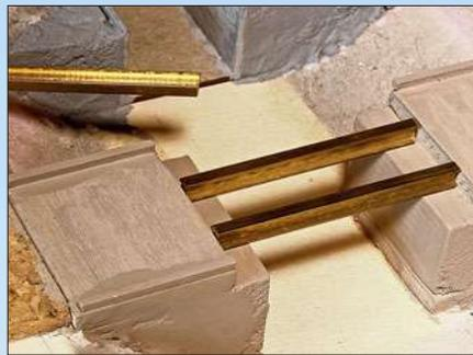
... beide mittig unter den Schienenprofilen liegen. Die Höhe der Auflagen auf den Widerlagern muss so bemessen sein, dass zwischen Grundplatte und Messingprofilen eine ebene Auflage für das Gleis entsteht. Mit etwas ...
