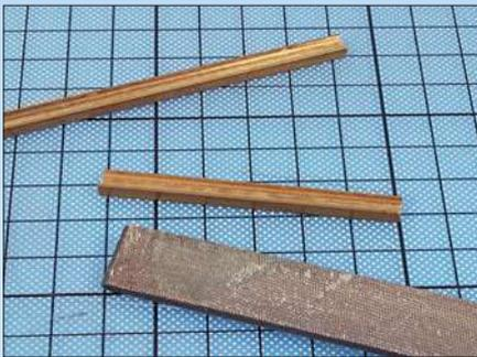
Die Brückenträger entstanden im Modell aus Messingprofilen, die auf die passende Länge gebracht und dann zwischen die Widerlager geklebt wurden. Der Abstand der Träger zueinander muss so ausgeführt werden, dass ...
