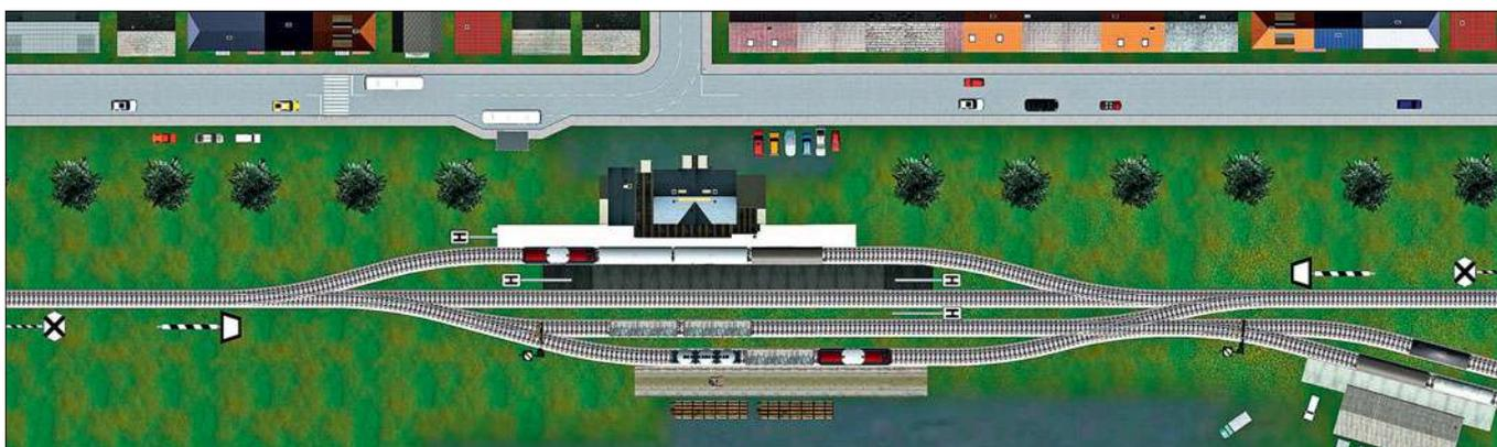
Die einfachste Variante, einen Nebenbahnbahnhof zu sichern. In der Variante vor 1959 ersetzt eine Kreuztafel das Einfahrvorsignal. Sie kündigt eine Trapeztafel an, die ihrerseits den Haltestandort anzeigt, wenn ein Zug im Zugleitbetrieb planmäßig warten muss. Das passiert in der Regel vor Bahnhöfen, falls gekreuzt wird oder auch vor Anschlussstellen. Nach 1959 wurden die Kreuztafeln durch alleinstehende Vorsignaltafeln ersetzt. Die Halteposition für haltende Züge wird, wie sonst
