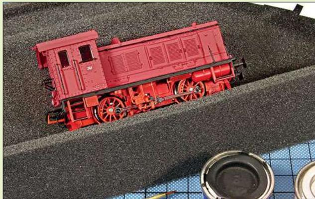
Am Modell der V 20 wurden der Umlauf und beide Pufferbohlen schwarz lackiert. Das Gehäuse erhielt neue Griffstangen und Laternen (oben). Die Beschriftung erfolgte mit Nassschiebern von Weinert und Kuswa.
