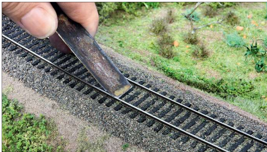
Bei anhaltenden Kontaktproblemen kann bei bestimmten Rad-Schienensystemen die Reinigung der Schieneninnenkante mit einem passend zurechtgefeilten Spatel angesagt sein. Dieser nimmt Farbreste und Anhaftung vom Betrieb von der abgerundeten Kante weg und sorgt für eine durchgehende Kontaktfläche.
