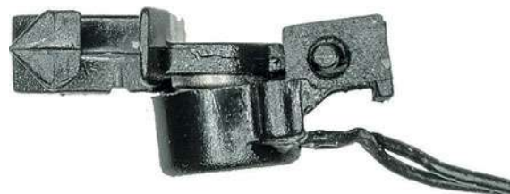
Die Digitalkupplung von SD-Modell verfügt über den Kopf der N-Standard-Kupplung nach NEM 357.
