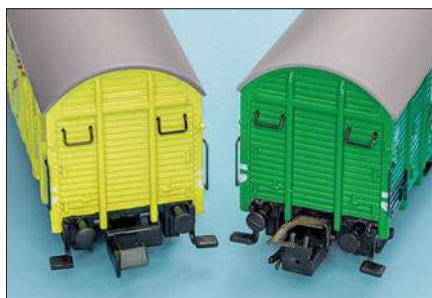
Nicht alle Fahrzeuge lassen sich ohne weiteres mit Digitalkupplung ausrüsten: Werden beispielsweise Krois-Kupplungen in die Opehn-Modelle von Lemke Collection eingebaut, so behindern sie die Funktion der Kurzkupplungskulisse.
