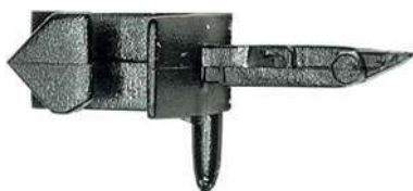
Eine N-Standard-Kupplung in der Seitenansicht als Vergleichsobjekt für den Querschnitt der Digitalkupplungen
