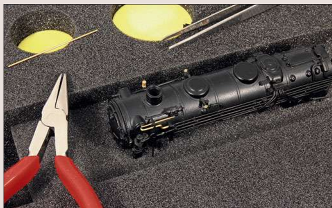
Gelockerte bzw. gebrochene Sandfallrohre ließen sich an den Bruchstellen „flicken“ und in die Haltebohrungen einkleben.
