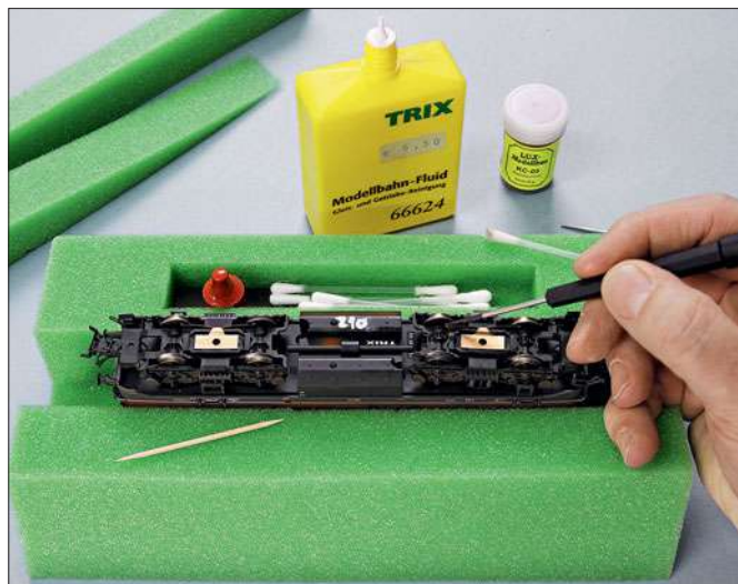
Kontaktprobleme können nicht nur auf den Laufflächen der Räder auftreten, sondern auch durch Flusen zwischen den Stromabnahmeblechen und den Radscheiben.
