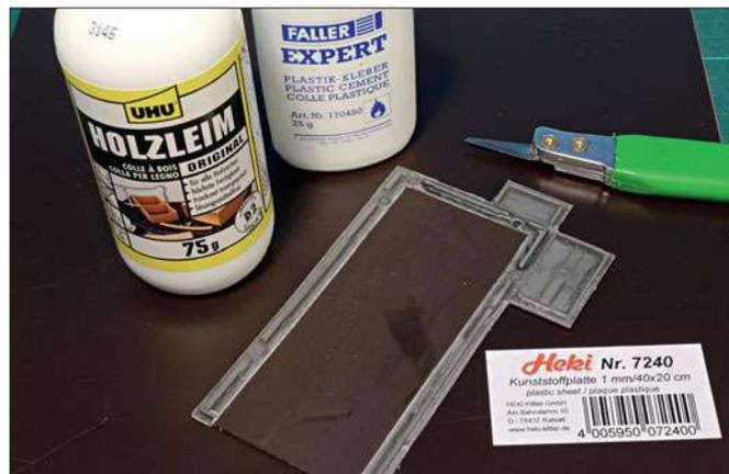
Der offene Teil der Bodenplatte wird mit einer 1,0 mm starken Kunststoffplatte „gefüllt“. Kleine Nahtstellen lassen sich mit Holzleim verschließen.
