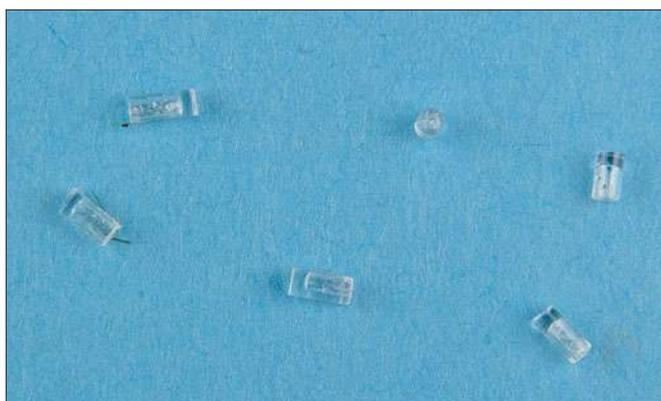
Der Becher wird aus Acrylstäben mit 1 mm Durchmesser und etwas Fingerspitzengefühl hergestellt.
