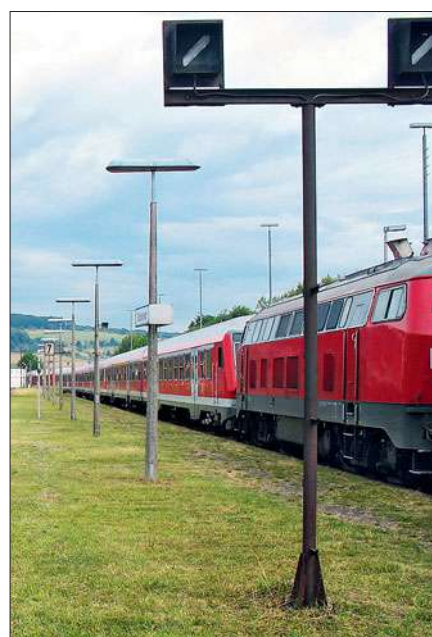
Ein Fahrtanzeiger neuerer Bauart in Frankfurt Süd. Ein Zugbegleiter, der einen Zug abfertigen möchte, sieht das Signal im Hintergrund nicht, da es durch den Zug verdeckt ist, muss aber wissen ob es einen Fahrtbegriff zeigt.
