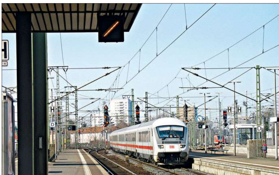
Ein Fahrtanzeiger neuerer Bauart in Frankfurt Süd. Ein Zugbegleiter, der einen Zug abfertigen möchte, sieht das Signal im Hintergrund nicht, da es durch den Zug verdeckt ist, muss aber wissen ob es einen Fahrtbegriff zeigt.
