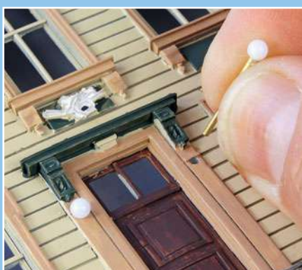
Für die Befestigung der Kugellampen von Beli-Beco wird ein 1-mm-Loch in die Gebäudewand gebohrt.
