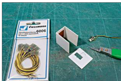
Als Zimmerdecke wird eine Kunststoffplatte zugeschnitten, in die eine Öffnung für eine LED eingebracht wird.
