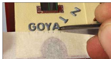
Die vom Spritzling getrennten und von Grat befreiten Lettern werden einzeln aufgeklebt, der Klebestreifen dient als Anschlag. Nach Entfernen des Klebestreifens befinden sich die Lettern im korrekten Abstand zueinander auf einer Linie.
