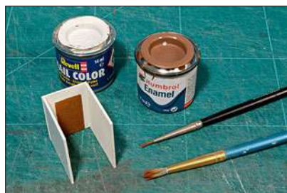
Vor dem Verkleben der Wände wurden die Ränder einer Tür in die Stirnwand geritzt. Das Türblatt lässt sich entlang der Kanten sauber lackieren.
