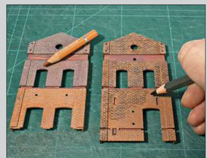
Die Ziegelsteinoberflächen betont man mit Aquarellstiften. Dabei kommt es einer realistischen Wirkung zugute, wenn die Oberfläche ungleichmäßig deckend behandelt wird.
