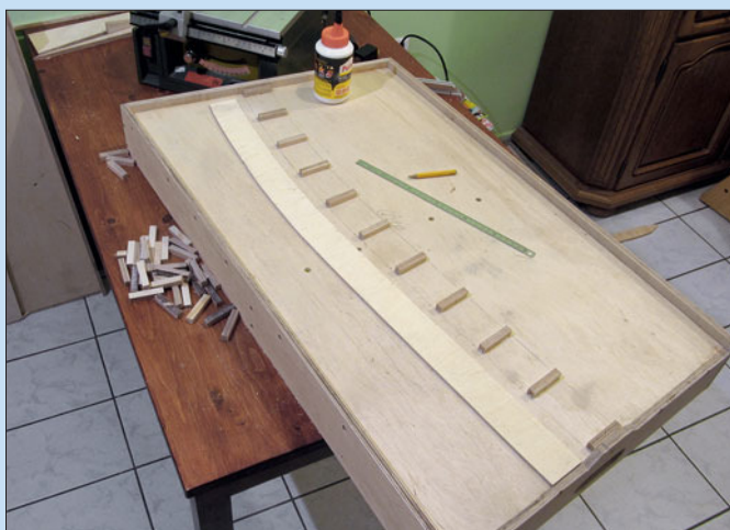
Links: Die Bettung des Streckengleises wurde aus kleinen Querhölzchen mit aufliegendem Trassenbrettchen normgerecht vorbereitet.
