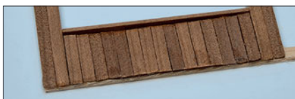
Die kleine Haltestelle bekommt als Verzierung gezackte Abschlussleisten. Diese werden mittels einer scharfen Schere spitz zugeschnitten. Eine Furnierleiste dient waagrecht aufgeklebt als Fensterbrett (rechts).
