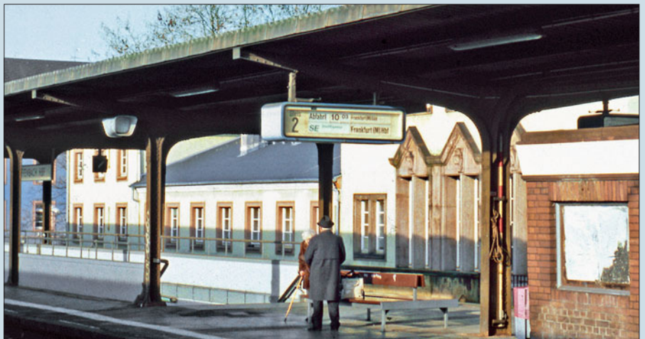
Ein Fallblattanzeiger (ohne Uhr) in Pastellblau im Bahnhof Offenbach: Gut zu erkennen sind die erneuerten Blätter für die veränderten Zugkategorien.
