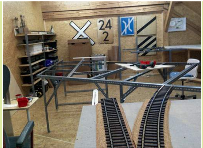
Der Unterbau entsteht aus Metallprofilen, die auch bei größeren Abständen der Stützen ausreichend Tragkraft bieten.
