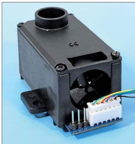
Die Raucherzeuger von ESU haben einen Ventilator und eine große Öffnung, durch die der Rauch je nach Bedarf abgeblasen wird.
