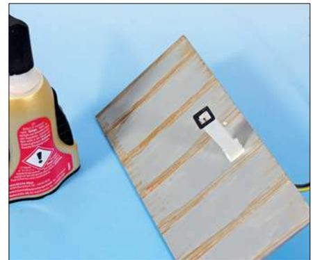
Nachdem die Anschlussdrähte durch das Dach gefädelt sind, kann der Raucherzeuger eingeklebt werden.
