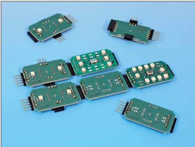
Platinen für die unterschiedlichen Funktionen der Weichen, Signale oder zur Streckenausleuchtung werden zusammengesteckt. Mit Verbindungsplatinen werden Streckenelemente überbrückt.
