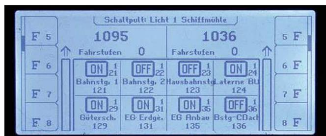
Auch alle Lichteffekte sind digital als Magnetartikel schaltbar. Sie wurden in Gruppen zusammengefasst, sodass sie besser auf dem Display dargestellt werden können.
