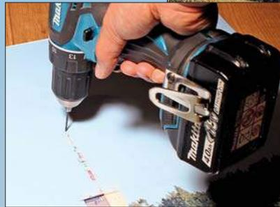
An den Positionen der Warnleuchten wurden kleine Löcher in den Hintergrund gebohrt. Hierbei sollte man darauf achten, dass die Oberfläche des Fotoposters nicht beschädigt wird.
