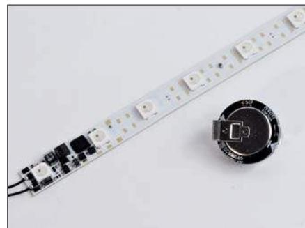
LED-RGB-Leiste von Arnold Hübsch mit einem Goldcap genannten Pufferkondensator. damit erreicht man flackerfreies Licht auch bei kleinen Stromunterbrechungen zum Beispiel in Folge schmutziger Gleise.
