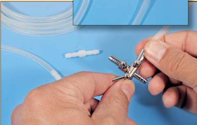
Kugelhähne eignen sich gut, um einzelne Verbraucher auf der Anlage von der Rauchleitung abzukoppeln. Diese erhält man auch als Verteiler, wie hier mit einem Eingang und drei Ausgängen.
