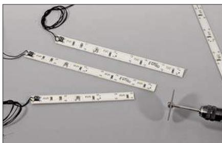
Lichtleisten mit weißen LEDs eignen sich dazu, Innenbeleuchtungen in Fahrzeugen einfach und schnell nachzurüsten. An den markierten Stellen lassen sich die Lichtleisten teilen – für die Wagenkästen der Straßenbahn wurden daher drei davon in der Länge gekürzt. Jede dieser Lichtleisten hat einen 12-V-Anschluss und eigene Vorwiderstände; angesteuert werden sie später über einen der Funktionsausgänge des Decoders.
