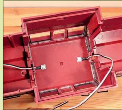
Selbstklebende LEDs von Woodlands Beleuchtungssystem Just-Plug werden unter der Decke des Führerhauses fixiert.
