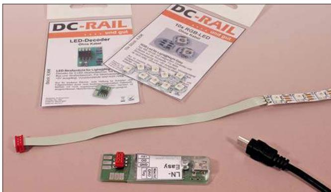
**Das System „Light@Night Easy“ besteht aus einem kleinen Steuermodul, das mit einem Mini-USB-Stecker mit Strom versorgt wird, und mehrfarbigen LEDs, die alle separat angesteuert werden können.**
