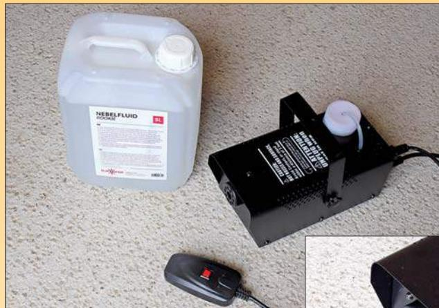
Auch Nebelmaschinen arbeiten zum Verdampfen mit Flüssigkeiten. Sie stoßen den Nebel jedoch mit hoher Geschwindigkeit aus.
