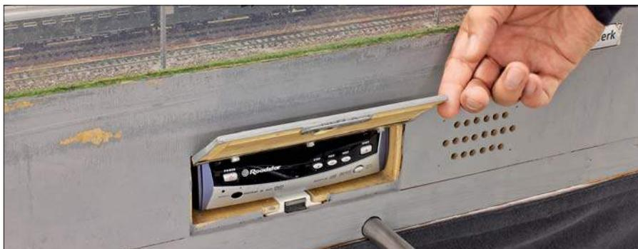
Die technische Basis für das Autokino ist neben dem kleinen Display ein DVD-Player, wie er für Autos verwendet wird. Dieser wurde in den Anlagenrahmen eingesetzt und mit einer Klappe verschlossen. Der Ton des Kinos kommt aus einem Lautsprecher im Anlagenrahmen.
