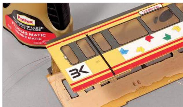
Mit einem kleinen Tupper Sekundenkleber werden die LEDs und ihre Anschlussdrähte so am Gehäuse fixiert, dass sie fest in der Bohrung sitzen und nicht abbrechen können. Die transparenten Fenster dürfen dabei aber keine Kleberspuren abbekommen!
