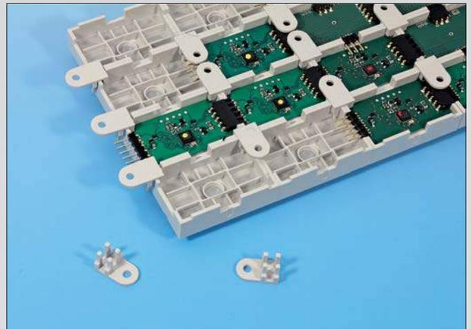
Nachdem die Platinen von unten in das Schaltpult eingesetzt wurden, werden die Kunststoffhalterungen mit kleinen Kunststoffverbindern montiert, mit denen das Stellpult auch festgeschraubt werden kann.
