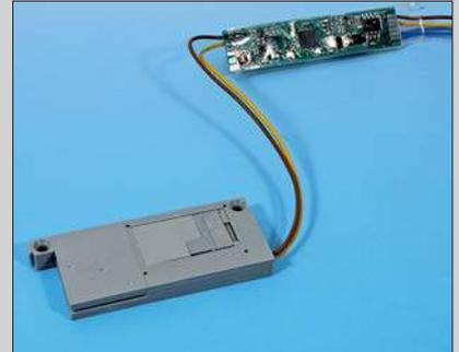
Der Viessmann-Universalantrieb eignet sich für unterschiedliche Anwendungen und enthält bereits einen Digitaldecoder.
