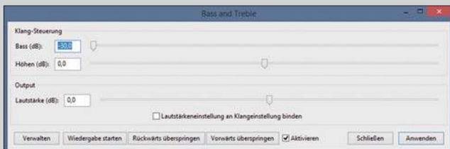
Auf Bahnsteigen werden üblicherweise Druckkammerlautsprecher verwendet. Diese haben einen charakteristischen Klang, dem fast vollständig die tiefen Frequenzen fehlen. Um dies nachzuahmen, wurden bei der Ansage für den Bahnsteig die Bässe entfernt.
