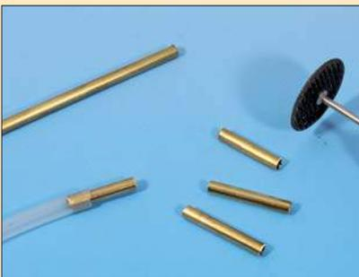
Durch die Kombination von Schläuchen mit passenden Messingröhrchen entstehen Endstücke, die sich als stabile Abschlussteile in Gebäuden oder unter der Anlage eignen.
