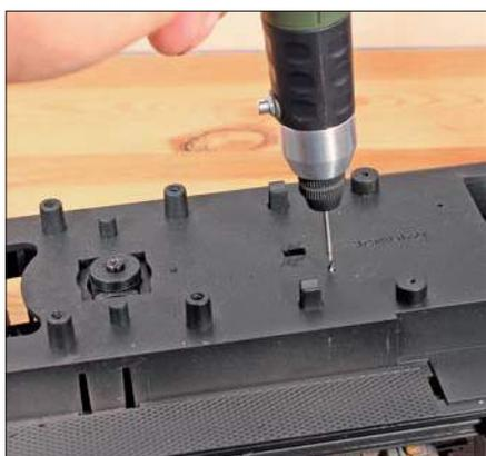
Das Innere der Lok bietet ausreichend Platz für den Einbau des großen Decoders von Massoth. In den Boden bohrt man kleine Löcher (links) für die Befestigungsschrauben des Decoders (rechts).
