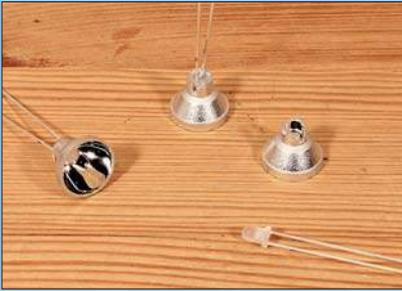
Zur Nachbildung von Scheinwerfern werden die LEDs in passende Leuchtschirme aus Kunststoff geklebt.
