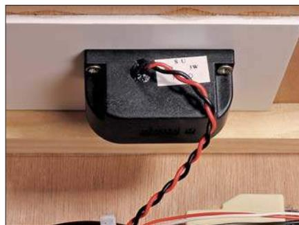
Die Lautsprecher wurden von innen am Anlagenrahmen montiert. Sie erhielten zum Schutz eine Abdeckung mit feinen Löchern.
