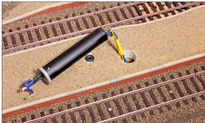
Die Grundplatte der Figur hat einen Durchmesser von 15 mm; so existiert ein Anschlag zum Befestigen des Antriebes. Wer will, kann eine Aussparung für die Grundplatte einarbeiten.
