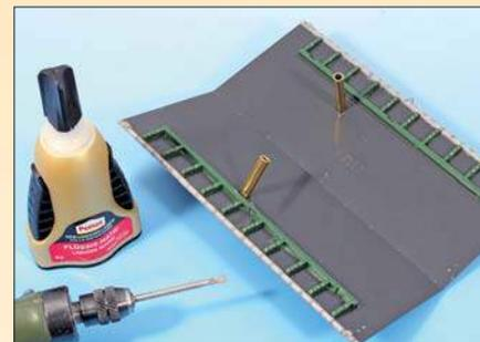
Dieses Dach erhielt Bohrungen unter den Schornsteinen zum Einkleben der Messingröhrchen, auf die man dann recht leicht die Schlauchenden aufziehen kann.
