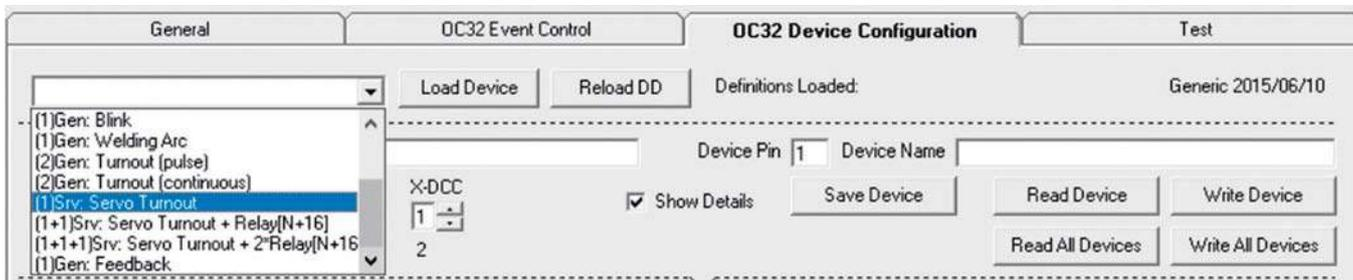
Jetzt muss man der OC32 natürlich diese Veränderung über die Software OC32Config mitteilen, wenn das nicht schon zu Beginn wie beschrieben geschehen ist. Zuvor wird die OC32 über die U485 mit der USB-Schnittstelle des PC verbunden und die Stromversor-
