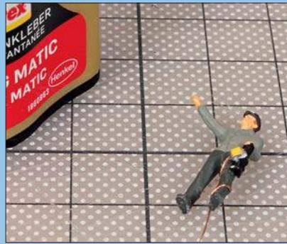
Auch Figuren können mit Lichteffekten versehen werden. Bei dem Schweißer links wurde eine kaltweiße LED platziert, die Laterne des Bahnmeisters (rechts) erhielt ebenfalls eine winzige LED. Die feinen Kupferlackdrähte werden an Armen und Beinen entlang zum Boden geführt.
