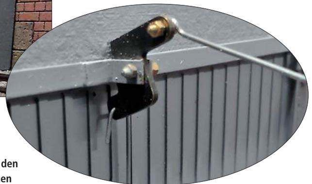
Der Knie-hebel mit den Stellstangen
