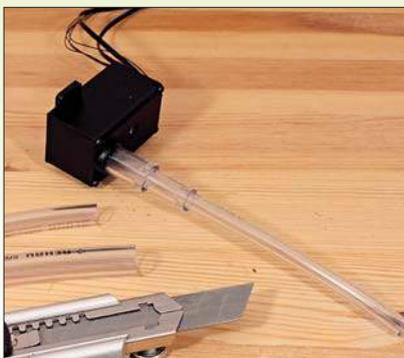
Für den Dampfaustritt kann man in die Öffnung des Dampferzeugers einen Gummischlauch stecken.
