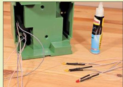
Die Anschlussdrähte der LEDs für die Instrumentenbeleuchtung führt man zur weiteren Verkabelung nach unten.
