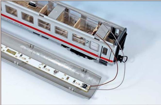
Die Lichtleiste wird unter das Dach des Personenwagens geklebt. Bei Bedarf können die Lichtleisten gekürzt werden. Man sollte wegen Schatten darauf achten, dass keine LED über einer Querstrebe sitzt.
