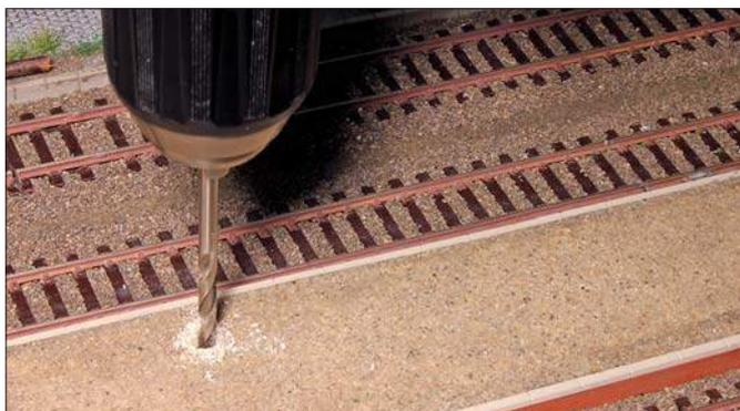
Basis für die Aufnahme des Wasserkrans in der Anlagengrundplatte ist eine senkrecht angelegte Bohrung von 5 mm Durchmesser, in die die Hülse aus Messingrohr eingeklebt wird.
