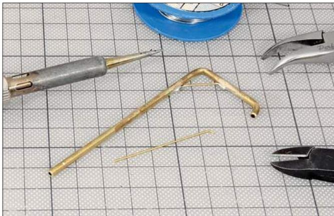
Eine Stütze zur Stabilisierung des Auslegers wurde aus 1-mm-Messingdraht gefertigt und eingelötet. Die Lötstellen sollte man vor dem Lackieren noch ein wenig versäuern.
