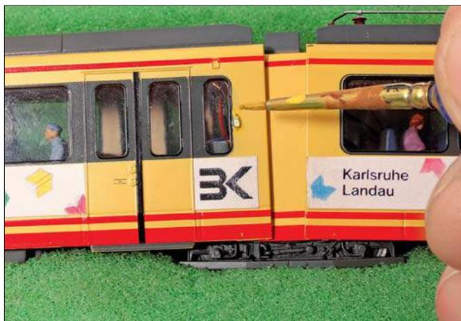
Zum Abschluss werden die sichtbaren Spuren am Gehäuse, die beim Entfernen der ursprünglichen Blinker entstanden, sowie die Bohrungen für die Anschlussdrähte mit etwas Farbe kaschiert.
