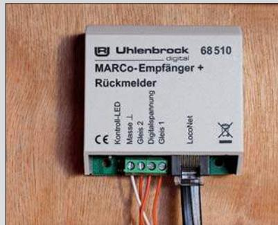
MARCo-Empfänger erkennen über RailCom-Signale die Loknummer, sodass jede Lok individuelle Abläufe auslöst.
