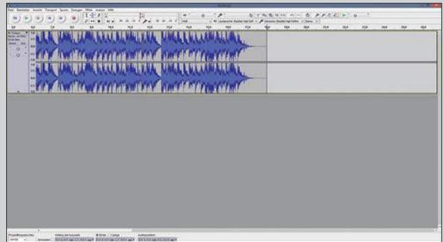
Die Software Audacity bietet umfangreiche Möglichkeiten, Geräuschdateien zu bearbeiten. Man kann schneiden und Tonspuren kombinieren, sodass ganz individuelle Geräuschdateien entstehen. Für die Module der 200er-Serie wird Audacity zudem benötigt, um mp3-Dateien in wav-Dateien umzuwandeln.
