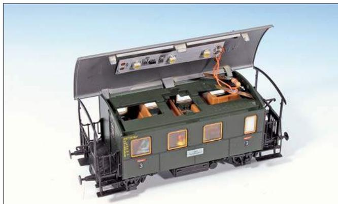
Dieser zweiachsige Roco-Wagen hat über die Achslager bereits eine Stromabnahme, die man auch für Beleuchtungs-LED-Streifen nutzen kann. Bei Gleichstrom muss man Leisten verbauen, die keine Polarisierung aufweisen, bei Wechsel- oder Digitalstrom genügen Vorwiderstände.
