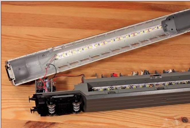
In Doppelstockwagen müssen in beiden Etagen Lichtstreifen eingeklebt werden. Hier sind alle Lichtstreifen eines Personenwagens miteinander verbunden, sodass sie über einen Decoder betrieben werden.
