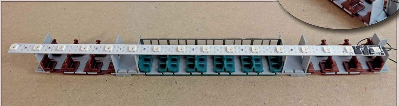
Der Lichtstab mit RGB-LEDs von Arnold Hübsch verfügt über einen Digitaldecoder, über den die Funktion eingestellt wird. Für den Einbau in diesen Personenwagen muss der Lichtstab von Arnold Hübsch zwischen den LEDs gekürzt werden.
