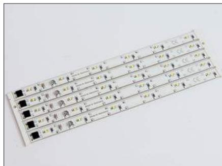
Von RailRoad24.com erhält man einen 5er Satz LED-Lichtleisten. Die Leisten sind analog, für den Digitalbetrieb wird noch ein Funktionsdecoder benötigt. Bei RailRoad24 erhält man auch Radschleifer und Figuren.
