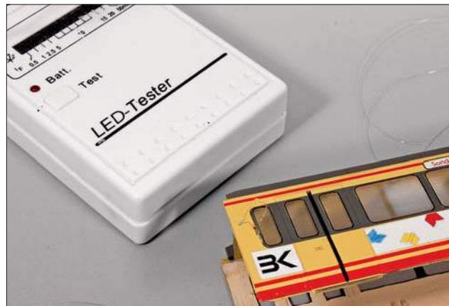
Kleine LEDs erhält man bereits mit angelöteten Litzen. Die Drähte führt man ins Innere der Straßenbahn. Beim Verbauen sollte man darauf achten, dass die Drähte nicht beschädigt werden. Mit einem LED-Tester kann die Funktion überprüft werden.
