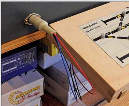
Das dreiadrige Anschlusskabel erhielt einen Stecker, mit dem es von der Anlage abgenommen werden kann. Da sich das Anschlussmodul im LocoNet unter der Anlage befindet, wurde im Rahmen eine passende Anschlussbuchse verbaut, mit der die Verbindung vom Pult zum Anschlussmodul hergestellt werden kann.
