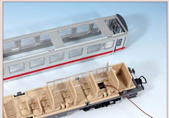
Die Kabel werden bei der Montage der Wagen durch die Inneneinrichtung gefädelt und zu den Anschlusspunkten der Innenbeleuchtung geführt. Sie sollten von außen möglichst nicht sichtbar sein.
