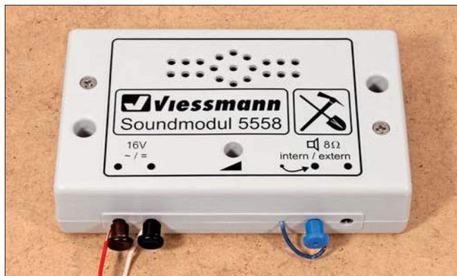
Der Einbau der kleinen Module ist recht einfach. Sie lassen sich aufkleben oder verschrauben und es muss nur die Stromversorgung angeschlossen werden. Neben der internen Wiedergabe kann auch ein externer Lautsprecher genutzt werden.
