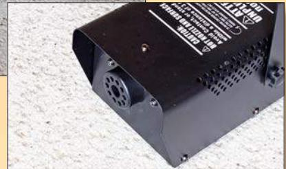
Zwischen den Verbrauchern auf der Modellbahn und der Nebelmaschine sollte eine Art Rauchtank vorgesehen werden. Man braucht ihn zum Sammeln des Kondensats aus dem warmen Nebel. Ein kleiner Kompressor pumpt Luft in die Rauchleitung zur Modellbahn und erhöht so die beförderte Dampfmenge und den Druck.
