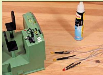
Ins Armaturenbrett werden an einzelnen Instrumenten Bohrungen eingebracht, die man von unten mit LEDs bestückt.
