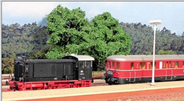
Die V 36.4 von Lenz verfügt über eine automatische Kupplung. Diese ermöglicht beim Umsetzen das Abkuppeln und Wegfahren vom Zug.
