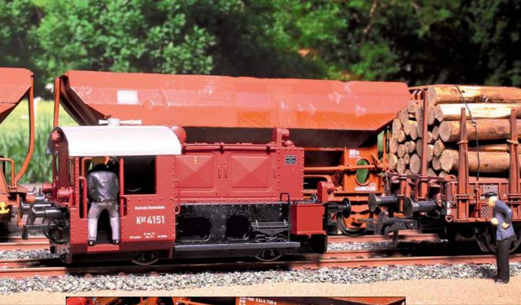
Die Köf von Lenz verfügt über eine automatische Kupplung und beherrscht den „Kuppungswalzer“, bei dem die Lok während des An- und Abkuppelns selbstständig heran und wieder weg fährt. Der kleine Kupplungshaken der Lok wird nach unten abgesenkt; kuppeln kann man damit Bügelkupplungen.
