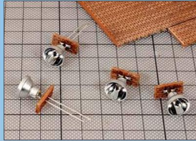
Zur Befestigung der Leuchten lötet man die LEDs auf Lochrasterplatten, über die sie angeschlossen werden.
