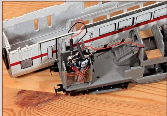
Das Flackern der Innenbeleuchtung durch Stromunterbrechungen zwischen Räder und Schienen minimiert man durch den Einbau von Stützkondensatoren, die hier unsichtbar im Wagen-WC sitzen.
