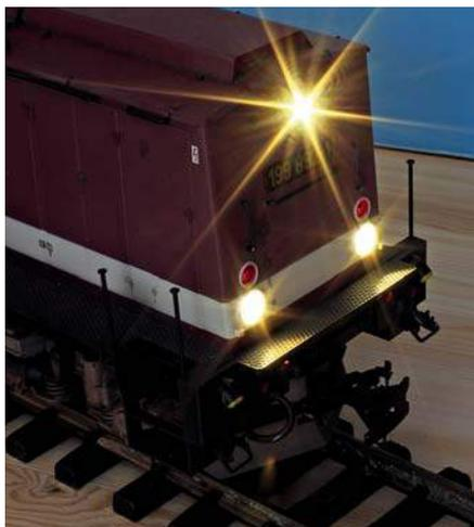
Das Spitzenlicht blieb unverändert. Die LEDs wurden an die Digitalsteuerung angeschlossen. Der Einbau der roten Lichter erfolgte nachträglich. Für den Zugbetrieb sind sie je nach Fahrtrichtung schaltbar. Einzelne schaltbare Lampen waren von Anfang an nicht vorgesehen.
