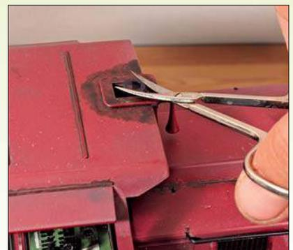
Den oben aus dem Abgasschlot ragenden Gummischlauch kann man mit einer kleinen Schere kürzen.
