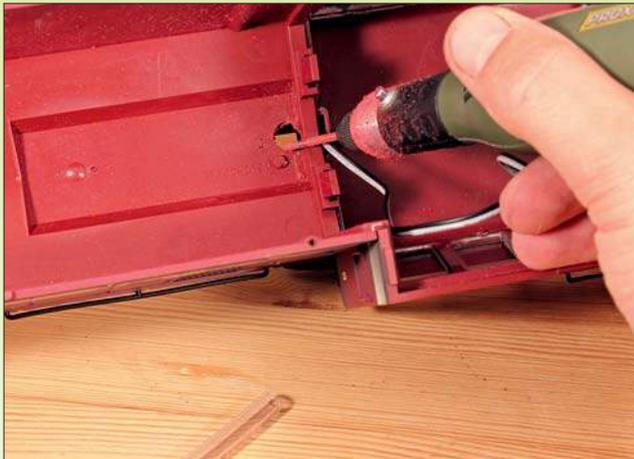
Mit einer Minibohrmaschine von Proxon und einem kleinen Fräsvorsatz wird die Öffnung unter dem Abgasschlot eingefräst. Sie muss den Durchmesser des kleinen Gummischlauchs haben, der dann den Dampf nach oben führt und durch den das Dampfdestillat eingefüllt wird.
