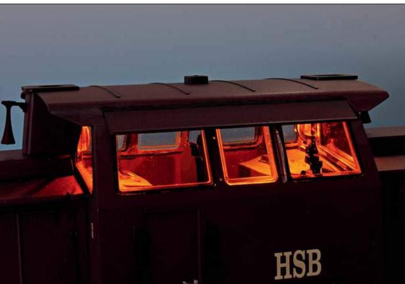
Ein Hingucker ist das beleuchtete Führerhaus mit dem lichttechnisch aufgewerteten Führerpult. Neben der Führerhausbeleuchtung wurden einige LEDs in die Armaturenbretter eingebaut und so an den Decoder angeschlossen, dass man sie einzeln ansteuern kann.
