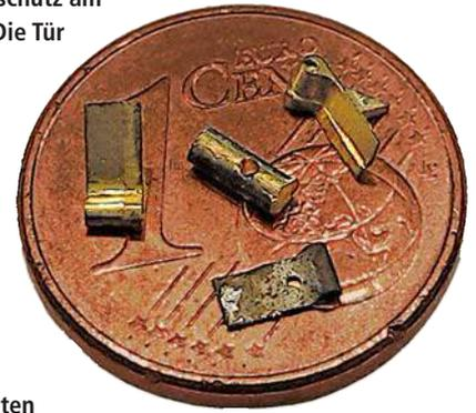
Zum Größenvergleich ein solches Scharnierband auf einer 1-Cent-Münze; die Bohrung im Scharnierband hat 0,5 mm. Diese verstärkten Scharnierbänder wurden am Gitter angebracht, um der Tür noch etwas mehr Halt zu geben.
