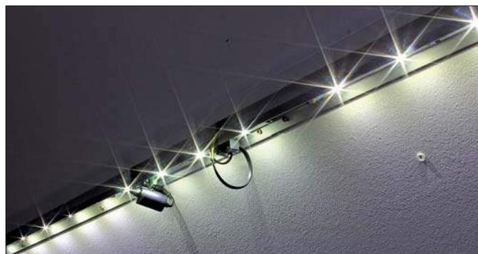
Die hellen LEDs sind im Abstand von wenigen Zentimetern verbaut. Auf der darunter liegenden Anlage entsteht somit ein gleichmäßiges Licht. Die roten und blauen LEDs sind nur auf dem Hauptleuchtstab vorhanden.
