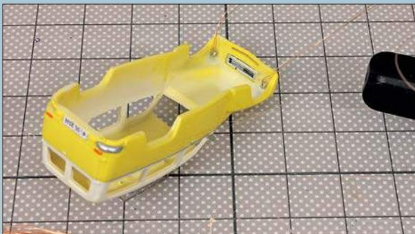
Kleine SMD-LEDs werden von hinten an die Scheinwerfer geklebt. Die werksseitig bereits angelötenen Kupferlackdrähte werden im Fahrzeuginneren verlegt.
