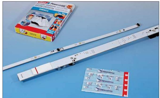
Nach Anschrauben der Aluprofile an die Dachschräge konnten die Leuchtstäbe von unten angeklebt werden. Um genügend Platz für die Steckverbindungen zu haben, wurden sie an die vordere Kante geklebt.
