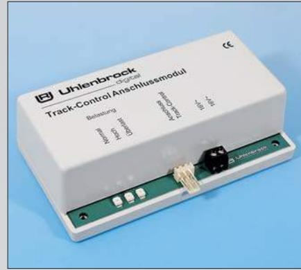
Das fertig montierte Stellpult mit einem Fahrregler und den zahlreichen Tastenfeldern (ganz links). Die Steuerung und die Verbindung zum LocoNet übernimmt ein Anschlussmodul (links).
