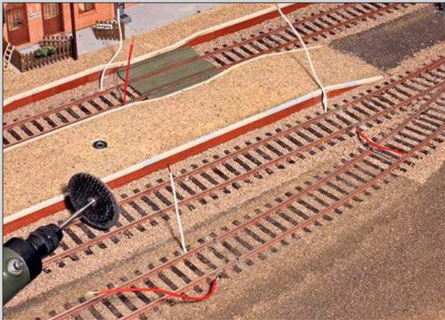
Für den Einbau von Gleisbelegmeldern werden die Gleise beidseitig getrennt und die zu überwachenden Bereiche an Rückmelder oder Belegtmelder angeschlossen. Über die Belegtmelder kann man dann später vordefinierte Abläufe starten.
