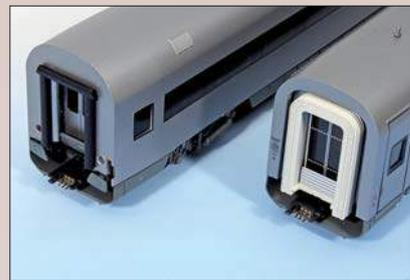
In den Drehgestellen sind kleine Kontaktfedern für die Stromabnahme vorhanden (links). Lok und Wagen verfügen über stromführende Kupplungen, die den Datenbus zu den Prozessoren übertragen.
