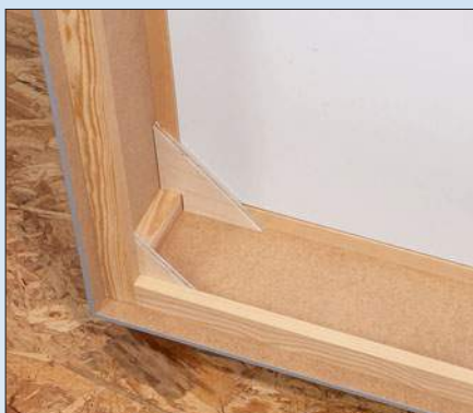
Der Lichtkasten ist eine leichte Konstruktion aus 3,5-mm-MDF und Holzleisten.
