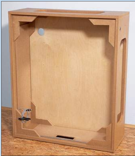
Der Unterbau der Anlage entstand anlässlich einer Ausstellung aus 19-mm-MDF und dient auch als Transportbehältnis.
