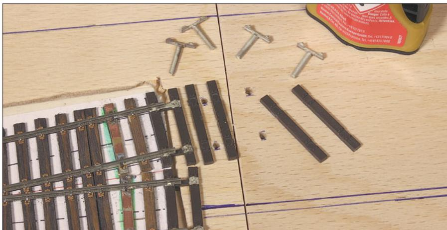
Für Gleisübergänge an Modulkanten hat Weinert Schienenbefestigungen mit angegossenem Bolzen im Sortiment. Sie werden auf die Schienenprofile gefädelt und die Bolzen in Bohrungen gesteckt. Letztere sollten etwas größer ausfallen, damit noch etwas Spiel vorhanden ist.
