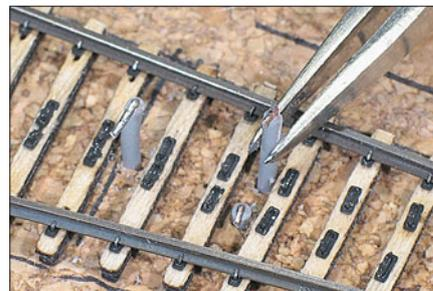
Mit Hilfe der N-tram-Bearbeitungslehren lassen sich die Schienenprofile für die Herzstückherstellung exakt im halben Winkel des Herzstücks abfeilen. Durch probeweises Einsetzen der beiden zurechtgefeilten Herzstückprofile die Spitze kontrollieren. Nach dem Verlöten des Herzstücks können die Kleisen der Zungen- und Flügelschienen
