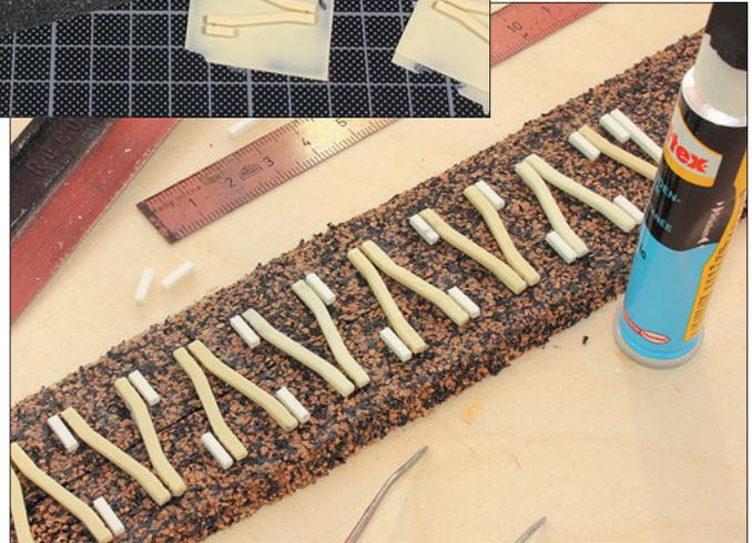
Angüsse unter den Schwellen werden auf flach liegendem Schleifpapier mit kreisenden Bewegungen abgetragen. Abschließend sollten die Schwellen alle die gleiche Höhe besitzen.
