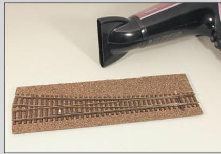
Die Bettungsstücke können mit einem Haarfön schnell erwärmt werden. Dadurch werden sie beweglicher, sodass sich die Schwellen besser einsetzen lassen.
