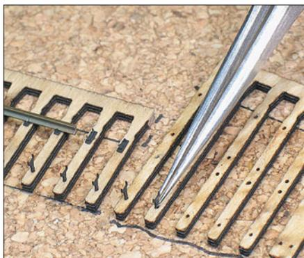
Die Gleisklammern werden lose mit einer Pinzette eingesetzt und mit einer kleinen Schnabelspitzzange so weit wie möglich nachgedrückt.
