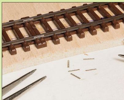
Zur perfekten Gestaltung der Gleise dürfen die Nachbildungen der Schienenlaschen nicht fehlen. Schienenlaschen erhält man beim Hersteller „Digitalzentrale“ als Neusilberätzteile. Nach dem Herausstrennen aus dem Ätzrahmen werden die Laschen mit einem winzigen Tropfen Sekundenkleber, der auf den Steg des Schienenprofils im Bereich der Doppelschwelle aufgetragen wird, in die Flanke des Schienenprofils geklebt. Es empfiehlt sich, die Laschen vor dem Lackieren in das Schienenprofil zu kleben.
