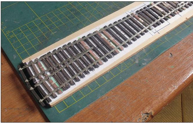
Die Backen- und Zweiggleisschienen lötet man auf die Kupferflächen. Alle Holzschwellen erhalten Rippenplattenimitate und werden durch Löcher der Neusilberätzplatten mit kleinen Schwellennägeln befestigt. Diese bestehen aus gekürzten Tackerklammern.
