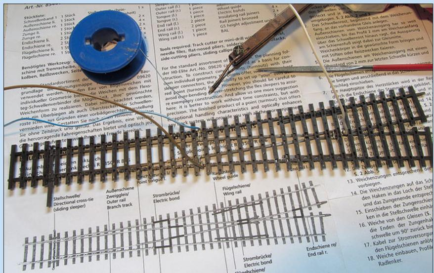
Von erheblicher Bedeutung ist eine exakte Lage der Bohrungen zur Durchführung ange­löteter Kabel. Die Bohrungen sollten unter allen Umständen direkt unter den Löt­punkten sitzen und dürfen den Schwellenrost der Weiche in seiner absolut planen Auflage auf dem Untergrund an keiner Stelle behindern.
