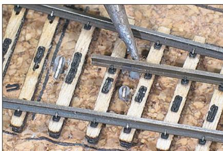
Beim Einsetzen der Weichenzungen müssen die verzinnten Enden der Litzen bündig anliegen, damit sie gut verlötet werden können; Schienenfüße zuvor blank feilen und wenig Lötlut auf dem LötKolben sowie Flussmittel/ Lötlutwasser verwenden. Um ein Verdrehen der Flügelschienen beim Biegen zu vermeiden, sollte der Biegevorgang (mit zwei kleinen Zangen) auf einer Stahlplatte oder einem Stahlwinkel ausgeführt werden.
