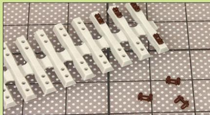
Die winzigen Schienenbefestigungen werden einzeln mit einem Skalpell vom Spritzling getrennt. Die Schwellenimitate besitzen bereits Löcher, in die die Schienenbefestigungen gesteckt werden. Sie halten auch ohne Kleber gut. Bei der Montage ist zu beachten, dass an der Schieneninnenseite die Muttern fehlen.
