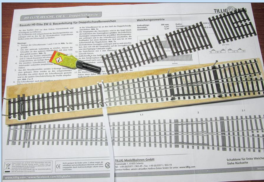
Oben: An dieser Stelle ist uns der Hinweis wichtig, dass beim Umbau auf Doppelschwellen wegen der neuen Schwellenlage bei einer Schwelle die Isolation vom Herzstück entfallen muss. Mit einem scharfen Skalpelli lässt sich dieser Eingriff schnell realisieren.
