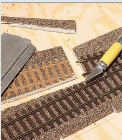
Für abzweigende Gleise von Weichen müssen die Bettungsstücke keilförmig zugeschnitten werden. Mit einem Skalpell und einem Lineal lassen sie sich leicht bearbeiten, sodass an der Weiche keine größeren Spalten entstehen.
