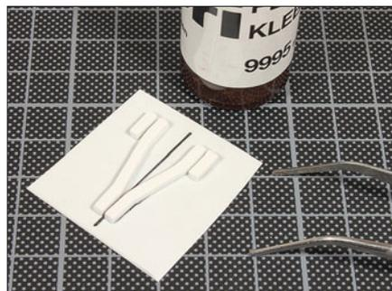
Das Urmodell dieses Y-Stahlschwellenpaares wurde auf eine Unterlage geklebt.
