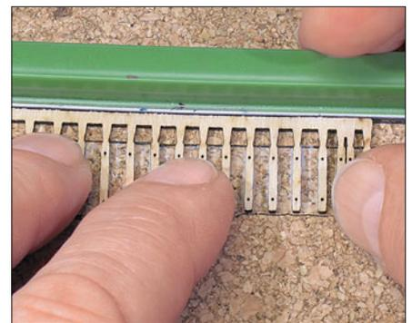
Stimmt die Lage des Schwellenrostes nach Augenschein, kann auch hier wieder mit dem Filzstift angezeichnet werden. Die Trennlinie zwischen den Schwellen und dem Kamm des Schwellenrostes wird markiert und mit dem vorsichtig versetzten Kurvenlineal angezeich-
