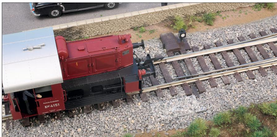
Beim eingeschotterten Gleisbett verschwindet der Antrieb optisch aus dem Sichtfeld.
