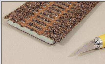
Nach dem Zuschneiden der Bettung steht die obere Schotterschicht über (oben links). Sie sollte so breit sein, dass sie bündig mit der unteren Kante der Bettung abschließen kann (oben rechts). Mit leichtem Druck wird die Bettung anschließend nach unten gebogen und auf der neu geschaffenen Schräge verklebt (rechts).
