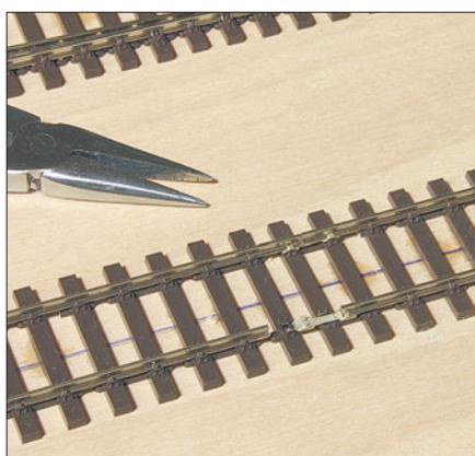
Die Schienenverbinder montiert man zwischen den Schienen so, dass die Schienenbefestigungen mittig auf den Schwellen sitzen. Durch die Aussparungen in den Schwellen sind die Verbinder kaum zu erkennen.
