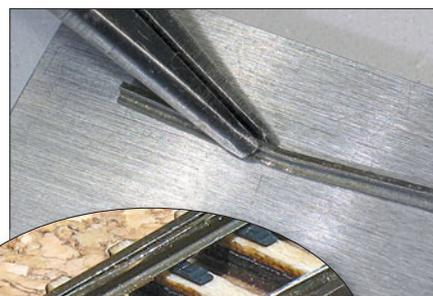
Zwischen Flügel- und Zungenschienen ist der Spalt zu beachten, der zur elektrischen Trennung von Herzstück und Weichenzungen notwendig ist. Im „entspannten“ Zustand sollten die beiden Zungen in etwa Mittelstellung einnehmen. Die Stellstange ist mit einem Polystyrolstreifen unterlegt, um ein besseres, spielfreieres Stellen zu ermöglichen. Bis auf die Radlenker ist die Weiche nun so weit fertig, um mit dem Beizen der Schwellen, der farblichen Nachbehandlung und dem Einschottern beginnen zu können.
