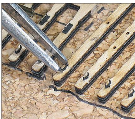
mit einer kräftigen Pinzette ausrichten und ein wenig zusammendrücken – das erleichtert das Aufsetzen der Schienenplättchen. Mit einer feinen, sehr exakt schließender Pinzette werden die Schienenplättchen über die Schienenklammern gelegt und heruntergedrückt.
