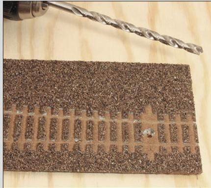
Im Bereich der Stellschwellen von Weichen muss man vor der Verlegung der Bettung ein Loch für den Stelldraht bohren.
