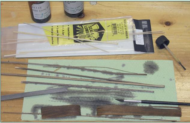
Holzleisten aus dem Bastelshop oder von speziellen Modellzubehörherstellern mussten gleichermaßen in einem ausgebleichten Holzton (Asoa) gebeizt werden. Furnier- und Bastelspanstreifen erfuhren das gleiche Schicksal.
