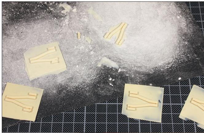
Die so geformten Schwellen werden mit den maßstäblichen Abständen auf einen Unterbau geklebt. Die geraden Nebenträger entstanden aus Polystyrolstücken. Auch die gerade Schwelle wurde aus einem Profil erstellt.
