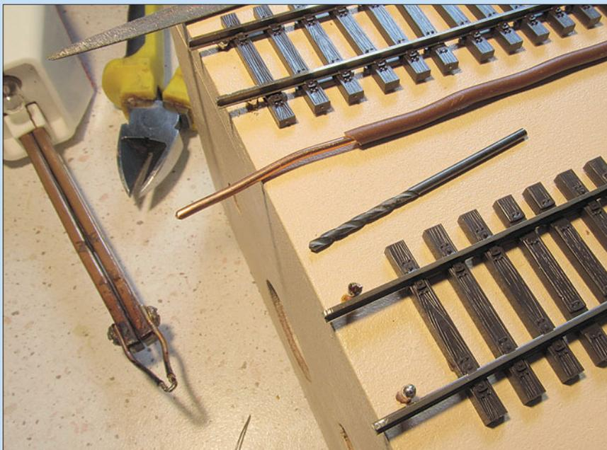
Nicht immer lässt sich gewährleisten, dass die Bohrungen hochpräzise unter den Löt-punkten an den Füßen der Schienenprofile sitzen. Man sollte die Bohrungen daher so vornehmen, dass die Anschlusskabel samt Isolierungen etwas Spiel bekommen. Dass den Löt-punkten unten an den Schienenfüßen höchste Aufmerksamkeit gelten muss, kann nicht oft genug betont werden.
