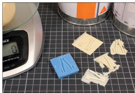
Durch Abgießen mit Resin entstehen nun unzählige Y-Stahlschwellen für den Gleisbau.
