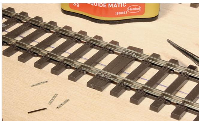
Die Nachbildungen der Schienenlaschen bestehen aus geätztem Neusilber; sie können einfach auf die Schienenprofile geklebt werden. Auf der Innenseite der Profile dürfen sie die Spurkränze der Fahrzeugräder nicht behindern.
