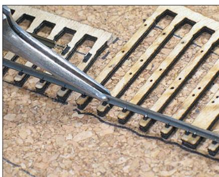
Nun können die Schienenprofile eingelegt und die Klammern mit der kräftigen Pinzette geschlossen werden. Zur Kontrolle sollten in gleichmäßigen Abständen die kleinen Gleislehren aufgelegt werden (hier nicht abgebildet). Sollen bei der Regelspur in N die Gleise auch mit nicht nachgedrehten Spurkränzen nach NEM befahrbar sein, müssen auf der Innenseite die Schienenklammern nochmals extra nachge-
