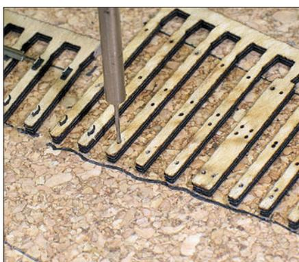
Bei nicht gleichmäßigem oder bei zu viel Leimauftrag kann es zum Verkleben der Bohrungen kommen. Mit einem 0,5-mm-Bohrer wird hier per Hand nachgebohrt. Das erleichtert das Eindrücken der Gleisklammern erheblich. Beim Eindrücken eventuell verbogene Klammern
