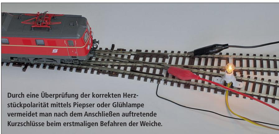
Durch eine Überprüfung der korrekten Herzstückpolarität mittels Piepser oder Glühlampe vermeidet man nach dem Anschließen auftretende Kurzschlüsse beim erstmaligen Befahren der Weiche.
