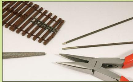
Flügel- und Herzstückschienen schiebt man von den Enden her in die Schwellen ein. Die Schienenprofile sollten an den Enden leicht konisch gefeilt werden.
