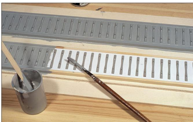
Die gesamte Oberfläche der Festen Fahrbahn wurde mit matter, hellgrauer Farbe gestrichen. Die Schienenbefestigungen dürfen bei diesem Arbeitsschritt nicht verschmiert werden, sonst wird das spätere Einziehen der Schienenprofile deutlich erschwert.
