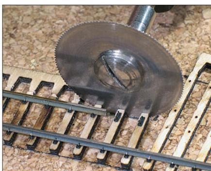
drückt werden (am besten mit einem kleinen Schraubenzieher). Sobald beide Schienen befestigt sind, kann mit einem feinen Kreissägeblatt der Kamm des Schwellenrostes abgetrennt und abgezogen werden. Nun ist auch der Schwellenrost des abzweigenden Gleises mit allen Kleisen, sowie der zweiten Backenschiene angebracht (die äußeren Schienen einer Weiche).
