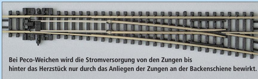
Bei Peco-Weichen wird die Stromversorgung von den Zungen bis hinter das Herzstück nur durch das Anlegen der Zungen an der Backenschiene bewirkt.
