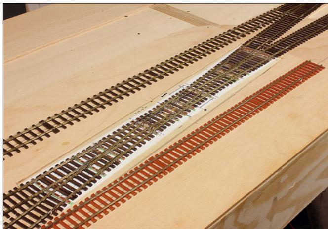
**An den Enden der DKW wurden Schienenverbinder von Weinert verbaut. Hiermit wurden die angrenzenden Schienen mit demselben Schienenprofil befestigt. Stöße oder optische Unterschiede waren danach nicht mehr vorhanden.**
