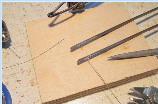
Unten: Die elektrische Verkabelung erfolgt getreu der Anleitung – mit einer Korrektur: Statt der kleinen Blechstreifen als Strombrücken, wie sie werkseitig vorhanden sind, löten wir neue Drahtbrücken ein. Die Spitzen der Schraubendreher weisen auf unsere neuen Lötunkte hin.
