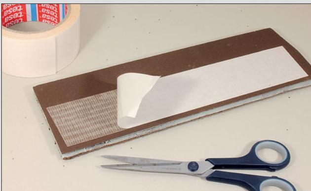
Im hier beschriebenen Fall wurden die Styrostone-Bettungen mit doppelseitigem Klebeband auf die Grundplatte geklebt.
