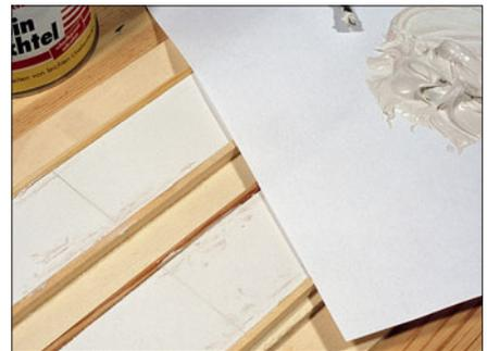
Aus Polystyrolplatten und Profilholzleisten entstand der Untergrund der Festen Fahrbahn. Die Holzleisten wurden neben die vorab zugeschnittenen Polystyrolstreifen geklebt. Die Verlegung muss gerade erfolgen. Abschließend wurden Kanten und Fugen verspachtelt.
