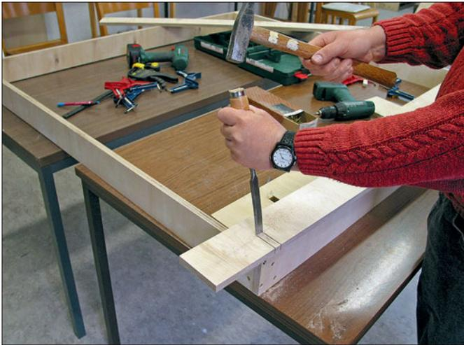
Die Unterbauten der Gleiswendeln entstanden aus äußerst stabilem, 15 mm starkem und wasserfest verleimtem Multiplex-Sperrholz. Für den Einbau des Doppelrahmens wird hier gerade eine Verzapfungsoffnung ausgesägt und ausgestemmt.
