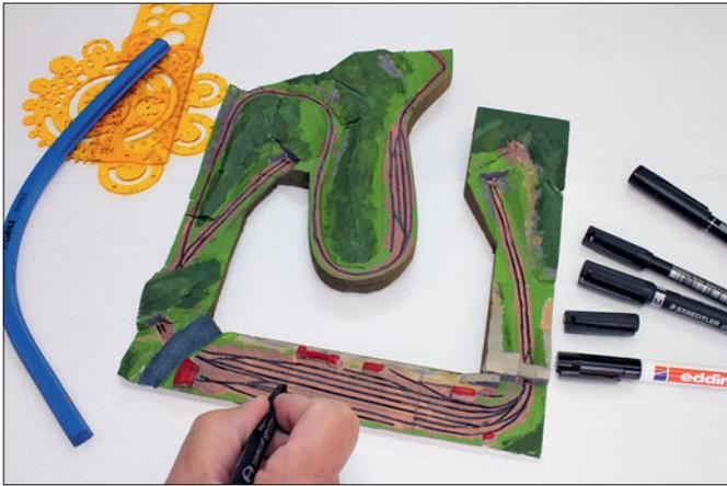
Nach dem Trocknen der Farbe zeichnet man mit wasserfestem Filzstift die Gleise ein und macht sie so kenntlich. In diesem Zustand ermöglicht die Kleinstkontrollanlage bereits eine ausreichende Einschätzung und wird damit ihrer Aufgabe gerecht.
