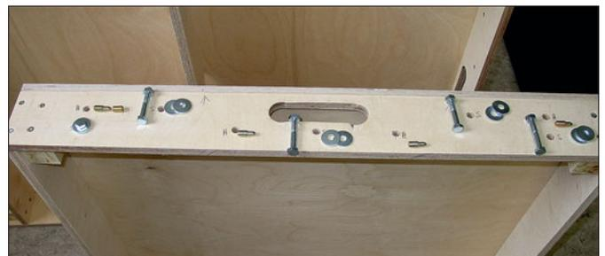
Die feste Verbindung der Elemente erfolgt mit M8-Schrauben, die Fixierung der Kästen außerdem mit zusätzlich eingesetzten Tischdübeln (8 mm).
