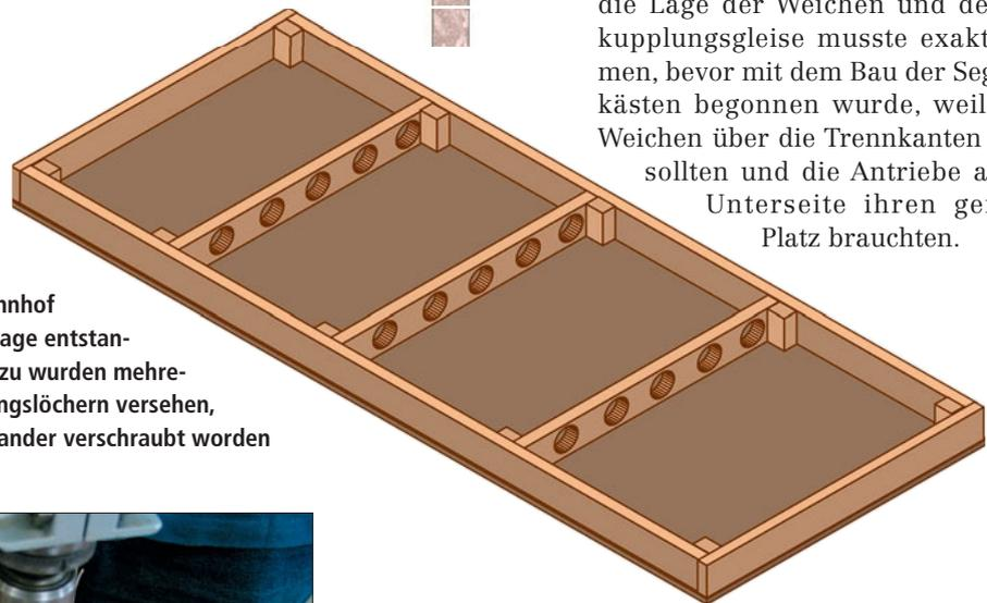
Die Segmentkästen für den Schattenbahnhof und auch für den sichtbaren Teil der Anlage entstanden nach nebenstehendem Muster. Hierzu wurden mehrere Kopfstücke gleichzeitig mit Verbindungslöchern versehen, nachdem sie vorher provisorisch miteinander verschraubt worden waren.
