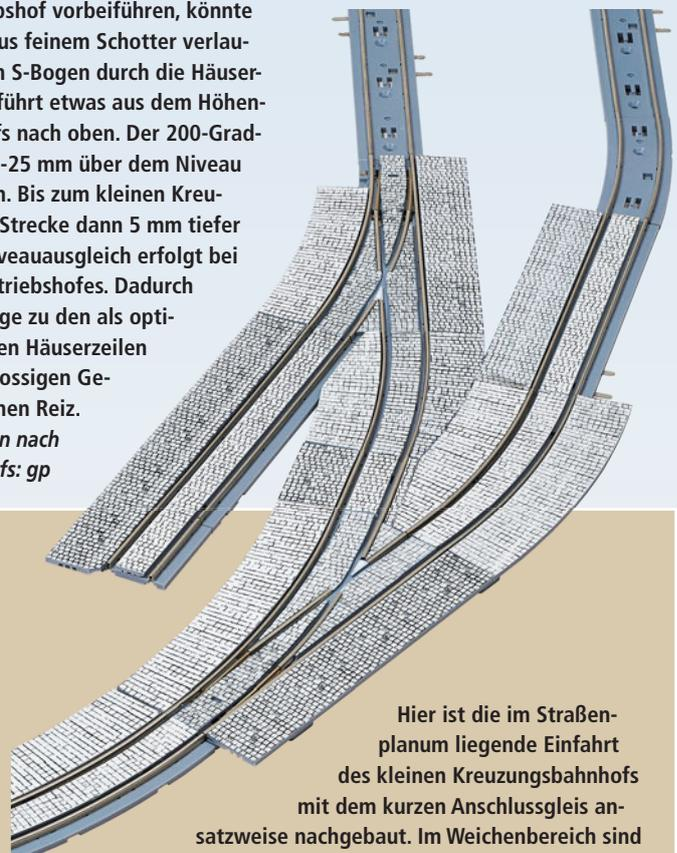
Hier ist die im Straßenplanum liegende Einfahrt des kleinen Kreuzungsbahnhofs mit dem kurzen Anschlussgleis ansatzweise nachgebaut. Im Weichenbereich sind die seitlichen Pflasterflächen anzupassen. Hier helfen die den Weichen beiliegenden Schnittschablonen. Bei Bedarf sollte man sich eine eigene Schnittschablone aus einem dünnen Kartonabschnitt anfertigen, um das Pflaster anzupassen.
