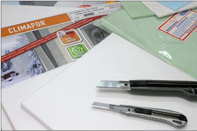
Eine Kleinstkontrollanlage muss kein exaktes Modell der geplanten Anlage sein, sondern nur einen Eindruck über Dimensionen, Farben und Stimmigkeit vermitteln. Ihr Bau soll schnell von der Hand gehen, weshalb Hartschaum ein ideales Ausgangsmaterial hierfür ist.
