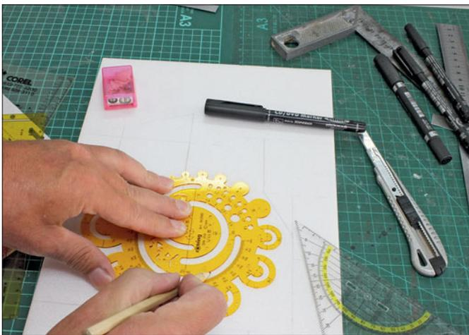
Für Anlagenrundungen oder Gleisverläufe eignet sich ein sogenanntes Kurvenlineal sehr gut. Auch mit den alten Gleisschablonen lassen sich Bögen und Kurven zeichnen.
