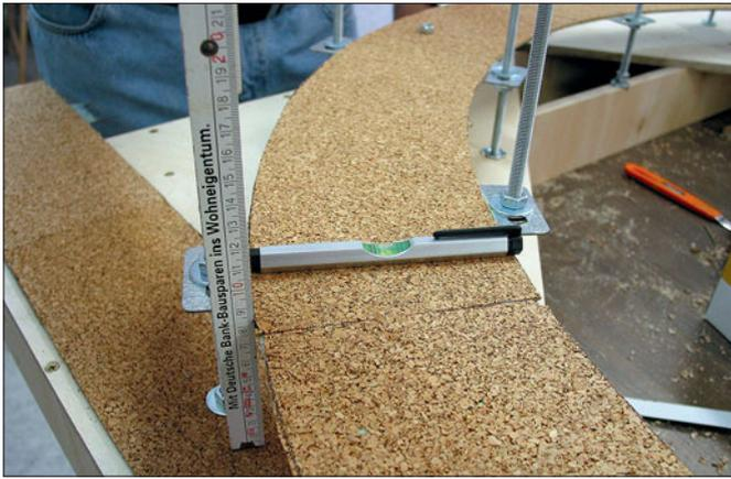
Mit einer kleinen Wasserwaage wird die Ausrichtung der Trasse überprüft; über die Muttern lässt sich deren Lage leicht justieren.
