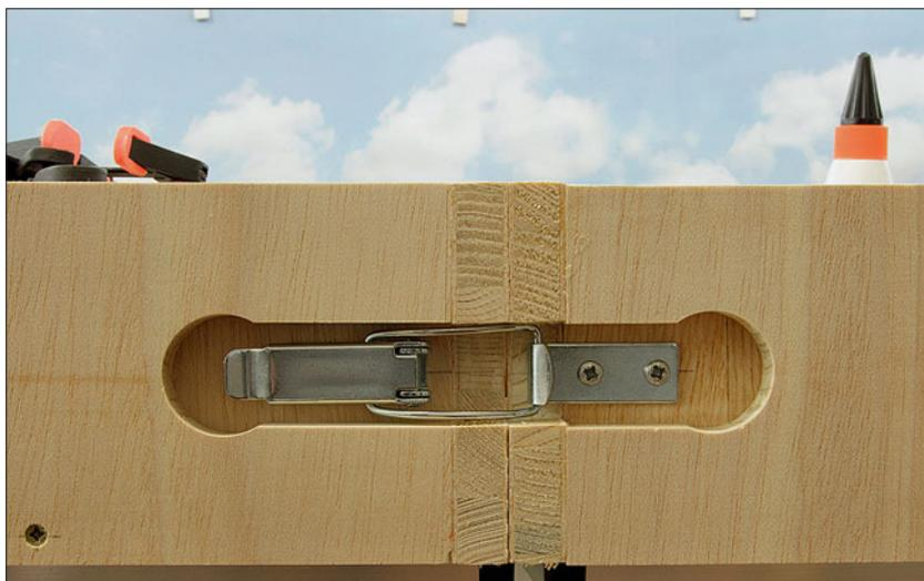
**Der Zusammenbau der Segmente ist einfach, erfordert allerdings präzises Arbeiten. Das gilt besonders für die praktischen, bündig im Holz versenkten Verschlüsse, mit denen sich die Segmente bombenfest und betriebssicher untereinander verbinden sowie verriegeln lassen. Hier hilft die als Zubehör erhältliche Bohrschablone, die exakte Position der Verschluss-teile zu bestimmen.**
