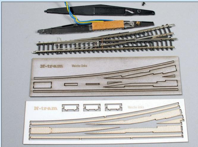
Zwei gelaserte Pflasterelemente zum Unterfüttern und als Einlage für eine Märklin-mini-club-Weiche. Der Originalantrieb wird mit einer kleinen Laubsäge entfernt. Die Betätigung der Weiche erfolgt später zweckmäßigerweise mit einem motorischen Unterflurantrieb.
