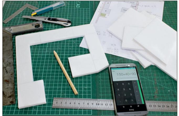
Aus 4 mm starken, feinschaumigen Styrodur-Dämmplatten lassen sich die Grundelemente der Kleinstkontrollanlage sehr gut schneiden. Zuvor ist ein wenig Rechenarbeit zur maßstäblichen Verkleinerung angesagt.
