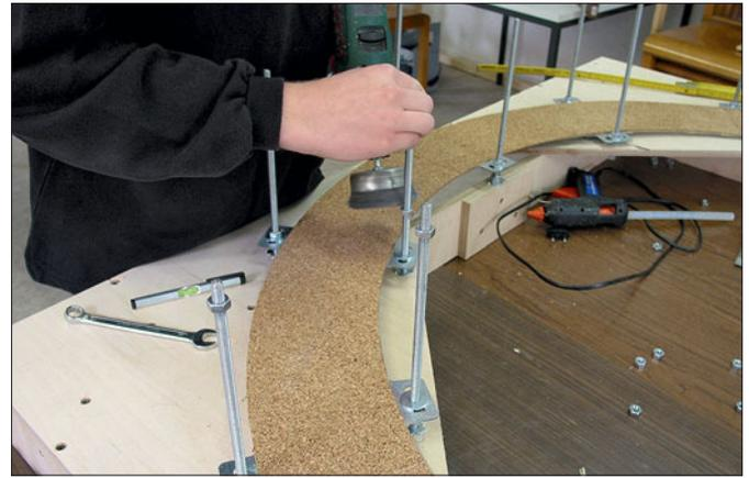
Das Aufdrehen der Muttern auf die teilweise recht langen Gewindestangen gelingt mit einer sich drehenden Runddrahtbürste im Nu ...
