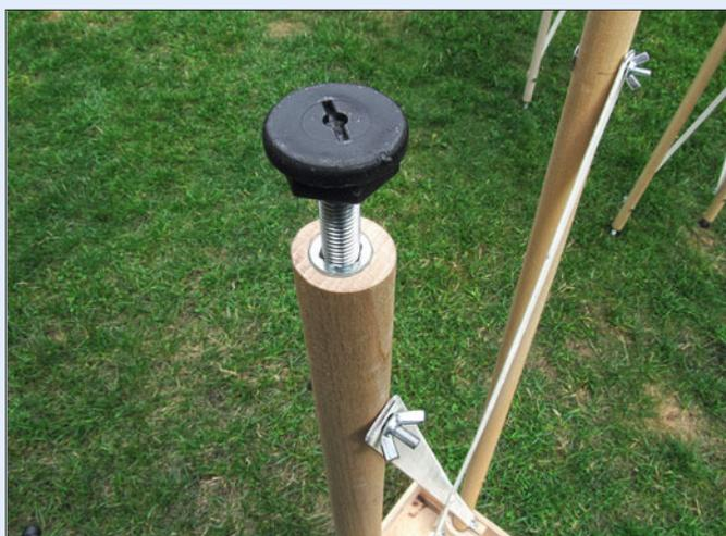
Die Standbeine besitzen zur Höhenverstellung bei schwierigen Aufstellflächen höhenverstellbare Fußschrauben. Erkennbar sind hier auch die X-förmigen Diagonalverstrebungen.
