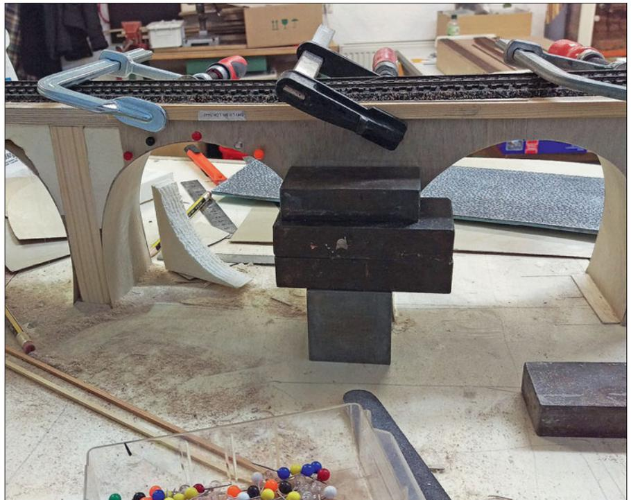
Die Verklebung mit Weißbleim wurde mit Stützklötzen und Schraubzwingen gesichert. Die Kanten lassen sich nach dessen Aushärtung bündig beischieben.
