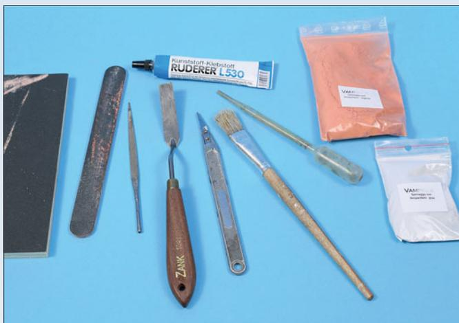
Für die Montage der Bauteile werden Sandfeilen, Spachtelwerkzeuge, Klebstoffe, eingefärbter Spezialgips und als praktischer Helfer ein mit 180er Sandpapier beklebtes, selbstangefertigtes Brettchen zum Egalisieren der Bauteile benötigt.
