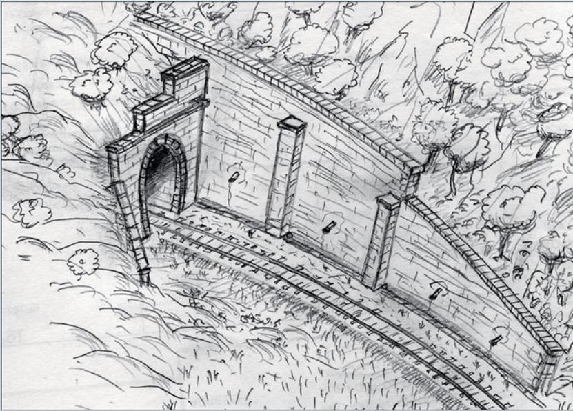
Entwurfsskizze des Tunnels im Stil von Pit-Peg: Die hohe Flügelmauer soll in einer 6° Neigung errichtet und mit zwei Stützfeilern verstärkt werden, um dem Druck des darüberlagernden Gesteins besser gewachsen zu sein.
