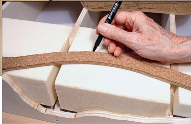
**Links:** So wird der Trassenverlauf auf den Hartschaumblöcken angezeichnet. Das Foto dokumentiert die Seite der Anlage, die das Lehnenviadukt zeigen soll. Die Vorderkante weist bereits auf das Geländeprofil hin.
