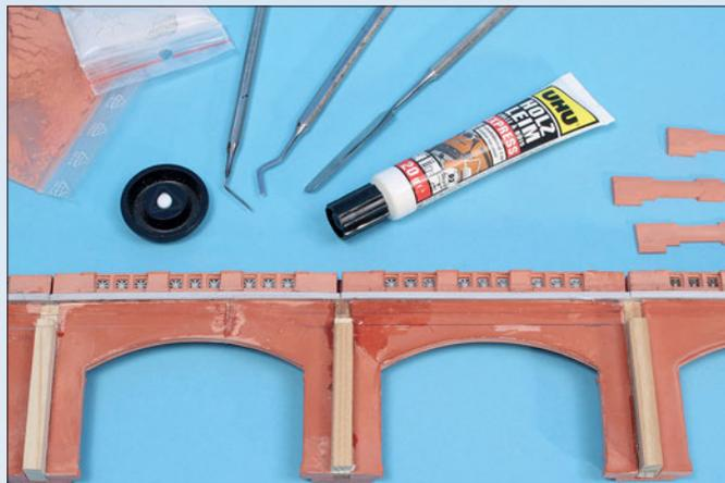
Nach dem Verkleben der Brüstungsteile bleiben innen Lücken, die mit eingefärbtem, bei Vampisol erhältlichen Spezialgips verschlossen werden können. Für diese Arbeiten hat sich Werkzeug aus dem Den- talbereich immer wieder bewährt.
