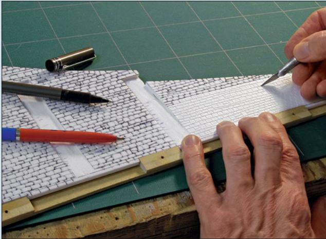
Die Fugen wurden im ersten Schritt mit einem Bastelmesser in die Hartschaumplatte geschnitten, dann wurden die Kanten mit alten Kugelschreibern gebrochen.
