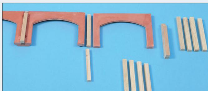
Hier sind bereits verschiedene Bogenteile mit den angefertigten Holzleisten verklebt.
