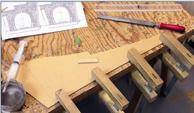
Vier Holzklötze wurden untern an die Flügelmauer geklebt um eine Neigung von 6° zu gewährleisten.
