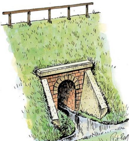
Der kleine Durchlass oben besteht möglicherweise aus Beton, der mit Hausteinen verkleidet wurde; die Flügelmauern erhielten einen einfachen Zementmörtel-Glattstrich als Abschluss. Fast schon um eine kleine Brücke handelt es sich dagegen bei dem Durchlass rechts; daher wurde der Randweg auf vorkragenden Platten weitergeführt und mit Geländern versehen.
