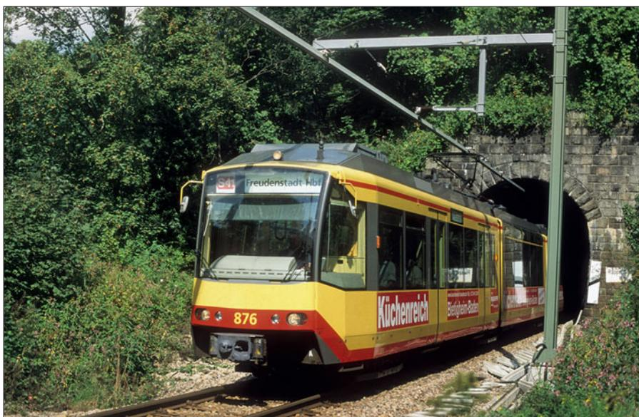
Fall immer unter dem Bauwerk hindurchgeführt. Hierbei ist ganz besonders der Mindestabstand zu geerdeten Bauteilen zu beachten, der bei der DB 300 mm beträgt. Wenn diese Maßnahmen nicht möglich waren, wurden Überführungen häufig umgebaut oder komplett neu errichtet.
