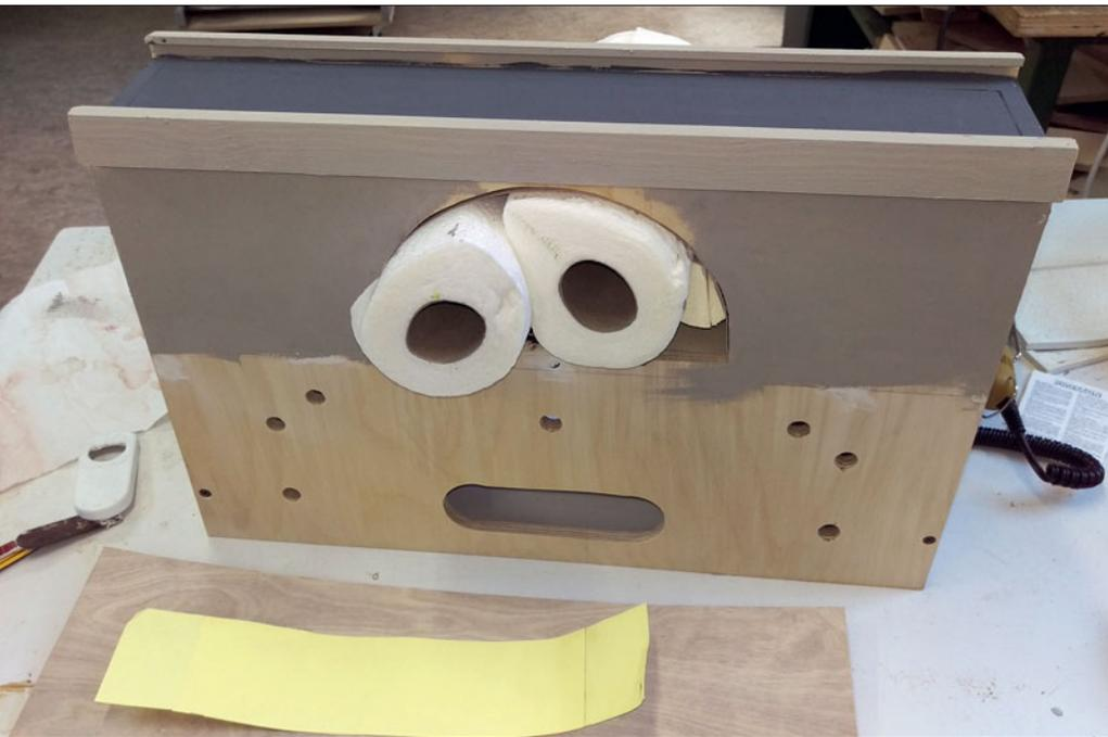
Der hoch aufragende Aufbau vermag die benachbarten Module komplett optisch zu trennen – egal welche Landschaft oder Kopfstückform auf der einen bzw. anderen Seite realisiert ist. Für die Verwendung bei beiden Betriebsmodi mussten daher nur die jeweiligen Bohrlöcher beider Systeme angebracht werden.
