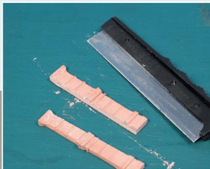
An den Enden der Bogenteile müssen die vorhandenen Lisenen mittig getrennt werden. Am einfachsten geht das mit einer Feinsäge wie hier von Roco bzw. Peter Post. Aber Achtung: das Sägeblatt muss bei diesen Arbeiten vorsichtig, gleichmäßig und nicht verkantend durch das Gipsmaterial gezogen werden, sonst besteht Bruchgefahr!
