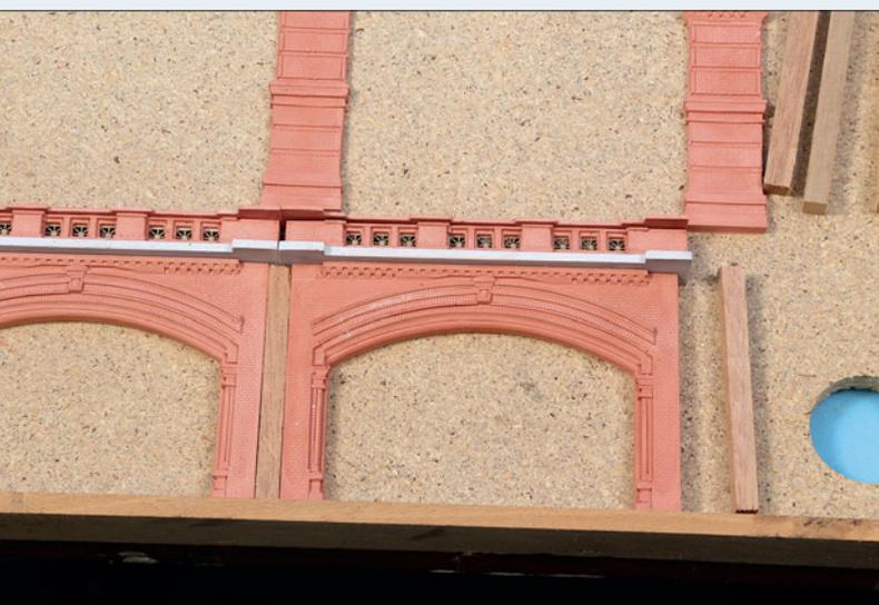
Zum leichteren Aneinanderfügen dient ein selbstangefertigtes Montagebrettchen mit unten angeleimter Anschlagleiste. Aufgrund der vorhandenen Lisenen müssen die einzelnen Bögen mit einem Abstand von 65 mm verbunden werden. Sinnvoll ist es hier, passend geschnittene, quadratische Holzleisten einzufügen.
