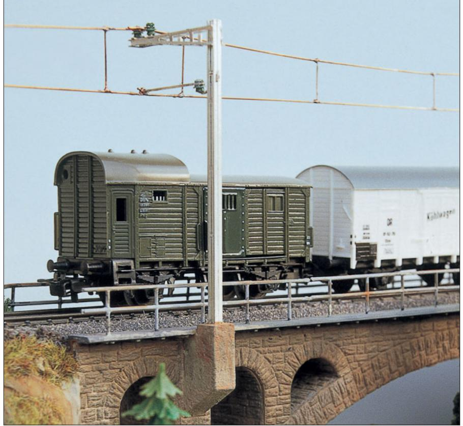
Einhaltung der Fahrdrathöhe und die Anbringung eines Brückenschutzes. Oder das Trageisil wird direkt unter der Brückendecke mit Halterungen an der Brückenstirnseite beweglich verlegt und durch Isolatoren vom spannungsführenden Teil getrennt.
