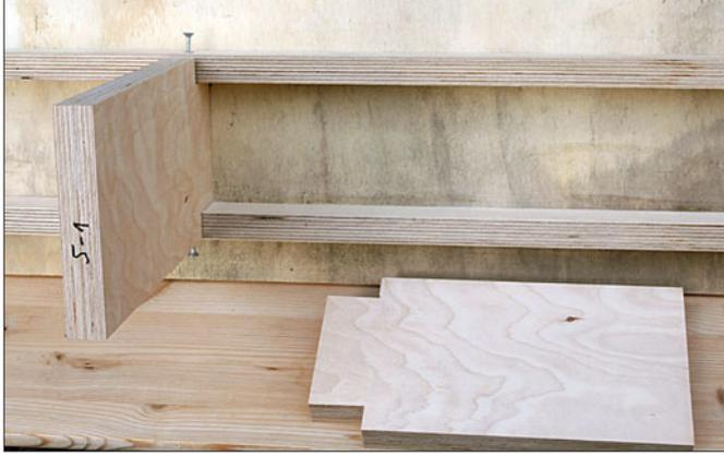
Die schmalen Pfeiler sind Attrappen und werden „frei hängend“ in den Drittelpunkten zwischen die Längsträger geschraubt. Die tragenden Pfeiler wurden beiderseits mit „Führungs“-Platten verstärkt. Trotz Schablonenbohrung wurden alle Teile durchnummeriert (oben).
