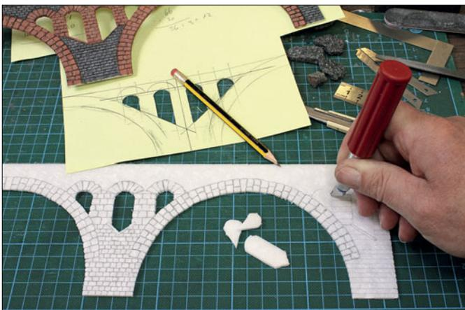
Die etwas hervorstehenden Sockel entstehen – wie auch die Wölbungsbögen – aus handelsüblichen Schaumstoffplatten mit geeigneter Gravur. Als Kleber dient UHU-Por im Kontaktklebeverfahren.
