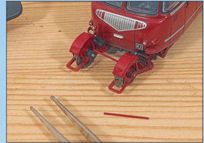
Die Querstreben zwischen den Radhalterungen der Spurwagen werden nachträglich an das Modell geklebt.
