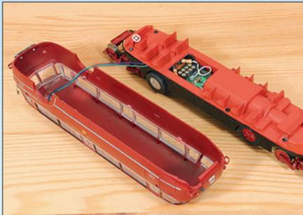
Die Anschlussdrähte der Innenbeleuchtung werden zur Lötleiste geführt und die Inneneinrichtung wieder aufgeschraubt. Ein kleiner Decoder schaltet das Licht im Digitalbetrieb.
