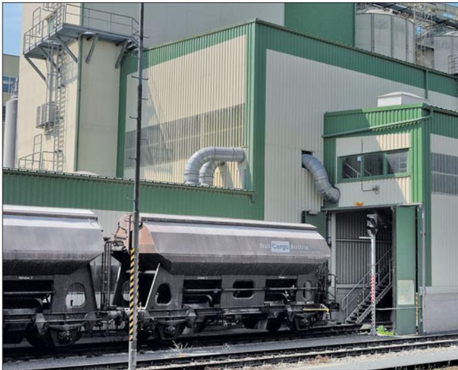
So könnte die Beladung von Waggons mit Schüttgütern aussehen. Diese erfolgt häufig in abgeschlossenen Gebäudeteilen, um sie vor Nässe und Verunreinigungen zu schützen. Das grüne Signallicht zeigt die erlaubte Weiterfahrt für eine bestimmte Waggonlänge an.
