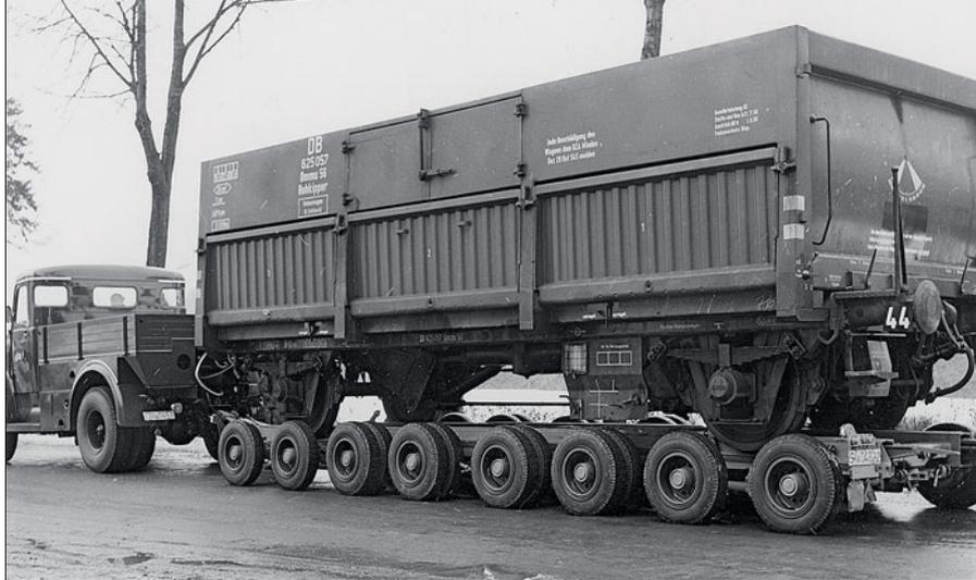
Ein achtschiger SEAG-Strassenroller LR 40.3 von 1958 mit einem von der SEAG entwickelten Hubkipper. Rechts: Blick in das „Innere“ eines LR 40.3
