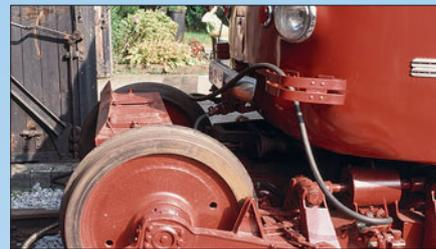
Unter der Stoßstange befinden sich die Luftkupplungen für die Bremsleitung und die davor liegende Besandungsanlage.
