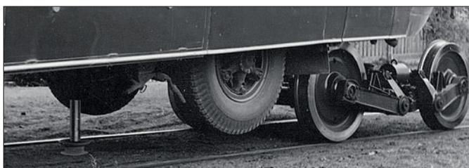
An diesem Bus aus der Vorserie bewerkstelligten vergleichsweise kleine Hydraulikstempel vorn und hinten im Chassis das Anheben.
