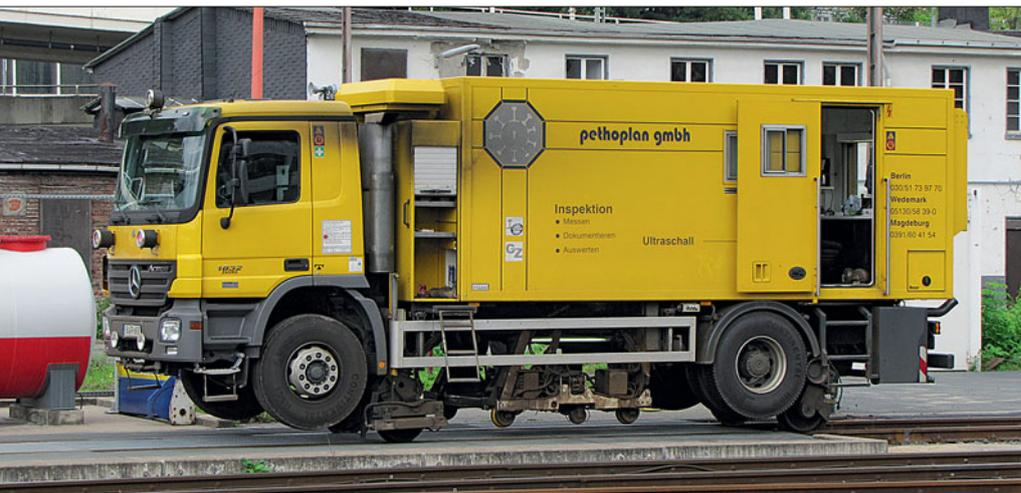
Dieser schienengängige Actros 1832 ist für 80 km/h zugelassen. Die Kraftübertragung erfolgt hydrostatisch auf die einachsigen Fahrgestelle. Gut zu erkennen sind die in Fahrzeugmitte unter dem Wagen angebrachten Ultraschall-Prüfköpfe. Foto: Dr. Löttgers
