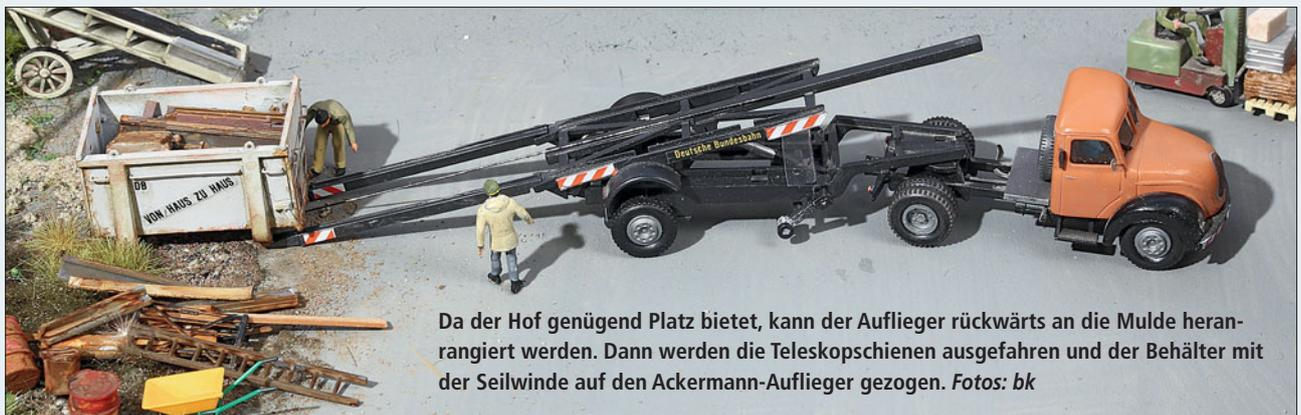
Da der Hof genügend Platz bietet, kann der Auflieger rückwärts an die Mulde herangangiert werden. Dann werden die Teleskopschienen ausgefahren und der Behälter mit der Seilwinde auf den Ackermann-Auflieger gezogen. Fotos: bk
