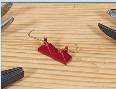
Die dünnen Drähte werden so gebogen, dass sie nach vorne schwenken und vor die Räder reichen. Die korrekte Form wird durch Anhalten an den Spurwagen ermittelt.
