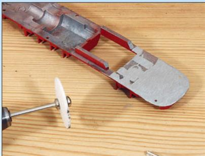
Links: Um den erforderlichen Platz für die Verkabelung der Beleuchtung zu schaffen, wurde die Unterseite der Inneneinrichtung etwas dünner geschliffen.
