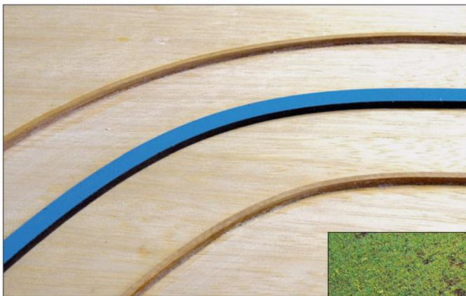
Nach dem Aufkleben der Magnetspur werden links und rechts entlang der Fahrbahnbegrenzung noch zwei Holzleisten in gleicher Stärke geklebt. In den Kurven lassen sich Holzleisten besser biegen, wenn weiches Holz verwendet wird und wenn es zuvor eingeweicht wird. Die Lücken werden anschließend mit Füllspachtel o.Ä. aufgefüllt.
