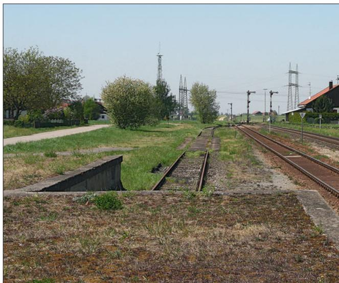
Bei einfacher Gleisplangestaltung lagen Rampe und Ladestraße oft am selben Gleis. In Pirach bildete die Kombirampe zugleich den Abschluss des Ladegleises. Im üppigen Grasbewuchs sind die letzten Reste der Ladestaßenkante erkennbar. Interessant ist die partielle Abdeckung des mittleren Ladegleises mit Betonplatten.
