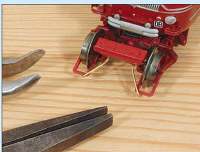
Der Sandkasten wird in den Spurwagen geklebt und die gebogenen Drähte vorne an den Bügeln festgeklebt. Sie sind so zu kürzen, dass sie kurz über den Schienen enden.
