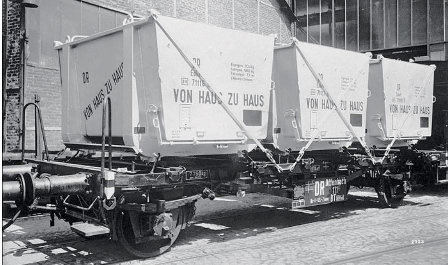
Ein BTs 50 mit drei offenen Großbehältern auf dem Werksgelände der SEAG – die Beschriftung im Jahre 1952 immer noch mit „DR, Offenbach“ und „Brit.-US-Zone“. Die Aufnahme eines unbeladenen Schwesterfahrzeugs im Bild unten macht deutlich, wie die Behälter auf dem Wagen befestigt werden.
