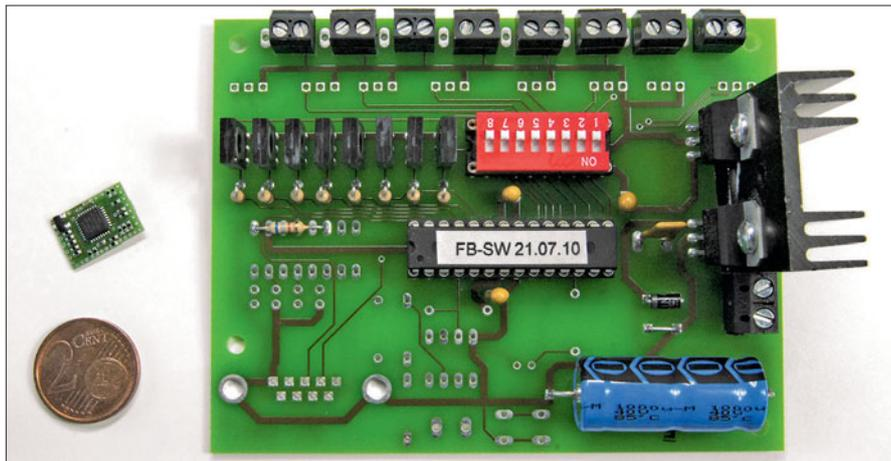
Mit Hilfe spezieller Funktionsbausteine wie dem für das DC-Car-System können Fahrzeugdecoder des gleichen Herstellers beeinflusst werden, um z.B. anzuhalten oder das Licht einzuschalten. Beide kommunizieren drahtlos per Infrarot.
