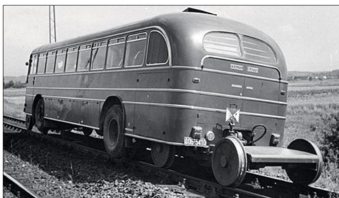
Die ersten Versuche fanden mit einem Krauss-Maffei-Bus statt. Dessen innere Reifen an der Hinterachse passten zur Spurweite. Die Spurwagen wurden mithilfe von hölzernen Rampen dem Bus untergeschoben. Fotos: DB/Archiv Michael Meinhold
