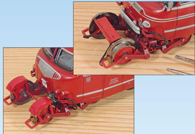
Mit einer Pinzette werden die Schlauchattrappen dann von den Spurwagen zum Bus gefädelt. Deutlich sind die Schlaufen zu erkennen, die die Bogenläufigkeit der Spurwagen ermöglichen. Der hintere Schlauch steckt in einem Loch neben der Luftkupplung.
