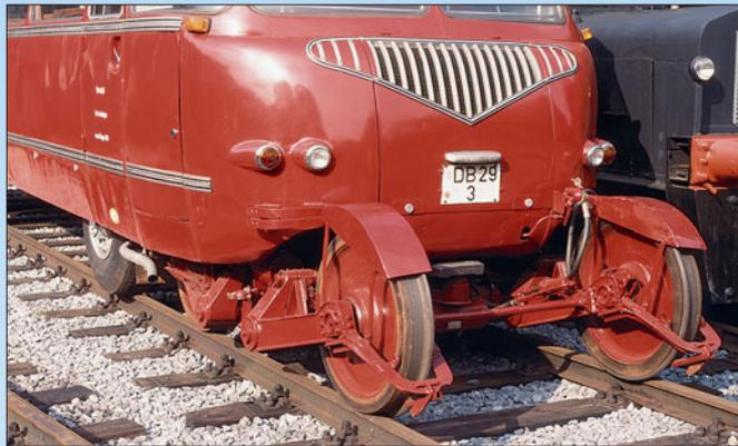
Der hintere Spurwagen im Detail. Rechts unter dem Nummernschild befindet sich die Luftkupplung für die Bremsleitung, die an die Bremse führt. Die Schutzbleche sind aufgesteckt.
