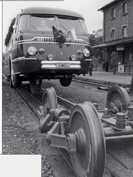
Rechts: In Kötzing war der Bus sogar mit Fähnchen und Girlanden geschmückt. Gut zu erkennen ist, dass der Hydraulikstempel nun von einer klappbar gelagerten und recht breiten Platte stabilisiert wird. Der Untergrund musste somit nicht mehr ganz so fest sein.
