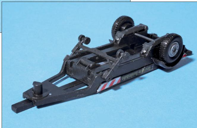
Damit das Stützgestell weit genug unter das Fahrgestell des Aufliegers gehievt werden kann, müssen zuvor die beiden radnahen Dreiecksverbindungen entfernt werden.
