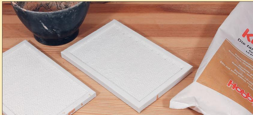
Mit Silikon-Kautschukformen, wie sie Spörle anbietet, lassen sich Gipsabgüsse herstellen, die man zu Ladestraßenpflasterungen zusammensetzen kann. Hier wurde Hartgips verwendet, der nicht so leicht bricht. Nach ausreichender Trocknungszeit entnimmt man die Gipsabgüsse der Form. Sie sollten identische Stärken aufweisen, damit beim Zusammensetzen störende Kanten ausbleiben. Nach dem Aufkleben der „Platten“ auf die Grundplatte verspachtelt man die Stöße und ritzt gegebenenfalls einzelne Fugen nach.
