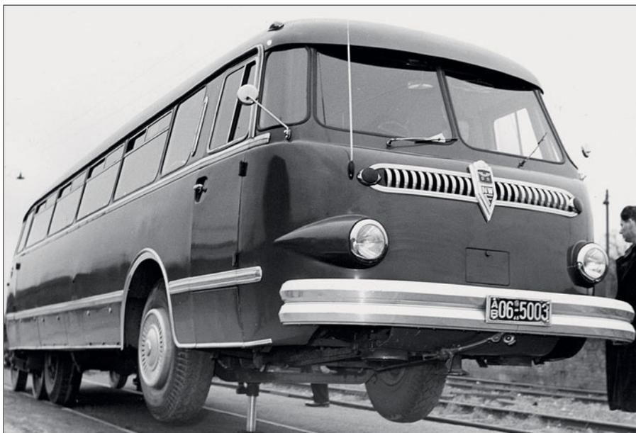
Antriebsachsen in etwa übereinstimmten. Die Vorderachse, die nicht mit der Spurweite der Schienen harmonierte, musste ganz angehoben werden, während die Hinterachse mit Teillast auf den Schienen laufen konnte und mit etwa 2/3 der Last zum Antrieb genutzt werden konnte.
