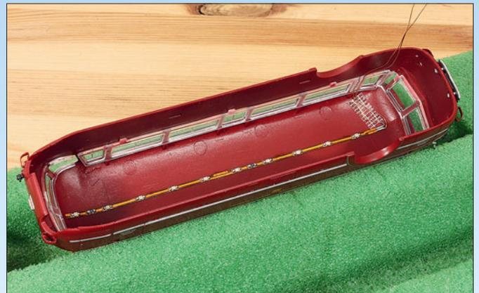
Die Innenbeleuchtung des Fahrgastraumes wird durch ein LED-Band erreicht. Sie ist innen unter das Dach geklebt worden.
