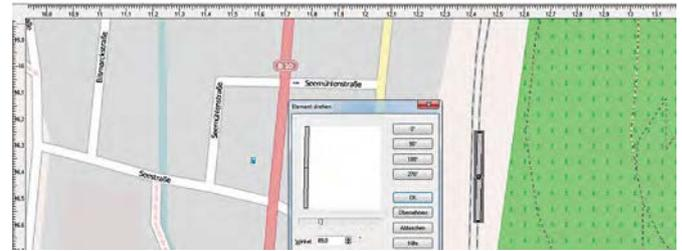
Über den Dialog „Gleiselement drehen“ wird nun der Abschnitt aus den geraden Gleisen an den Verlauf der Vorlage angepasst. Dies erfolgt dank des „Übernehmen“-Buttons recht schnell. Wünschenswert wäre hier eine „Ausrichten-Funktion“, die das Gleis an einer imaginären Geraden zwischen zwei Mausklicks ausrichtet – eine solche bietet aber bisher keines der Gleisplanungsprogramme.
