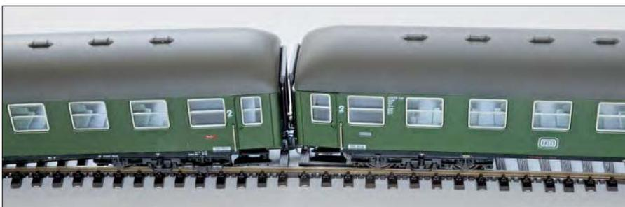
Zwei kurzgekuppelte, maßstäbliche H0-Roco-Mitteleinstiegswagen vom Typ B4ymg beim Gleiswechsel auf zwei Tillig-Elite-EW-5-Weichen. Der Wagenversatz ist für Modellverhältnisse minimal und optisch in Ordnung. Ein fast gleiches Bild ergibt sich mit dem RocoLine-10°-Typ.
