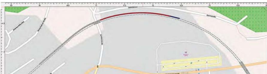
Weist der Bogen verschiedene Krümmungsradien auf oder handelt es sich um eine S-Kurve, so kann der Verlauf nicht durch ein einziges Flexgleis nachgebildet werden. Stattdessen wird an der Position, an der sich der Krümmungsradius ändert, ein weiteres gerades Gleis so platziert, dass es als Tangente an der Kurve der Vorlage anliegt.
