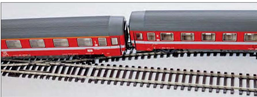
**Oben:** Das H0-Beispiel zum Wagenversatz beim Gleiswechsel mit den 15°-Weichen von Roco oder Tillig-Elite. Zwei Roco-Eurofima-Wagen befinden sich mittig im Gleiswechsel. Der Versatz beträgt etwa die Hälfte der Wagenbreite.
