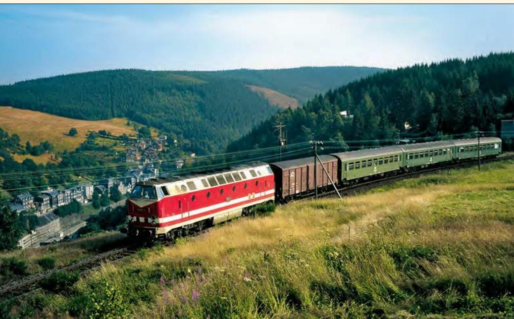
Dieses Foto vom P 18006 am 6. August 1991 verdeutlicht die topografische Problematik, die seinerzeit zum Bau des Spitzkehrenbahnhofs Lauscha (Gleisplan unten) führte: Seit der Abfahrt aus dem 85 m tiefer liegenden Bf Lauscha (erkennbar an seinen Stützmauern ganz links im Bild) hat der Zug u.a. einen Gleisbogen von rund 4 km Länge hinter sich! *Foto: Udo Kandler*
