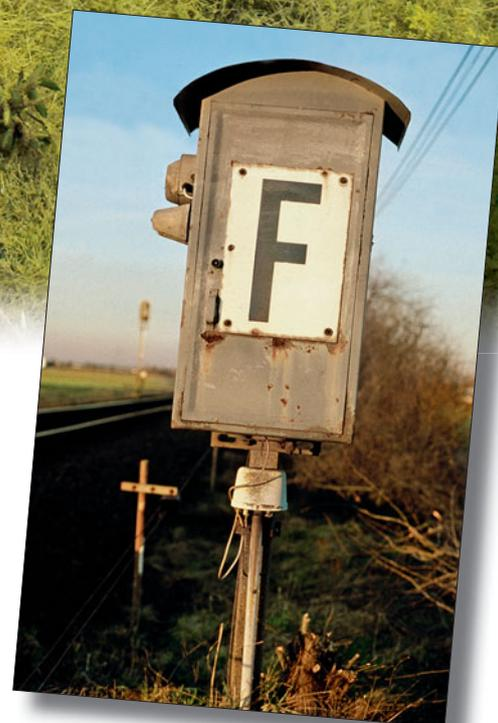
Ein Signalfernsprecher der alten Bauart mit gewölbtem Dach und einem sogenannten „Außenwecker“ an der Seite. Die Leitung führt in einem Rohr nach unten. Die stimmungsvolle Aufnahme im Abendlicht zeigt gewissermaßen ein Zeugnis einer längst vergangenen Epoche.
