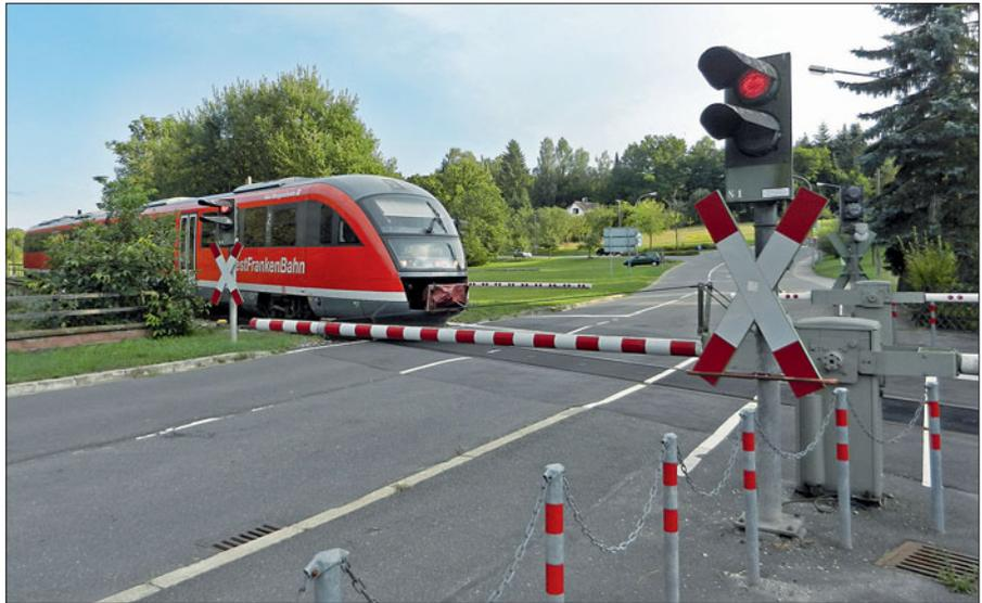
**Einer der Vorbildbahnübergänge befindet sich in Walldürn an der Strecke Miltenberg–Seckach im Odenwald. Interessanterweise wurden bei der Sanierung der Sicherungstechnik die alten Ampelschirme beibehalten.**
